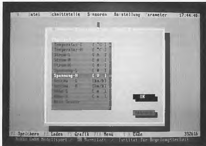
Konfigurationsmenü zur Zuteilung der Sensoren zu den einzelnen Kanälen.
