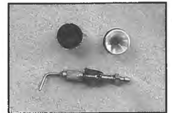
Der Düsenstock ist dann notwendig, wenn anstelle des Drosselvergasers der offene Ansaugtrichter montiert wird. Links der große „Renntrichter“, rechts der kleinere zum Einlaufen ohne RC-Funktion
