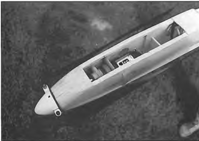
Der Antrieb. Das Getriebe ist Eigenbau unter Verwendung des Graupner-Produktes mit der Übersetzung 3:1. Durch eine zweite Stufe (im Bild ist das Abtriebszahnrad dieser zweiten Getriebestufe zu sehen) wurde eine Übersetzung von 16,15:1 erreicht
