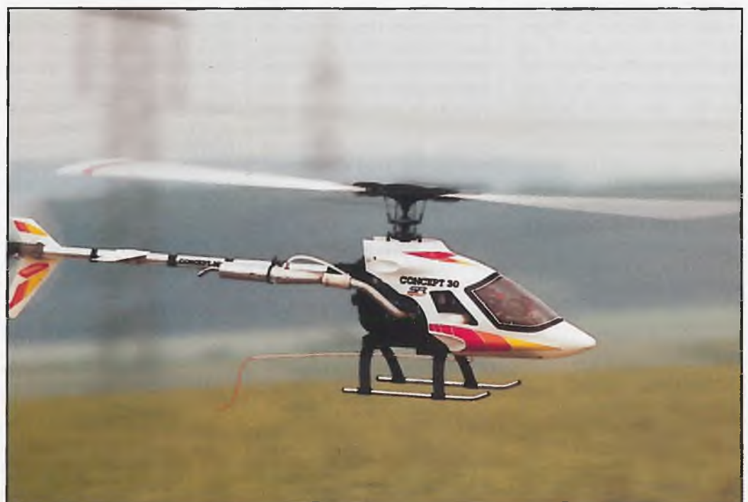
Der Concept 30 von Kyosho stellt eine eigenständige Entwicklung dar, die sich an kein herkömmliches System anlehnt. Im Prinzip eine Kunststoff-Mechanik mit zweistufigem Getriebe, bei dem der Motor längs hängend eingebaut ist
