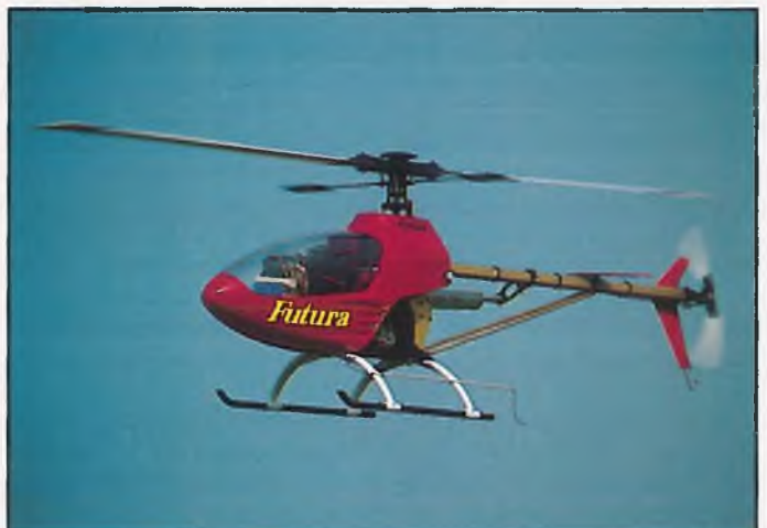
Der Futura stellt zur Zeit den modernsten Robbe/Schlüter Hubschrauber dar. Er hat zwar auch noch die Grundidee mit den zwei Alu-Seitentellen, hat aber schon Lagerböcke aus Kunststoff, kombiniert also beider Vorteile
