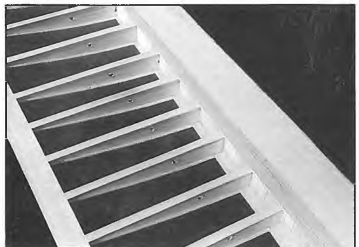
Leichtbau aus 3 Komponenten: ausgesuchtes Balsaholz, Sekundenkleber, extrem leichte Bespannfolie (11 g/m 2 ). Der Flügel ist trotz des niedrigen Gewichts (160 g) so steif und fest, daß (eingeschränkter) Kunstflug möglich ist. Die Grenze des Leichtbaus ist damit bei weitem nicht erreicht. Der Autor hält eine Halbierung des Gewichts für machbar - bei ausreichender Festigkeit
