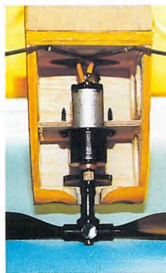
Der Antrieb des Slow-Boy: Die leichte Version mit dem TP-03 ...
