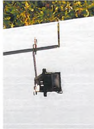
▲ Die Querruderanlenkung wurde abweichend von der Herstellerempfehlung gebaut.
