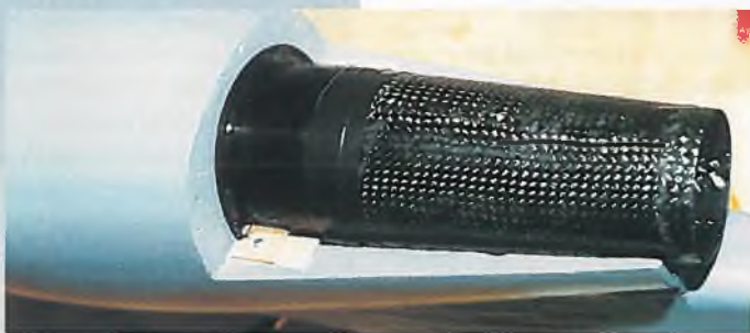
Fertig eingebauter Impellerantrieb.
