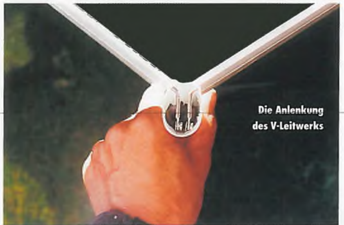
Mit den MPX-Flächenservos hat man gleich den kompletten Einbau samt Verkleidung des Gestänges im Handumdrehen erledigt.
