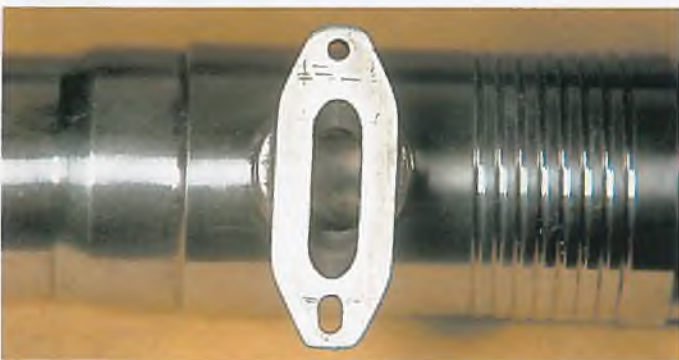
Der Schalldämpferflansch mit dem Langloch, das nun exakt auf das Flanschmaß des Raptor-Motors passt.
