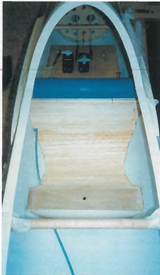
Das Cockpit des Fox entsteht. Der hintere Sitz besteht aus 5 mm breiten Balsastreifen, die mit einer Lage 49-g-Gewebe belegt wurden.
