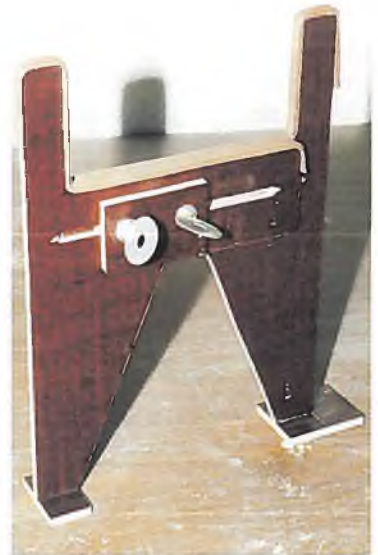
▲ Die Montagehalter lassen sich auf verschiedene Breiten einstellen.
