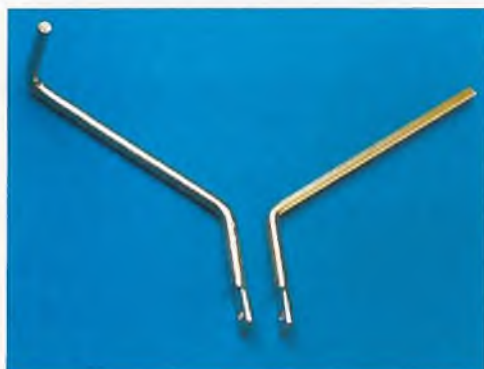
Nach dem Willen des Herstellers sollen die Ruderhebel stumpf verklebt werden (rechts). Die abgewinkelte Version (links) gibt mehr Sicherheit.
