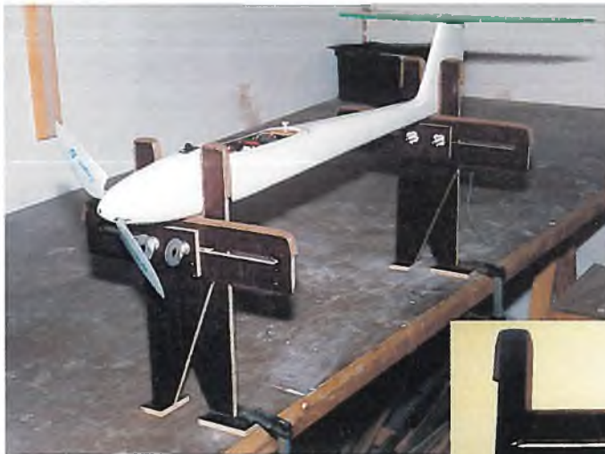
▲ Die Montagehalter lassen sich auf verschiedene Breiten einstellen.
