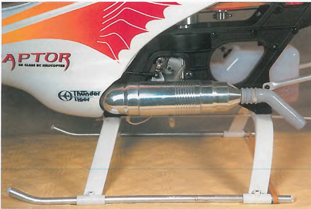
Die Kabinenhaube muss leicht ausgeschnitten werden, damit der robbe-Dämpfer passt. ▼
