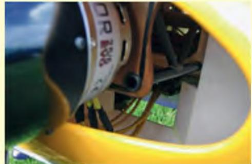
▲ Aus Depron ist ein Luftleitsystem in die Motorhaube eingebaut, das auf drei Seiten um den Motordom abdichtet. Die schwarze Hutze aus GFK sorgt für die seitliche Motorkühlung, da dieser vom Spinner vollständig verdeckt wird. ▼
