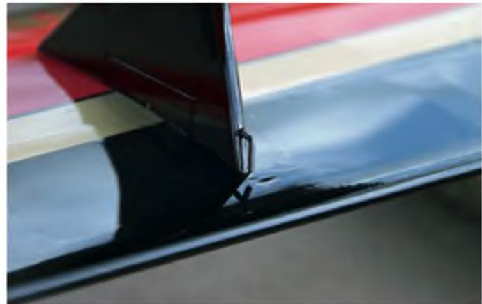
Mit je einem Drahtsplint werden die Streben mit der Flächenaufnahme verbunden – die Rüstzeit fällt mit weniger als drei Minuten alltagstauglich kurz aus.
