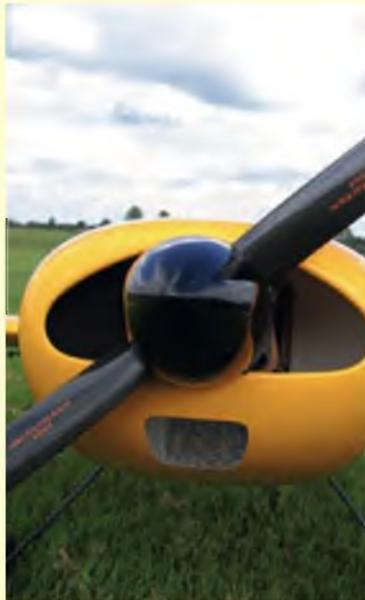
▲ Die Ölkuhler-Öffnung in der Motorhaube wurde zusätzlich angebracht, damit der YGE-HV-Regler direkt von kalter Propellerluft angeströmt wird.
