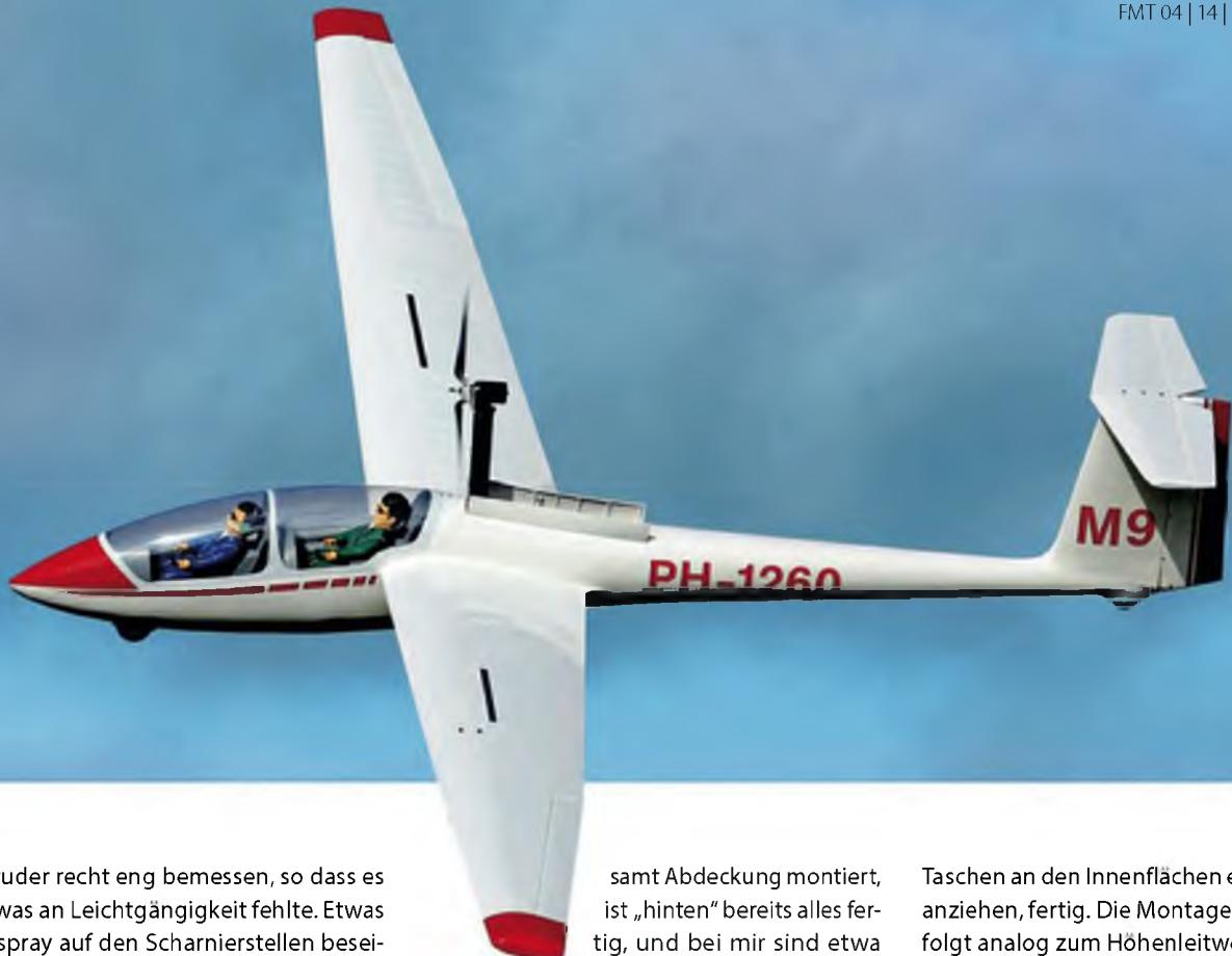
Seitenruder recht eng bemessen, so dass es hier etwas an Leichtgängigkeit fehlte. Etwas Silikonspray auf den Scharnierstellen beseitigt diesen Zustand aber zuverlässig. Da am Übergang der Seitenruder-Dämpfungsfläche zur Rumpfröhre doch einige Kräfte wirken, hat der Hersteller in diesem Bereich senkrecht stehende Kohlefaserrohre zur Verstärkung eingebbracht. Stabil und leicht zugleich – gut gemacht!
