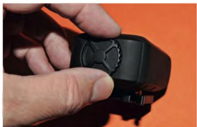
Dieser Schraubknopf verschließt den hinteren Deckel wassererdicht. 3 Meter Tauchtiefe sind ohne Zusatzgehäuse erlaubt.
