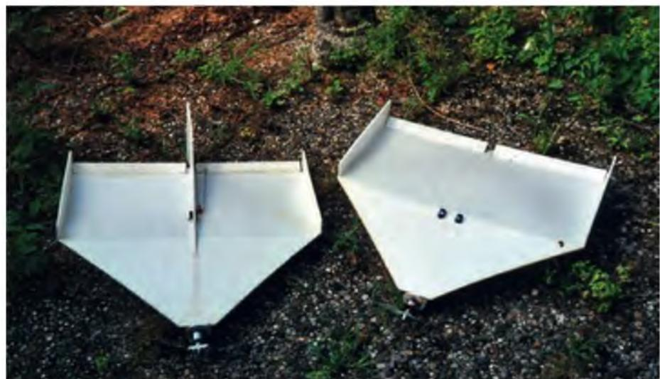
Links der HR/SR-gesteuerte Prototyp mit Rückenflosse, die dank ausgiebiger Schränkung nicht nötig ist. Auf die Flossenteile im Plan kann also verzichtet werden.
