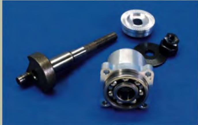
Das Kurbelwellen-Lagergehäuse ist aus dem Vollen gefertigt.
