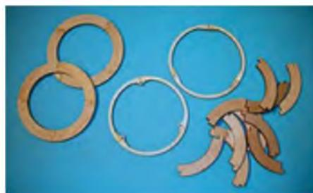
Die Motorhaube wird aus Balsaringen gefertigt und in Form geschliffen.
