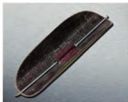
Die Haube wird per Stahldrahtmethode auf dem Rumpf gehalten, der Draht ist bereits fertig montiert.
