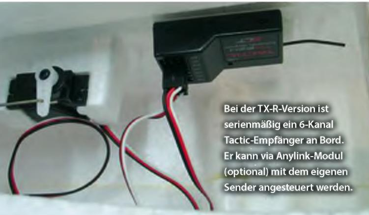
Bei der TX-R-Version ist serienmäßig ein 6-Kanal Tactic-Empfänger an Bord. Er kann via Anylink-Modul (optional) mit dem eigenen Sender angesteuert werden.
