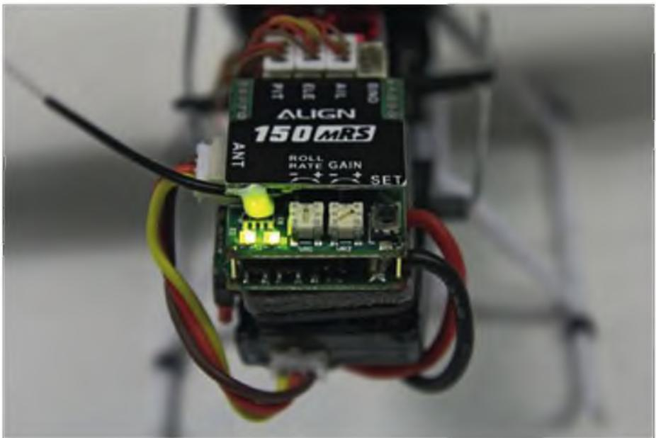
Alles okay. Die grünen LEDs signalisieren Startbereitschaft. Das Poti für die Rollrate (links) steht auf 12 Uhr für 3D-Flug. Das Poti für Gain steht auf 2 Uhr.
