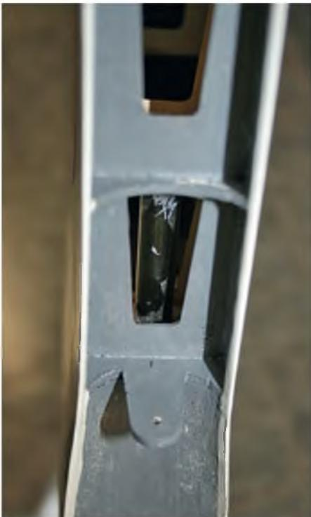
Das im Text angesprochene Kohlefaserrohr dient zur Versteifung des Rumpf-Seitenleitwerk-Übergangs.
