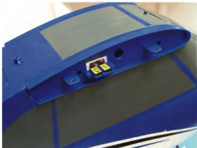
Die Flächenaufnahme am Rumpf. Integriert sind die Halter für die Servokabel, die fertig beschriftet sind.
