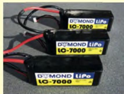
Die neuen Akkugröße von Staufenbiel: 7.000-mAh-Dymond-Zellen mit 30C und nur etwa 157 g Zellengewicht, was rund 44,5 mAh je Gramm entspricht.
