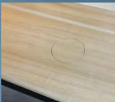
So sind die Servoschächte vorbereitet, der entsprechende Teil der Beplankung muss noch abgelöst und das darunter liegende Styro entfernt werden.
