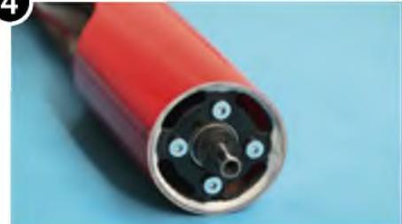
Sind wir mit dem Sitz zufrieden, wird der Motorspant mit ein paar Tropfen Sekundenkleber fixiert, danach der Motor vorsichtig ausgebaut und der Motorspant mit 24-Stunden-Epoxy umlaufend beidseitig eingeklebt.
