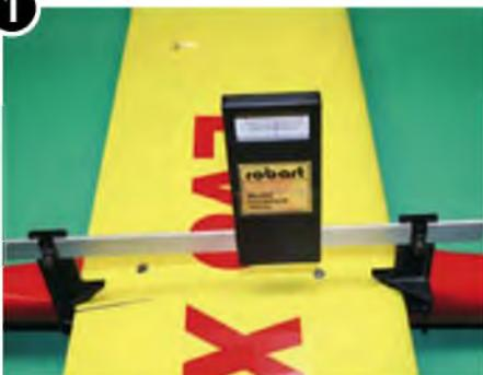
Die Tragfläche wird auf dem Rumpf angesteckt/verschraubt und das Ganze auf dem Baubrett mit einem Einstellwinkel zwischen 1 und 1,5° fixiert.
