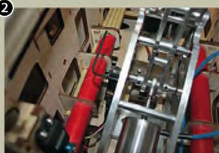
◀ Impulsunterbrechungsschalter lösen, damit man den Kabelbaum nicht herausziehen muss.
