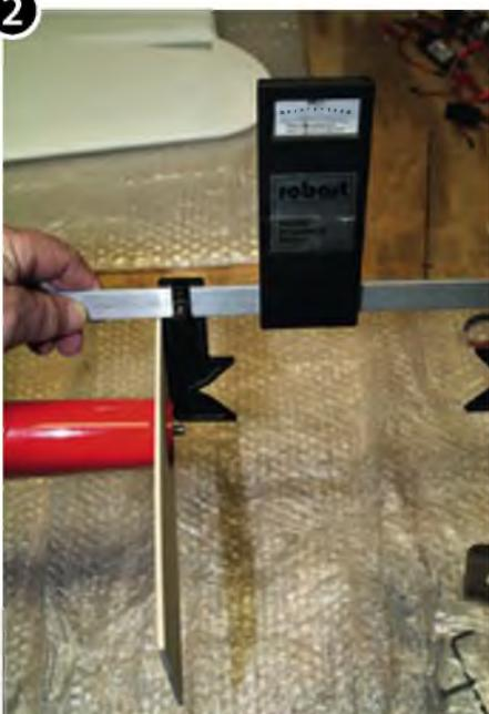
Die Lehre an der Rumpfspitze kann nun mit der EWD-Waage für den notwendigen Motorsturz von 3 bis 5° ausgerichtet werden. Dazu wird die EWD-Waage mit einem Schenkel an die Lehre gehalten und diese solange verrückt, bis der gewünschte Wert für den Motorsturz erreicht ist.
