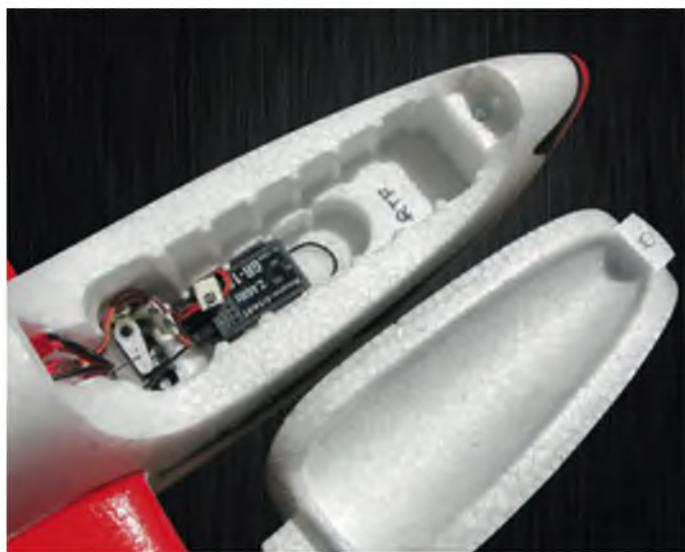
Unter dem Flugakku befinden sich der Empfänger und das Höhenruder-servo.
