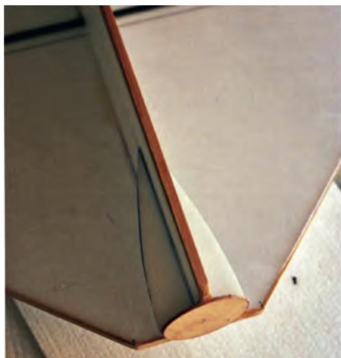
Die Ruderhörner wurden aus 1-mm-Sperrholz ausgeschnitten. Statt mit Kiefernholz kann der Kiel auch mit einem 6x1-mm-CFK-Profil verstärkt werden.
