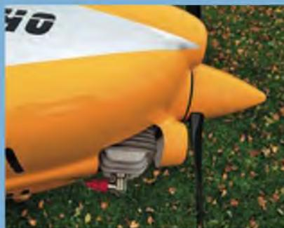
Der Zylinderkopf lässt sich nicht so einfach verstecken wie ein Elektromotor. Glücklicherweise liegen dem Bausatz verschiedene Frässchablonen für die Kühlöffnungen bei.
