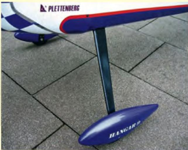
▲ Das mit Orastick in CFK-Optik beklebte KHK-Fahrwerk aus GFK: 200 g sind gegenüber dem originalen Alu-Fahrwerksbügel eingespart.
