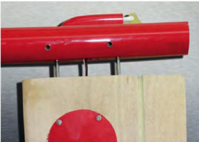
Das V-Leitwerk im Detail. Die Servoschachtabdeckungen wurden selbst beschafft und mittels kleiner Schräubchen befestigt. Die Steckung am Rumpf geschieht über Stahldrähte.
