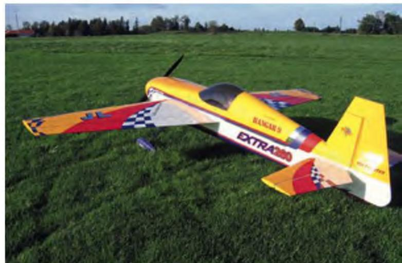
Die Hangar 9-Extra ist deutlich größer und voluminöser als so manches 2,6-m-Modell – durch konsequente Gewichtseinsparung ist je nach Antriebskonfiguration ein Fluggewicht ab 12,1 kg möglich.
