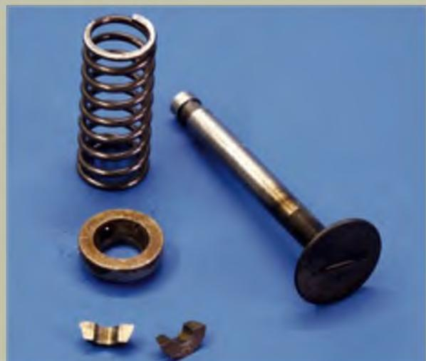
Das Auslassventil mit Feder, Federteller und Kegelhälften.
