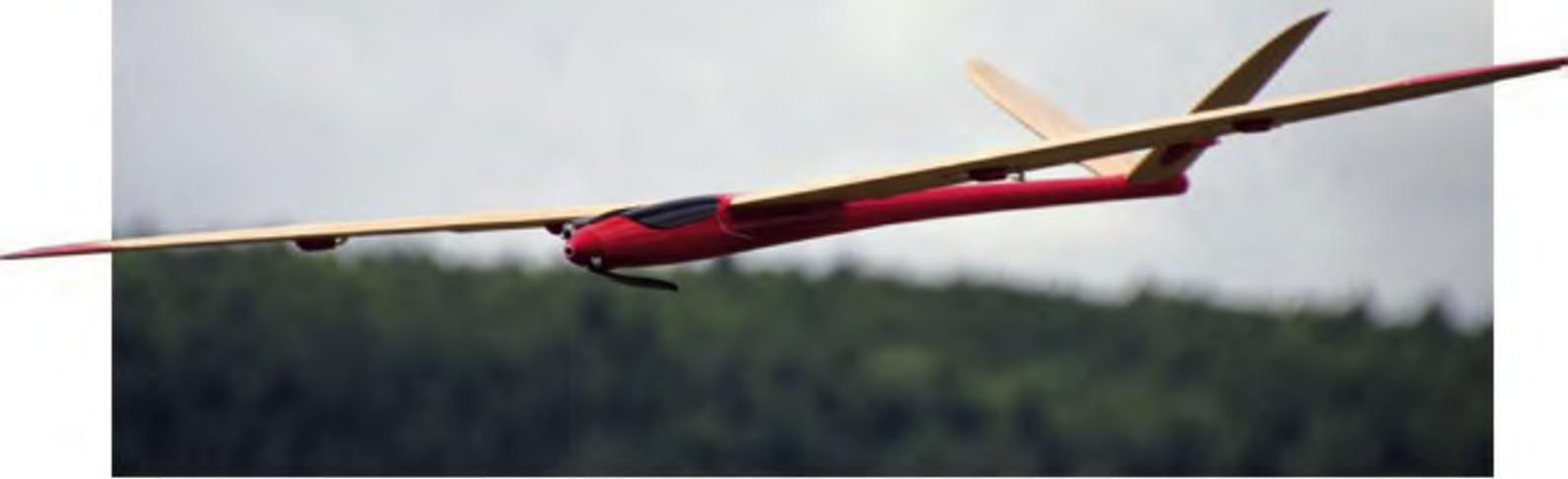
so dass der Antrieb ein erstes Mal abgestellt und die Trimmung des Modells überprüft werden konnte. Trimmkorrekturen waren kaum notwendig, der Fenrir lag von Anfang an ruhig in der Luft und vermittelte gleich ein vertrautes Gefühl am Knüppel. Die Ruderreaktion auf Höhen- und Seitenruder ist angenehm weich, aber dennoch exakt; auf dem Querruder reagiert der Fenrir deutlich direkter, weshalb hier – je nach persönlichen Vorlieben – ein paar Prozent Expo sicherlich nicht schaden könnten.
