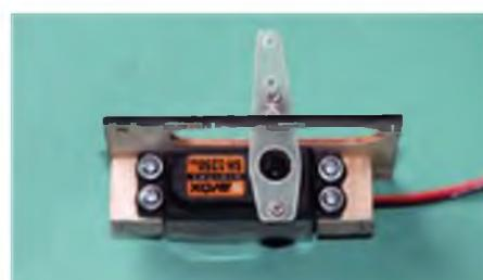
Die mit Hebelverlängerungen ausgestatteten Querruderservos wurden zusätzlich zur Verschraubung eingeschrumpft und mit dem Deckel verklebt.
