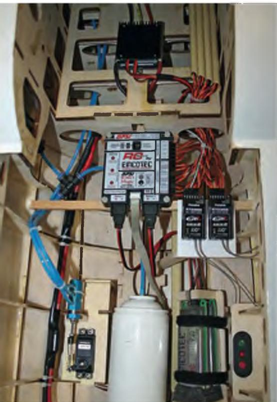
Im Rumpf ist ausreichend Platz zur Positionierung der Komponenten vorhanden, wobei der Regler so dicht wie möglich am Motor platziert werden sollte.
