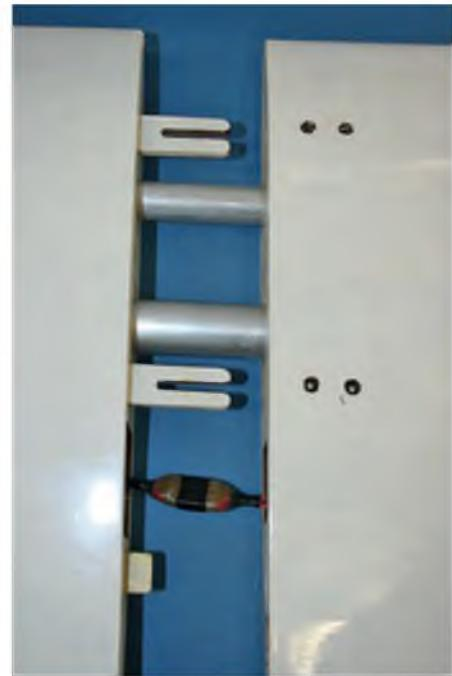
Außen- und Innenflächen werden über zwei Aluminiumrohre verbunden und mit einer Klemmbefestigung gesichert. Keine Sorge, die vier M4-Schrauben halten die Sache sicher zusammen.
