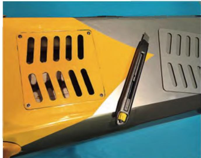
Die Aufnahme für die Deckel mit Kühlluftauslassöffnungen ist unter der Folie schon vorbereitet.
