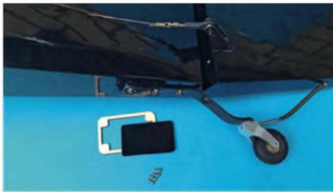
Am Rumpfheck befindet sich eine Gewichtsbox. Das Heckfahrwerk ist über eine kleine Spiralfeder mit dem Seitenruderblatt verbunden.
