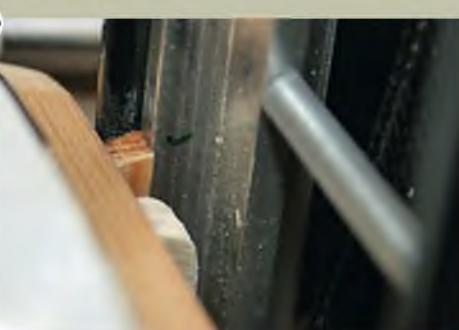
▲ Zusätzliche Distanzhölzer überbrücken die Höhe der Aluminium-Seitenteile der Mechanik. Darauf werden dann Aluminiumlaschen verschraubt, welche die Mechanik zusätzlich halten.
