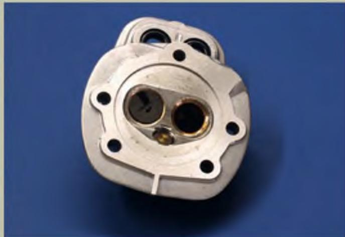
Der Blick in den Brennraum – das Auslassventil ist ausgebaut.
