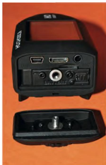
Bei abgenommenem Deckel hat man Zugriff auf das Akkufach, die HDMI- und USB-Anschlüsse sowie die Buchse für ein externes Mikrofon.
