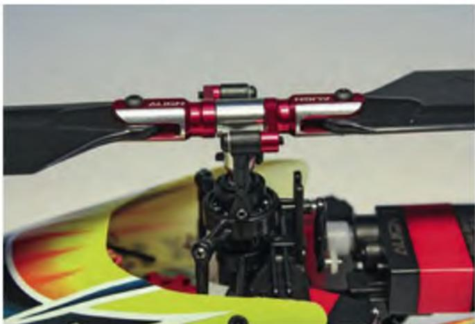
Das Sahnestück: der DFC-Rotorkopf. Durch die verdrehsichere Anbindung der Blatthalterlenkungen wird die Taumelscheibe mitgenommen.
