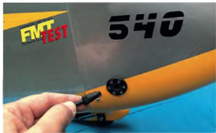
Über die PowerCube-Ladebuchse sind die Empfängerakkus komfortabel mit einem Stecker zu laden.
