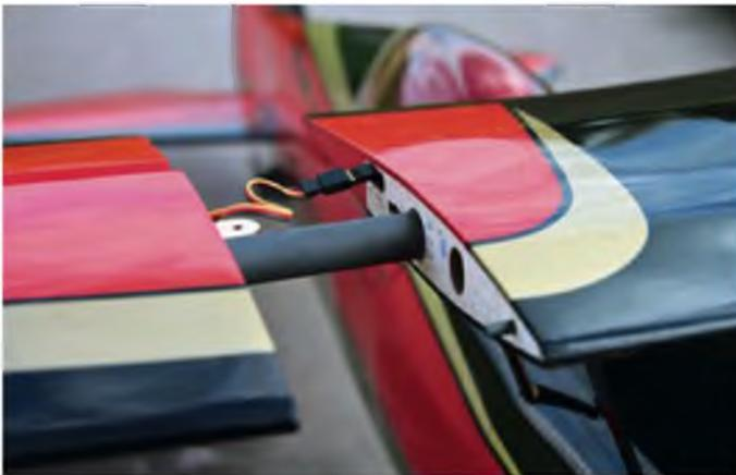
Die vier einzelnen Tragflächenelemente werden über CFK-Rohre mit dem Rumpf verbunden und mittels vier M3-Schrauben gesichert.
