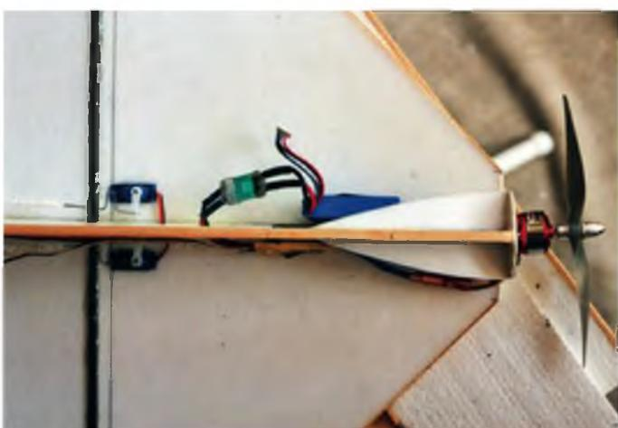
Antriebs- und RC-Einbau. Der Motor benötigt einen deutlichen Sturz und Seitenzug, den man z.B. mit Unterlegscheiben einstellen kann.
