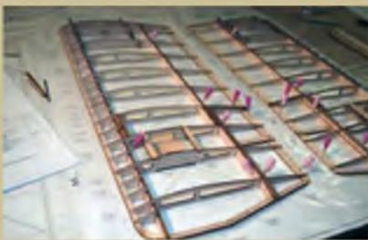
Bis auf die Servobretter bleiben die Tragflächen ohne Beplankung. Zwischen den Hauptrippen verstärken Halbrippen den Aufbau.
