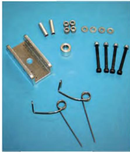
Alle Teile zum Aufbau der benötigten Faltnabe liegen dem Modell bei. Zwei der M4-Schrauben müssen allerdings gegen M3 getauscht werden, da man sonst die Luftschaublätter an der Wurzel aufbohren müsste.
