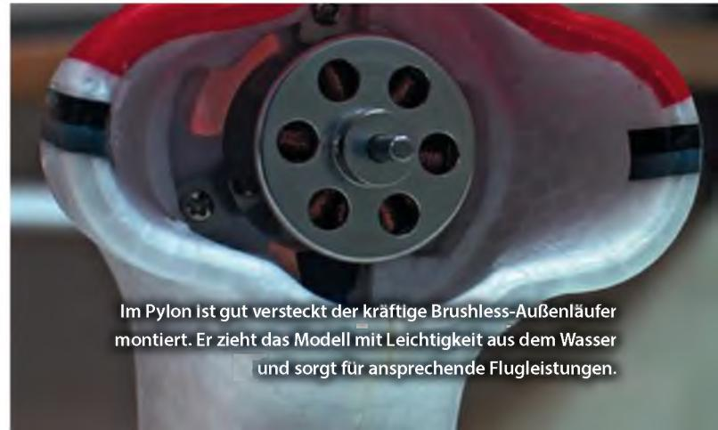
Im Pylon ist gut versteckt der kräftige Brushless-Außenläufer montiert. Er zieht das Modell mit Leichtigkeit aus dem Wasser und sorgt für ansprechende Flugleistungen.
