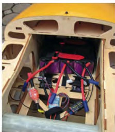
Hier ist das Modell mit den 5.000-mAh-Eco-Top-Fuel-Akkus bestückt. Davor zu sehen das Messequipment aus Unilog 2 mit Stromsensor und Jeti-Sendemodul, um ausgewählte Daten gleich online auf der Profibox einsehen zu können.
