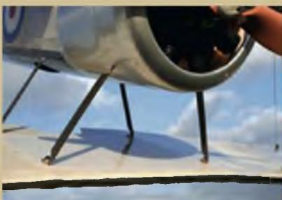
Die Stiele und Verstrebungen der Flächen erhöhen die Stabilität wesentlich. Die obere Fläche wird mit Gestängeanschlüssen am Baldachin befestigt.
