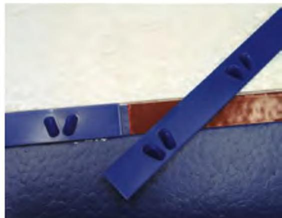
Die Turbulatoren werden mit Doppelklebeband auf den Tragflächenhälften montiert, sie tragen sicherlich zu den gutmütigen Langsamfliegenschaften bei.
