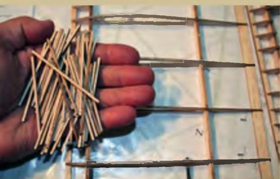
Zwischen den Rippen werden zusätzlich Diagonalstreben eingeklebt. Für diese Arbeit sind Nadeln und Pinzette unerlässlich.
