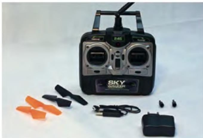
Mit im Lieferumfang: Sender (kurios sind die Knüppel zum Selbstan-schrauben), Ladekabel und vier Ersatzpropeller. Bei uns war auch ein USB-Netzteil dabei.
