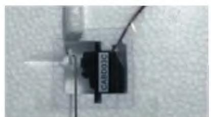
Mit einer dünnen Kunststoffscheibe aus einem Leichtverpackungsrest kann kein Schmutz mehr eindringen und die Aerodynamik wird etwas verbessert.
