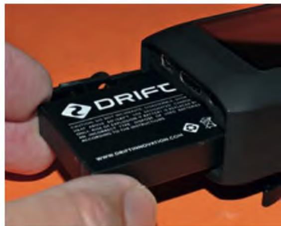
Der serienmäßige Li-Ion-Akku mit 1.700 mAh ermöglicht Laufzeiten bis zu 3 Stunden, das sollte für die meisten Anwendung genügen.
