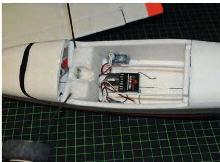
Das Fahrwerk wird in einem 2 cm starken EPP-Stück gelagert. Die Servos wurden einfach mit UHU-Por an die Rumpfseitenwände geklebt.
