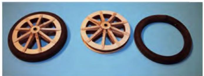
Die Räder sind ganz aus Holz gefertigt. Der Gummiring wird nach dem Be-spannen der Seitenflächen aufgeklebt.
