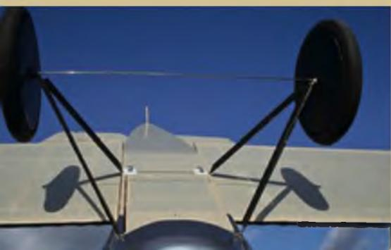
Das Hauptfahrwerk wird – wie auch der Baldachin – aus Stahldraht gebogen und anschließend mit Balsaholz verkleidet.
