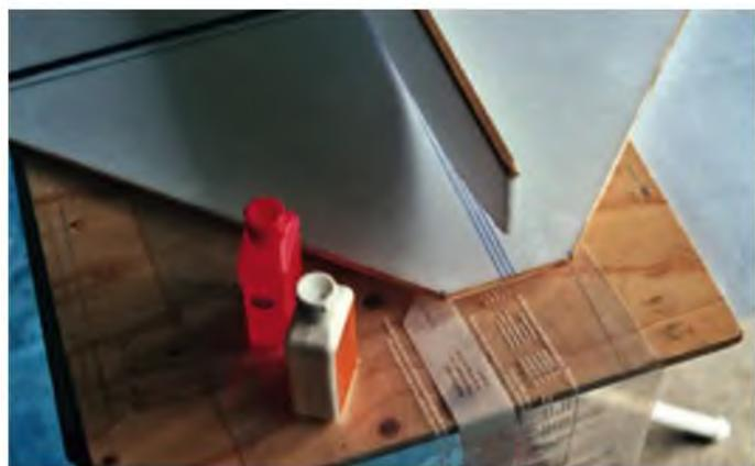
Gleich wird der vordere Teil des Kiels an die Fläche geklebt. Ebenfalls zu sehen: der Nasenleistenschutz aus Kiefernholz.
