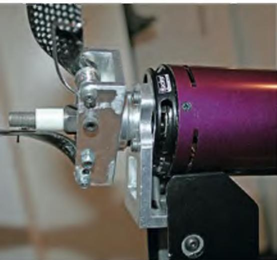
Die Motoraufnahme der Klappmechanik ist herstellerseitig passend für den Hacker A60 gebohrt. Ebenfalls zu erkennen ist die beiliegende Faltnabe mit den im Text beschriebenen Modifikationen.
