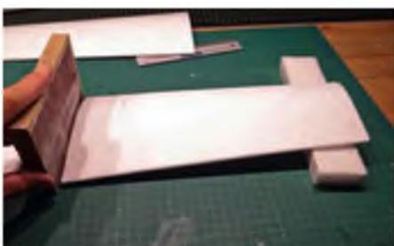
Die richtige V-Form der Tragfläche entsteht durch Unterlegen von 2 cm hohen Klötzen an den Flächenenden. Die Klebeflächen entsprechend zuschleifen.
