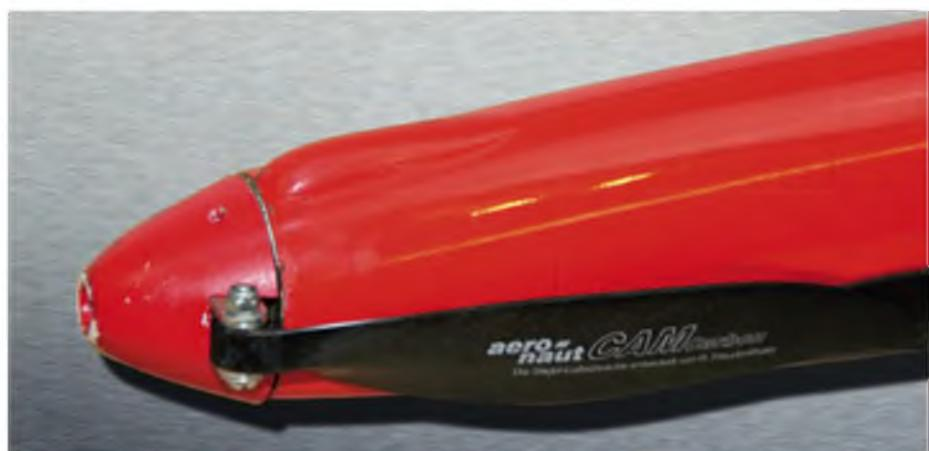
Die kleine Anformung am Rumpf ermöglicht es, die Kabel des Außenläufers elegant am Motor vorbei zu führen.
