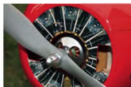
Für ausreichend Kühlluftzufuhr sorgt der bereits serienmäßig eingebaute Kühllufttunnel, der gezielt Luft auf die Rotorglocke des Motors lenkt.
