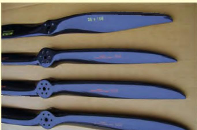
Diese vier Propeller haben sich prima für das Modell mit dem E-Antrieb bewährt. Man beachte das breite Blatt der Mejzlik E-Luftschraube, das sehr schmale der 27x14 SS sowie die vor allem im Außenbereich etwas breitere Blattform der neueren Super Silence-Propeller 29x13 und 30x16.
