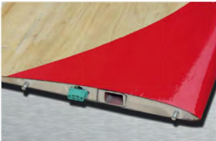
Hier sieht man schön die CFK-Einlage im Wurzelbereich, die Torsionsbolzen sind bereits fertig montiert, der MPX-Stecker wurde in Eigenregie verbaute. Das Design wurde aus Oracover-Klebefolie erstellt.
