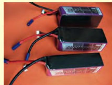
Die leichten 5.000er Eco-X, die laut Hacker auch wirklich für 20-C-Dauerentladung ausgelegt sind und ein Zellengewicht von etwa 122 g aufweisen, was rund 41 mAh je Gramm entspricht.
