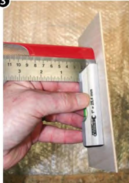
Auch der Seitenzug kann dabei berücksichtigt werden. Dazu wird ein Winkel an die Lehre gehalten, orientiert an der Trennnaht des Rumpfs. Ein Seitenzug von 2° entspricht dabei einer Abweichung von der Mittellinie (Trennnaht) um ca. 3 mm bei einem Abstand zur Rumpfspitze (Lehre) von 80 mm. Ist die passende Stellung der Lehre gefunden, wird deren Lage auf den Rumpf mit einem dünnen Filzstift übertragen. An dieser Linie wird nun der Rumpf exakt abgetrennt. Der
