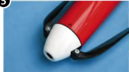
Das Ergebnis: Ein hervorragender Übergang, hohe Festigkeit und die Gewähr für eine optimale Einstellung von Motorsturz und Seitenzug.
