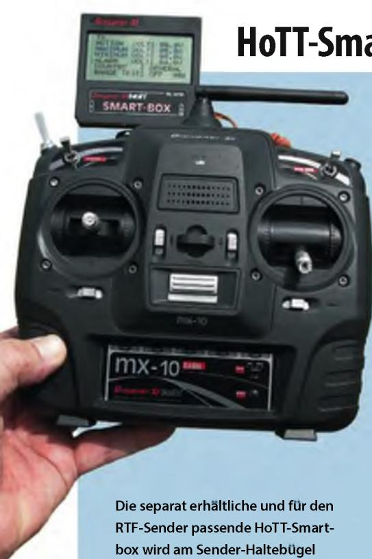
Die separat erhältliche und für den RTF-Sender passende HoTT-Smartbox wird am Sender-Haltebügel befestigt. Das Display ist auch bei Sonnenschein gut ablesbar.
