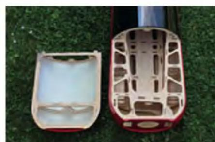
Der obere Teil der aus GFK gefertigten, geteilten Motorhaube ist abnehmbar und ermöglicht den direkten Zugriff auf Motor, Akku und RC-Komponenten.
