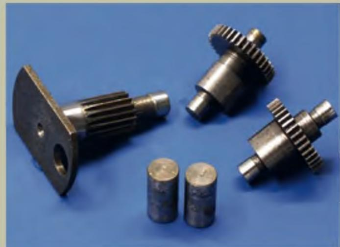
Die Nockenwellen mit Stößeln und Antrieb (rechts)
