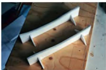
Eine Helling dient zur Befestigung der Seitenflossen. Beide Teile bestehen aus je zwei zusammengeklebten 6-mm-Depron-Platten.
