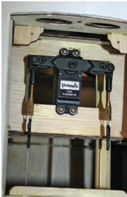
Das D-Power-Servo mit Gabriel-Abtriebshebel ist mehr als ausreichend stark dimensioniert, um das Seitenruder sicher zu bewegen. Insgesamt wurden 11 Servos von D-Power/Derkum verbaut.
