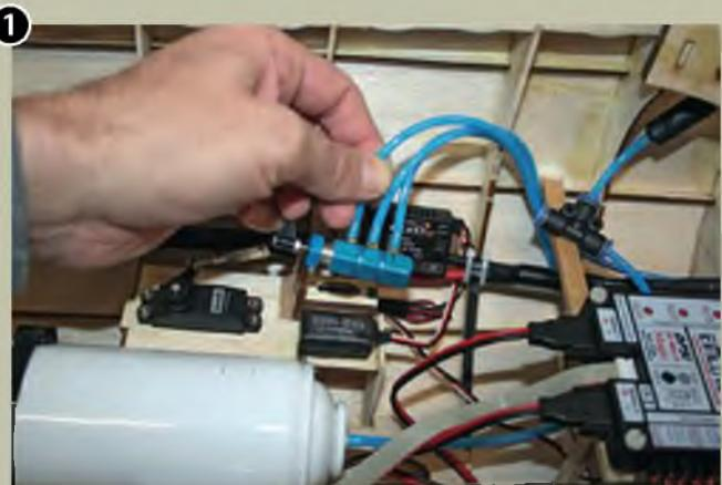
▲ Das Ventil wird gelöst und Richtung Triebwerk verschoben, damit die Schlauchverbindungen nicht gelöst werden müssen.
