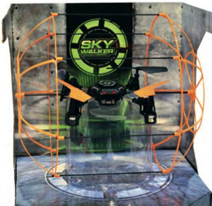
Nicht entsorgen sollte man die Transporthalterung. Auf ihr findet der R800 vor jedem Start sicheren Halt zum Initialisieren seines Kreiselsystems.
