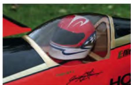
Die empfohlene Pilotenbüste passt gut zum Modell, muss allerdings vom Erbauer noch im Schulterbereich in der Höhe gestutzt werden.
