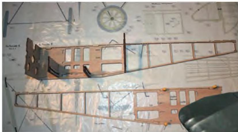
Auch so können Baupläne aussehen - gut gemacht, übersichtlich, farbig und prima gekennzeichnet. Die Rumpfseiten werden direkt auf dem durch Folie geschützten Plan aufgebaut.
