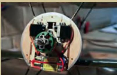
Motor, Regler und die Servos sitzen direkt vor dem Motorspant.
