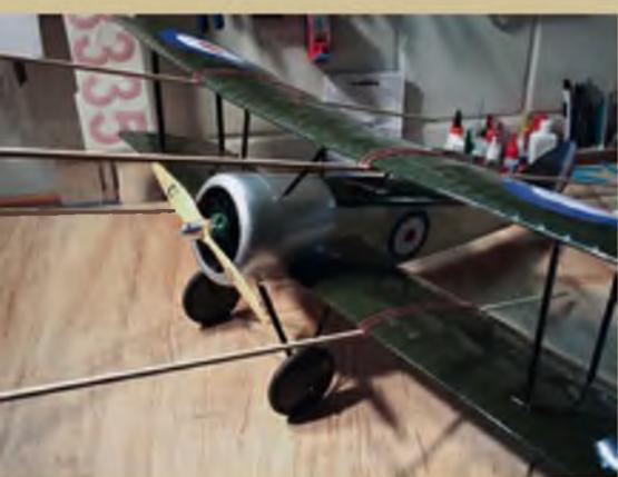
Damit die Einstellungen für die beiden Flächen exakt stimmen, erfolgt die Ausrichtung mit Kiefernleisten, die mit Gummibändern an der Unterseite der Flächen gesichert werden.
