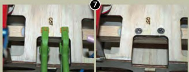
▲ Die Verstärkungsleiste wird mit der Struktur verklebt und zusätzlich verschraubt.
