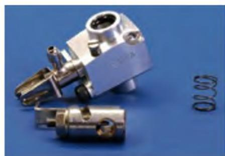
Detail am Vergaser: eine Dichtmanschette für die Düsenadel.
