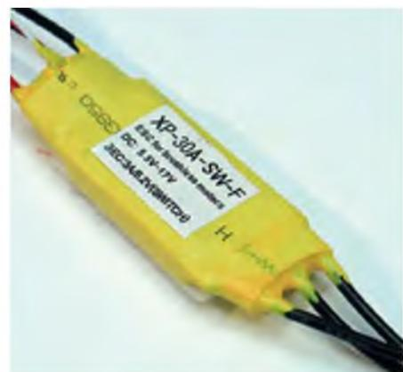
Die Schrumpfschlauchhülle des Reglers wurde an den Kabelaustritten mit Plastidip verschlossen, um die Elektronik vor Wasser zu schützen.
