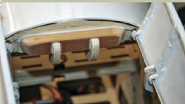
► Diese Teile benötigt man, um einen vorderen Anschlag für die Triebwerksmechanik zu erstellen. Über die zwei Sperrholzteile werden die Kräfte auf zwei Spanter übertragen.
