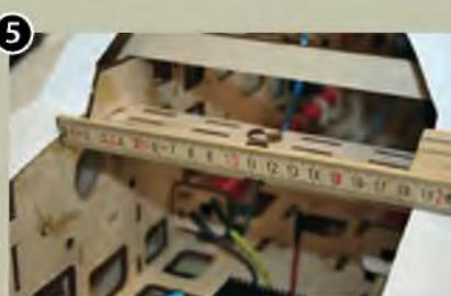
◀ Mindestens 195 Millimeter muss die Verstärkungsleiste lang sein, um die Kräfte sicher auf die stabilen Längsteile des Rumpfkastens zu übertragen.
