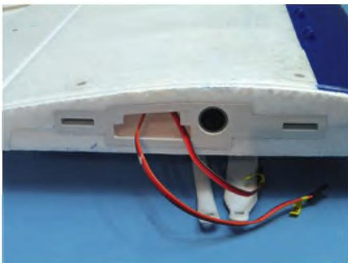
Die Tragflächenwurzel im Lieferzustand. Zum Verstauen der Servokabel bei angesteckten Flächen ist eine Tasche in den Schaum eingearbeitet.
