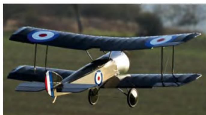
Mit weniger als Halbgas erreicht die Pup eine angemessene Geschwindigkeit. Bei Vollast geht's mit 60 Grad nach oben.
