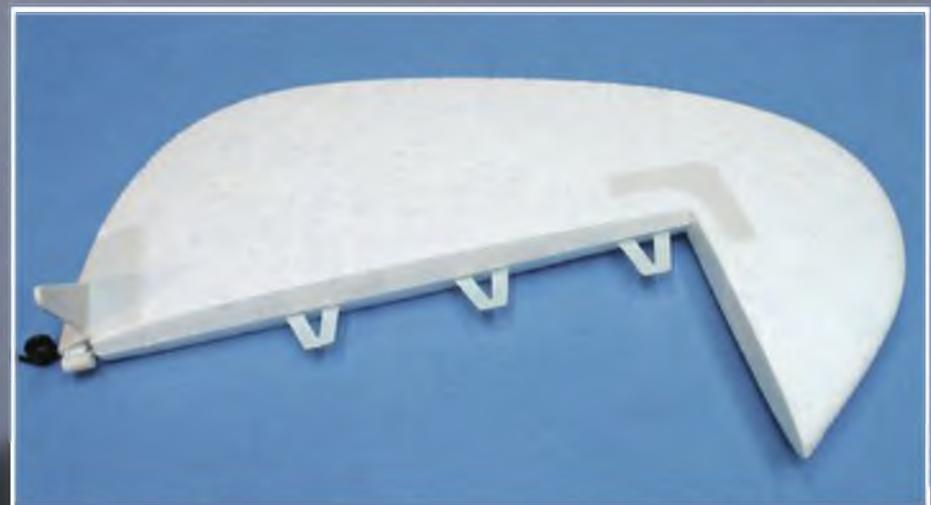
Aus Transportgründen ist das Seitenruder noch nicht angeschlagen, geklebt wurde beim Testmodell mit UHU-Por (nass, nicht ablüften lassen).
