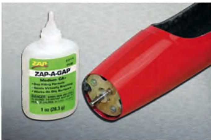
Der Motorspant wurde mit Sekundenkleber eingepasst und dann mit Epoxy verklebt.
