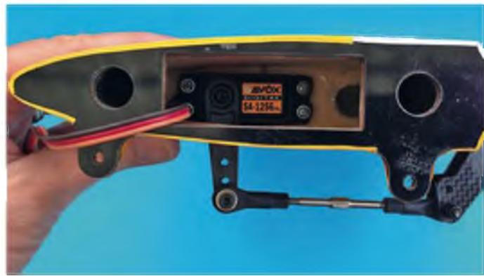
Die Höhenruderservos sind liegend eingebaut. Die Schubstangen sind fertig abgelängt und mit Rechts-/Linksgewinde versehen. Über die Schlüsselfläche kann die Länge verstellt werden.
