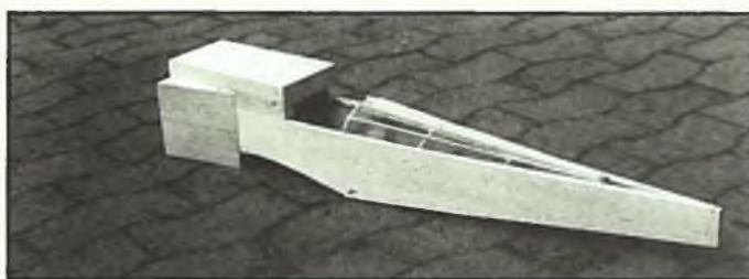
Rohbaufotos. Dem Doppeldecker liegt eine recht einfache Holzkonstruktion zu Grunde
