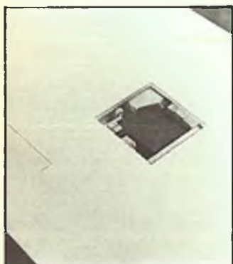
Nicht ganz einfach im Bau, aber schön: Innenanlenkung der Querruder. Nach dem Aufsetzen der Abdeckung des Servoschachtes sieht man nichts mehr
