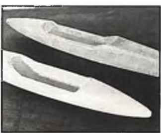
Zwei GfK-Rümpfe für F3B, hinten einer mit Glas und Epoxid hergestellt, vorn ein Rumpf, der mit Glasgewebe und Weißbleim laminiert wurde
