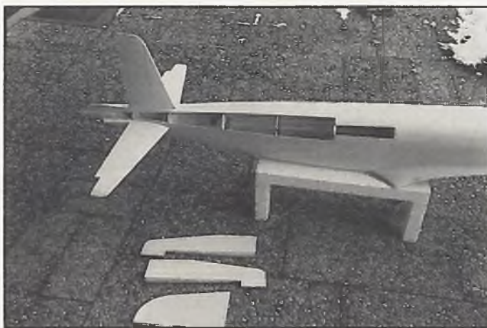
Aus der Bauzeit. Der Rumpf ist noch nicht ganz verschlossen, damit das Rudergestänge angepaßt werden kann. Die Schubstangen sind in diesem Stadium erst nur bis zum Mittellager montiert. Erst wenn die Ruder befestigt sind, kann das Gestänge vervollständigt werden.
