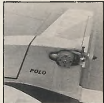
Vorteilhaft ein Heckauslaßmotor, dessen Schalldämpfer im Rumpf untergebracht werden kann
