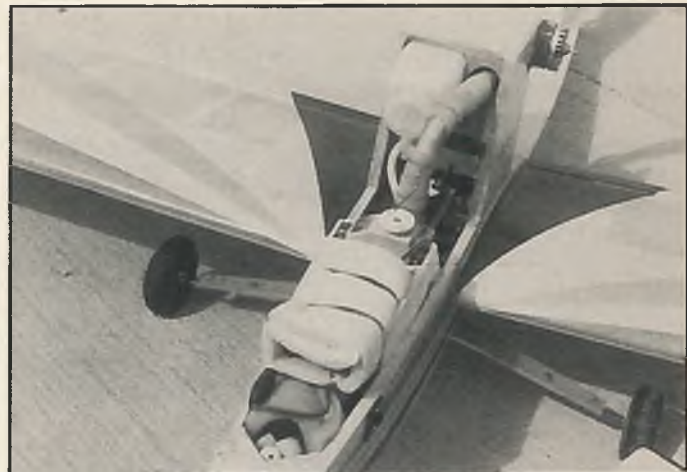
Für den Piloten ist kein Platz mehr übrig. Viel Raum beansprucht al- lerdings die Schalldämpferanlage: Vom Motor werden die Abgase über einen Krümmer in den eigentlichen Dämpfer geleitet, dessen Auslaß aus dem Rumpfboden herausführt
