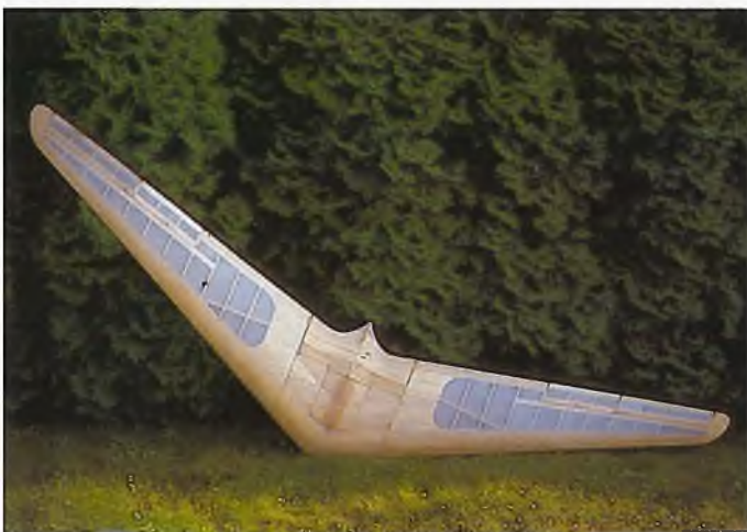
Verjüngter, gefeilter Flügel, weiche Rundungen zeichnen die typischen Nurflügel des Horten-Typs aus
