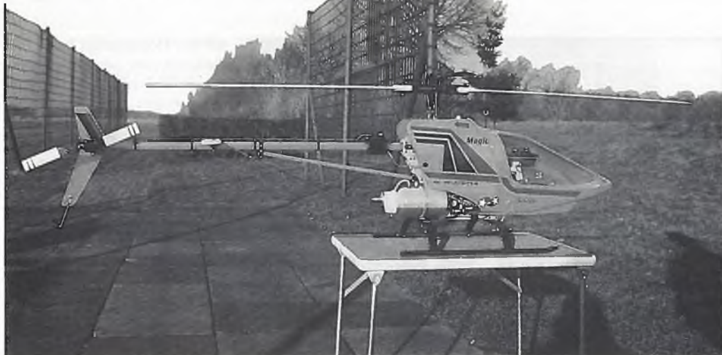
Ein Trainer-Hubschrauber soll eine offene, leicht zugängliche Mechanik haben und z. B. den Tank im Fluge leicht einsehen lassen. Die Magic von Schlüter hat alles, und sieht dazu auch noch gut aus
