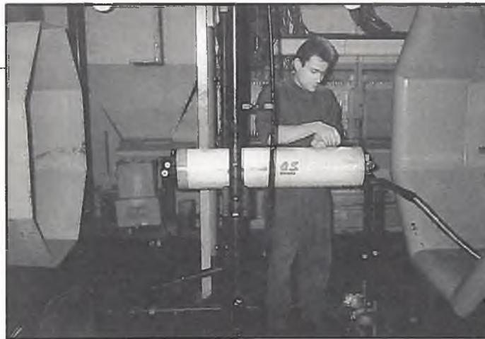
Die Triebwerksgondel in der Freistrahlmessstrecke des Windkanales. Rechts neben der Gondel erkennt man die Abgasabsaugung.
