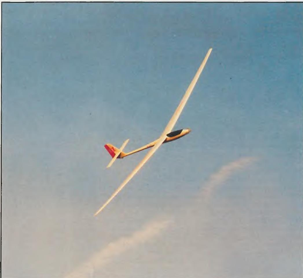
**Kunstflug ist mit den Aufsteckohren und einer Spannweite von 4400 mm durchaus möglich. Allerdings biegen sich die Flächen merkbar durch.**
