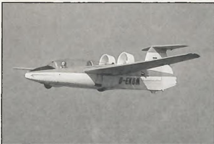
**... und heute, als Erprobungsträger für einen 2-Fan-Antrieb. Das Flugzeug, von Hanno Fischer noch heute geflogen, ist durch die Manteltriebwerksanordnung sehr leise, zumal der Tragflügel den Lärm nach unten abschirmt. Die Montage der Mantelpropeller direkt auf der Flügeloberfläche verbessert den Wirkungsgrad (Grenzschichtabsaugung).**
