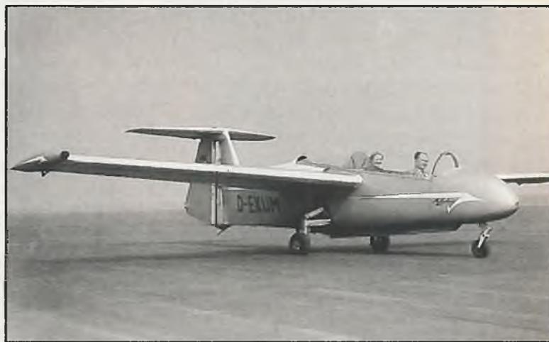
**Das Allroundflugzeug: Mit 15 m Flügel ein Motorsegler für "Lustfliegen" und Prüfungsflüge, nach Abnahme der Außenflügel dann ein schneller, kunstflugtauglicher Reisendoppelsitzer. Fast unglaublich der Preis, den der Hersteller für die serienfertigen Maschinen veranschlagte: 16.000,- DM für den Motorsegler, 18.000 DM für die stärker motorisierte Reisemaschine! In den fünfziger Jahren sahen aber nicht nur die Preise, sondern auch die Löhne anders aus als heute**
