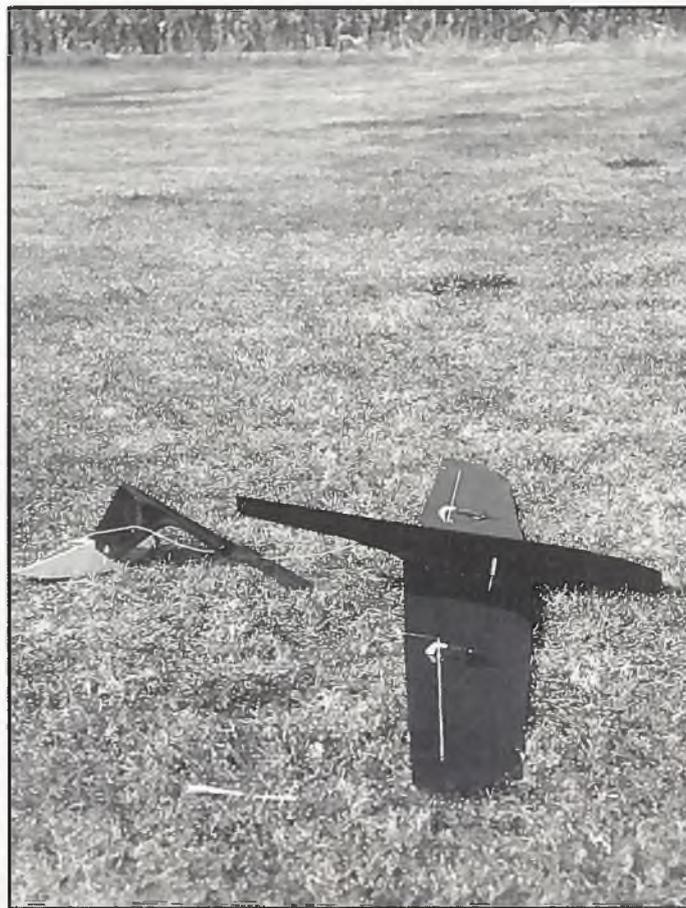
Drei hart arbeitende Servos im Landeanflug dieses Hot-Liners (QR-Bremse, QR-Lageausrichtung und Höhenruder) zwangen offensichtlich den Empfängerakku in die Knie und das Modell unsanft auf die Erde.
