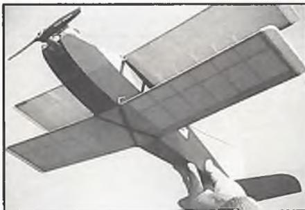
Am Schwerpunkt kann man den Funny beim Handstart leider nicht halten. Für die ersten Flüge sollte man einen Helfer zum Abwerfen des Modells haben. Mit der stärkeren Motorvariante geht das Modell sofort nach der Freigabe in einen flotten Steigflug über. Ein kleiner Schubs genügt.
