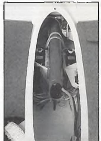
Blick in das Innere des Rumpfes. Der 20-Zellen-Akku ist auf einer Sperrholzrutsche befestigt, links und rechts daneben bedrinnen sich Höhen- und Seitenruderservo, Empfänger und Flugregler. Das Störklappenservo ist auf einer Sperrholzhalterung unter dem Drucksteg etwas versteckt angeordnet.
