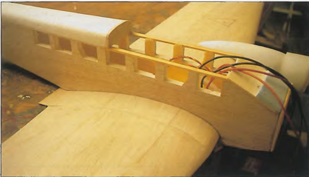
Beim getesteten Bausatz war noch kein Akkuschacht vorgesehen, daher mußte hier ein wenig improvisiert werden; der Hersteller will künftige Serienmodelle aber damit ausrüsten
