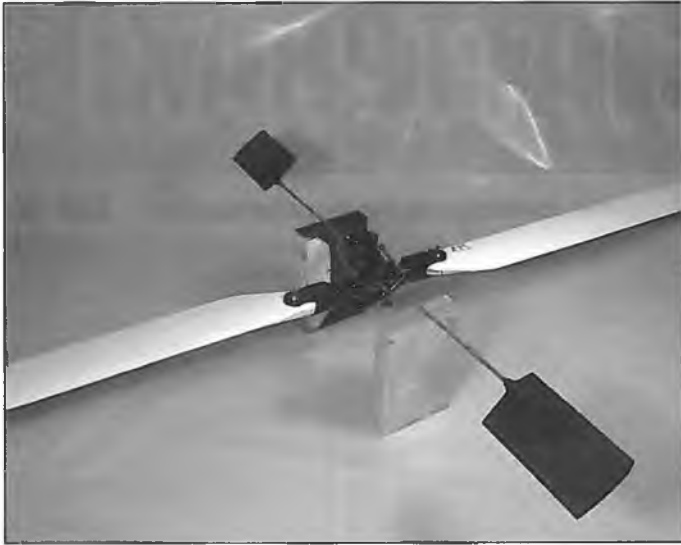
Zum Auswuchten des Hauptrotors wird dieser an der Stabilisierungsstange pendelnd aufgebockt. Er ist richtig ausgewuchtet, wenn er waagrecht hängen bleibt. Die einfachste Art des Wuchtens, aber vollauf genügend
