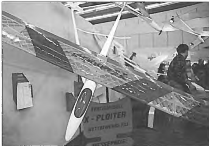
Die Freiflieger kriegen glänzende Augen, und Jupp Wimmer auch, der die geodätische Bauweise in seinem Artikel in diesem Heft auf Seite 61 beschreibt. Das, was als die hohe Kunst des Rippenflügelmodellbaus gilt, kann man auch fertiggebaut erwerben. X-Plotter heißt der F3J-Segler von X-models aus Duedlingen in Luxemburg. 898,- DM ist sicherlich nicht viel Geld für soviel Arbeit
