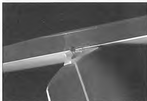
Anlenkung des Höhenleitwerks. Der Stahldraht wurde nur durch das selbsthergestellte Ruderhorn gesteckt. So kann das Leitwerk schnell demontiert werden
