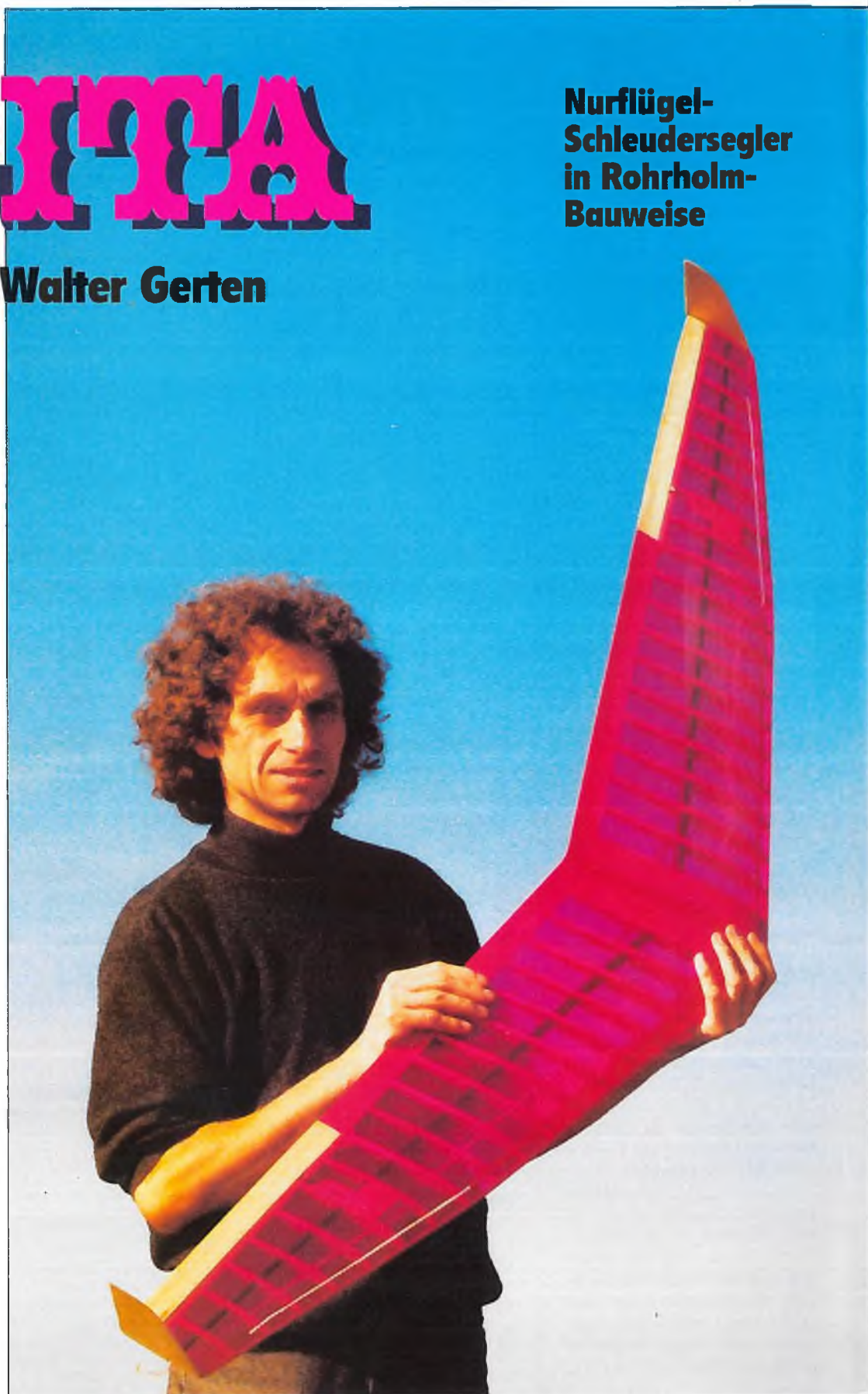
Der Mini-Nurflügel mit Folienbespannung; bei dieser Oberfläche ist ein Zackenband-Turbulator sehr zu empfehlen; auf der Flügeloberseite geht der Turbulator, anders als im Bild, über die ganze Spannweite, unten ist er nur im Ruderbereich
