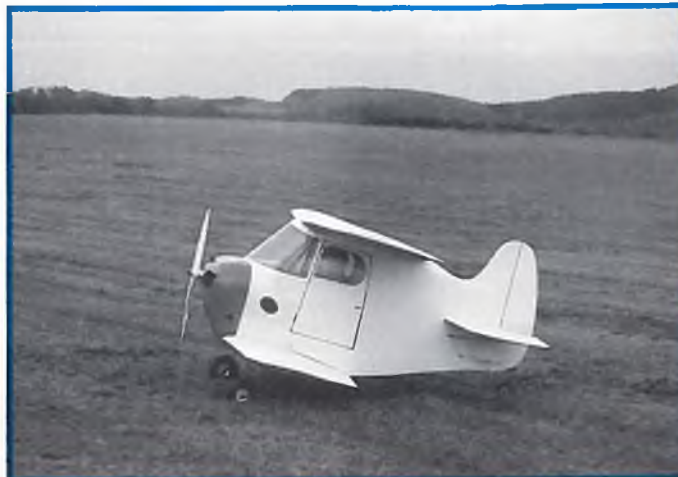
Die Tür ist einfach mit einem Edding aufgemalt, ebenso der obere Seitenruder-spalt und die Landeklappen
