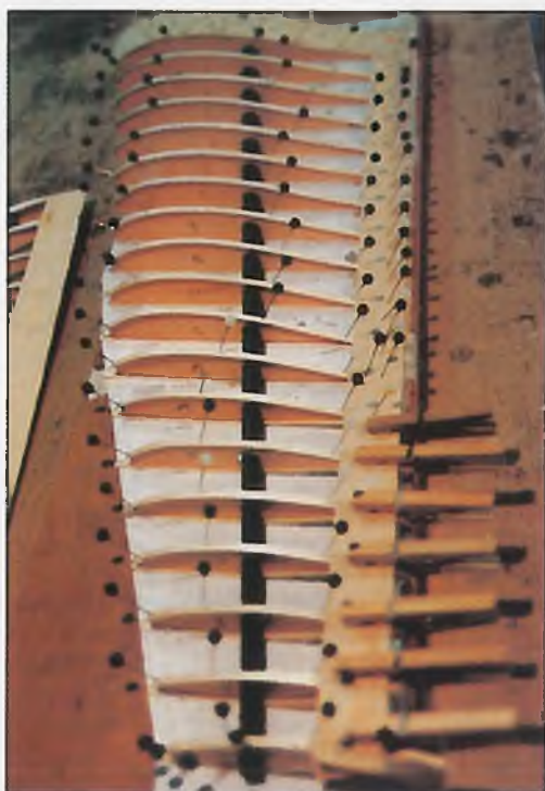
Die oberen Rippenaufleimer und Endleisten werden angebracht
