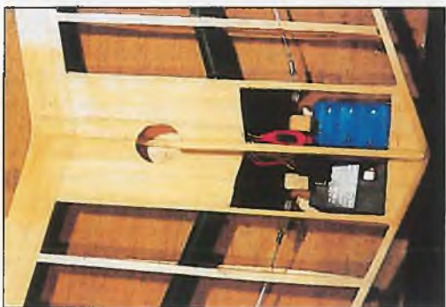
Hier heißt es, mit dem Platz zu sparen. Kleinste RC-Komponenten sind notwendig, dafür kommt man aber ohne Bleiballast aus
