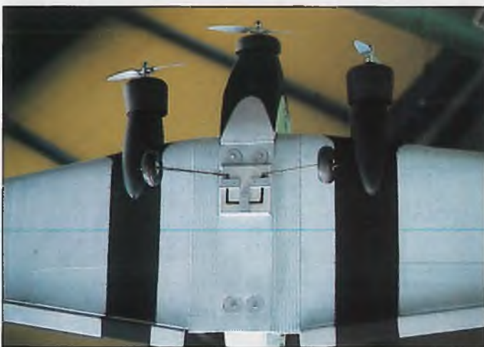
Beim getesteten Bausatz war noch kein Akkuschacht vorgesehen, daher mußte hier ein wenig improvisiert werden; der Hersteller will künftige Serienmodelle aber damit ausrüsten
