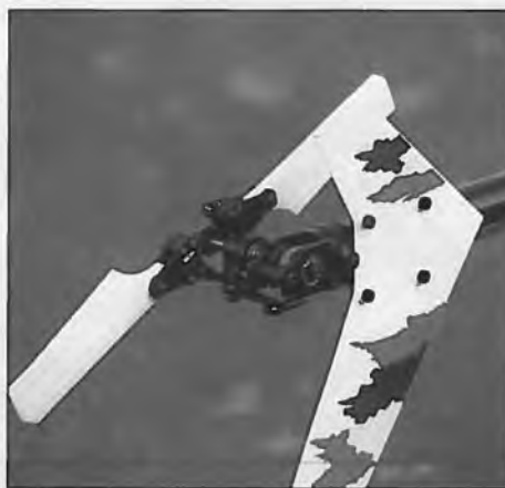
Das vordere Heckrotorblatt läuft von unten nach oben, die Anlenkung ist vorne, bezogen auf das Blatt
