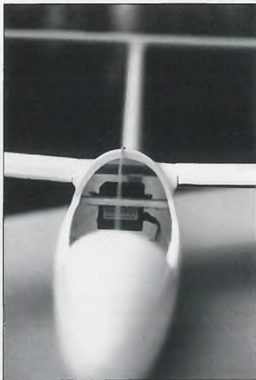
Etwas versteckt im Rumpf befindet sich das Querruderservo. Die Bowdenzüge werden lediglich in ein 0,5-mm-Loch gesteckt. So ist auch hier eine schnelle Montage der Tragflächen gewährleistet.
