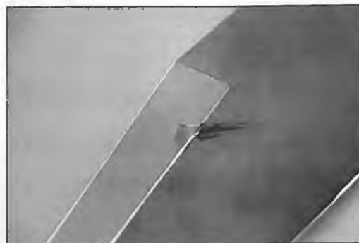
Die Querruder erhielten auch selbstgebaute Ruderhörner. Die Bowdenzugröhrchen mußten noch etwas aus der Fläche herausgearbeitet werden.
