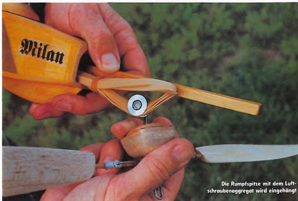
„Tanken“: Das Rumpffende ist in einer Gabel eingehängt, der Gummimotor wird mit einer Handbohrmaschine aufgezogen
