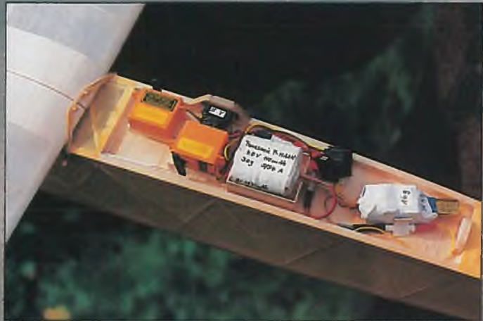
Die Empfangsanlage auf dem Rumpf: Skyline-Empfänger, 2 Becker-Servos, 110 mA-Akku und E/A-Schalter. Die in letzter Zeit schneller voranschreitende Miniaturisierung von RC-Komponenten wird das Gewicht des „RC-Ballastes“ noch weiter verringern
