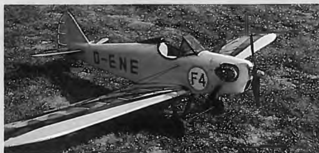
MT-1009 ist die Nummer des Bauplans für das kleine Fly Baby mit 1380 mm Spannweite (außerdem haben wir als MT-989 noch eine Version als Großmodell mit 2,8 m Spw.). Das hier beschriebene „Kleinbaby“ ist handlich, wendig und nicht ganz leicht zu bauen
