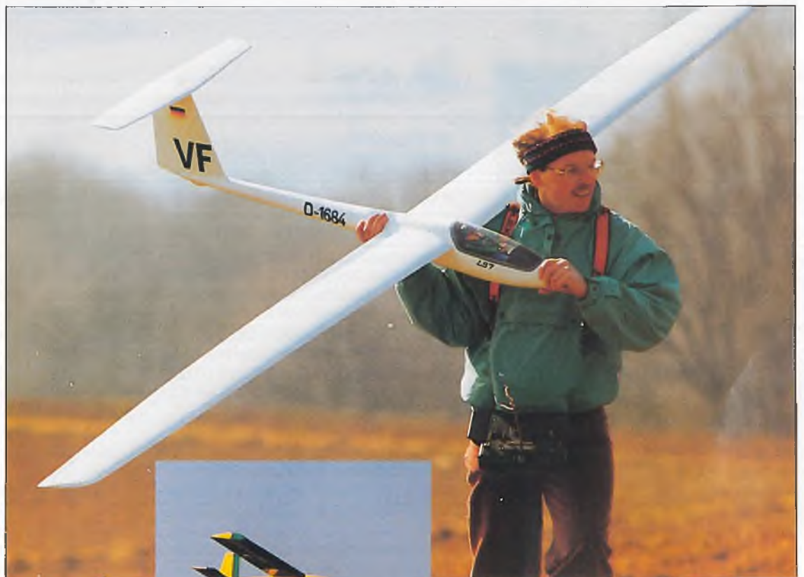
Multiplex hat mit dem zwar nicht neuen, dafür aber bestens bewährten „Le Traktor“ (kleines Bild) seine Neuheiten viele Male in den Himmel befördert. Dazu zählte auch die neue LS 7. (Spannweite 330 cm, Profil HQ-3,5/12 mod., Gewicht ca. 3 kg)
