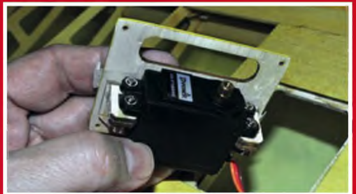
Die Servohalterung muss noch etwas nachgearbeitet werden, damit die Derkum-Servos sauber passen.
