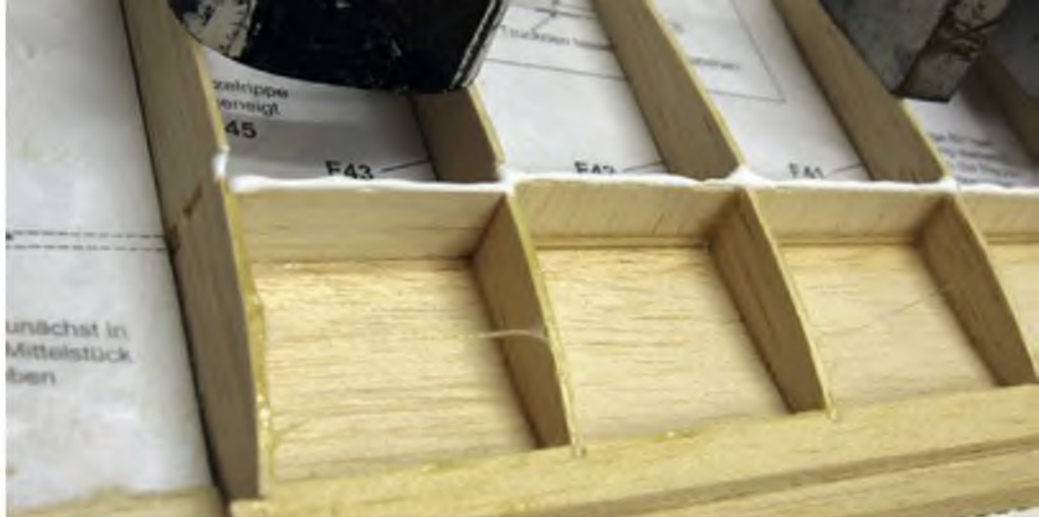
Die Verklebung der Holmleiste zu Rippen und Holmsteg erfolgt mit Weißleim oder dickem Sekundärkleber.
