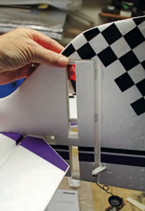
Geht ruck-zuck: zuerst das Höhenleitwerk eingeschoben, danach das Seitenleitwerk. Ruder und Heckfahrwerk sind ab Werk schon montiert.
