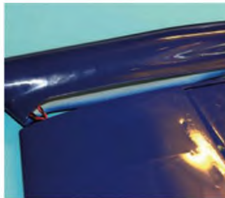
Die beiden tiefgezogenen Tiptanks werden nur an den Randbogen verklebt, wofür sich Uhu por sehr gut eignet.
