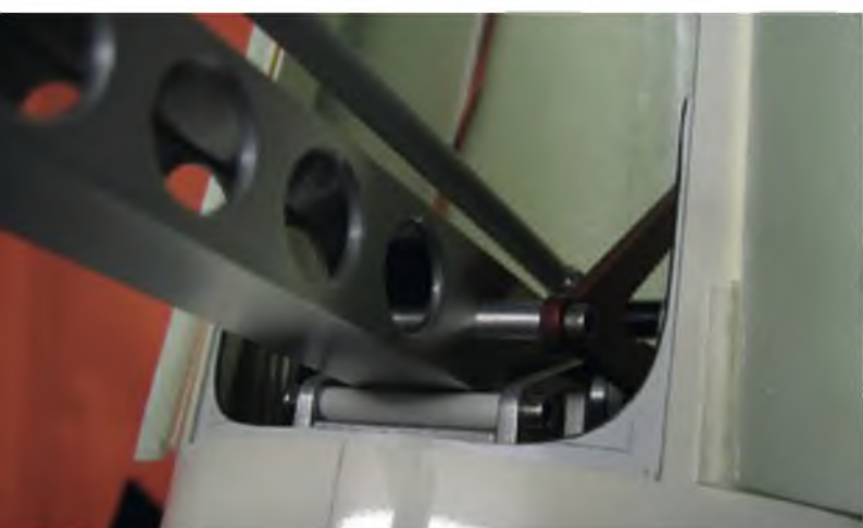
Der Triebwerksarm des K15 drückt in der ausgefahrenen Position gegen diese Querstrebe.
