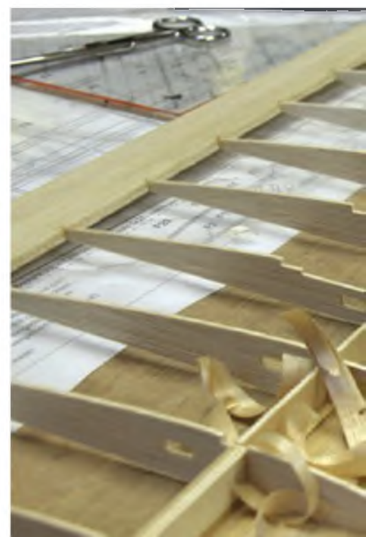
Gewichte halten das Flügelgerüst auf dem Baubrett, bis der Leim trocken ist. Die Holmstege sitzen mittig auf der Holmleiste.
