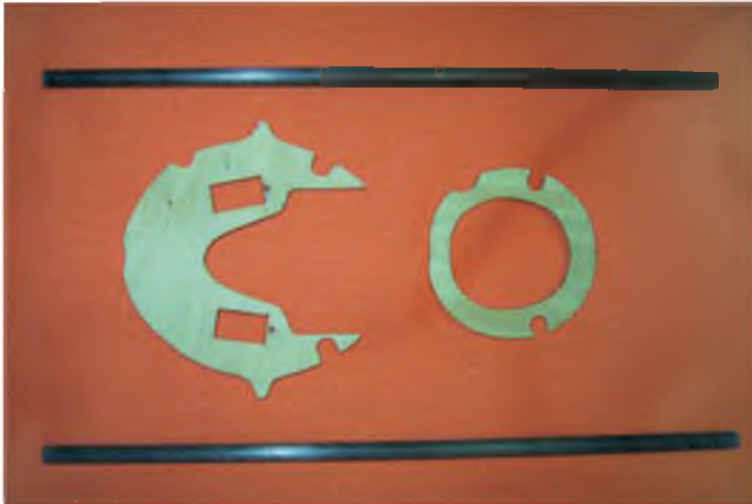
Verstärkungselemente für den Rumpf: Der mittlere V-förmige Spant ersetzt die originale Strebe an der Flügelhinterkante, die für die Klapptriebwerksmechanik entfernt werden musste. Die beiden dünnwandigen Kohlerohre dienen der Längsversteifung.
