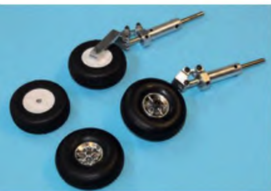
Die serienmäßigen 55-mm-Räder wurden gegen 60-mm-Lufträder von Kavan ausgetauscht.
