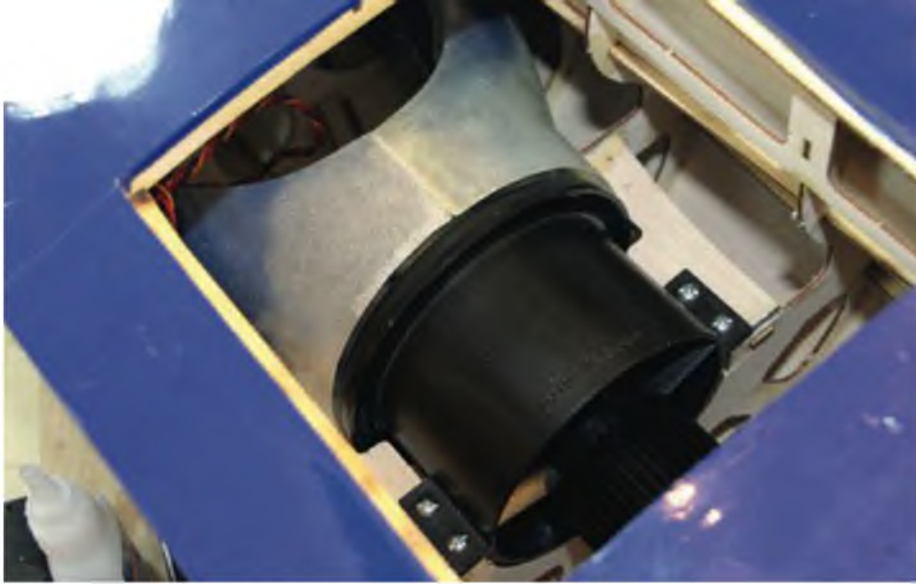
Der Impeller wird mit Einlauftring montiert, da der Luftkanal größer als der Impellerdurchmesser ist.
