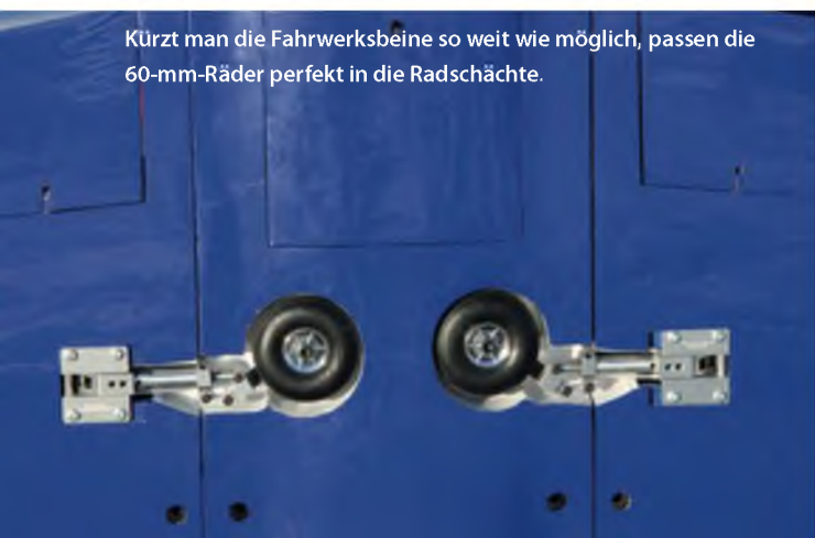
Die serienmäßigen 55-mm-Räder wurden gegen 60-mm-Lufträder von Kavan ausgetauscht.
