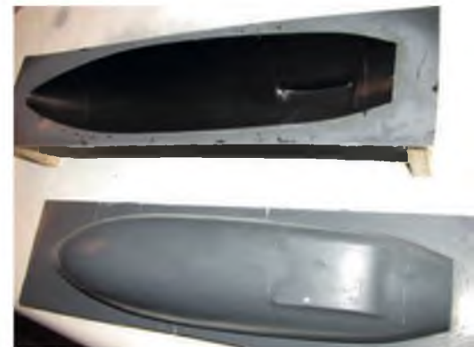
Bild 8: Das Positiv und die Negativ-Form der Unterschale.
