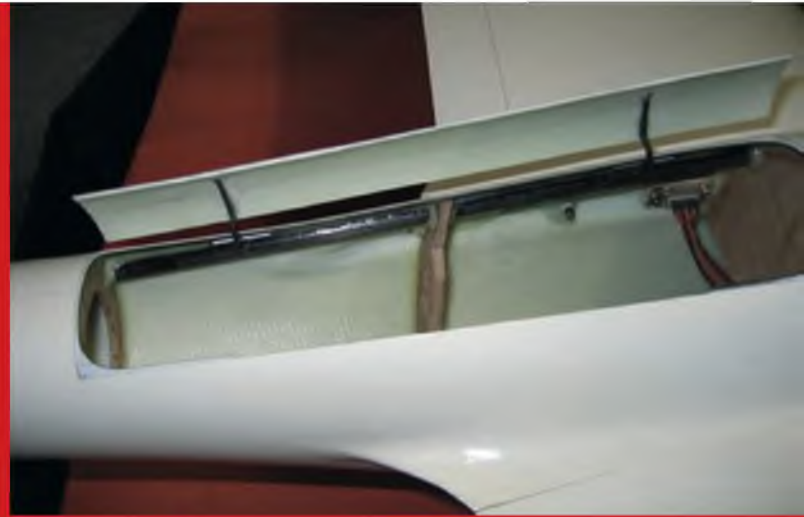
Hier sind alle Verstärkungselemente mit der Rumpfwand verharzt, die linke Schachtklappe ist bereits anscharniert.
