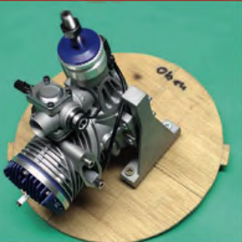
Der Dummy-Spant: Die Anschraubpunkte des Motorträgers entsprechen in der Lage exakt jenen des Original-Spants. Sturz und Seitenzug wurden durch Unterlegen mit Scheiben unter den Motorträger nachgestellt.
