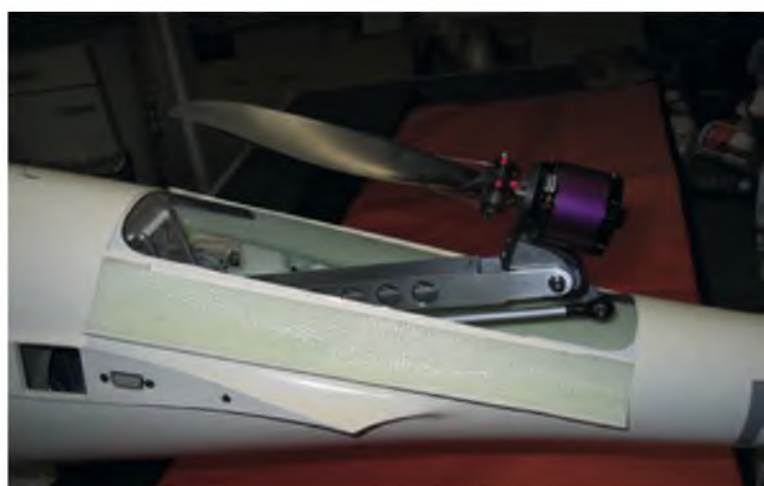
Erster Test im fertigen Rumpfausschnitt: Die Öffnung passt, das Triebwerk schwenkt ungehindert ein und aus, die Klappen schließen vollständig.
