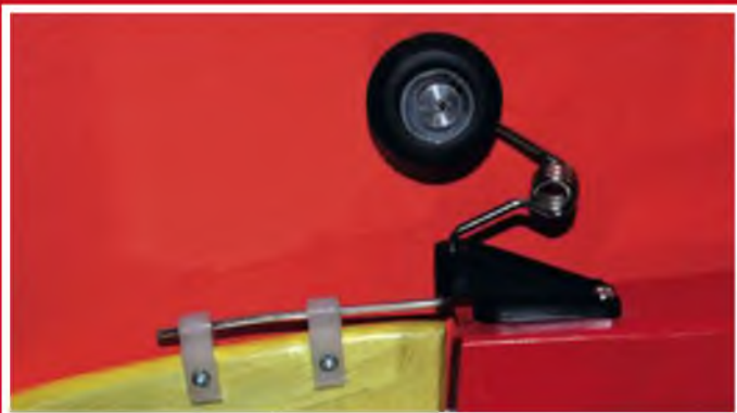
Das Spornrad wird so befestigt. Am Ende die Schrauben noch etwas abschleifen, damit man sich daran nicht verletzt.
