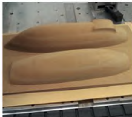
Bild 6: Die Rohlinge der Gondeln wurden mit 1 mm Untermaß gefräst.
