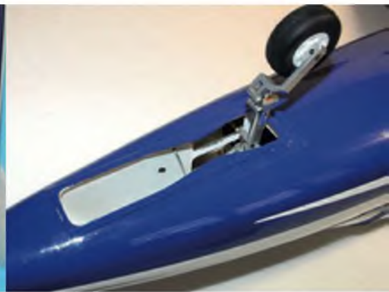
Zwei Keile sorgen dafür, dass trotz des 105°-Ausfahrwinkels das Bugfahrwerk im 90°-Winkel zum Rumpf steht. Der Fahrwerksschacht wird nach dem Einbau der Mechanik mit einer Abdeckung verschlossen.
