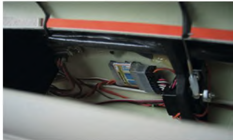
Die JK-Steuerung von SM-Modellbau fand ihren Platz an der seitlichen Rumpfwand im Schacht.
