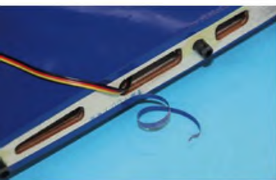
Vor dem verkleben des Seitenleitwerks, ist die Folie so weit wie möglich zu entfernen.
