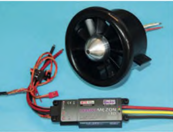
Die Antriebseinheit: WeMoTec Midi Fan evo mit Motor HET 650-68-1340 und dem Regler Hacker Master MEZON 130. Der Midi Fan evo ist fertig montiert und dynamisch gewuchtet. Bei 10s ist ein HV tauglicher Regler nötig, der mindestens 100 A, besser aber etwas mehr verträgt.
