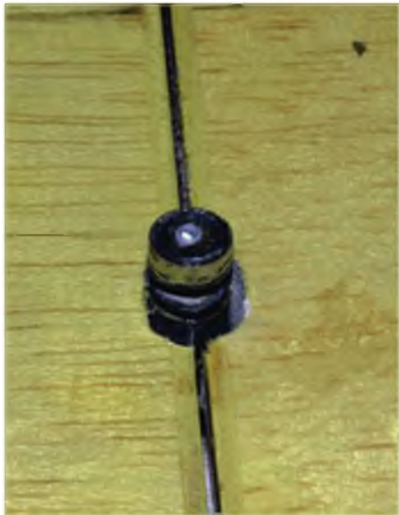
Eine einfache selbst gemachte Schleppkuppelung sitzt genau zwischen den Flächen.
