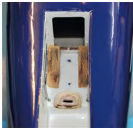
Zwei Keile sorgen dafür, dass trotz des 105°-Ausfahrwinkels das Bugfahrwerk im 90°-Winkel zum Rumpf steht. Der Fahrwerksschacht wird nach dem Einbau der Mechanik mit einer Abdeckung verschlossen.
