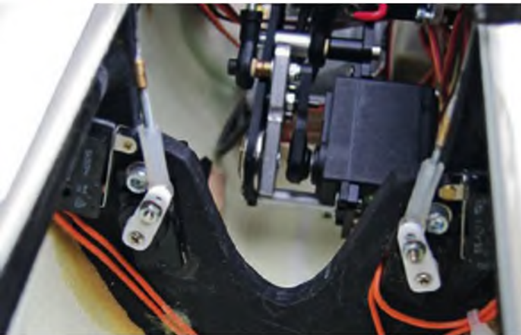
Der mittlere Spant trägt die Servos für die Klappenbetätigung; die Gestänge betätigen bei voller Schachtklappen-Öffnung die zugehörigen Endschalter.
