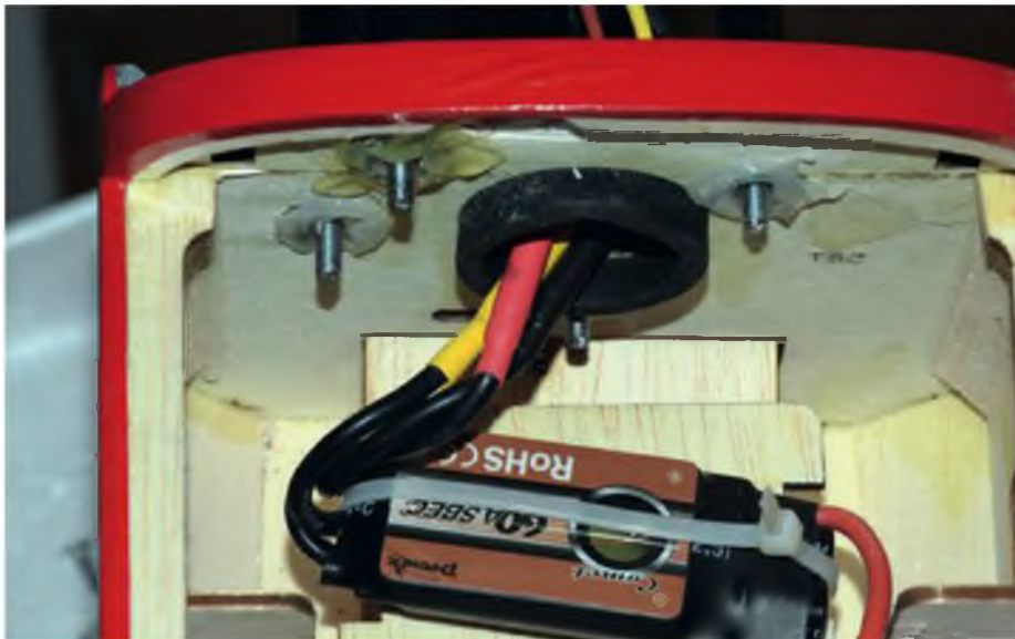
Der Regler sitzt direkt hinter dem Kopfspannt, dann reichen die Kabel bis zum Akku.
