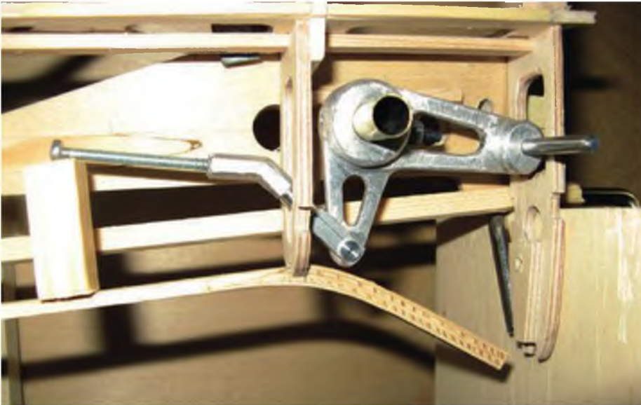
Pendelhebel beim Höhenleitwerk der „Wien“. Die lange Schraube wird später zur Schubstange.
