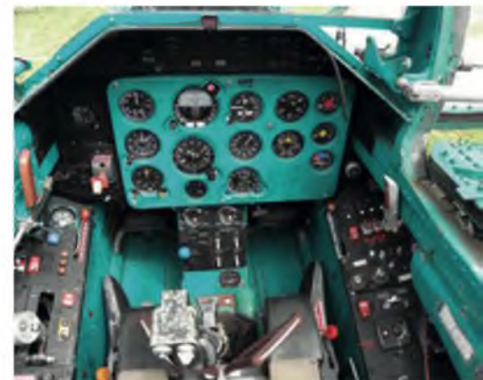
... hintere Cockpit ist als gemeinsame Druckkabine ausgelegt. Der hintere Sitz ist etwa 15 cm höher angeordnet.
