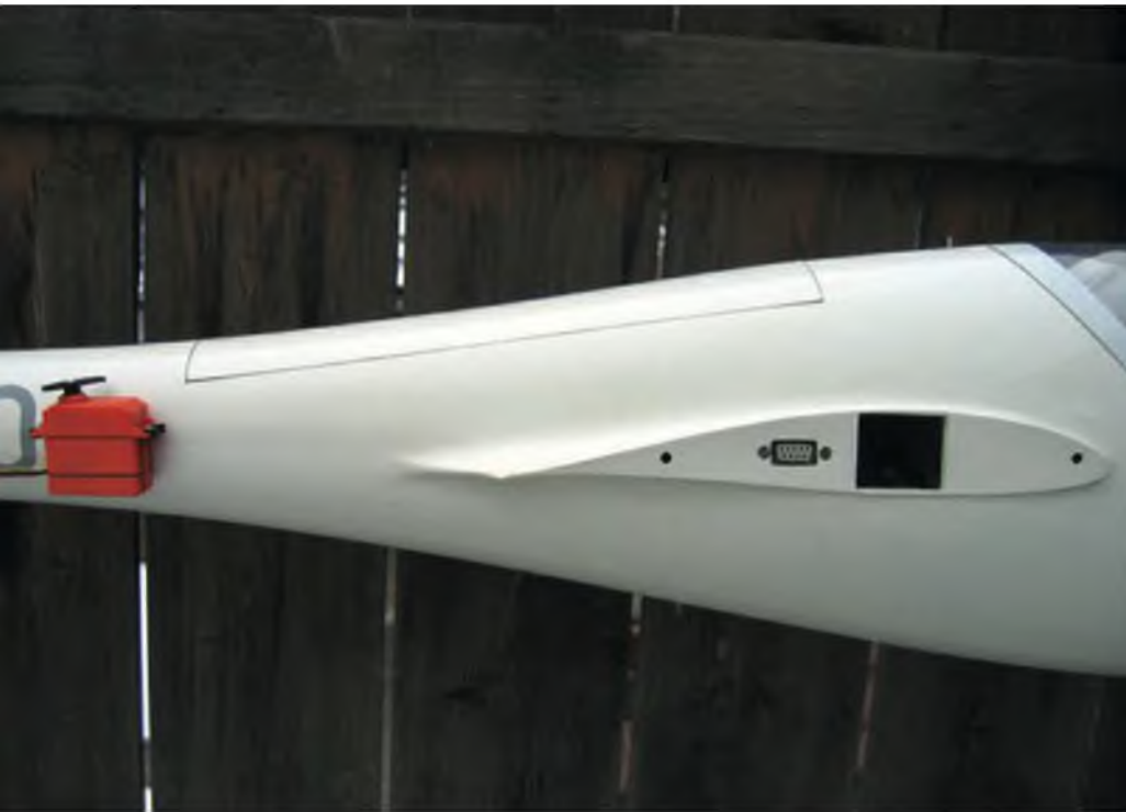
In dieser Rumpfkontur musste die eigenstarttaugliche Lösung untergebracht werden. Das gezeigte Standard-Servo dient dem Größenvergleich.
