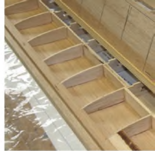
Die obere Beplankung wird mit Kontaktkleber aufgezogen; den Kleber streiche ich nur auf die tatsächlichen Kontaktflächen.
