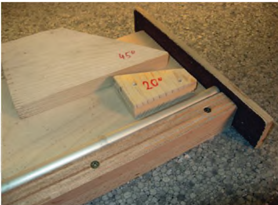
So einfach kann man Rohre, Leisten und Kleinteile in verschiedenen Winkeln genau abschleifen.
