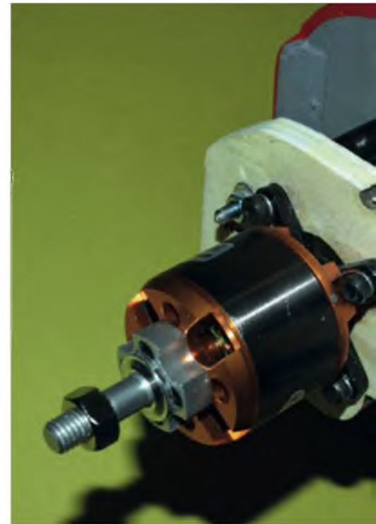
Die von Derkum empfohlene Motorisierung mit dem D-Power AL 42-6 und einem Comet 60A-Regler ist für kraftvolles Fliegen und einfache Schleppaufgaben ausreichend.
