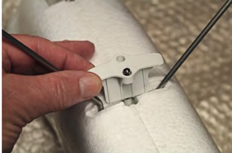
Auch das geht fix: Fahrwerksbügel einstecken und mit Gegenhalter befestigen. Zur gesamten Montage ist kein Klebstoff erforderlich.
