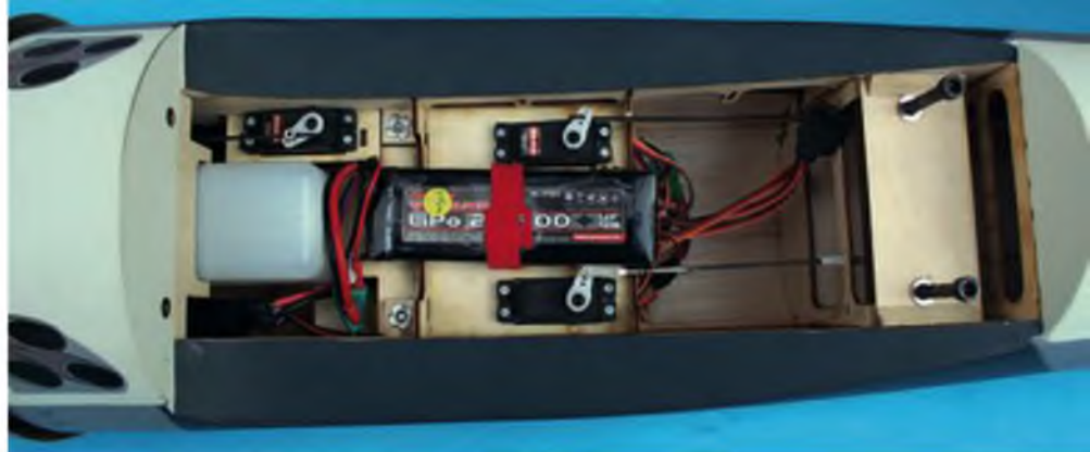
Auf der Unterseite des Anlagenbrettes sind die Servos montiert und der Akku zur RC-Versorgung untergebracht.
