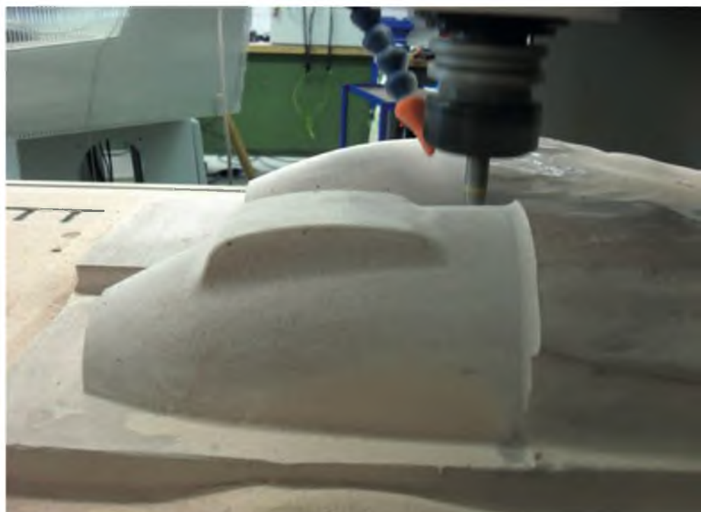
Bild 7: Der Schlichtvorgang der Außenschicht schließt die maschinelle Bearbeitung ab.
