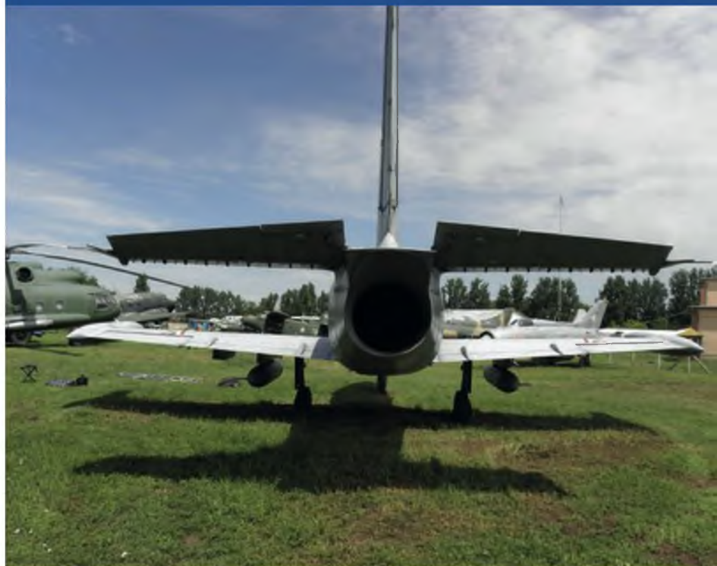
Das freitragende Leitwerk ist auch komplett in Metall gehalten. Das Höhenleitwerk hat wie der Flügel keine Pfeilung.
