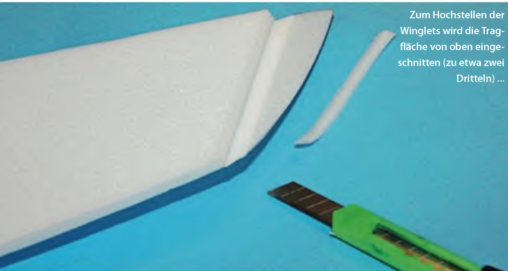
... dann werden die Kanten angeschrägt, so dass sich die Winglets im Winkel von etwa 45° aufrichten lassen.
