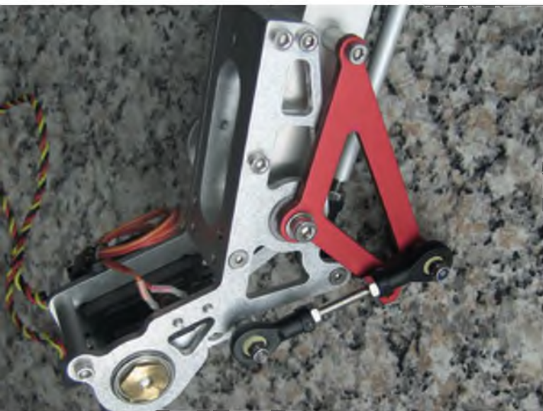
Das K15-Triebwerk von JK in der Version „B“, mit nach schräg vorn/unten zeigendem Betätigungsservo, in der ausgefahrenen Stellung...
