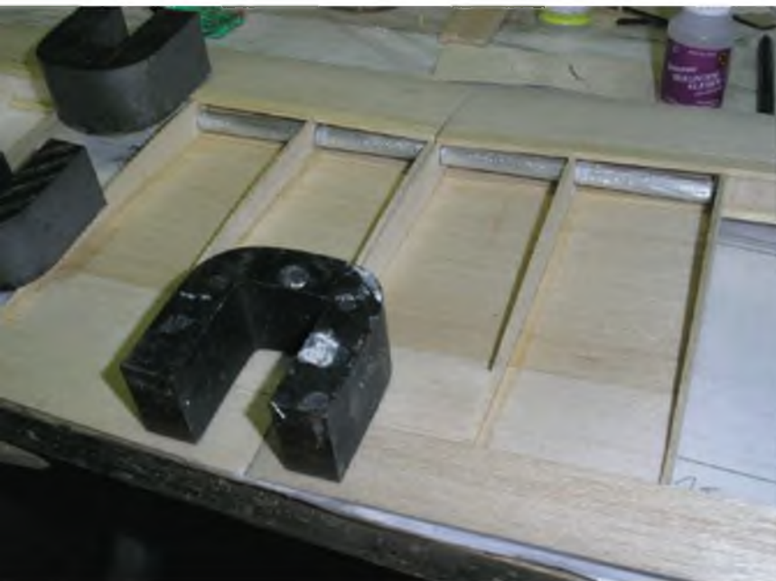
Aufziehen der Nasenbeplankung: Die Nasenleiste ist passend unterlegt, der Holm wird mit Gewichten gut angepresst. Erst wenn der Holm fest ist, drückt man die Beplankung auf die Rippen nieder (Kontaktklebung eventuell leicht anbügeln).
