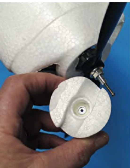
Massiv „in Eisen gelegt“: der kräftige Brushless-Motor ist sehr stabil im Rumpf montiert.
