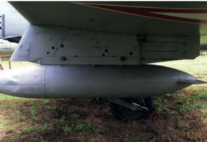
Die Version L-39ZO ist ein Waffeneinsatztrainer, der vier Unterflügelstationen für 2 × 500 kg und 2 × 250 kg bietet (Bomben, Raketen, Zusatzbehälter). Das gezeigte Exemplar trägt einen Zusatztank.
