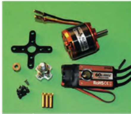
Die von Derkum empfohlene Motorisierung mit dem D-Power AL 42-6 und einem Comet 60A-Regler ist für kraftvolles Fliegen und einfache Schleppaufgaben ausreichend.
