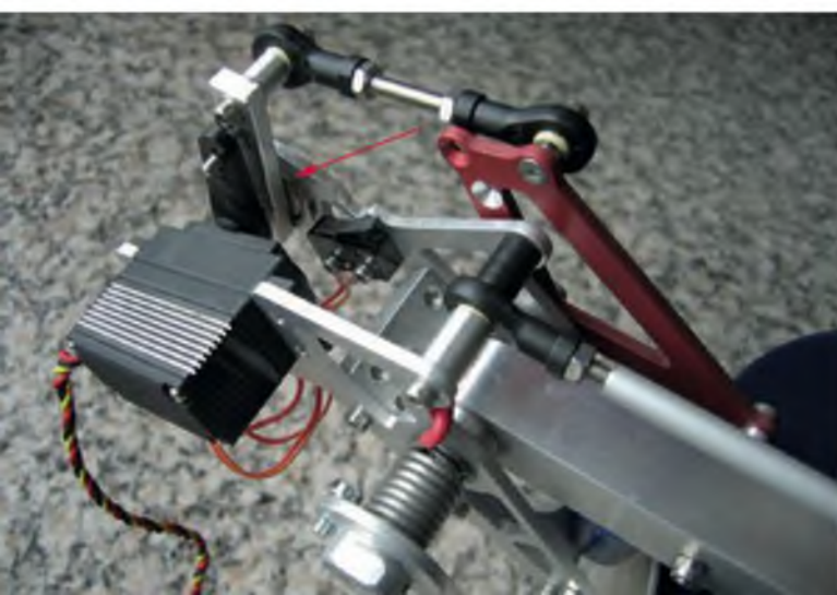
Das K15-Triebwerk von JK in der Version „B“, mit nach schräg vorn/unten zeigendem Betätigungsservo, in der ausgefahrenen Stellung...
