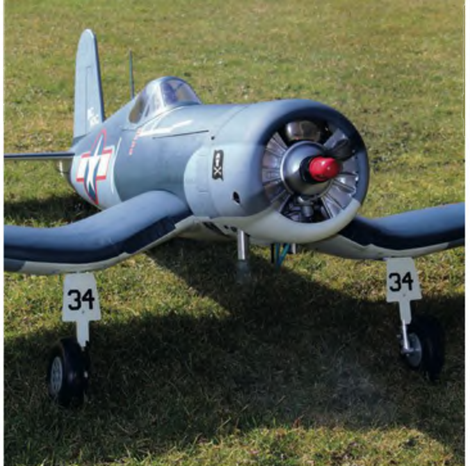
Der Sternmotorattrappe fallen wegen des Vergasers und Schalldämpfers zwei große Stücke zum Opfer. Optisch kein großer Nachteil, für einen gesunden Lufthaushalt unter der Haube aber unverzichtbar.
