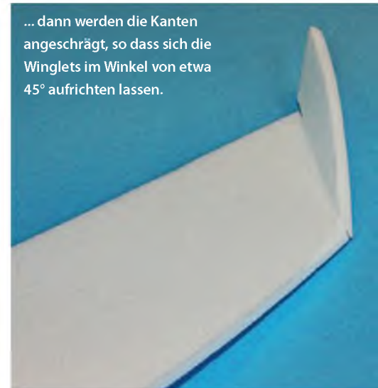
Zum Hochstellen der Winglets wird die Tragfläche von oben eingeschnitten (zu etwa zwei Dritteln) ...
