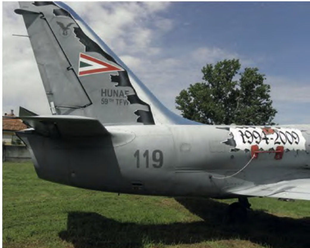
Das freitragende Leitwerk ist auch komplett in Metall gehalten. Das Höhenleitwerk hat wie der Flügel keine Pfeilung.
