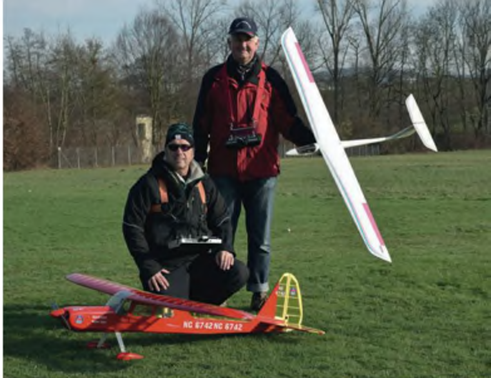
Volker Kecks kleiner und schon etwas betagter Conzelmann-Kolibri-Segler wurde mit Halbgas geschleppt! Eine Akkuladung reicht für 6 bis 8 Schlepps plus etwas Kunstflug.
