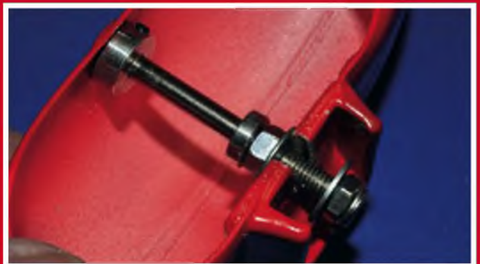
Das Befestigen der Radschuhe und Räder ist einfach und hält sehr solide. Man beachte die Anformung an den Radschuhen.
