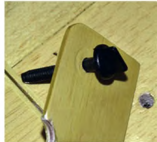
Die Fläche wird mit zwei solchen Schrauben befestigt. Da die zugehörigen Muttern gerade eingeklebt sind, schneiden sie sich etwas in die Verbindungsplatte ein. Nicht schön, aber ohne Folgen.
