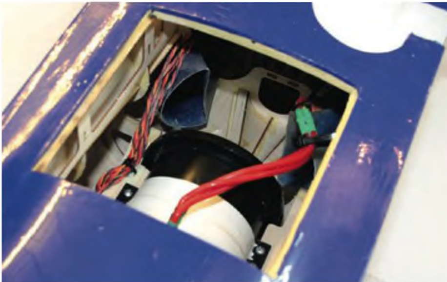
Zu Testzwecken entfernte ich den Trichter vor dem Impeller, der Schubgewinn war jedoch gering.
