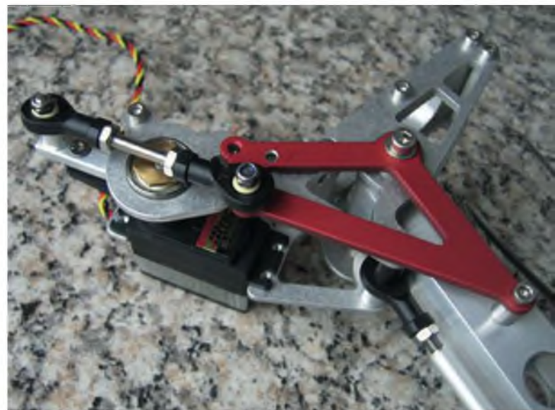
... und hier in der eingefahrenen Position. Der vom Servo angetriebene Betätigungshebel ragt weit nach vorn – zu weit für die DG-600 im Maßstab 1:3,75.
