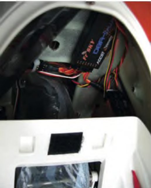
Einbauort des 8-Kanal FrSky-Telemetrie-Empfängers, der zugehörige Höhenmesser sitzt auf dem Fahrwerksservo; links ein 2s-LiFePo für die Empfangsanlage.
