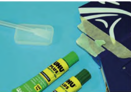
Die Zungen der GFK-Ruderhörner sind leider recht kurz geraten, weshalb sie sorgfältig verklebt werden müssen.
