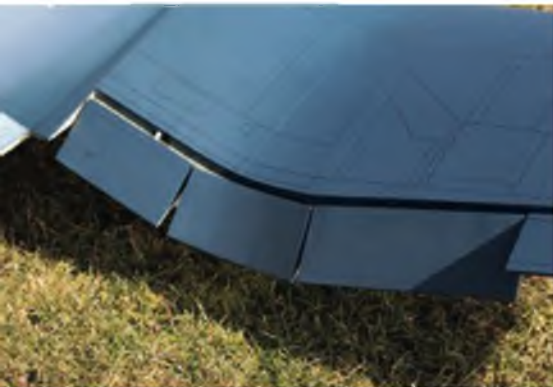
Die sind für das Bremsen zuständig. Die Klappenteile sind mit dünnen Sperrholzungen miteinander verbunden, die Anlenkung erfolgt an der innersten Klappe.
