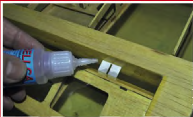
Die Ruder werden mit Vliesscharnieren befestigt.
