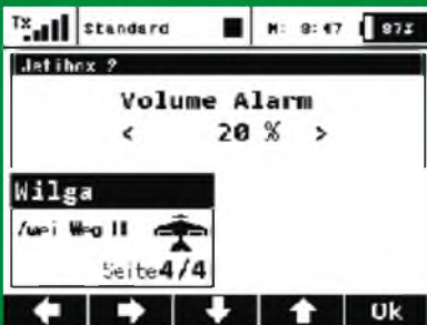
Der Tankalarm ist auf 20% Restkapazität eingestellt, in meinem Fall bei 190 ml.
