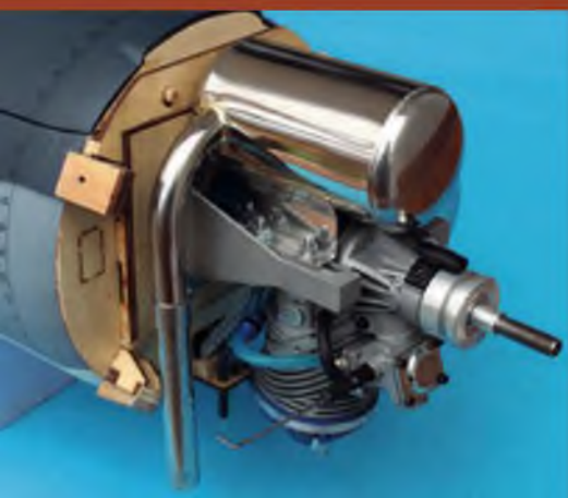
Der Schalldämpfer passt wie ein Maßanzug an den Motor. Abgestützt wird der Dämpfer durch ein Winkelblech, welches an einem Schenkel des Motorträgers verschraubt wird. Der Lochabstand entspricht dabei dem Abstand der Schraubenlöcher im Motorflansch. Das durch die Einbaulage bedingt längere Auslassrohr wird mittels einer Schelle am Motorträger abgefangen.
