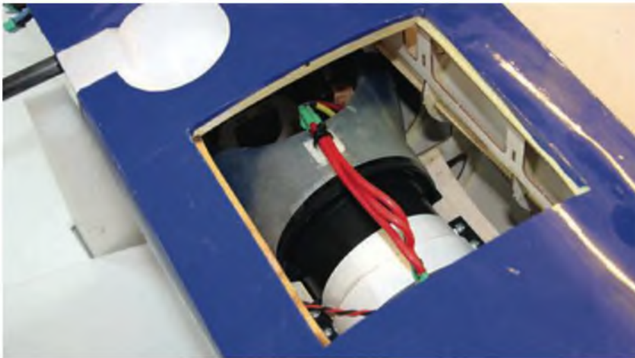
Der Impeller passt perfekt in die vorbereitete Halterung, das Schubrohr wird aufgeschoben und mit Tape gesichert.
