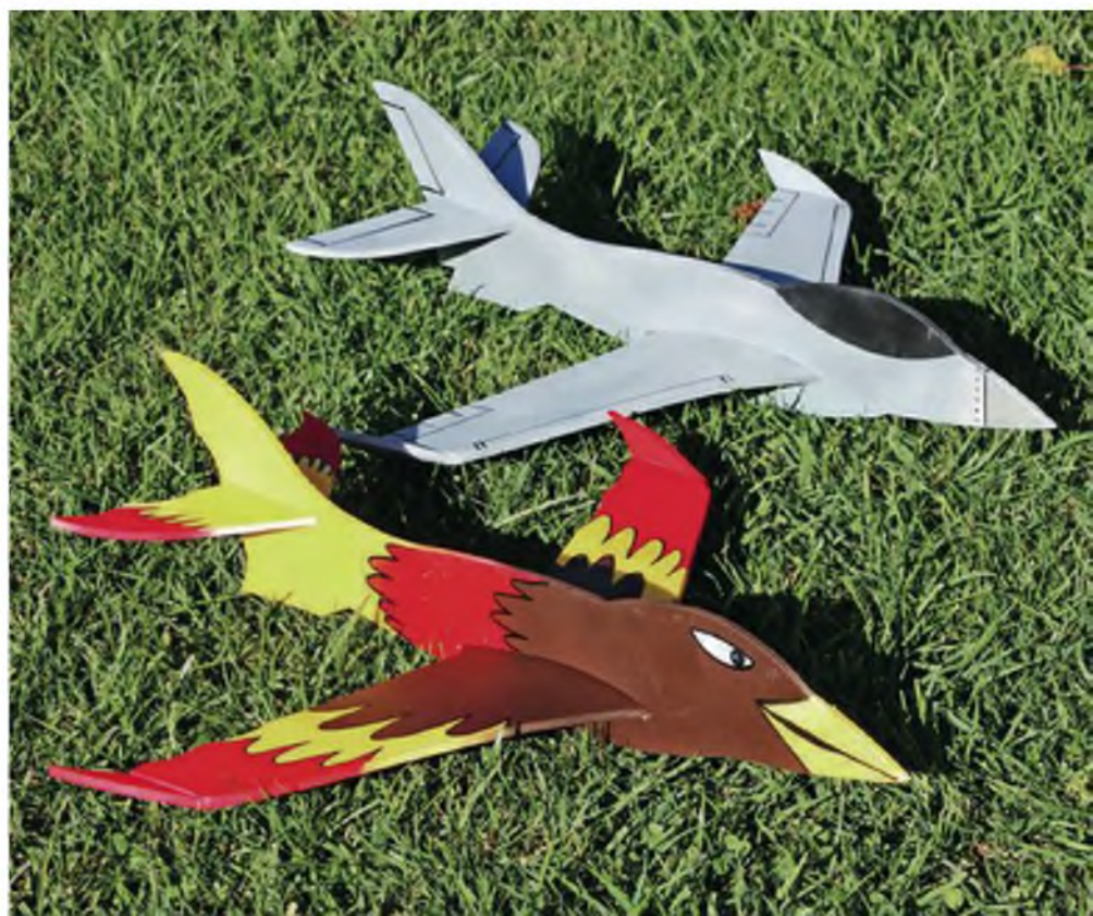
Die hängenden Flächenenden sollten von Hand vorsichtig wieder etwas nach oben gebogen werden, so dass sie wie hier ausgerichtet sind.
