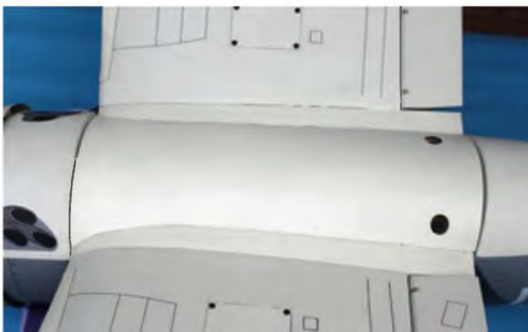
Der GFK-Rumpf-Flächenübergang könnte gern einige Millimeter länger sein – die kleinen Spalten und eine leichte Stufe fallen unter dem Knickflügel aber nicht auf.
