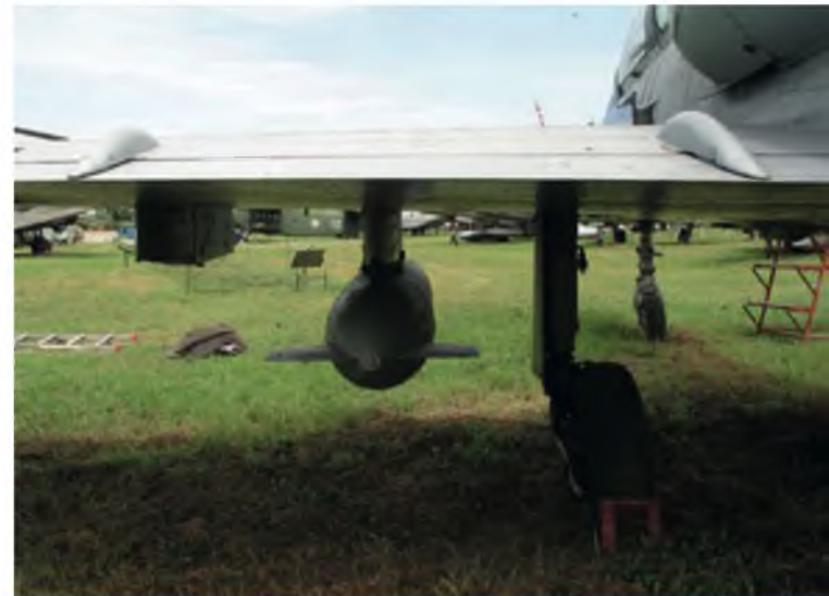
Die Version L-39ZO ist ein Waffeneinsatztrainer, der vier Unterflügelstationen für 2 × 500 kg und 2 × 250 kg bietet (Bomben, Raketen, Zusatzbehälter). Das gezeigte Exemplar trägt einen Zusatztank.
