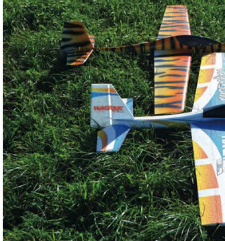
Verglichen mit dem Voll-GFK-Segler „Wasabi“ (hinten) hat der Vagabond bei gleicher Spannweite mehr Flächeninhalt und wiegt gerade mal die Hälfte.
