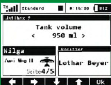
Das Tankvolumen wurde mit echten 960 ml ausgeliefert und mit 950 ml im MFlow eingestellt.
