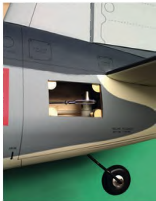
Seitenruder und Heckfahrwerk werden über eine gemeinsame Achse im Rumpf angelenkt. Das Heckfahrwerk darf gern an den Scale-Charakter des Modells angepasst werden.
