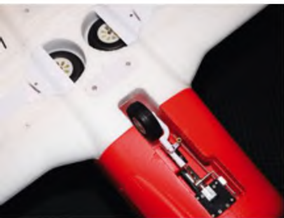
Das dreiteilige Einziehfahrwerk ist optisch und mechanisch sehr gelungen – und die Start- und Landebahn muss auch keinen Golfplatz-Rasen haben.
