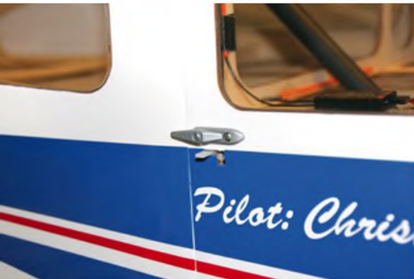
Die Tür wird von zwei Riegeln verschlossen. Um sie leichter öffnen zu können, habe ich einen Griff montiert, welcher aus einem silbern lackierten Hochstarrhaken von Graupner besteht.
