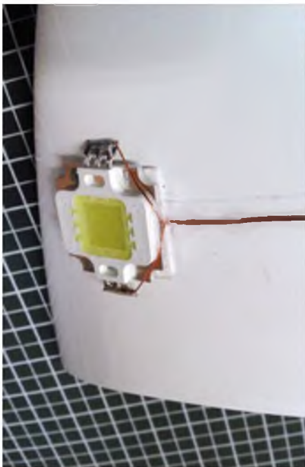
Die beiden Kupferlackdrähte verlegte ich parallel nebeneinander vom Randbogen bis zur Wurzelrippe.
