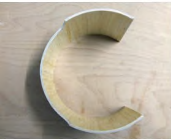
Die Motorhaube entstand aus einem gewickelten Balsa-GFK-Laminat.
