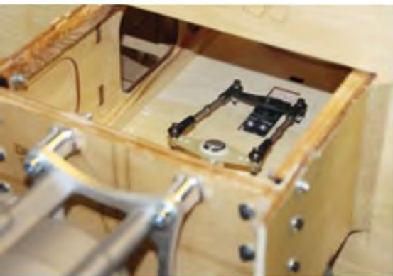
Um dem stärkeren Motor gerecht zu werden, habe ich den Motordom mit Glasgewebe bzw. Kohle/Kevlarband verstärkt und zusätzlich mit CFK-Rohren abgestrebt.
