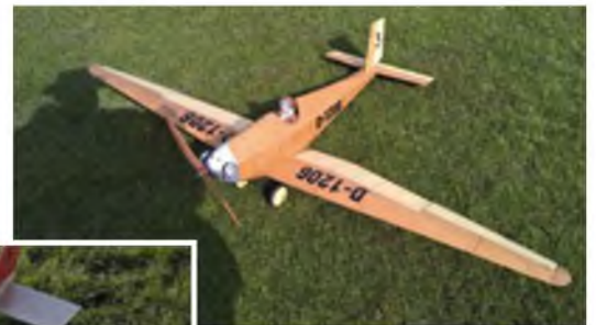
De Chica , Funflyer, Spw. 1 m, Gewicht 1 kg, E-Motor 1.250-1.600 kV, LiPo 3-4s.
