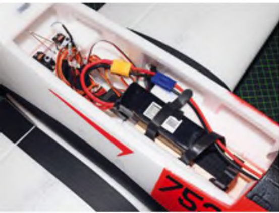
Der 2.200-mAh-3s-Akku muss zum Erreichen des angegebenen Schwerpunktes nach hinten über das Akkubrett hinaus verschoben werden.
