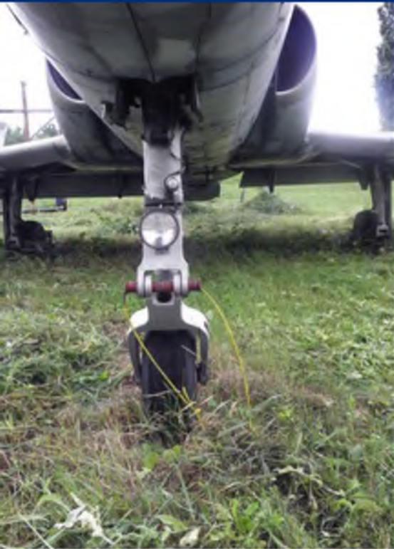
Das dreiteilige Einziehfahrwerk ist sehr robust konstruiert und ermöglicht sogar Starts auf Gras und von provisorisch vorbereiteten Autobahnen.
