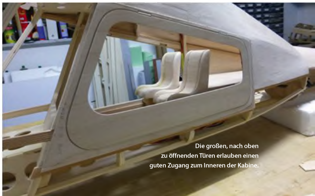
Die markanten Sitze in der Kabine entstanden aus Balsa und sind herausnehmbar.
