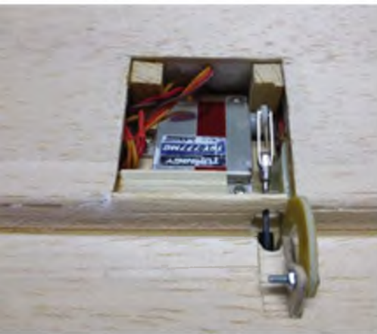
Die Anlenkung der Klappen und Ruder erfolgt verdeckt.
