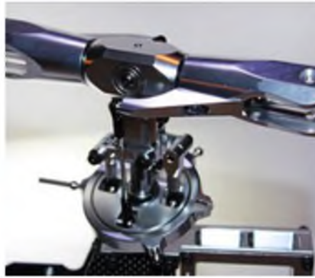
Der Rotorkopf hat eine Lagerung der Blattlagerwelle im Zentralstück. Hierdurch wird von den Dämpfergummis nur die tatsächliche Blattdämpfung übernommen.
