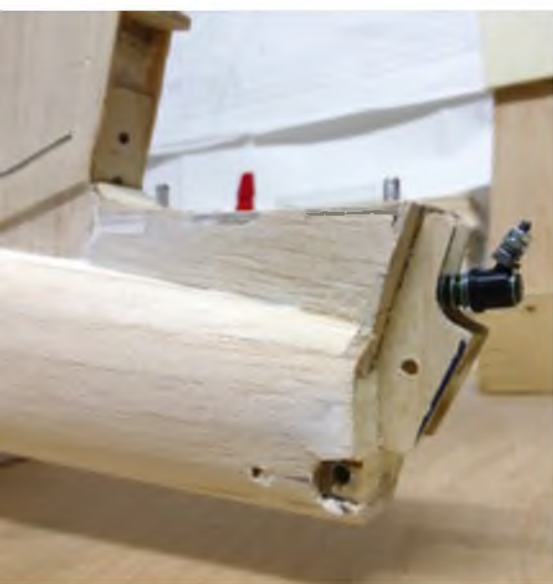
Die Höhenleitwerksauflage und Spornradhalterung am Heck.
