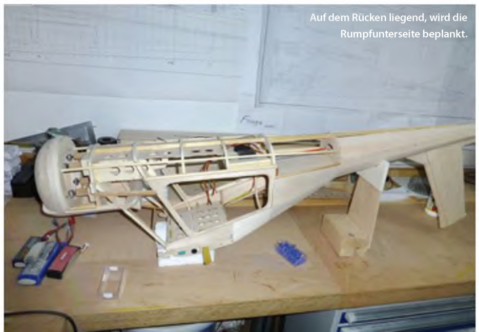
Der integrierte Akkuschacht ist über die Türen zugänglich. Um Trimmblei zu vermeiden, hätte der Schacht noch weiter nach vorn reichen müssen.
