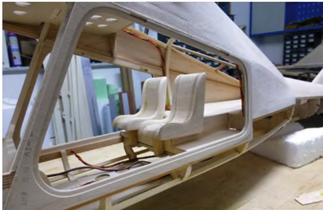
Die markanten Sitze in der Kabine entstanden aus Balsa und sind herausnehmbar.
