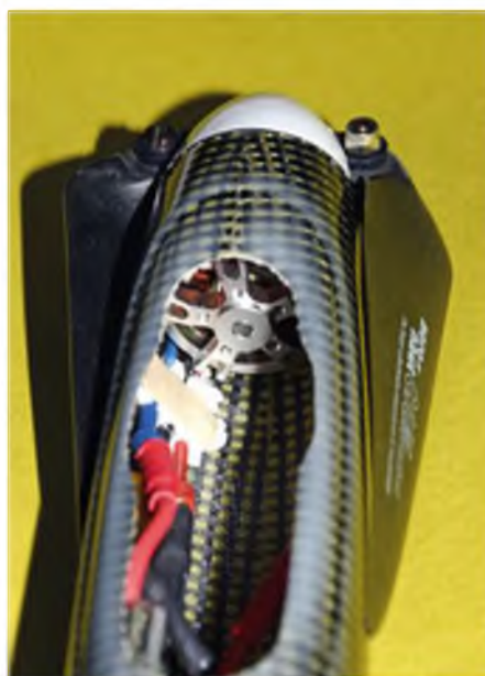
Die Motorkabel muss man sorgfältig perfekt sichern, denn bis zur Glocke des Motors ist nur ein Hauch Platz. ▶
