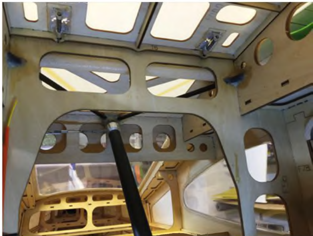
Die Schleppkupplung wurde in ein CFK-Rohr integriert, das zusätzlich zu den tragenden Spanten hin abgestrebt wurde. Das Servo zieht einen 3-mm-Stahldraht zur Seite heraus.
