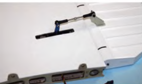
Die Servos für das Höhenruder sitzen direkt in der Dämpfungsfäche.
