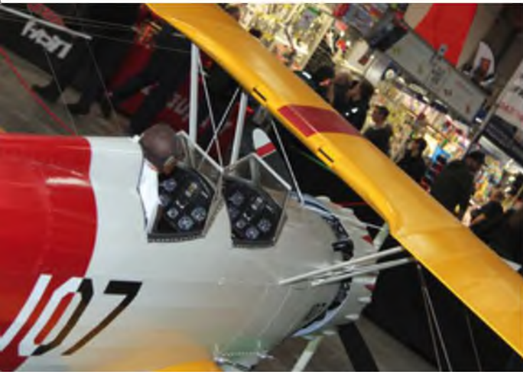
Die wunderschöne Super Stearman von Jörg Albrecht hat einen Moki-250-Sternmotor unter der Cowling. Die technischen Daten: Spw. 3,2 m, Länge 2,56 m, Gewicht 30 kg.
