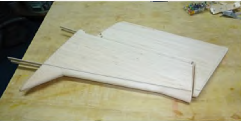
Das Höhenleitwerk entstand ebenfalls in klassischer Styro-Balsa-Bauweise.
