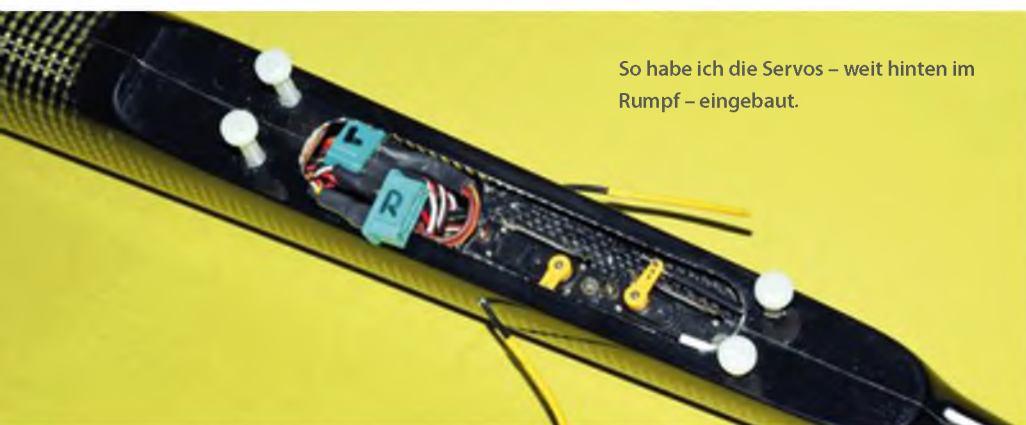
Die Anlenkung des Höhenruders. Ein kleines Stückchen Schrumpfschlauch dient als Sicherung.
