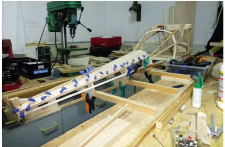
Die Verwendung einer freien Helling ermöglicht den verzugsfreien Aufbau und das Aufbringen großer Teile der Rumpfbepunktung.
