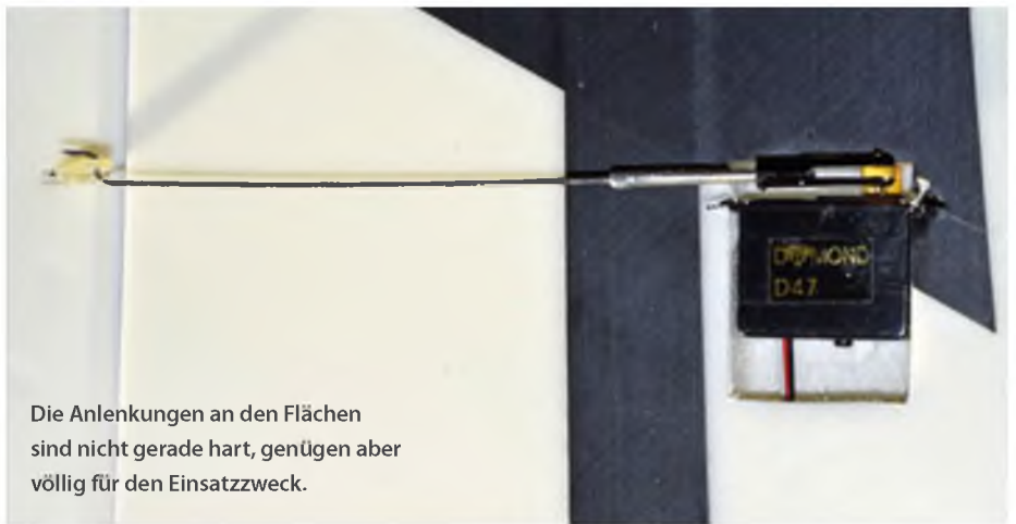
Die Seitenrudieranlenkung wird am Pylon nochmals gestützt.
