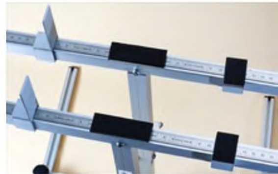
Der verstellbare Anschlag für die Nasenleiste (links) und das Gegengewicht (rechts) können auf der Millimeterskala exakt positioniert werden.
