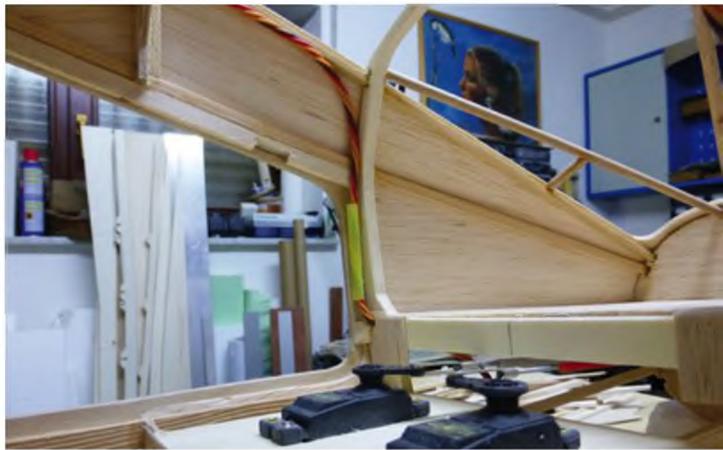
Die Servos für Höhen- und Seitenruder sitzen unter dem hinteren Kabinenboden.
