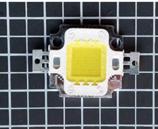
Eine der beiden Power-LEDs. Daran löten wir je zwei Kupferlackdrähte.
