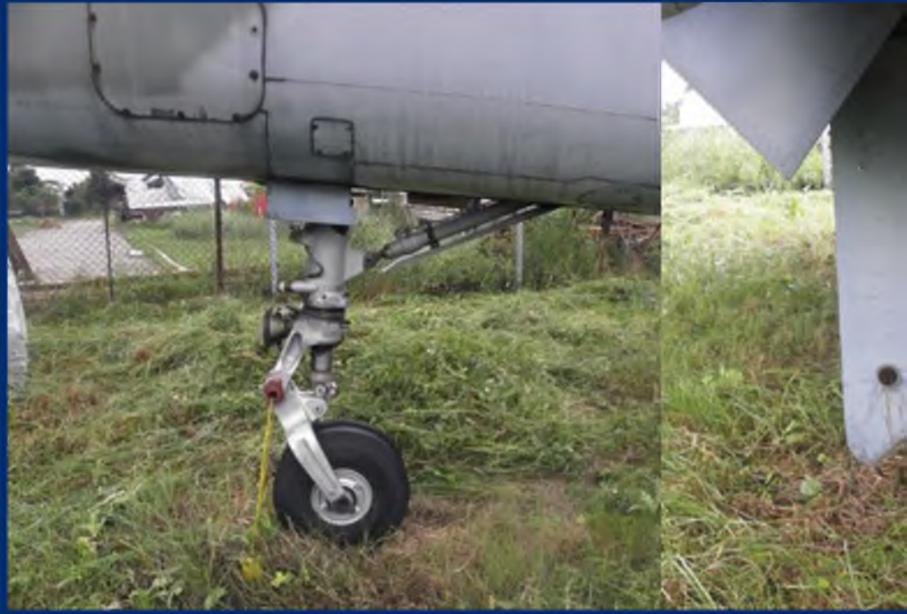
Das dreiteilige Einziehfahrwerk ist sehr robust konstruiert und ermöglicht sogar Starts auf Gras und von provisorisch vorbereiteten Autobahnen.
