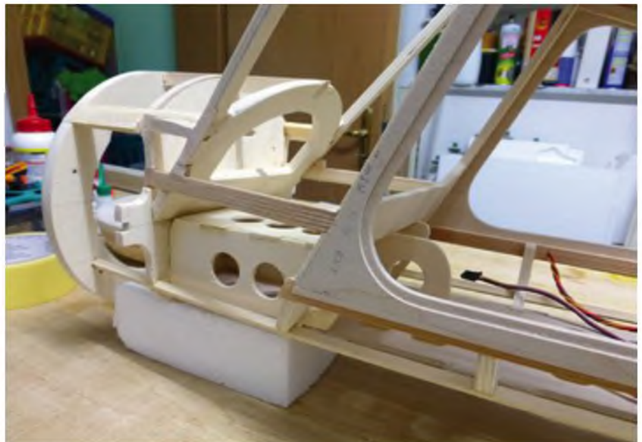
Der integrierte Akkuschacht ist über die Türen zugänglich. Um Trimmblei zu vermeiden, hätte der Schacht noch weiter nach vorn reichen müssen.
