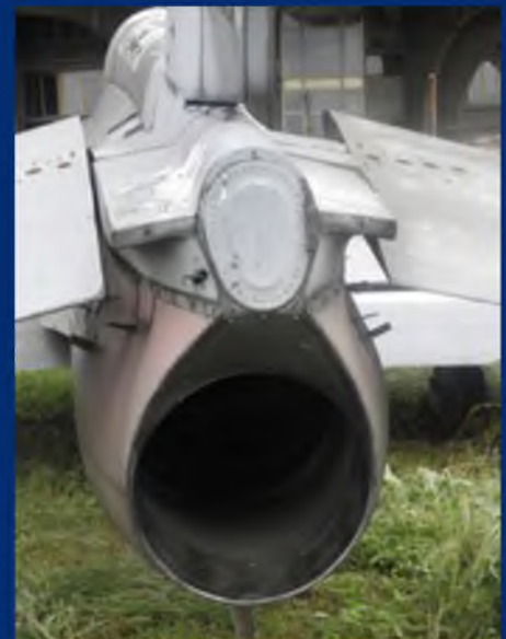
Den Antrieb der Soko G-4 Super Galeb übernimmt ein Stahltriebwerk Rolls-Royce Viper Mk.632-48 mit einem Standschub von 17,8 kN.
