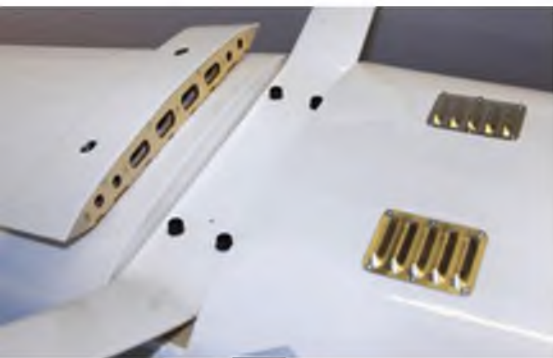
Das CFK-Hauptfahrwerk wird mit vier Schrauben befestigt und die Aussparung mit einem Deckel verschlossen. Die Federwirkung des Fahrwerksbügels ist sehr gut auf das Modellgewicht abgestimmt. Kiemenbleche entlüften den hinteren Bereich des Dämpferschachtes, um einen Wärmestau zu vermeiden.
