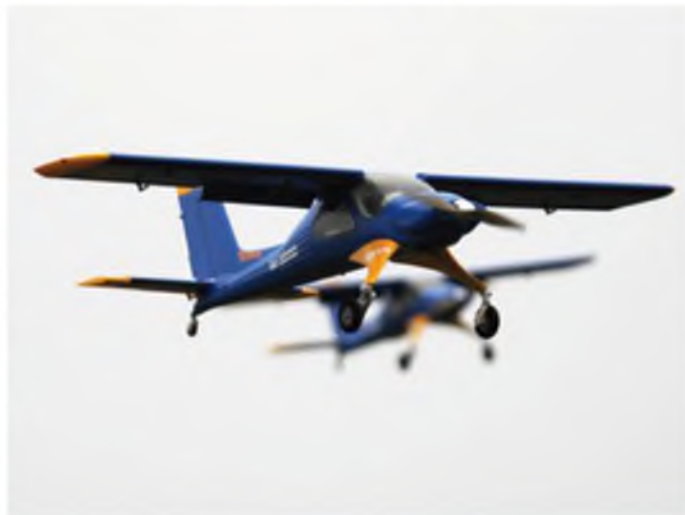
Mit reichlich Turbinenpower (IQ Hämmer) bewegte Lukas Nakir den großen MDM-1 Fox von Paritech auf engstem Raum (Maßstab 1:2, Spw. 7 m, Gewicht 24,8 kg).
