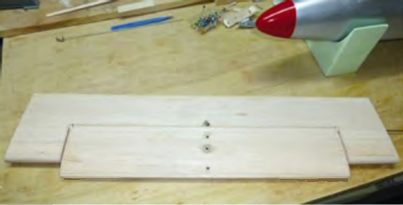
Das Höhenleitwerk entstand ebenfalls in klassischer Styro-Balsa-Bauweise.
