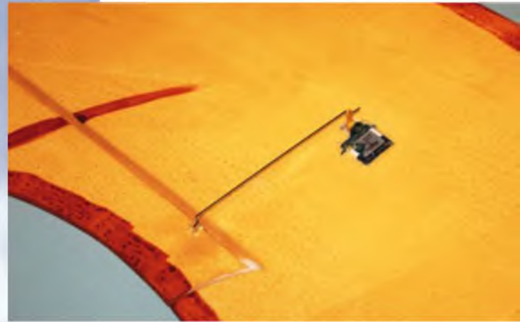
Die Querruderservos sitzen klassisch direkt vor dem Ruder und bewegen dieses über kurze Schubstangen.
