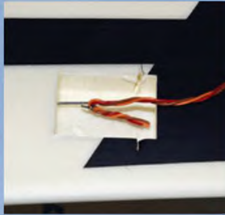
Das Einziehen der Kabel erfordert etwas Fingerspitzengefühl. Nimmt man ein Bowdenzug-Außenrohr zu Hilfe, geht es besser.
