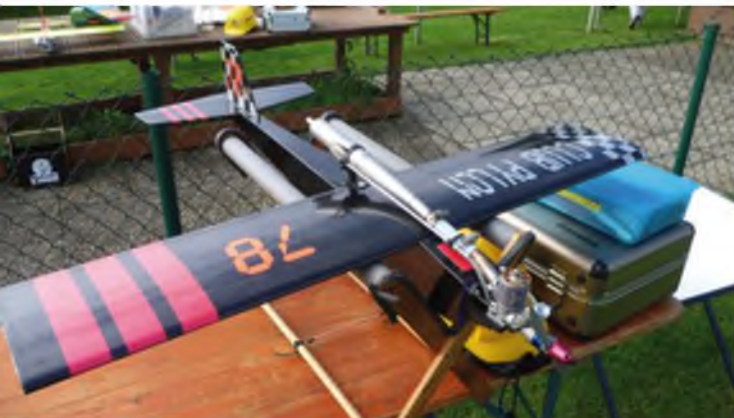
Das Unlimited-Modell von Marcus Schill: Eine Eigenkonstruktion, ausgerüstet mit einem sehr preisgünstigen Motor aus Tschechien, dem MVVS 4,2 Combat und einem OPS-Resonanzrohr.
