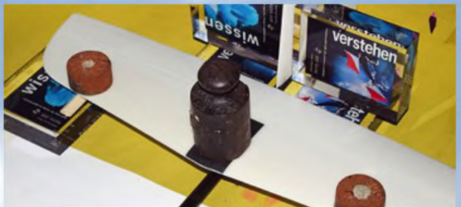
So wird das Seitenruder angeklebt und ausgerichtet.
