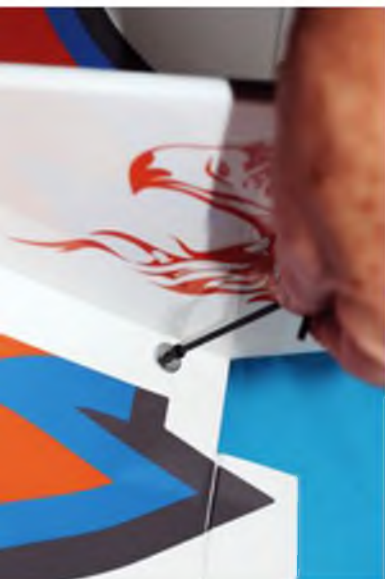
Hinten wird die Tragfläche durch zwei Schrauben am Rumpf gehalten.
