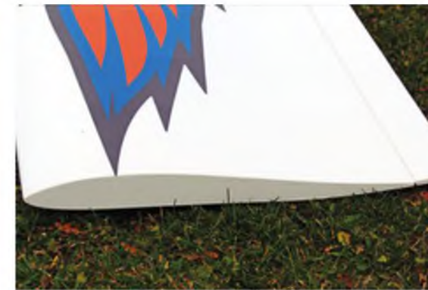
Das beim Big Plank verwendete Profil hat einen deutlichen S-Schlag.
