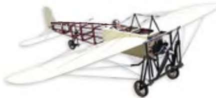
Blériot XI , mit Vollholzrädern, Flächen einfach zu demontieren, Spw. 1.295 mm, Gewicht 1.980 g (leer), BL-Motor/LiPo 3s, Preis: 219,99 €.
