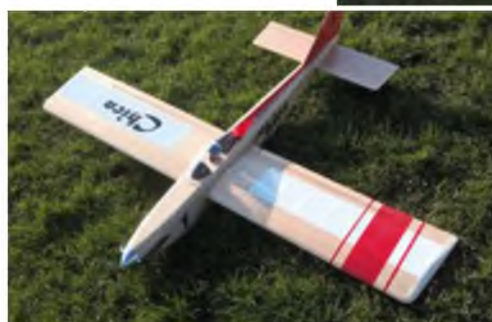
De Chica , Funflyer, Spw. 1 m, Gewicht 1 kg, E-Motor 1.250-1.600 kV, LiPo 3-4s.
