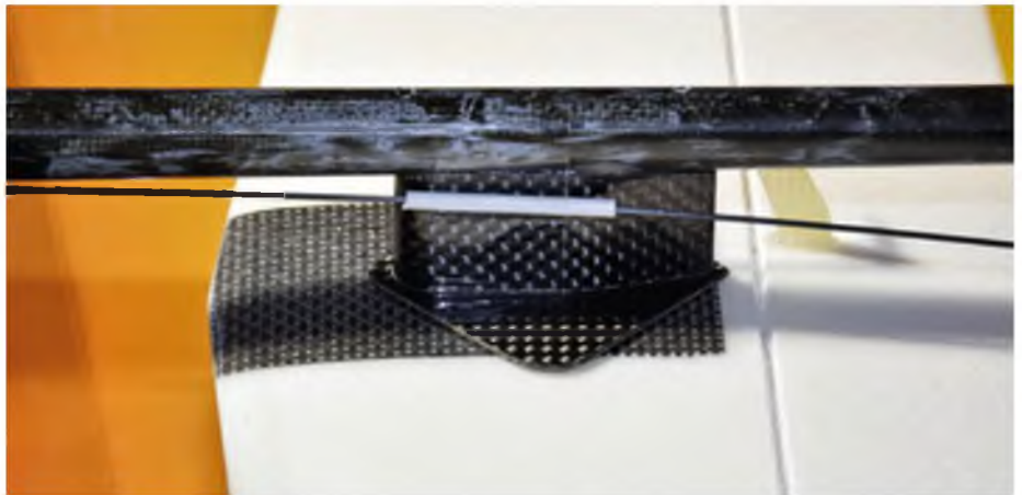
Die Seitenrudieranlenkung wird am Pylon nochmals gestützt.
