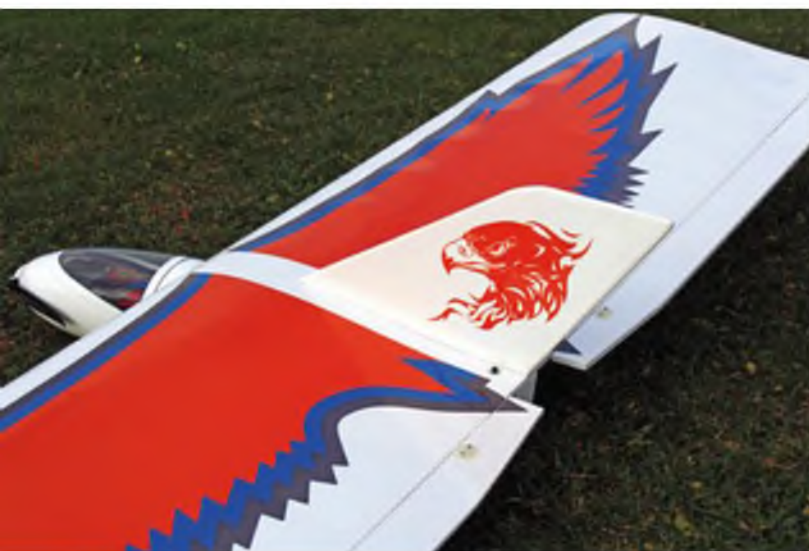
Hinten wird die Tragfläche durch zwei Schrauben am Rumpf gehalten.
