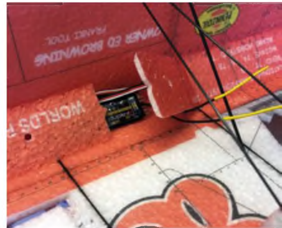
Den Empfänger habe ich unter einem seitlichen Torsionsstreifen versteckt.
