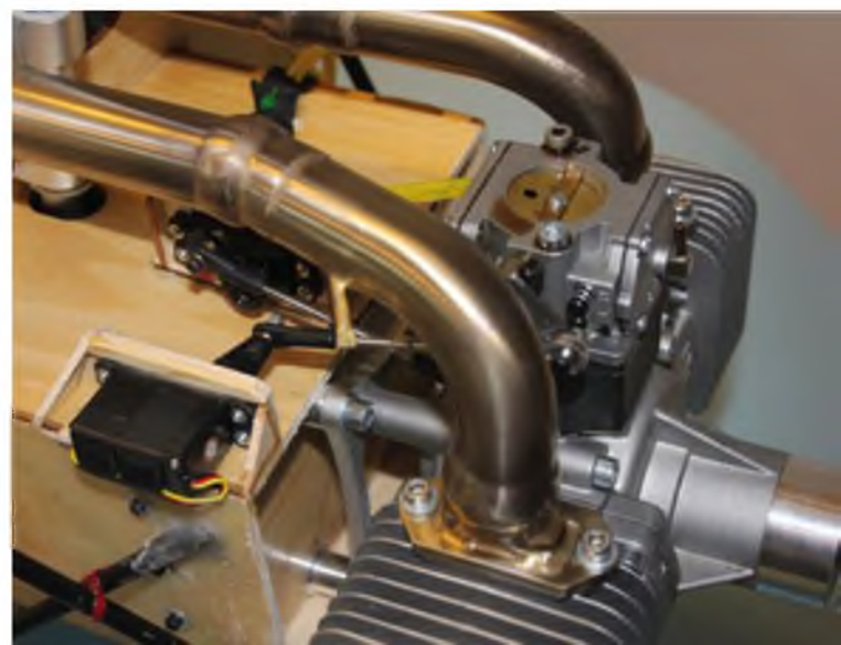
Um dem stärkeren Motor gerecht zu werden, habe ich den Motordom mit Glasgewebe bzw. Kohle/Kevlarband verstärkt und zusätzlich mit CFK-Rohren abgestrebt.
