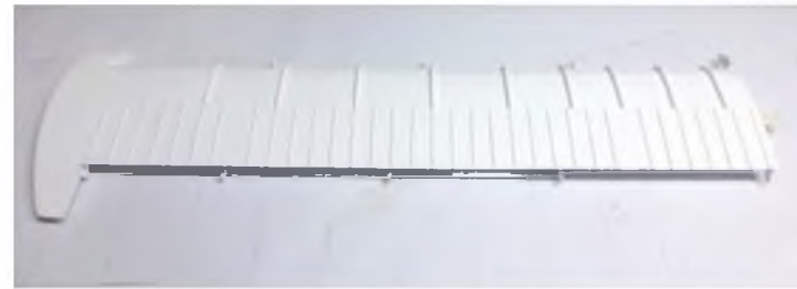
Vor dem Aufbringen der charakteristischen Sicken und der Grenzschichtzäune wurden alle Balsaoberflächen lackierfertig vorbereitet.
