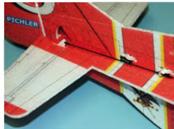
Die Ruder werden über Schubstangen direkt angelenkt. Es liegen sogar leichte Klemmhülsen bei, mit deren Hilfe sich die Gestängelänge exakt einstellen lässt.
