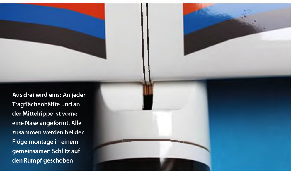
Die Aufnahme für das Steckungsrohr ist fertig eingebaut. Der CFK-Stift als Verdrehsicherung ist aber noch einzukleben.
