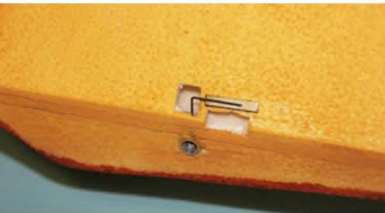
Zur Sicherung der Flächen habe ich ein dünnes Loch durch die Steckungshülse und das Loch gebohrt, durch das ein Stahldraht kommt. Der Draht selbst wird von einem Magneten an seinem Platz gehalten.
