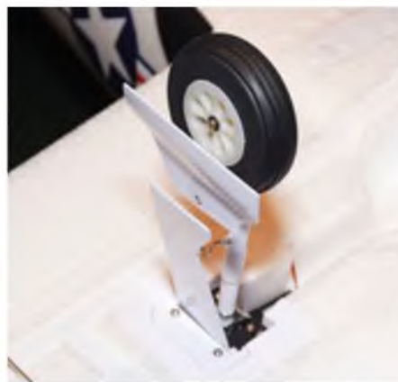
Das dreiteilige Einziehfahrwerk ist optisch und mechanisch sehr gelungen – und die Start- und Landebahn muss auch keinen Golfplatz-Rasen haben.
