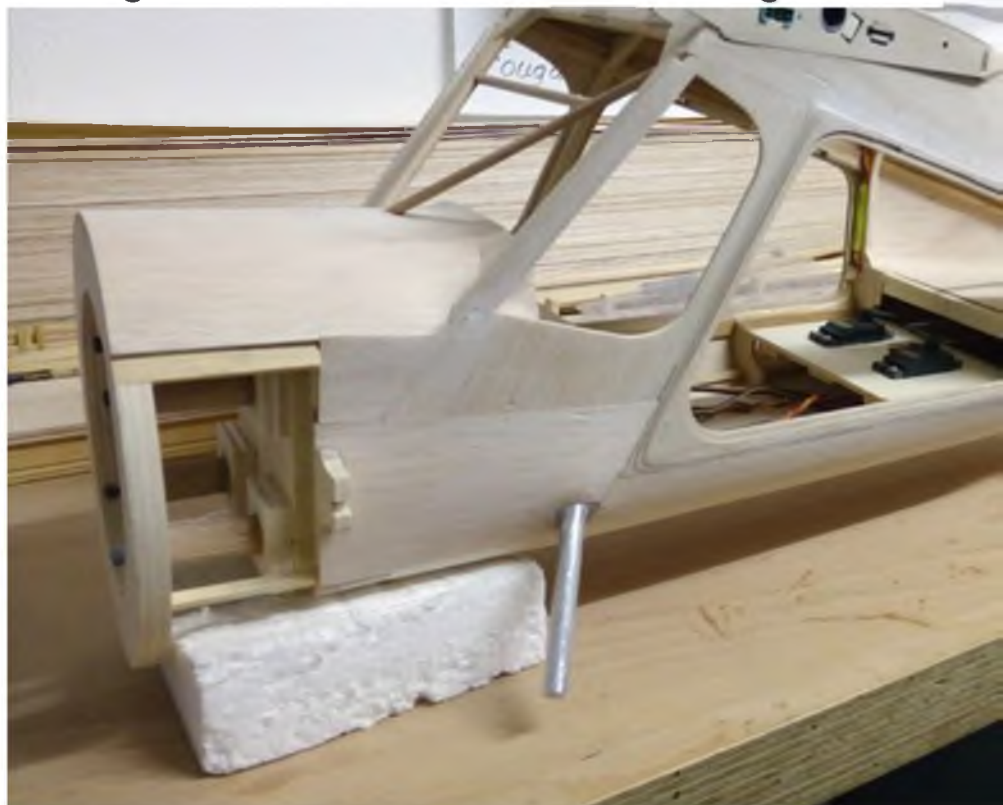
Zur Aufnahme der Fahrwerksbeine wurden Alu-Rundstäbe im Rumpf verklebt.
