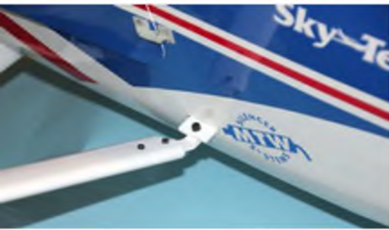
Sowohl im Rumpf als auch in den Flächen ist die Halterung der Streben sehr stabil ausgeführt, so dass diese eine tragende Funktion übernehmen.
