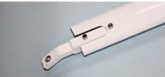
Dieses Profil stellt die Verbindung zum Rumpf her. Es muss noch selbst ausgerichtet und verschraubt werden.
