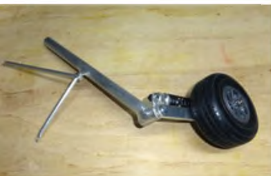
Die zur Dämpfung der Hauptfahrwerke vorgesehenen RC-Car-Dämpfer haben sich nicht bewährt und wurden später gegen Eigenbau-dämpfer ersetzt.
