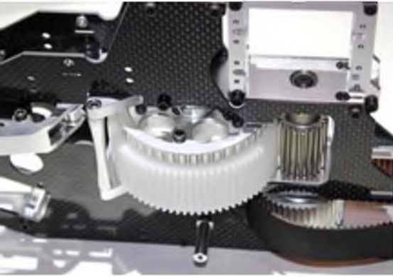
Der massive Antriebsstrang kommt auch mit hohen Motorleistungen klar. Das Ritzel und das Hauptzahnrad bauen sehr hoch für eine optimale Kraftübertragung.
