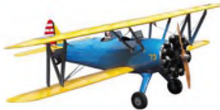
PT-17 Stearman , mit Sternmotoratrappe, Spw. 1.270 mm, Gewicht 960 g (leer), BL-Motor/LiPo 3-4s/2.100 mAh, Preis: 259,99 €.
