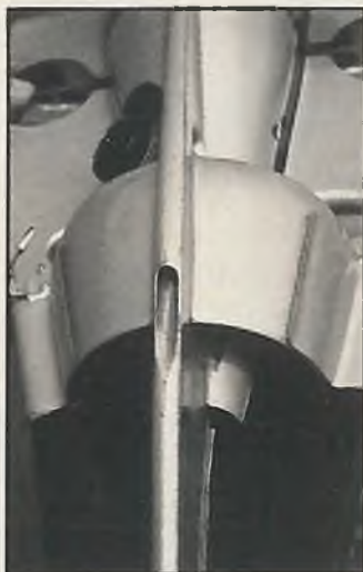
Blick auf den Fanantrieb, man beachte die elegante Lösung der Abgasführung.
