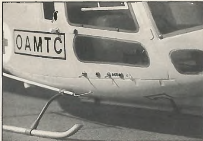
Gut ausgerüstet: Zwei Akkus, zwei Schalterkabel, zwei Ladebuchsen. Die komplette Stromversorgung bis hin zum Schalterkabel und Empfängeranschluß ist doppelt ausgelegt
