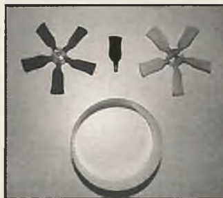
Der Rotor: links in der CfK-Ausführung, rechts in der GfK-Ausführung. Die Blattform entspricht der des Originals
