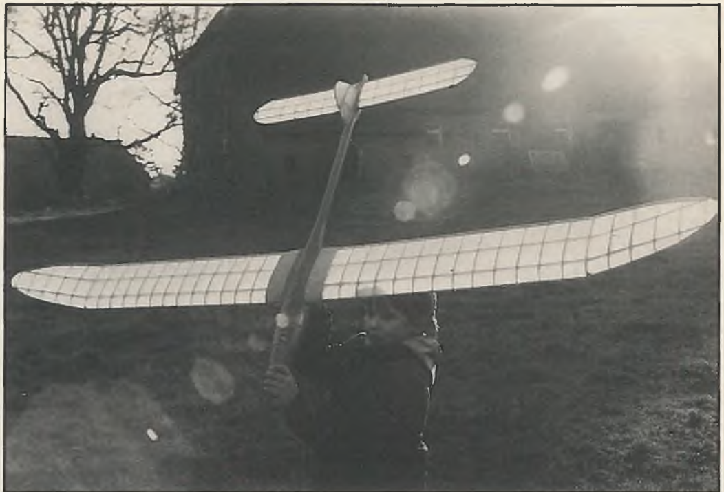
Bei Freiflugmodellen, die mit Fernsteuerung ausgestattet werden sollen, darf man bei der Seitenrudergröße nicht knausern; das eigenstabile, langsame Modell gehorcht nur unwillig den Kommandos. Bei der „Libelle“ wurde das Seitenleitwerk als Pendelruder ausgelegt
