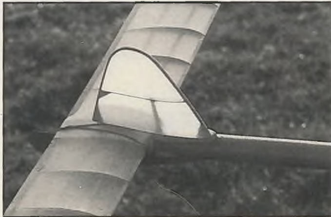
Bei Freiflugmodellen, die mit Fernsteuerung ausgestattet werden sollen, darf man bei der Seitenrudergröße nicht knausern; das eigenstabile, langsame Modell gehorcht nur unwillig den Kommandos. Bei der „Libelle“ wurde das Seitenleitwerk als Pendelruder ausgelegt
