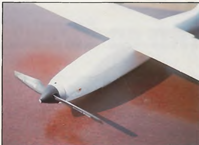
Unerlässlich für einen leisen Lauf des Speed 400 ist der Aluminium-Spinner von Graupner. Produkte aus Kunststoff konnten in dieser Größe nicht überzeugen.
