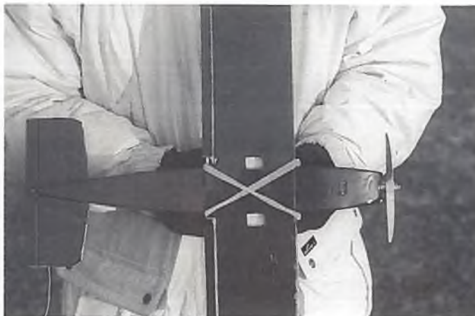
In die kleinen Lcher steckt man die Finger hinein. Dadurch hat man beim Start den Flieger gut im Griff.
