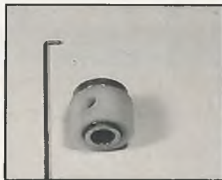
Die verschlissene serlenmäßige Pitchgleithülse aus Kunststoff
