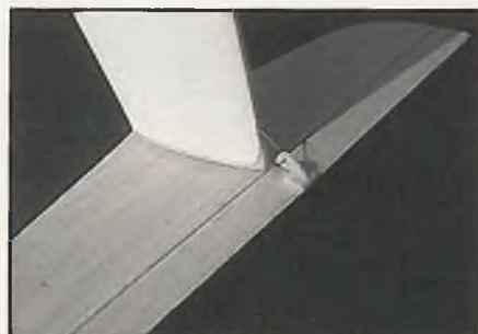
Die Anlenkung des Höhenruders geschieht auf die gleiche Weise wie bei den "Ratten" und "Katzen" derselben Flugmodellart.
