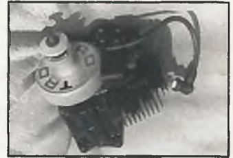
Die Zündspule verdeckt einen großen Teil des Zylinders, thermisch ergaben sich daraus keine Probleme
