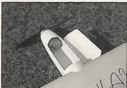
Die geöffnete Rumpflappe zeigt viel Platz für den Schalter/Regler und zum Einschleiben des Flugakkus.
