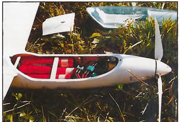
Einbau des Motors und der Antriebsakkus - Platz bietet der Rumpf reichlich
