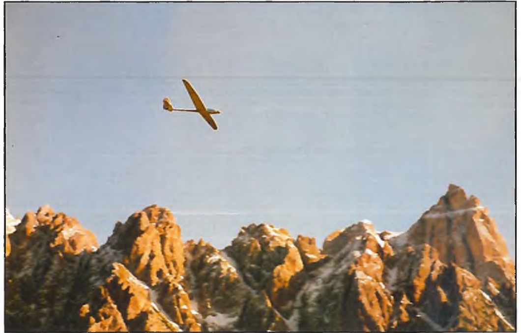
Die höhere Flächenbelastung durch den Elektroantrieb macht den Arriba nicht gerade zu einem Thermikschleicher, durch den guten "Durchzug" überzeugt das Modell allerdings im Kunstflug
