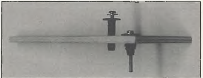
Sehr vielseitig verwendbar sind diese neuartigen Schwinggummis. Das Funktionsprinzip ist ähnlich dem einer Niete. Das linke Element ist durch das Montageloch gesteckt, das rechte ist bereits angezogen, wobei sich der Gummikulstartig verkeilt.
