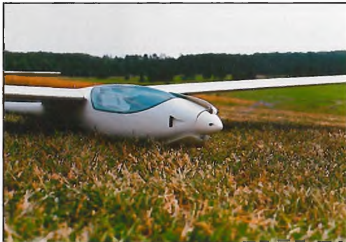
Über die auf beiden Seiten vorhandenen Hutzen erfolgt die Belüftung des Rumpfes
