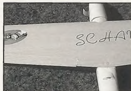
Das Querruder ist etwas klein ausgefallen und den Luftauslaß sollte man besser ganz wegschleifen.
