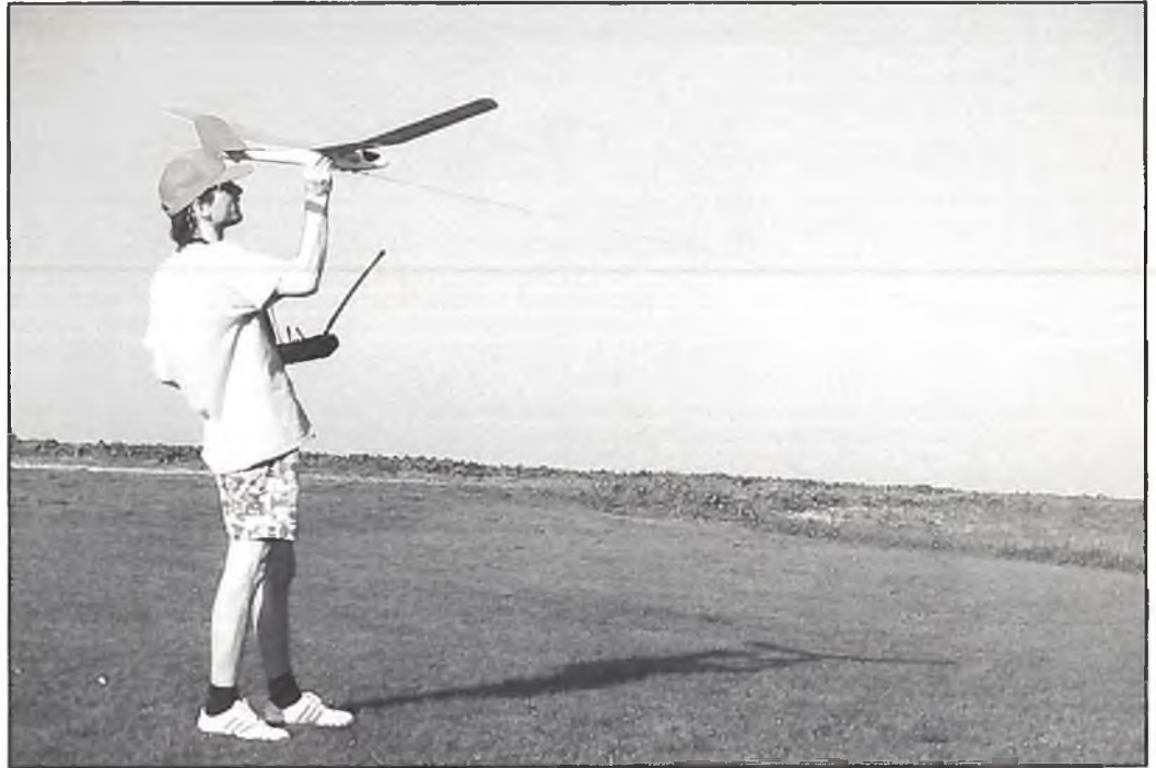
So geht es etwas geruhsamer als beim richtigen Wurfstart, der einen normalen, nicht durchtrainierten "Schreibtischtäter" schnell erschöpft. Die Katapultstartmethode ist kein richtiger Hochstart mit langer Steigstrecke, der Segler wird mit einem kurzen Seil nur stark beschleunigt
