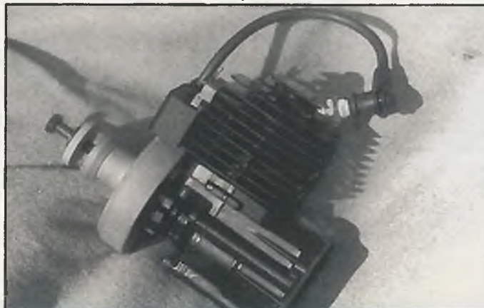
Der kurze Hub führt auch zu einer kompakten Bauform
