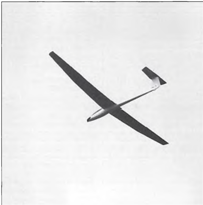
Vier Klappen, viel dahinter: Wölbklappen und Querruder beim tiefen Vorbeiflug im Einsatz. Das Klappensystem erwies sich als sehr hilfreich
