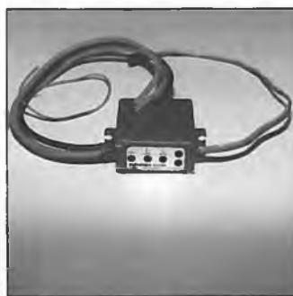
Der Hölzl-Glühkerzenregler, hier in der Version für zwei Glühkerzen, wird in einem Standard-Servogehäuse geliefert. Die Einstellregler für den Schalterpunkt und die Glühkerzen, sowie die beiden Kontroll-LED's sind sichtbar. Die Zeitverzögerung muß innen im Gerät eingestellt werden ▼
