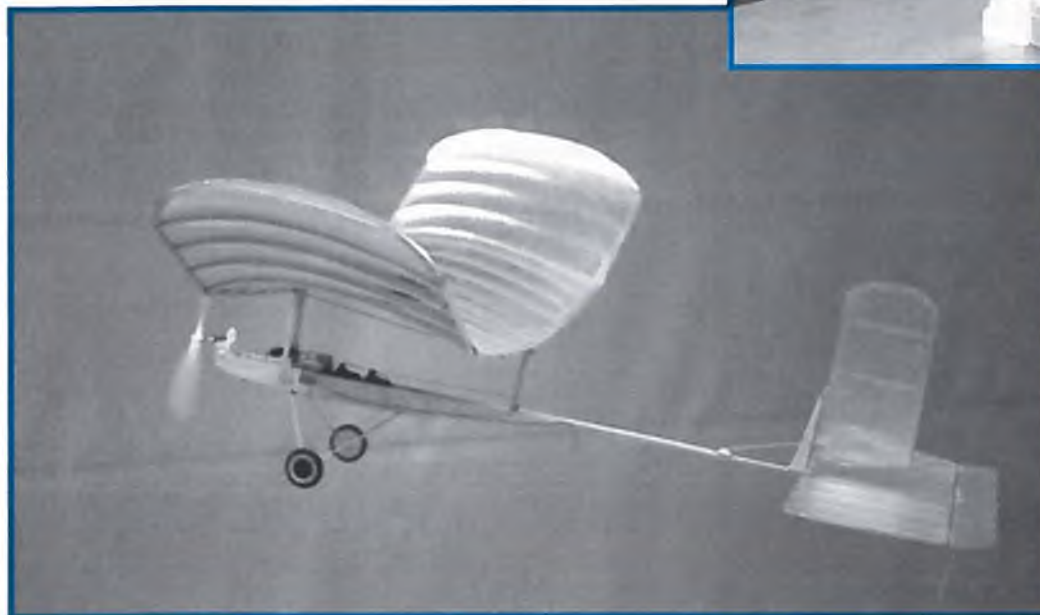
◀ „Elektrosali“ ist der größte der drei RC-Saalflieger, seine Spannweite beträgt 1050 mm
