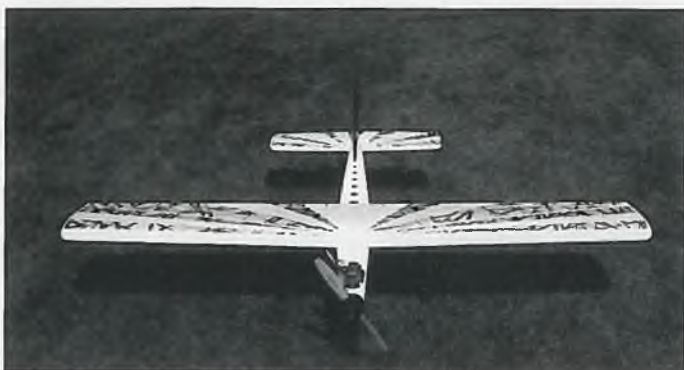
Mit der Pladerung der Anlage ist auch bei diesem Modell möglich, den Schwerpunkt ohne Ballastzugabe einzustellen
