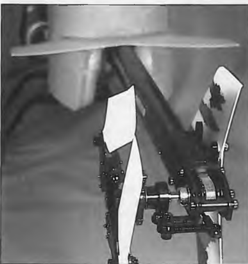
Ein Abstand von ca. 20 mm sind beim Kleinhubschrauber etwa die Grundeinstellung bei Minimum-Pitch. Der 10-cm-Hubschrauber benötigt etwa Null-Grad, die hier gezeigte Einstellung ist bereits für den Schwebeflug. Es zeigt sich deutlich, daß der erheblich längere Heckausleger des „Großen“ einen besseren Wirkungsgrad besitzt
