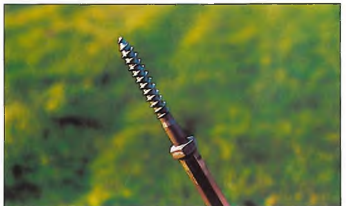
Der Erdanker der Kühlvorrichtung ▼
