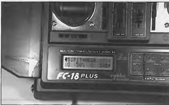
▲ Menüpunkt Heckbeimischung; gewählte Rotordrehrichtung ist rechts; unterhalb der Schwebeflug-einstellung sind 50% vorgegeben, ebenso 50% oberhalb des Schwebeflugpunktes. Diese Einstellung kann so stehen bleiben
