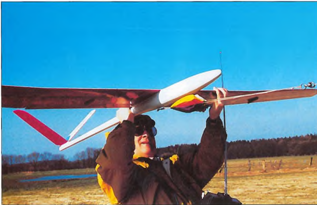
Beim Hochstart werden die Wölbklappen zirka 10 mm, die Querruder bis 8 mm nach unten gestellt.
