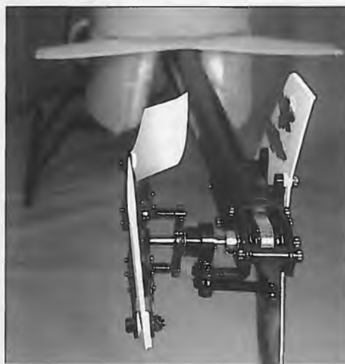
Ein Abstand von ca. 20 mm sind beim Kleinhubschrauber etwa die Grundeinstellung bei Minimum-Pitch. Der 10-cm-Hubschrauber benötigt etwa Null-Grad, die hier gezeigte Einstellung ist bereits für den Schwebeflug. Es zeigt sich deutlich, daß der erheblich längere Heckausleger des „Großen“ einen besseren Wirkungsgrad besitzt
