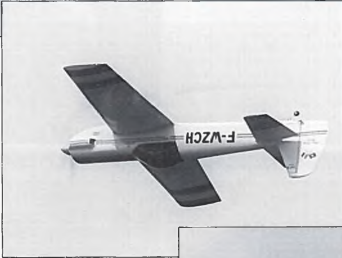
Ein Kunstflugmodell von P.C. Junker, geflogen von Ralf Binder. Das Modell hat einen GFK-Rumpf und eine in der SBS-Bauweise gefertigte Fläche. Diese Styropor-Leichtbauweise wurde in der FMT 1 und 2/95 beschrieben
