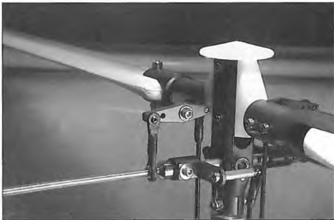
Von der eingestellten Taumelscheibe aus wird der Mischebel am Blatthalter ebenfalls waagrecht eingestellt, was die gewünschten 4° (5°) Schwebeflugwinkel bringt
