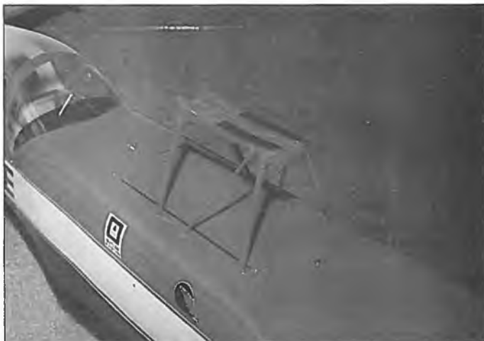
Der Baldachin wurde umkonstruiert, um einen Akkuschacht im Schwerpunkt zu ermöglichen
