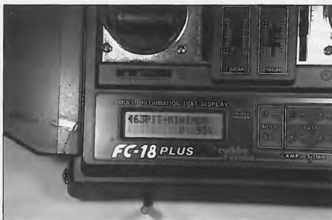
▲ Die Einstellung des Pi-Minimum erfolgt mit Hilfe der Einstellwinkellehre auf 0° für den Anfänger
