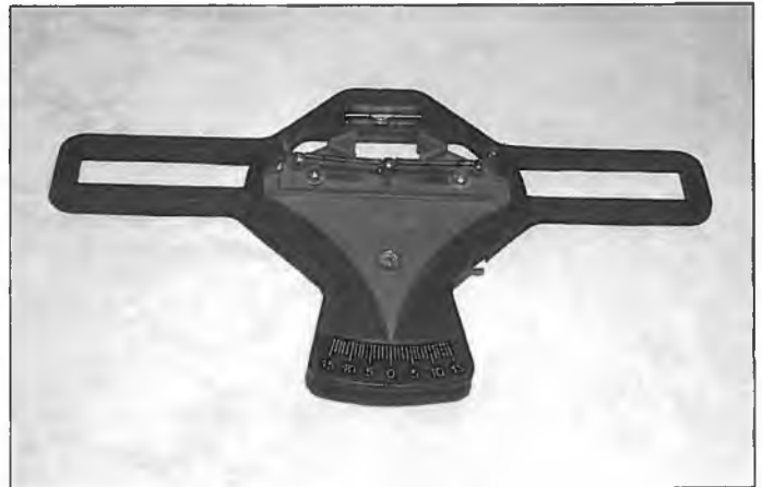
Eine Einstellwinkellehre, die über das Rotorblatt geschoben wird und über einen Pendel den Winkel anzeigt. Voraussetzung ist allerdings, daß Hubschrauber und Paddelstange waagrecht stehen.
