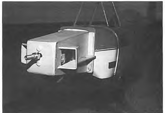
Der selbstkonstruierte Motorträger mit den großen Lufteinläufen zur optimalen Kühlung des Motors
