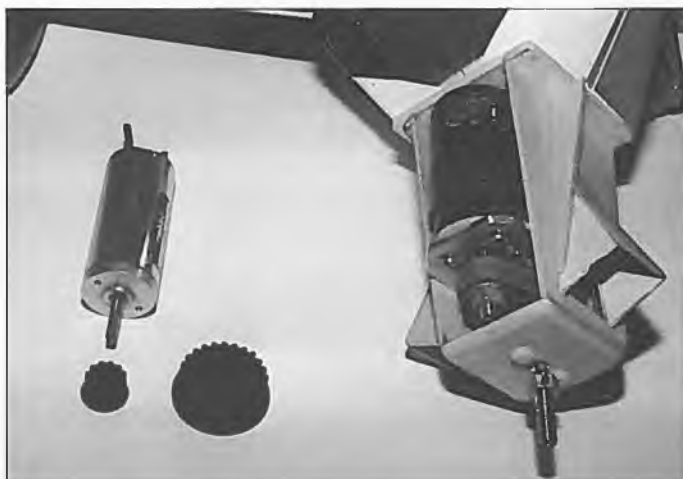
Die beiden Getriebe-Brüder: KE 40/10 mit 1:2,0 Getriebe und eingebaut der Ultra 1600/8 mit 1:1,84-Getriebe
