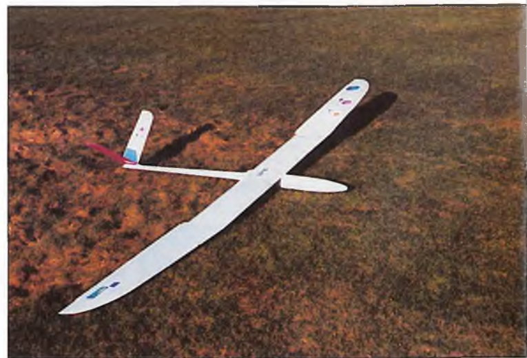
Butterflystellung: Querruder 13 mm nach oben, Wölbklappen 16 mm nach unten.
