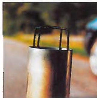
◀ Unten am Rohr ist ein Schutzgitter aus Federstahl angebracht; er verhindert, daß ein Akku bis auf die Erde durchfallen könnte
