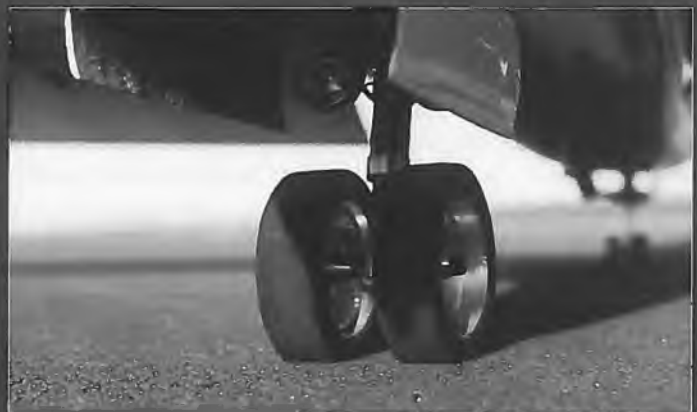
Das hochbelastete Hauptfahrwerk trägt 80 Prozent des Gesamtgewichts.
