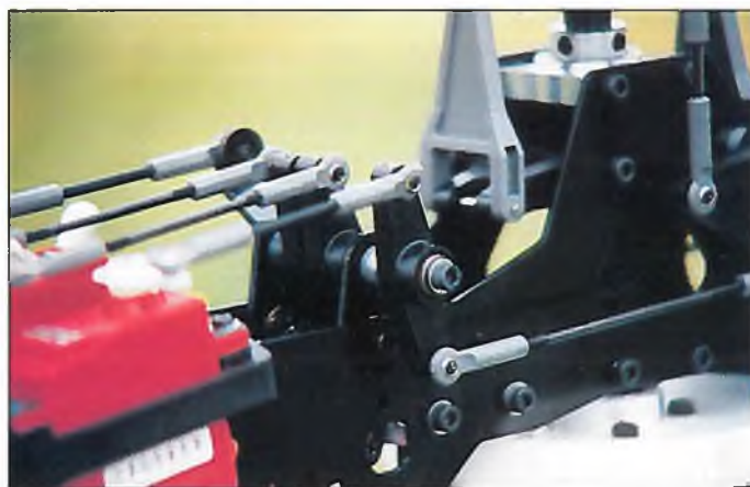
Die Graupner/JR-Hubschrauber Ergo30/50 haben wieder einen anderen mechanischen Taumelscheibenmischer. Trotzdem gelten auch hier die Einstellhinweise.
