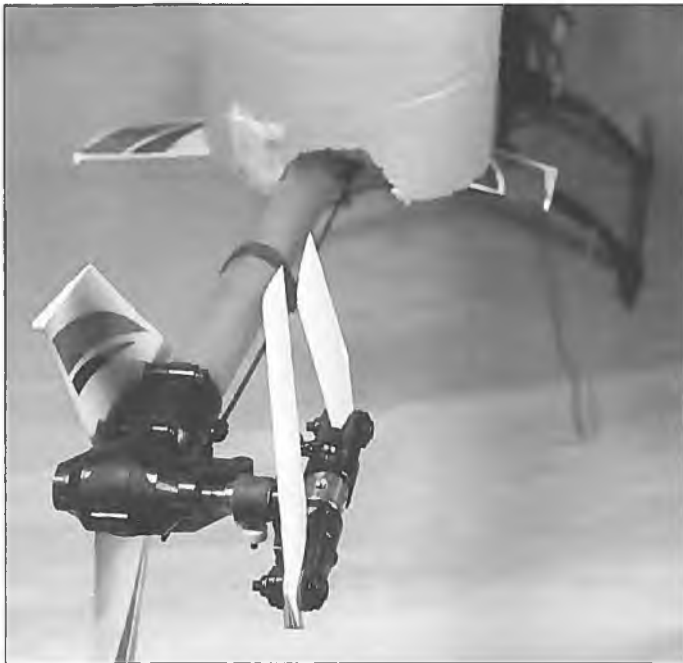
Die Heckrotorgrundstellung eines 10-ccm-Hubschraubers bei Pitch-Minimum. Die hochgeklappten Blätter sollten eine Linie bilden.
