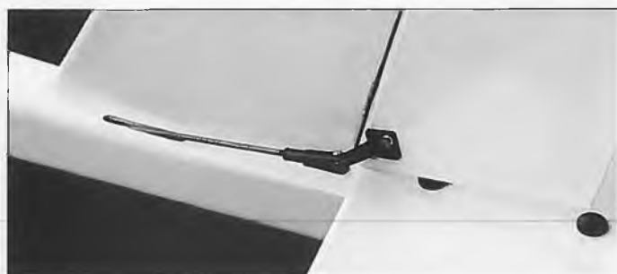
Die Seitenrudernanlenkung. Bis auf das Anschrauben des Ruderhorns ist alles fertig. Das Zubehör ist von ausgezeichnetem Qualität.
