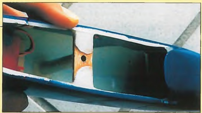
So wird die Fläche nach alter „Werner Dettweiler“-Technik von unten angeschraubt. Das Alurohr erleichtert das Einführen der Kunststoffschraube und der eingeklebte Querriegel aus Holz trägt den Schraubenkopf, während die Mutter in der Fläche sitzt.
