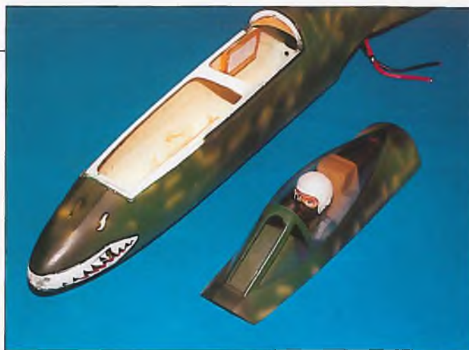
Platz für den Flugakku gibt es in der GFK-Version in jedem Falle ausreichend. Doch die abnehmbare Kabinenhaube läßt sich der Akku leicht wechseln.
