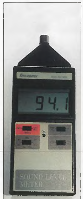
Graupners Schallpegelmeßgerät SL 4001 mit eingeschalteter Kalibrierfunktion.
