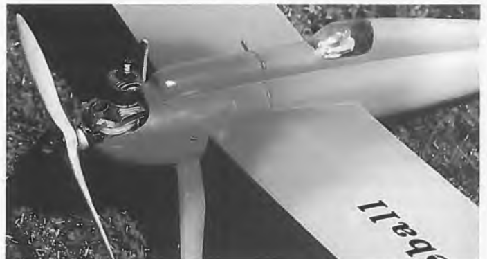
So sah das allererste Fesselflug-Modell aus, welches an zwei Leinen gesteuert wurde. Der „Fireball“ mit Antik-Motor
