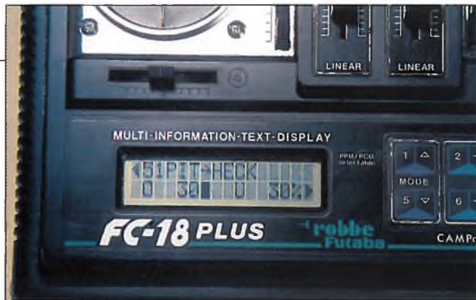
Ein Beispiel für den Menü-Punkt Heckbeimischung. Diese Werte sind schon in der Grundeinstellung des Menüs: oben 30%, unten 30%, bezogen auf die Pitchknüppel-Mittelstellung. Kann so stehen bleiben. Rechts oben wird noch die Drehrichtung des Rotors eingegeben, was im Bild schlecht erkennbar ist.
