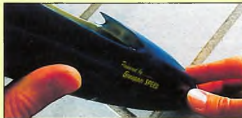
Die Flächenaufnahme nach der Verstärkung mit eingedicktem Harz. So sollte es eigentlich schon vom Hersteller aussehen.
