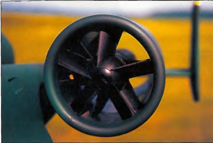
Für die A 10 ist der Aeronaut Impeller Turbo-Fan 1000 vorgesehen. Wenn's sein muß, passen auch andere 90-mm-Impeller.
