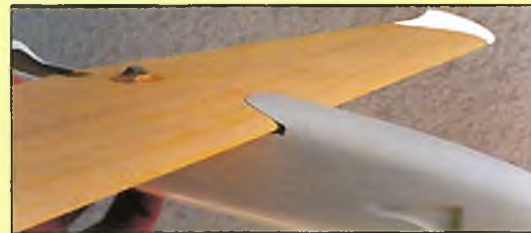
Die vordere Flächenaufnahme im Auslieferungszustand – deutlich vor der Nasenleiste ist ein großzügiger Spalt zu sehen.
