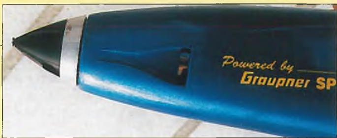
Luftkappen, die an der richtigen Stelle sitzen, sind für die kleinen Motoren ein Garant für ein längeres Leben. Wie man sieht, paßt der Graupner-Präzisionsspinner auch hier perfekt.
