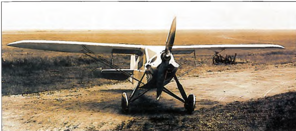
Vorbild für den klassischen Einbau der luftgekühlten Motoren As 10 bis zum As 10C, die hängenden Zylinder und die obenliegende Kurbelwelle ermöglichten trotz großer Luftschaube ein relativ niedriges Fahrwerk. Die mögliche Einschnürung der Haube bis zur Propellernabe hatte nicht nur aerodynamische Gründe. Sie gab dem Piloten auch eine verbesserte Sicht, besonders beim Rollen am Boden.
