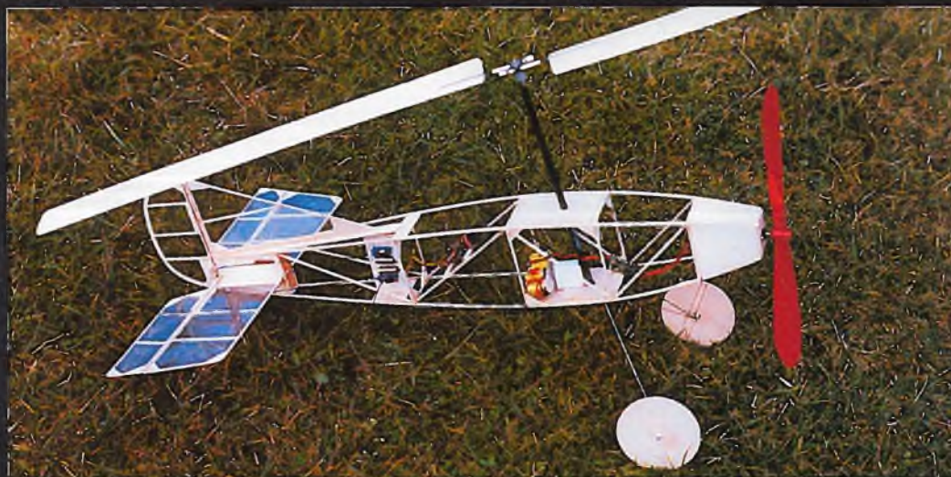
Der Autogyro für die Halle von Sylvia Koberger und dem Autor; Rotordurchmesser 72 cm und Abfluggewicht 108 g; Gesteuert wird konventionell über Höhen- und Seitenruder. Leider ist die Flugstabilität noch nicht optimal und das Modell fliegt erst einige Meter, aber die Tendenz ist steigend.
