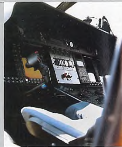
Das Cockpit ist mit farbigen Multifunktionsanzeigen ausgestattet, die zur Anzeige von Flugdaten, technischen Parametern und taktischen Informationen dienen. Die zusätzlich vorhandenen, konventionellen Rundinstrumente dienen als Sicherheitsreserve.
