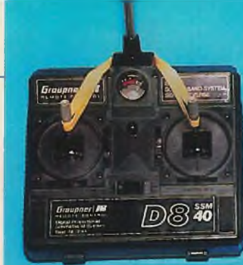
Normallage. Die beiden Steuerknüppel werden mittels Gummiband in der oberen Position gehalten.
