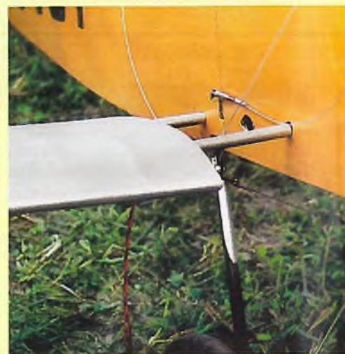
▲ Tragflächensteckung aus 12mm Alurohr
