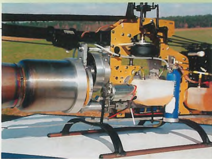
Die Turbine hängt unterhalb des Heckrohrs; trotz des kurzen Abstandes zum Heckrotor gibt es keinerlei Hitze Probleme ▽
