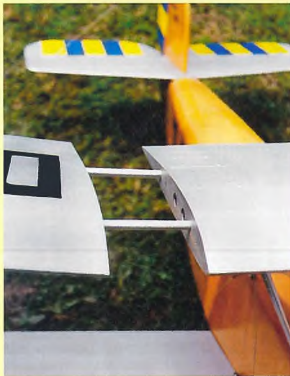
▲ Tragflächensteckung aus 12mm Alurohr
