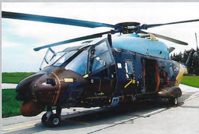
Der Prototyp Nr. 4, der komplett in Deutschland montiert wurde. Die braun gefärbten Rumpfssegmente wurden bei Eurocopter Deutschland (ECD) laminiert, während die hellblau eingefärbten Verkleidungen bei Eurocopter Frankreich (ECF) entstanden.
