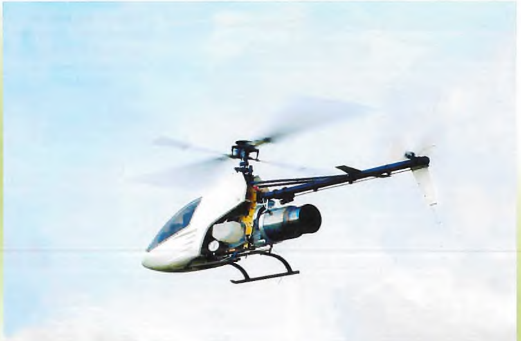
◀ Blick von hinten auf den schwebenden Helikopter; am Flimmer der Luft kann man sehr gut die Ablenkung des Abgases durch den Rotorabwind erkennen
