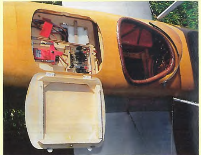
▶ Unter der Kofferraumklappe liegen Doppelstromversorgung, Seitenruderservo, Empfänger
