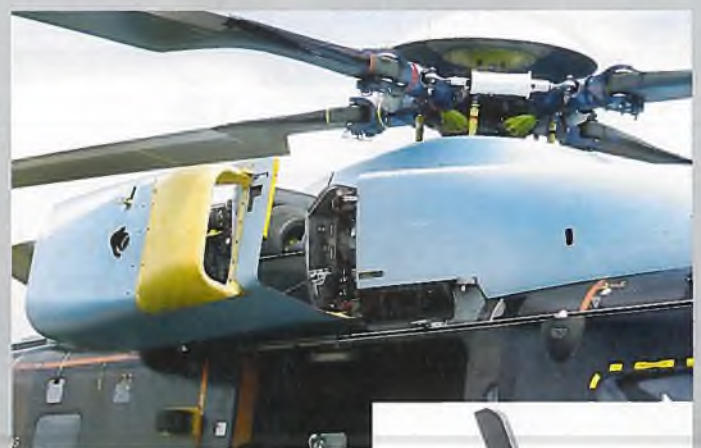
Der Hauptrotorkopf der NH 90 besteht aus Titan und ist mit wartungsarmen Elastomerlagern ausgerüstet.
