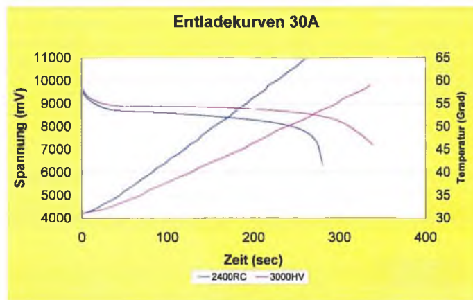
Abb. 5: Verhalten bei 30 A Entladestrom
