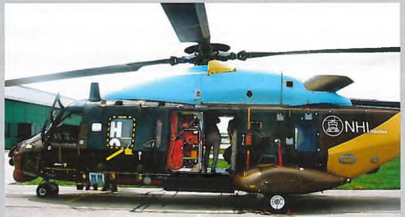
Der Prototyp Nr. 4, der komplett in Deutschland montiert wurde. Die braun gefärbten Rumpfssegmente wurden bei Eurocopter Deutschland (ECD) laminiert, während die hellblau eingefärbten Verkleidungen bei Eurocopter Frankreich (ECF) entstanden.
