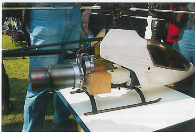
▼ Die Eigenbau-Turbine von Raimund Kreher. Der Sperrholzkasten beinhaltet der Startermotor, der auch nach dem Flug für die Abkühlphase zuständig ist.
