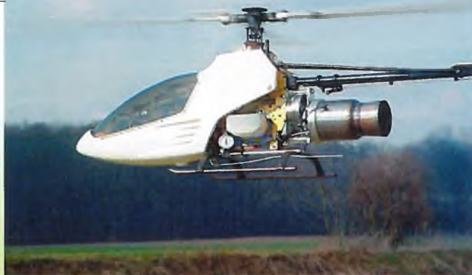
Schwebeflug, das Manometer zeigt 0,5 bar Verdichterdruck
