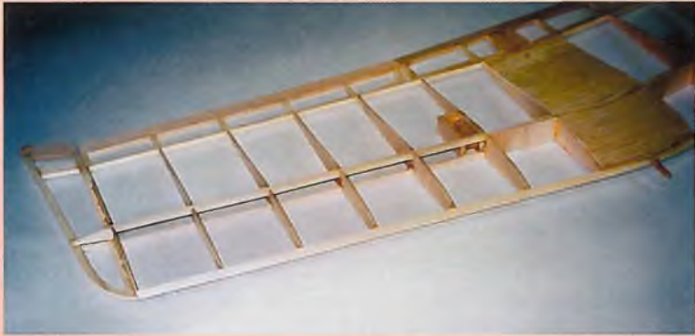
▲ Die Rippenfläche des Willow: fast alles Balsa. Vorne hält ein Buchendübel die Fläche im Rumpf, ...
