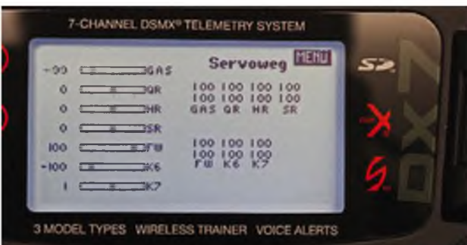
Auch der Servoweg kann für alle Kanäle frei eingestellt werden. Die Anpassung der Servomitte / Laufrichtung erfolgt in weiteren Menüpunkten.
