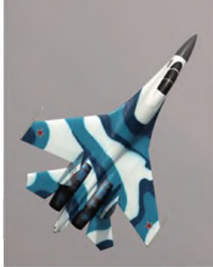
Wahnsinns-Performance: Die neue Su-30 von Ralph Losemann, in Voll-GKF/CFK-Bauweise aufgebaut und mit zwei Turbinen mit Vektorsteuerung ausgestattet.
