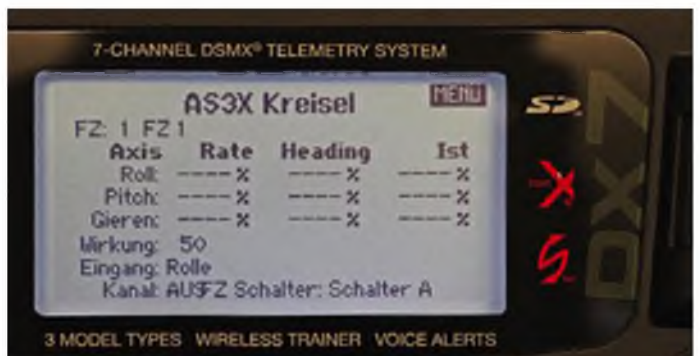
Eine Besonderheit ist das AS3X-Kreisel-Menü. Wird ein solcher genutzt, kann er über diesen Menüpunkt angepasst werden.
