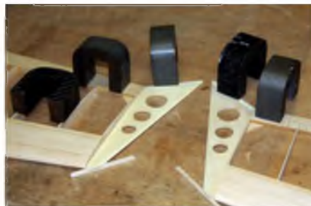
Die Randbögen müssen beim Verkleben vorne unterlegt werden, damit sie die Mitte der Nasenleiste treffen.
