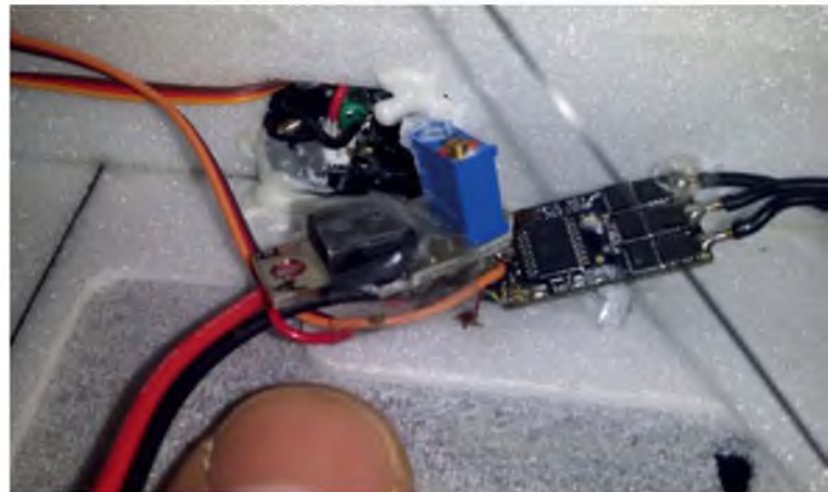
Hinten sieht man den freiliegenden Motor des gestrippten Querruderservos. Davor der Kiss Umpolregler und das Eigenbau-BEC.
