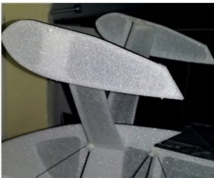
Der Motor wird mithilfe eines GFK-Spantes befestigt. CFK-Streben und Depronecken verhindern ein Verwinden der Rumpfnase durch die Antriebskräfte.
