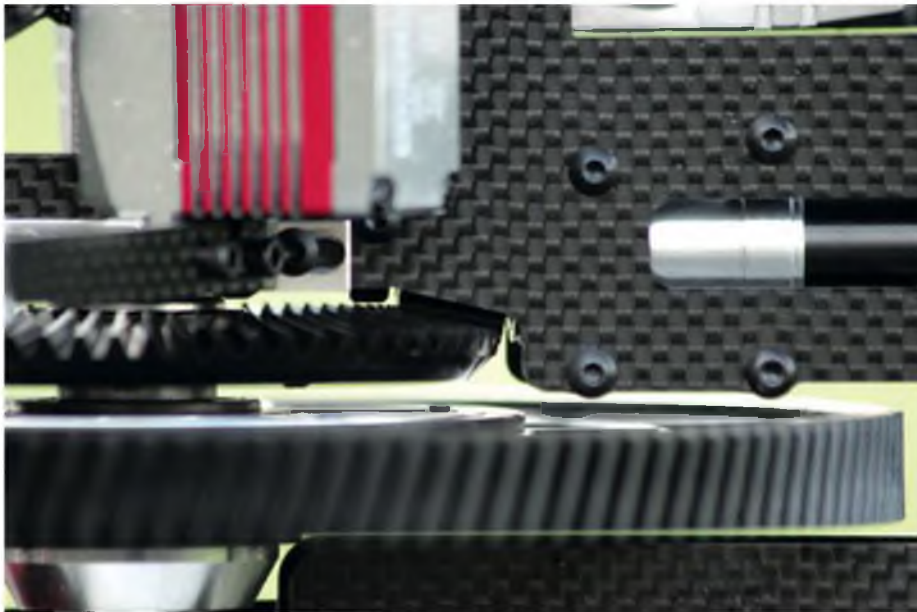
Ein Tellerrad treibt den Starrantrieb an. Das Zahnflankenspiel muss passen. Mit einem dazwischengeschobenen Blatt Papier lässt sich das Spiel gut einstellen.
