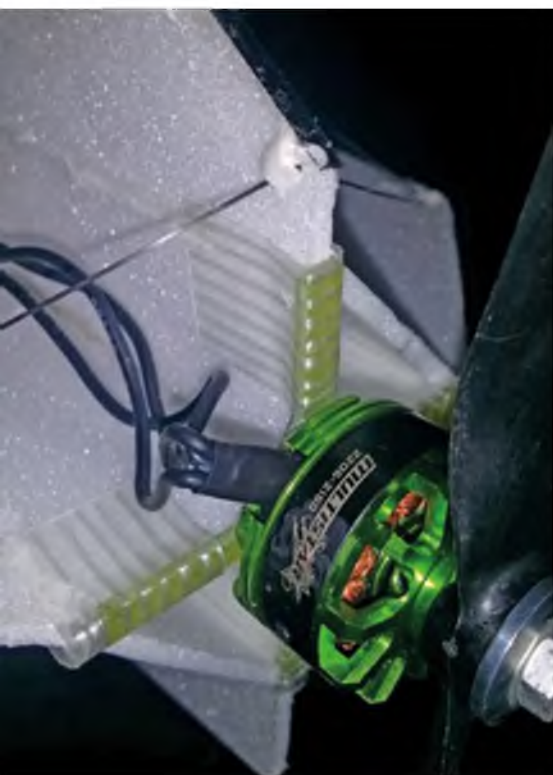
Der Motor wird mithilfe eines GFK-Spantes befestigt. CFK-Streben und Depronecken verhindern ein Verwinden der Rumpfnase durch die Antriebskräfte.
