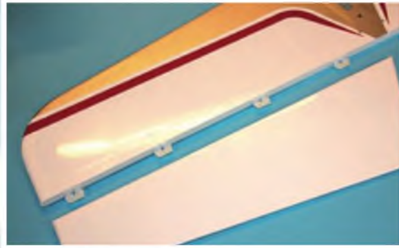
Höhen-, Seiten- und Querruder werden mittels Vliesscharnieren angeschlagen.
