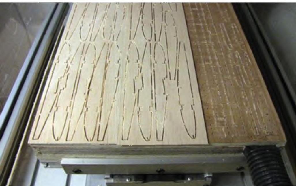
Bild 9: Der Eigenbau-Vakuumschrank im Einsatz.
