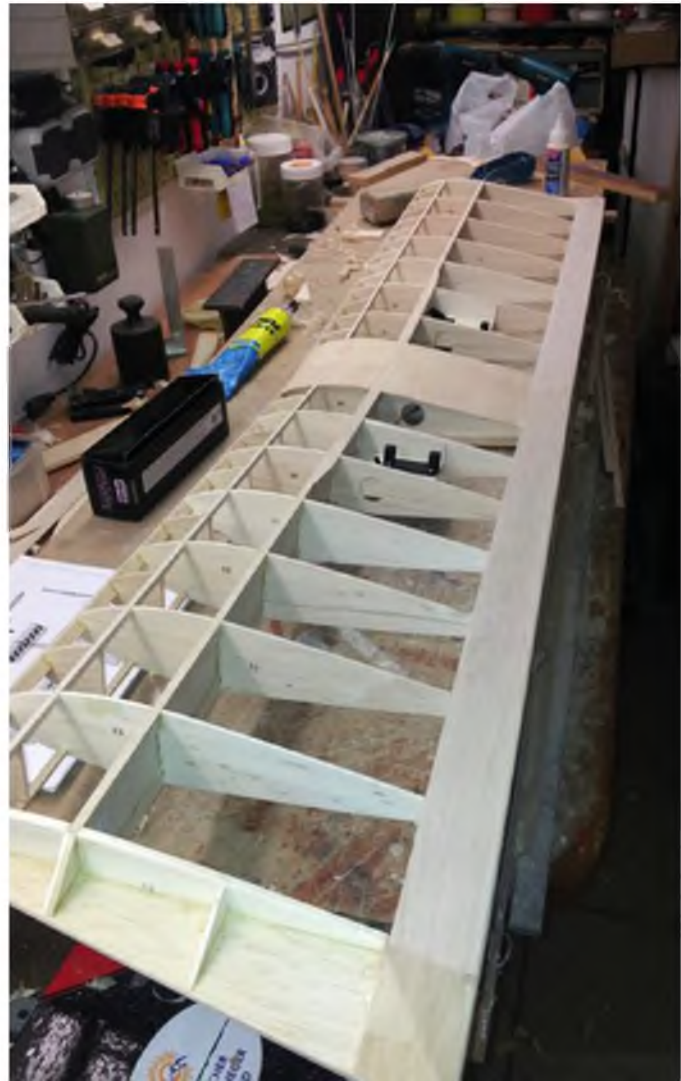
Dann haben doch noch moderne Fertigungsmethoden Einzug gehalten: Der Rippenatz ist CNC-gefräst.
