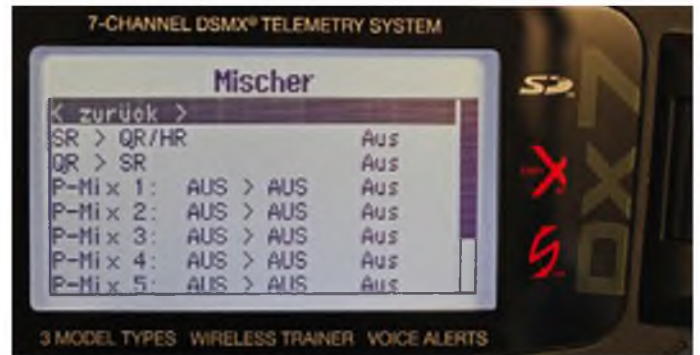
Im Mischer-Menü stehen acht freie und mehrere voreingestellte Mixer (je nach Modelltyp) zur Verfügung.
