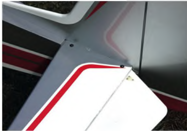
Die Leitwerke werden zunächst mit zwei Schrauben untereinander verbunden und dann mit vier Schrauben auf dem Rumpf befestigt.
