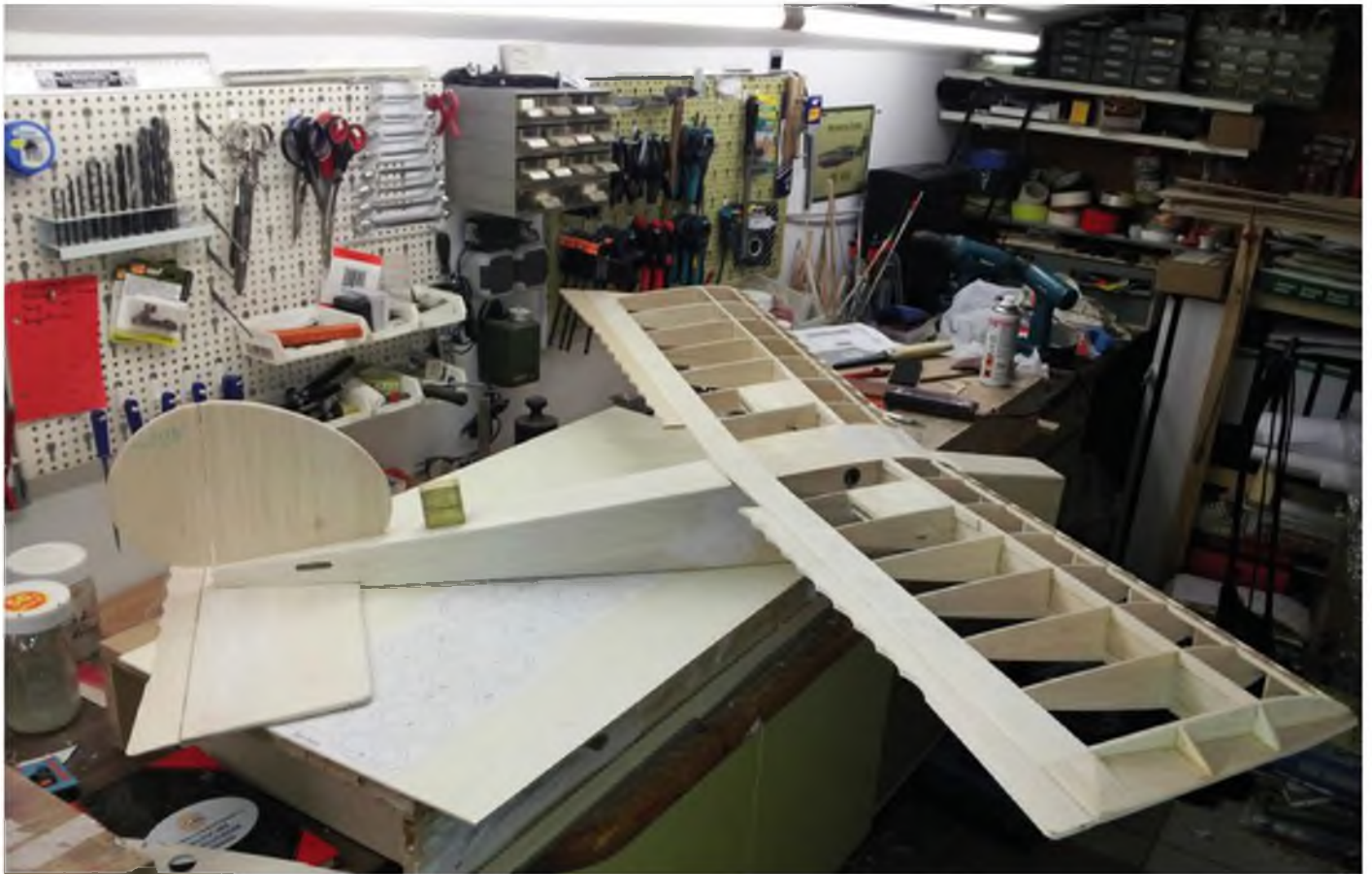
Sieht schon sehr nach Flugzeug aus. Der Rohbau ist geschafft und wartet aufs Bespannen.
