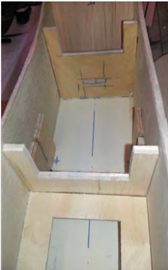
Nach Plan gebaut. Die meisten Holzteile wurden wie damals mit der Laubsäge bearbeitet und mit Weißleim oder UHU-Hart verklebt.
