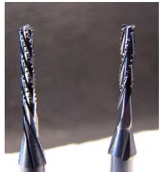
Bild 4: Spiralfräser mit üblicher Schneidengeometrie (rechts) und cut-down-Schliff (links).
