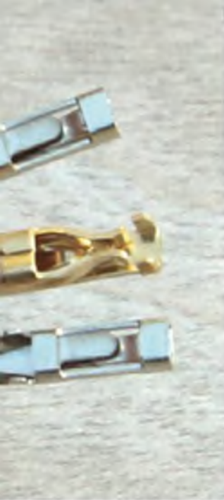
Zwei selbst gecrimpte Stecker im Vergleich zum industriell gecrimpten (Mitte).
