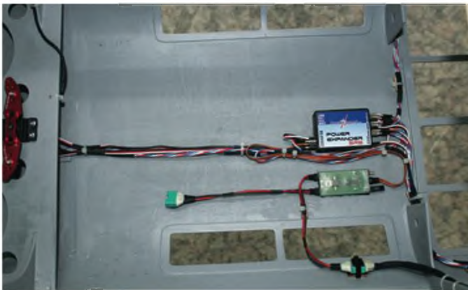
Mit einer Masse von nur 23,6 g kann der Expander ohne besondere Rücksicht auf die Schwerpunktlage an der besten Stelle im Modell installiert werden – hier im Kreuzungspunkt zwischen Rumpf- und Tragflächenverkabelung.
