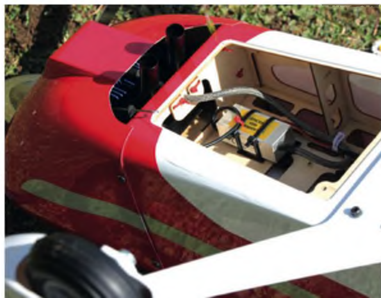
Der Tank wird in einen vorbereiteten Spant eingeschoben und dann durch eine Sperrholzhalterung dahinter fixiert.
