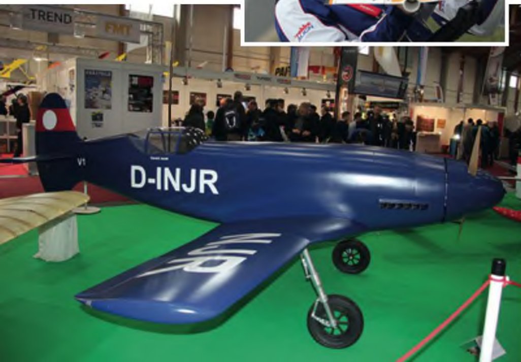
◀ Highlight der Modellausstellung in der Halle: Messerschmitt Me-209, ein Eigenbau von Harald Jezek mit 4,33 m Spannweite, 4,03 m Länge, 80 kg Gewicht und einem 3W-Motor mit 684 cm 3 .
