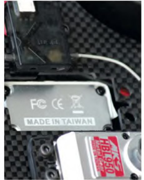
Wer die Servokabel im Inneren des Chassis verlegen will, sollte an dieser Stelle genauer hinschauen. Eventuell scheuern die Kabel am Servo. Daher habe ich das Gehäuse mit etwas Spiegeltape versehen.
