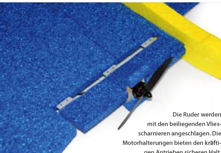
Die Motorzuleitungen sollten wie hier zu sehen in einer leichten Schlaufe verlegt werden, um die Belastungen für das Kabel so gering wie möglich zu halten.
