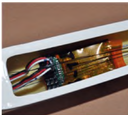
Der modifizierte Empfänger passt exakt unter die Anlenkseile.
