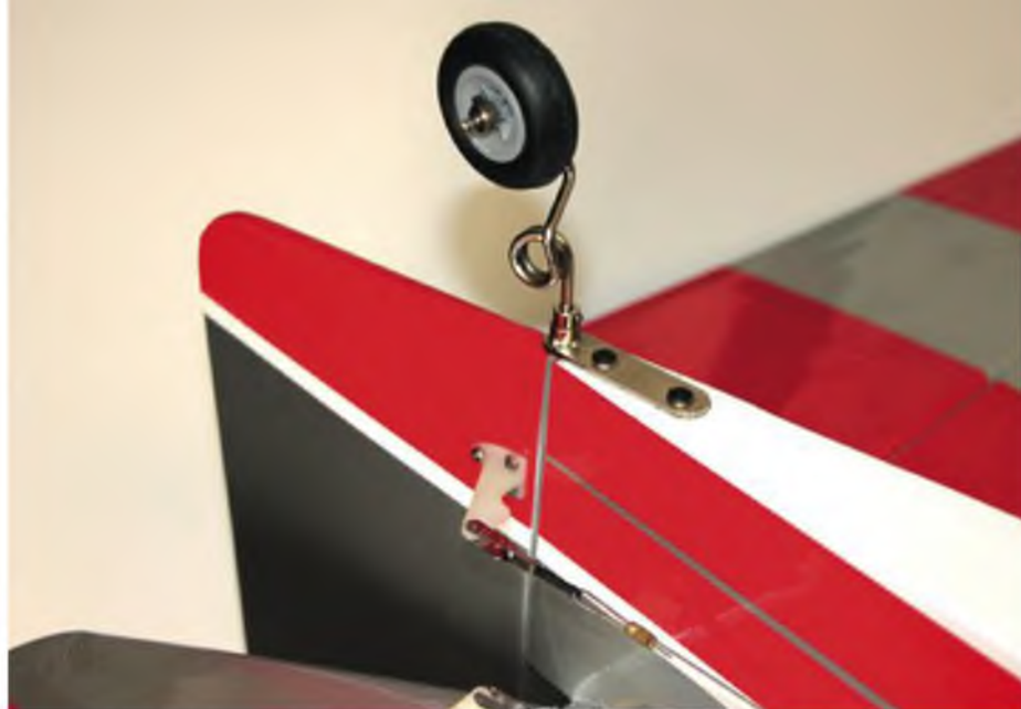
Der Draht des Spornrades muss noch im Seitenruder eingeklebt werden und dient als zusätzlicher Lagerpunkt unten am Rumpf.
