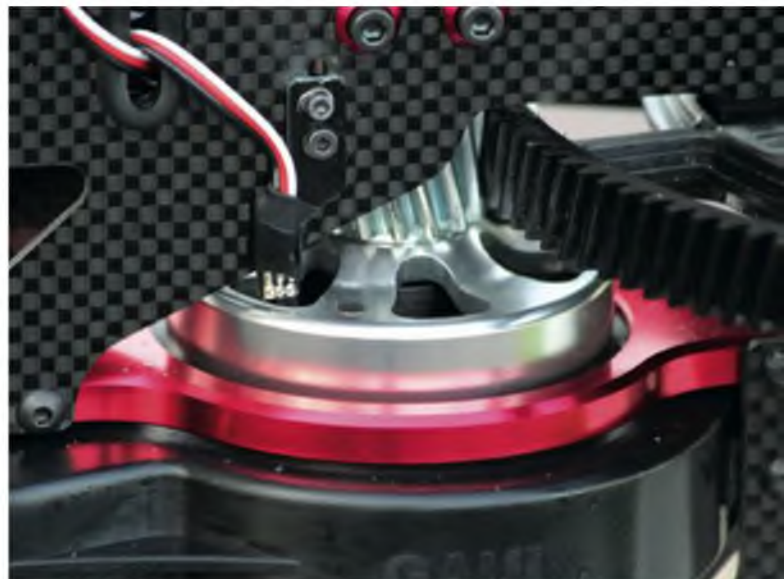
Eine rot eloxierte Alu-Platte versteift das Chassis zusätzlich. Der Drehzahl-sensor wird auf der Außenseite montiert. In der Kupplungsglocke werden die Magnete verklebt.
