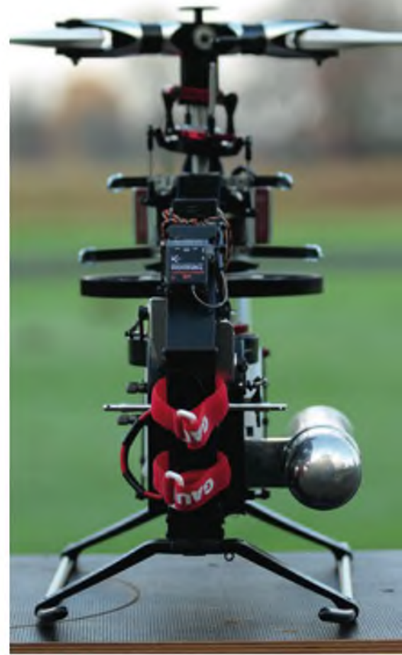
Der schlank aufgebaute Gauji NX7 in der Frontansicht. Ein groß dimensioniertes Hauptzahnrad sorgt für eine gute Umsetzung der Antriebsleistung des Motors.
