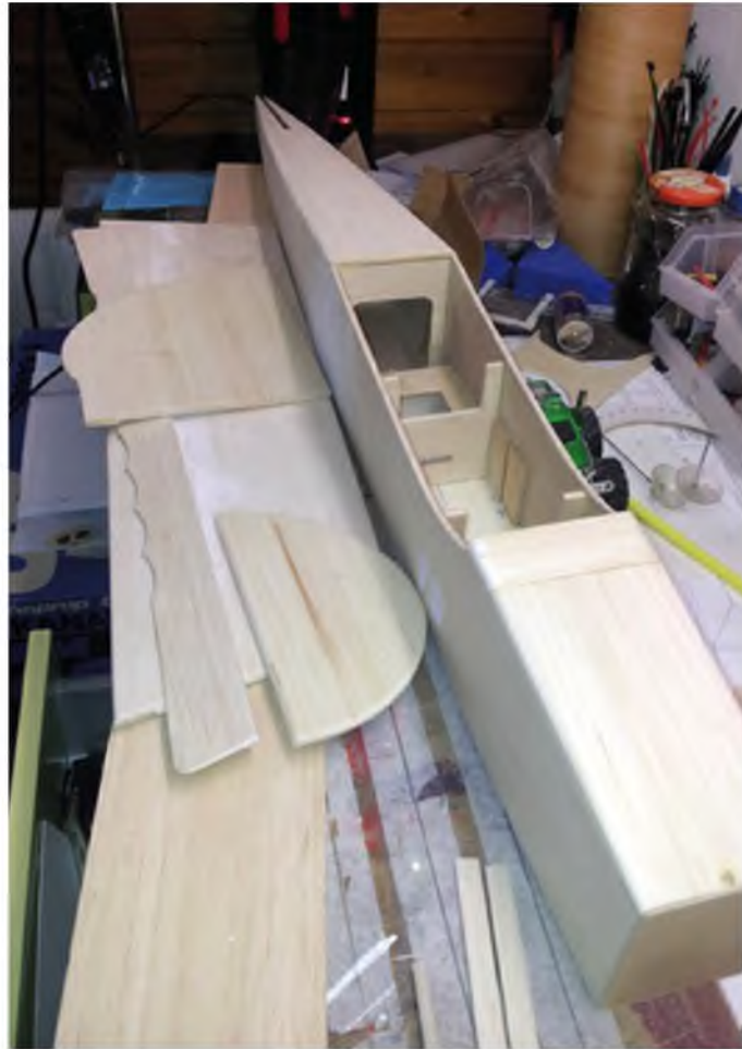
Ein klassischer Holzbau. Hier zu sehen sind der Rumpf und die Leitwerksteile des Middle Stick im Rohbau.
