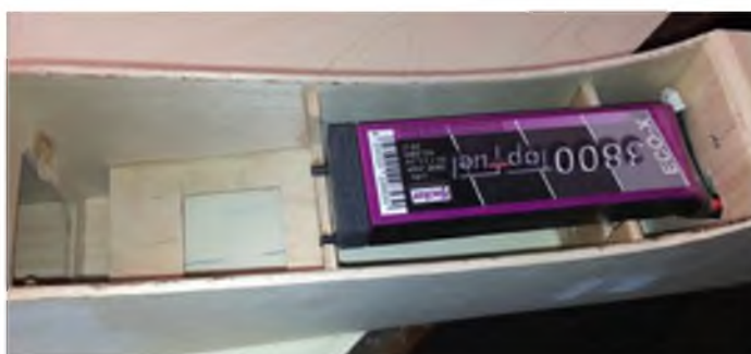
Topfuel statt Methanol-Sprit. Die Energie liefert ein 3s 3.800-mAh-LiPo von Hacker.
