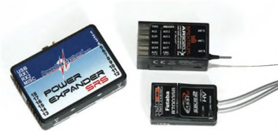
Der Power Expander wird über serielle Signale von den Empfängern bedient. Spektrum und Futaba übertragen 18 Kanäle, beispielsweise mit den Empfängern Spektrum AR 9020 und Futaba R7003SB.
