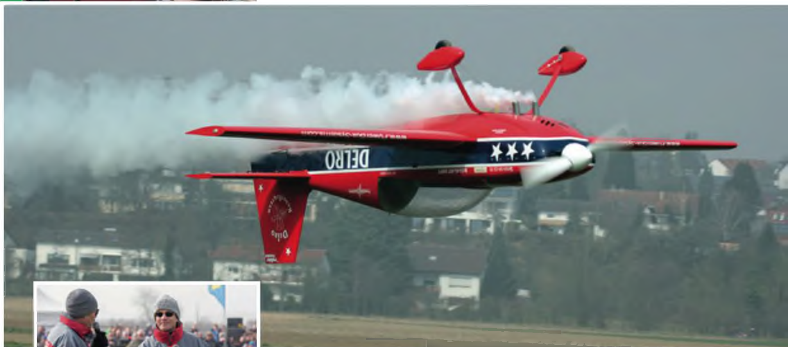
Wahnsinns-Performance: Die neue Su-30 von Ralph Losemann, in Voll-GKF/CFK-Bauweise aufgebaut und mit zwei Turbinen mit Vektorsteuerung ausgestattet.
