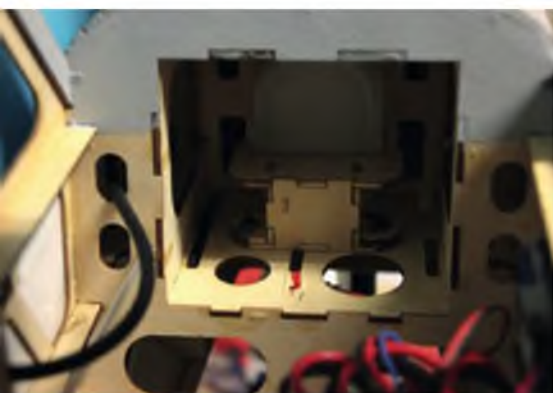
Der Tank wird in einen vorbereiteten Spant eingeschoben und dann durch eine Sperrholzhalterung dahinter fixiert.
