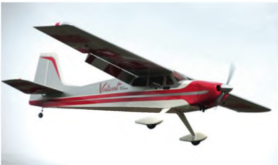
Der realisierbare Ausschlag der Landeklappen ermöglicht eine hohe Bremswirkung für steile Abstiege.
