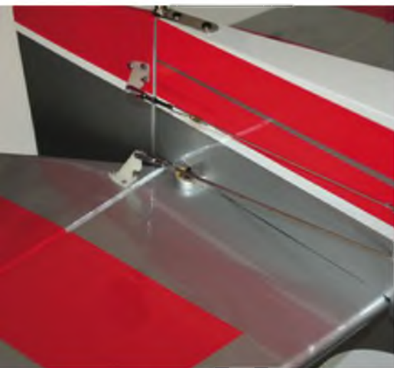
Die beiden Höhenruderblätter werden über je eine Schubstange, das Seitenruder über Stahlilitzen angelenkt. Für beide sind bereits passende Führungsrohe im Rumpf verbaut.
