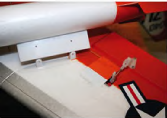
Die Flächentanks passen in entsprechend ausgeformte Halterungen und werden dort zweifach verschraubt. Das eingebaute Servo entspricht dem Lieferzustand, da gibt es nichts weiter zu tun.
