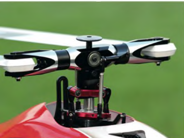
Auffällig ist die gelagerte Blattlagerwelle. Dadurch wird das Schlaglenk im Rotorkopf fest definiert. Eine präzisere Umsetzung der Steuerbefehle resultiert daraus.
