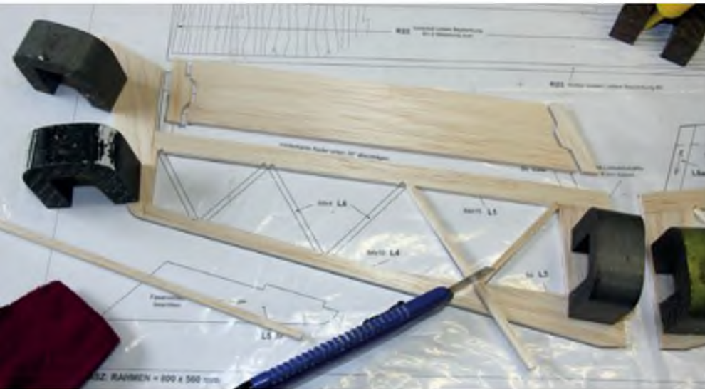
Das Leitwerk ist eine ebene Platte, in der gewohnten Rahmenbauweise.
