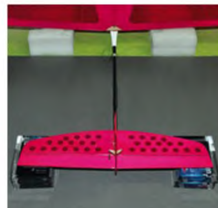
Das Leitwerk klebt man erst rechtwinklig zusammen und fixiert das Ganze dann auf dem Leitwerksausleger.
