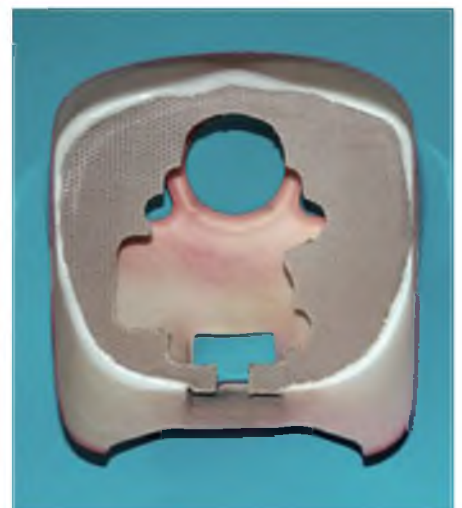
Für die Luftleitplatte findet sich auf dem letzten Blatt der Anleitung eine Schablone. Das Teil entstand aus einem Reststück Wabenplatte und wurde mit eingedicktem Harz verklebt.
