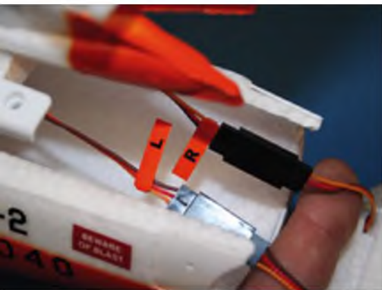
Die Anschlüsse der Höhenruder-Servos sind deutlich gekennzeichnet, da dies für die korrekte Funktion des Kreisels vonnöten ist.
