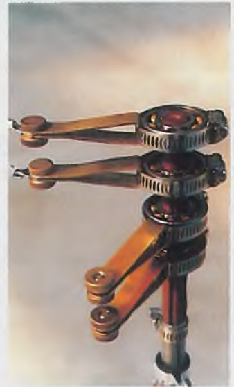
Ein bißchen wie aus der Werkstatt eines Modelleisenbahners: Der Pylon und Detailbild der rotierenden Stromabnehmer
