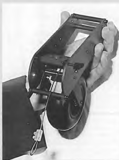
Die Verbindung zum Servo geschieht bei der Hock'schen Fahrwerksbremse durch ein Stahlschleif, dessen Ende mit einem Servo verbunden wird.
