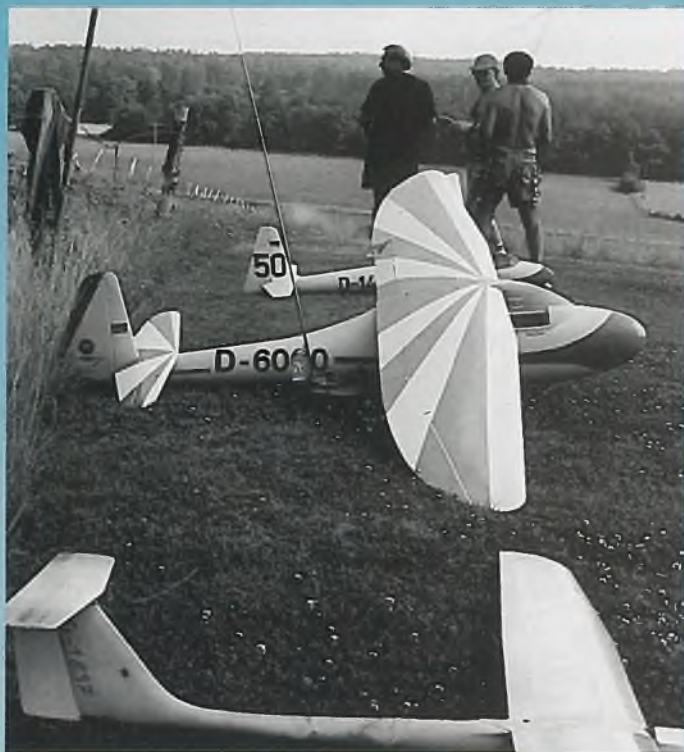
Bei aufwendigen Modellen wie der großen LO 100, gibt es für die Software der mc-4000 schon einiges zu tun. Das Ende ihrer Leistungsfähigkeit ist jedoch auch hier noch lange nicht erreicht. Die LO 100 wird mit Hilfe der Flugzustandsumschaltung mit drei verschiedenen Rudereinstellungen für den F-Schlepp, den Kunstflug und die Landung geflogen. So ist es möglich, auch solche nicht ganz unproblematisch zu fliegende Modelle, für die verschiedenen Flugaufgaben zu optimieren und dadurch die Flugleistungen zu steigern
