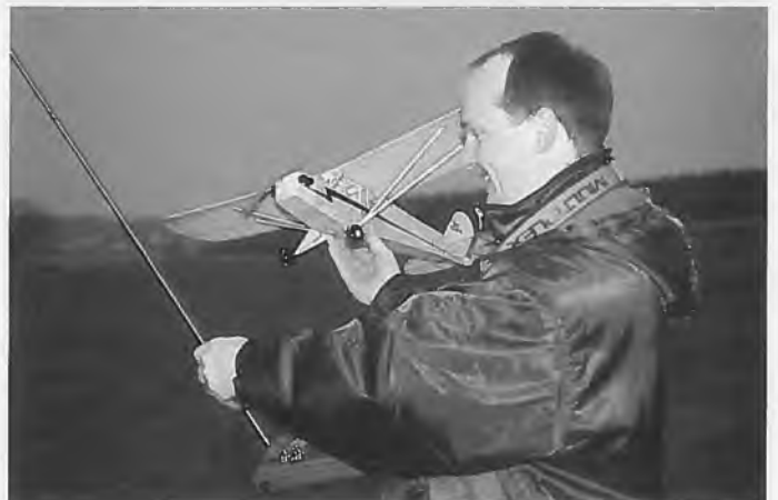
Beim Winterfliegen in Halberstadt gesehen: eine Piper J-3 Cub mit 90 cm Spannweite und ganzen 300 g Fluggewicht. Präsentiert wurde das Modell von K & K Modellbau, Halberstadt. Für den Vortrieb sorgte die Getriebe-Einheit 'Mücke' (Modellbau Groß, Göttingen) 6 : 1 untersetzt und 8 Zellen 250 mAh; Flugzeit etwas über 5 Minuten
