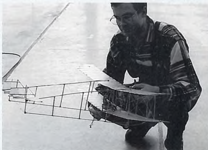
Ein edles Scale-Modell, Nachbau einer Caudron A1, Antrieb Speed 400 mit Getriebe
