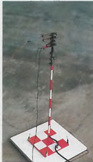
Ein bißchen wie aus der Werkstatt eines Modelleisenbahners: Der Pylon und Detailbild der rotierenden Stromabnehmer
