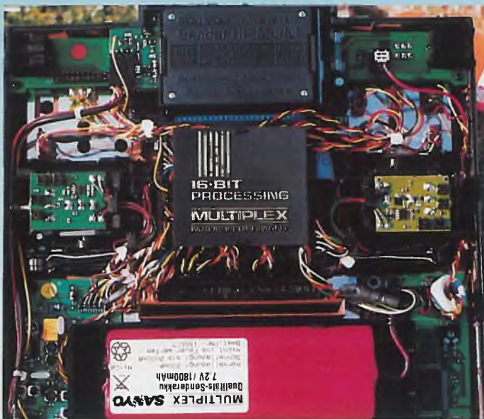
Das Innenleben des Senders. Links neben dem Akku ist die Platine des Scanners eingebaut, rechts das Sprachausgabemodul. Der Schnellladefähige 1800mAh Akku erlaubt eine Betriebszeit von etwa 4,5 Stunden. Oben in der Mitte sitzt das leicht wechselbare HF-Modul
