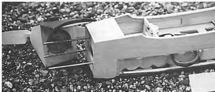
Praktisch: Der abnehmbare Motorblock. Drei Alu-Gewindestangen sind im Rumpf eingearzt, in der Rumpfnase mit Motor sind drei Aluröhrchen montiert. So kann die ganze Einheit nach Lösen von drei Muttern abgenommen werden.
