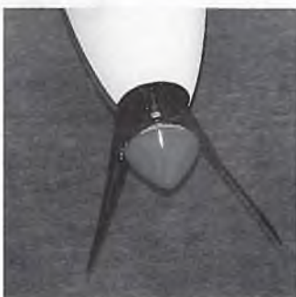
Die Rumpfspitze ist bereits grob abgestüzt. Mit einer ringförmigen Montageschablone, die mit 2 Gewindestangen fest gegen den Rumpf gezogen ist, wird der Übergang zum Spinner exakt in Kreisform gedrückt und mit einem Schleifhorn genau auf Maß geschliffen. Auf dem Gehäuserohr des Teleprop sind die beiden Endlagenschalter aufgeklebt (berührungslose Hall-Sensoren).
