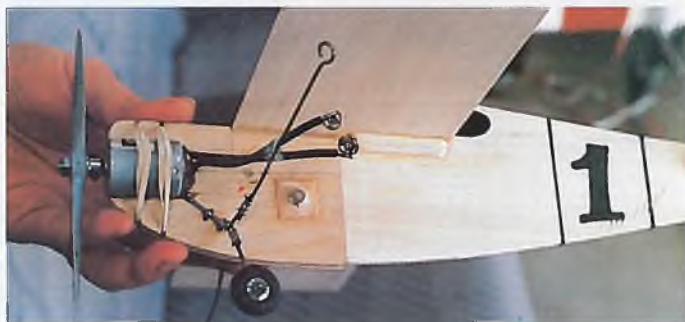
Einfacher geht es nicht mehr: Ein Balsa-Brettchenmodell, ein kleiner, mit Gummiringen gehaltener E-Motor, Druckknöpfe aus dem Textilgeschäft als Steckverbindung
