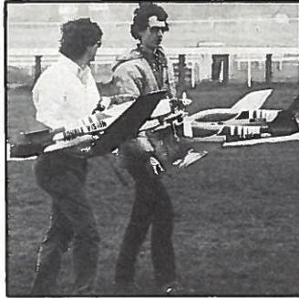
**Double Vision** hießen diese Kreationen von „Clive Hall Models“, GFK-Doppelrumpf mit zwei 40er Motoren, ohne Fahrwerk und sehr schnell. Eine robuste Konstruktion, die auch die nicht sehr sanften Landungen „auf dem Bauch“ vertrug
