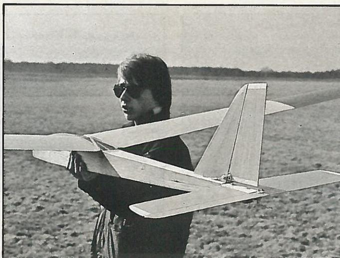
Hochstarthaken habe ich an der angegebenen Position eingeklebt und bis heute keine Veränderung vornehmen müssen. Der Hochstart am Gummiseil klappt einwandfrei und ohne Ausbrechen, nach dem Ausklinken hat der Domino einen flachen Gleitwinkel und marschiert auch noch gut bei mittelstarkem Wind. In der Thermik kann eng gekurvt und schnell Höhe gewonnen werden.
