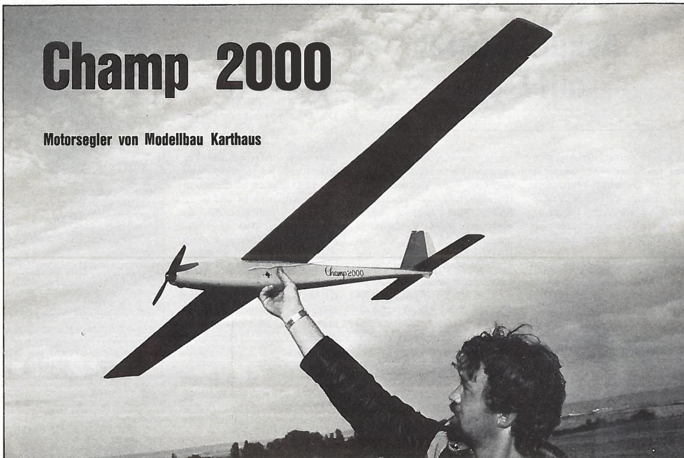
Dieses Modell ist für Antrieb mit Verbrennungs- oder Elektromotor vorgesehen, beim Verbrenner wird ein 3,5 ccm Triebwerk vorgeschlagen, das Testmodell wurde mit einem leistungsfähigen 2,5er bestückt.
