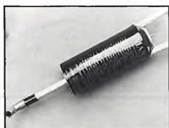
Der 250-cm 3 -Dämpfer wie in der Skizze aufgeschnitten dargestellt; er wiegt unter 95 Gramm
