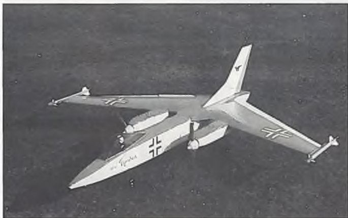
H.269 „Red Tigershark“, ein vorgepfeilter Nurlügel mit 2 Motoren. Technische Daten: Spw. 1600 mm, Länge 1860 mm, Gewicht 4350 g, Flügelfläche 27,2 dm 2 , Flächenbelastung 92 g/dm 2 , Motoren 2 × OS Max 6,5 ccm
