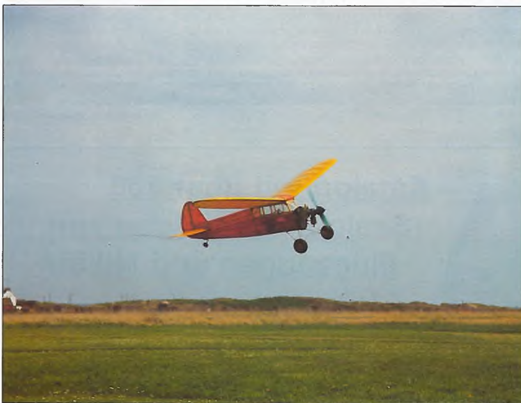
Die MS Bee von Oldiespezialist Brian Park. 1,20 m Spw., 0,8 m Länge. Plan 1945, Modell 1968, Motor 1947, FROG 180 mit Original-Laufgarnitur!!!
