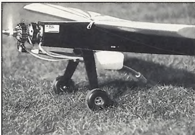
Für die „Säuer“ unter den Motoren, aber auch für Langzeit- und Langstreckenflieger: der Außentank
