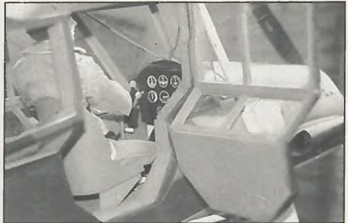
Brian Baxters Fieseler Storch. 2,32 m Spw., 1,52 m Länge, 61er-Gold-Cup. Fahrwerk gefedert, Vorflügel funktionsfähig.
