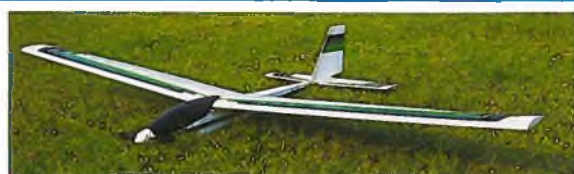
Eagle-Ep RC-Elektrosegler mit Mabuchi RS540 SH-Motor und Klappflugschraube. Spannweite 1700 mm, Rumpflänge 940 mm, Tragflächeninhalt 31,87 dm 2 , Gewicht 850-1049 g, RC-Funktionen: Höhe, Seite, Motor, Akkus. 6-7 NC-Zellen 7,2 V/1,2 Ah. Fertigmodell in Balsa/Rippenbauweise.
