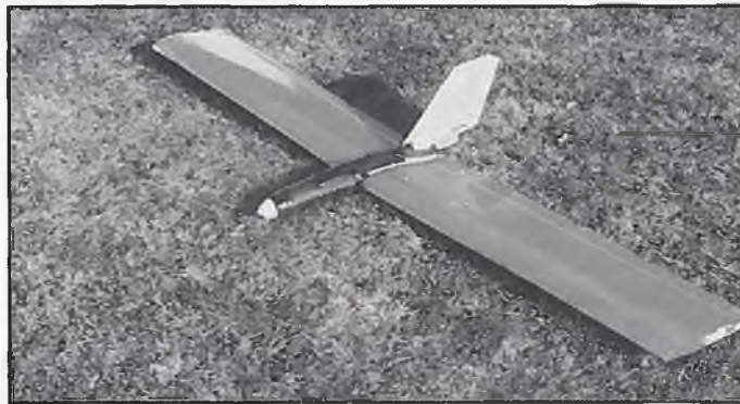
Die Friedhofsvase als Modellrumpfskeule eines Thermikseglers ...
