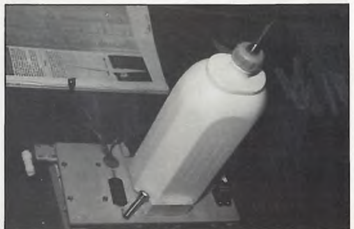
Die Platte mit wesentlichen RC-Teilen sowie der Wasserballast-Anlage. Ein kräftiges Servo steuert ein Kunststoffventil an. Der eigentliche Wasserbehälter, eine 1,5-l-Flasche, ist auf der anderen Seite des Sperrholzbrettes montiert
