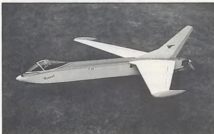
„Blizzard“ mit Tandemmotoren. Spannweite 1600 mm, vollsymmetrisches Profil
