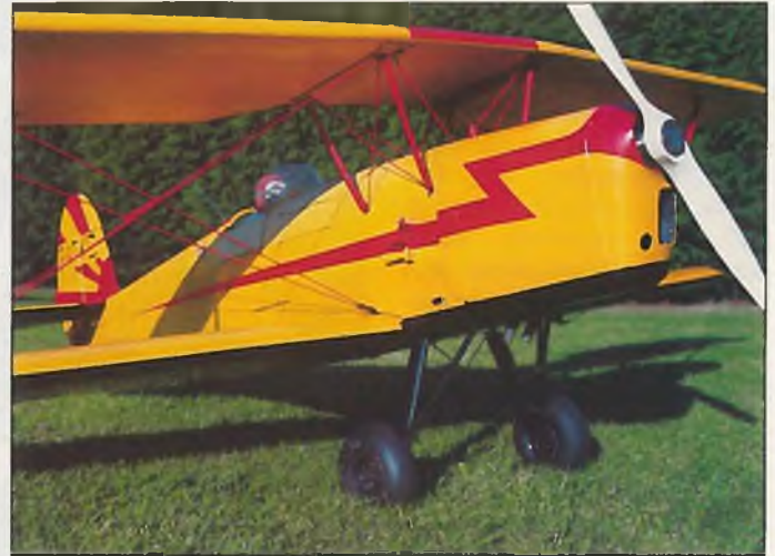
Stampe SV 4B. 2,05 m Spw., 1,74 m Länge, 6,7 kg, 35 ccm Quadra, Prop. 20 x 7. Bausatz von Precedent, Rippenflächen. Querruder in beiden Flächen. Vorbild fliegt beim Tiger Club in Redhill, Surrey.
