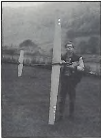
Die Friedhofsvase als Modellrumpfskeule eines Thermikseglers ...
