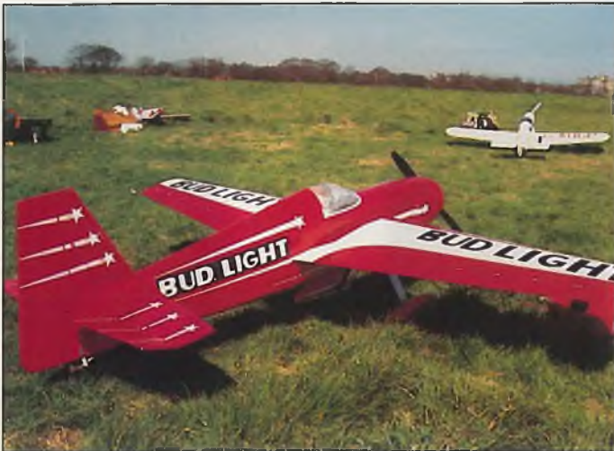
Ted Allison's Laser Super Star. Bausatz besteht aus Plan und Flächen. 35 ccm Quadra, Rauchanlage wird mittels Motorgehäusedruck betrieben.
