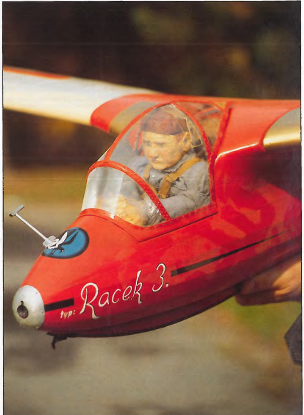
Viele, viele Stunden sind in die Kabinenhaube eingeflossen: Allein an die 80 kleine Alunierten mußten eingesetzt werden
