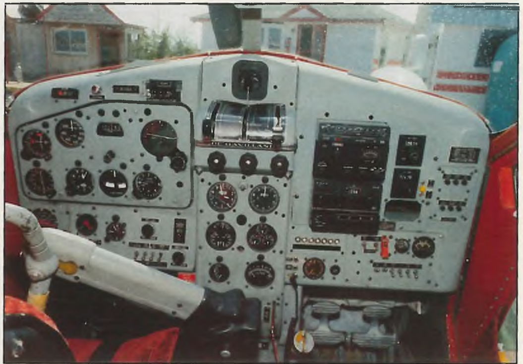
Das Cockpit: Mittig angeordnet das Steuerhorn, das vor beide Sitze geschwenkt werden kann
