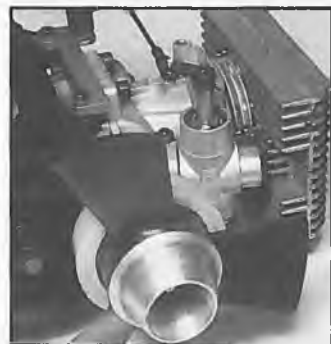
Der Kühlkörper ist unten ausgefräst, damit der Motor weniger erhitzte Luft ansaugen kann.
