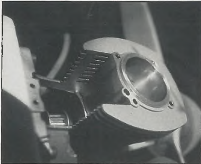
Vom Zylinder ist vor allem die Lauffläche im Bereich des OT thermisch und mechanisch hoch belastet, hier zeigt sich Mangelschmierung besonders schnell.
