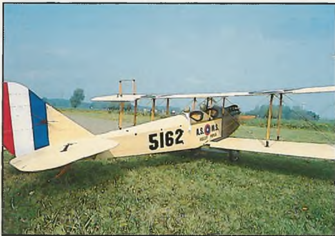
Mit 4 000 mm Spannweite, Maßstab 1:4 ein wirklich großes Modell der Curtiss JENNY baute Detlef Sewing. Zunächst mit einem 38 ccm-Benziner ausgerüstet, soll nun ein 90 ccm-Reihenmotor eingebaut werden.
