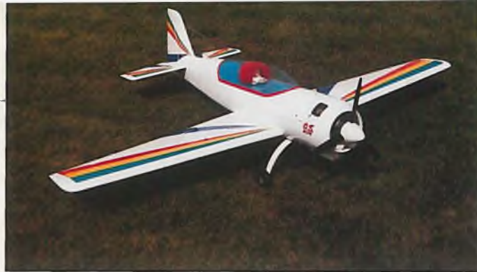
"Hier bin ich" - Sukhoi Su 29 von HAFU in voller Größe: Spannweite 2,10 m, Rumpflänge 1,65 m
