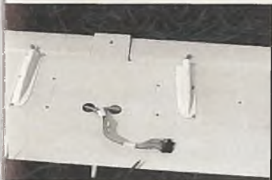
Vier Servos in der Fläche fordern ihren Tribut: Ein Kabelbaum ist unter Dach und Fach zu bringen.
