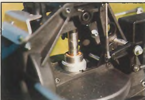
Modifizierter Freilauf und Distanzbuchsen unter dem Rollhebel
