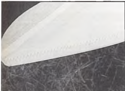
Ganz wichtig, der Zackenband-Turbulator. Am Außenflügel (unten und oben) angebracht, läßt er die Strömung länger anliegen und verbessert dadurch die Ruderwirksamkeit
