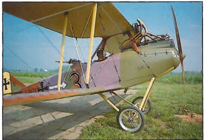
Rumpler C I V (1917) von Jörg Vogelsang. Bis auf die Flügelrippen eine Metallkonstruktion. Spannweite 3 300 mm, Gewicht 18 000 g, Motor 2-Zylinder 110 ccm SOLO
