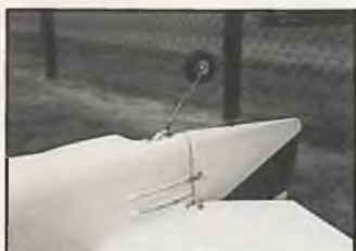
Detaillösungen für Ruderanlenkungen und Spornrad: die Dämpfung des Rades übernimmt ein 0,8-mm-Stahldraht von ca. 10 cm Länge.
