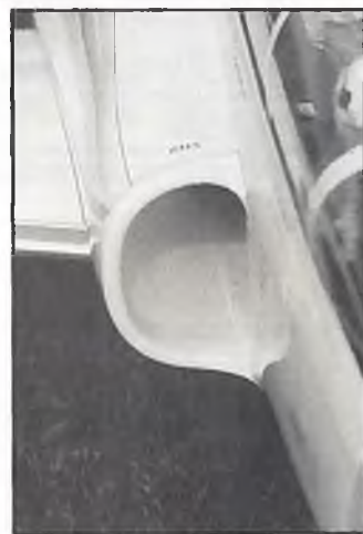
Der schallgedämpfte Einlaufkanal des Maverick als Anregung für alle Bastler: Die Löcher sind etwa einen Millimeter groß und fünf Millimeter auseinander. Die Berelche, in denen Kraftstoff austreten könnte, sind nicht perforiert, damit er nicht in das dahinterliegende Schaumgummi gelangen kann
