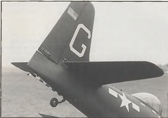
◀ Die Ausführung verdient Bestnoten: Innenanlenkung der Ruder, deren saubere Aufhängung in Hohlkehle, die Beschriftung, der Fanghaken
