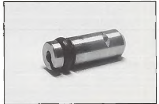
Dieses Röhrrchen sitzt auf dem Drosselkücken des Vergasers; eine Verunreinigung an dieser Stelle kommt seltener vor.
