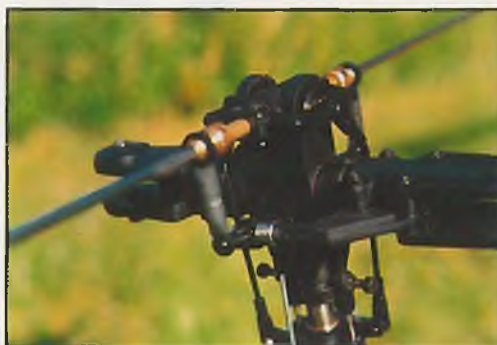
Abstandstücke am Blatthalter mit verlängertem Doppelkugelgelenk
