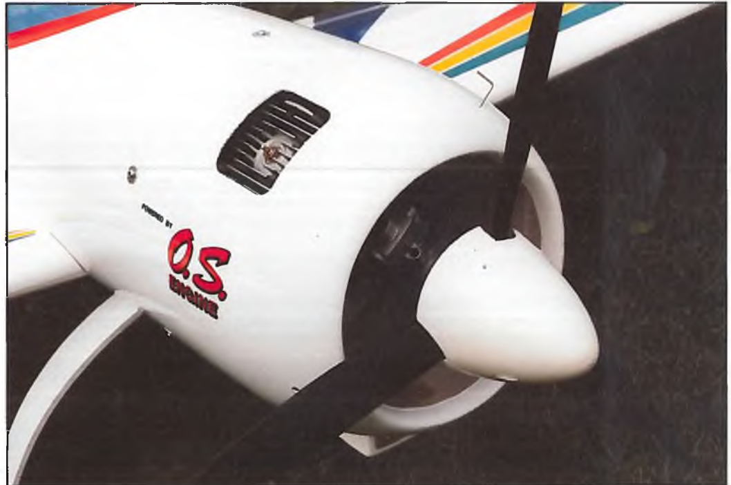
Eine saubere Sache: der OS-BGX mit 35 ccm verschwindet gänzlich unter der Motorhaube. Seine Leistung ist für alle Kunstflugfiguren ausreichend.
