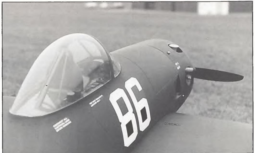
Scale das Cockpit, scale die Beplankungsbleche mit Vernietung
