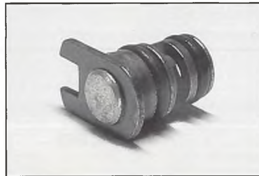
Die Reglerkulissee für den Leerlauf. Hier findet man oft Verunreinigungen, die sich mit einfachem Durchspülen des Vergasers nicht beseitigen lassen.
