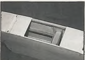
Durch diese große Öffnung an der Rumpfunterseite, die mit einer dünnen Balsaklappe verschlossen wird, lassen sich später die Akkus in Sekundenschnelle wechseln.
