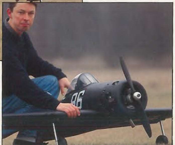
Von den beiden, nach unserem Bauplan möglichen Versionen ist dies die große, mit 2,3 m Spannweite und 12 kg Fluggewicht. Motor 50 cc, und daher Kraft reichlich
