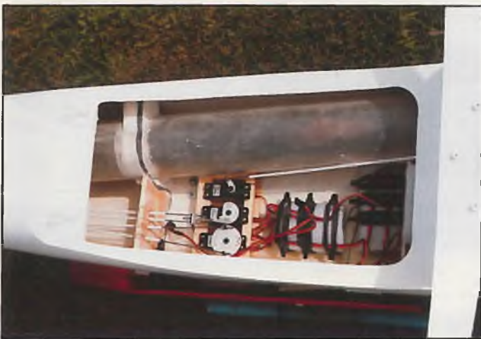
Nicht nur außen "hul": das Reso-Rohr ist im Rumpf in einer GfK-Schale verlegt, Platz für alle anderen Einbauten bleibt immer noch reichlich.
