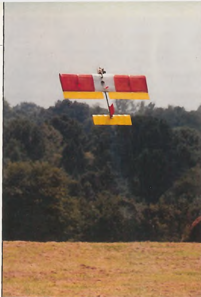
Pendelleitwerk wie bei diesem Modell erhöht die Wendigkeit zusätzlich
