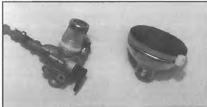
Links ein Luftfilter, das wenig tauglich ist: Die Filteroberfläche ist sehr klein. Rechts ein für den gleichen Vergaser selbstgedrehtes Filter mit großer Oberfläche
