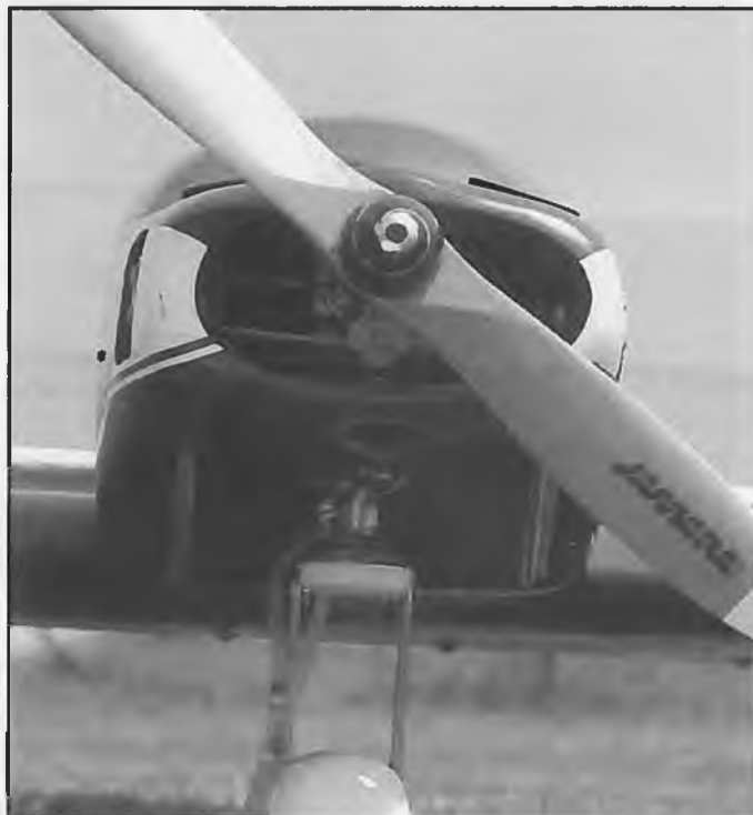
Die Ansaugluft liegt unmittelbar im Bereich starker Propellerverwirbelungen
