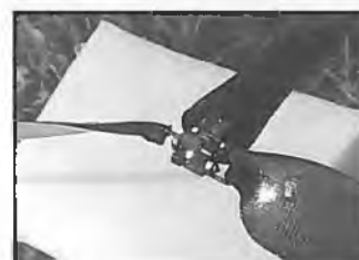
Der Verstellpropeller am Nurflügel von F.-J. Ney. Seine kompakte Mechanik verschwindet völlig unter dem Spinner. Um den Blattstellwinkel an die jeweilige Fluggeschwindigkeit anzupassen, hat Franz-Josef Ney eine spezielle Regelung: Bei mehr Spannung am Motor (entspricht höheren Fluggeschwindigkeiten) wird die Luftschraube automatisch auf mehr Steigung gestellt
