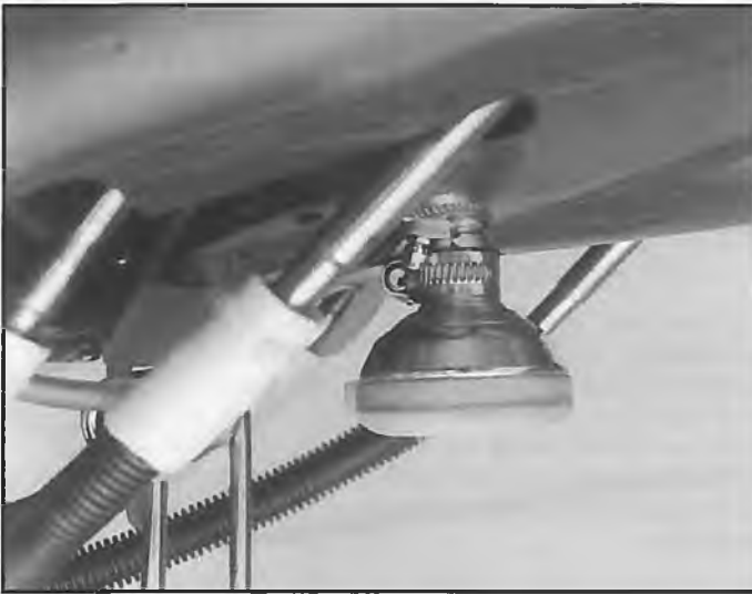
Beim senkrecht von unten ansaugenden O.S. »Pegasus« wurde das Eigenbau-Filter montiert
