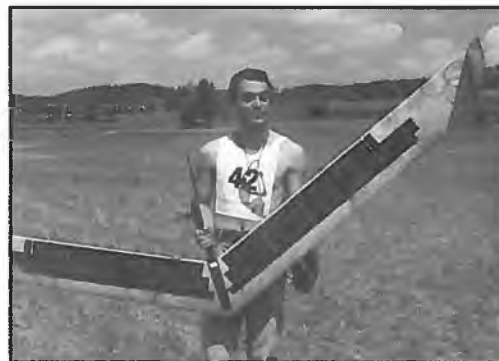
Der ungepufferte Solar-Nurflügel von und mit Bernd Bossmann: Spw. 2,5 m, Gewicht 1180 g! Der Flügel wurde in gefrästen Negativformen gebaut. Installierte Solarleisten 56 W. Der Glockenankermotor von Edwin Bloch soll 4% besser im Wirkungsgrad sein als der vergleichbare Maxon-Treibling (92 statt 89%). Die Solarzellen (Labormuster von der Fraunhofer-Gesellschaft Freiburg) erreichen 19% Wirkungsgrad. Das Modell fliegt schon bei unter 20% Einstrahlung.
