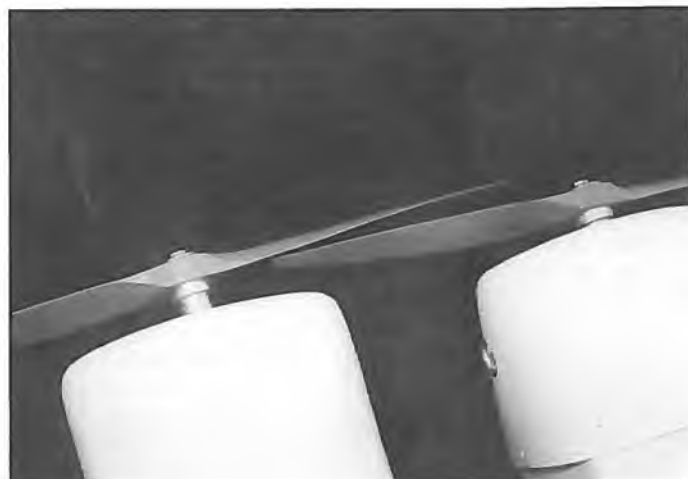
Nicht empfehlenswert, den zweiten Motor per Hand anzuwerfen! Er, der linke, nach vorn versetzt, wird mit Seil gestartet
