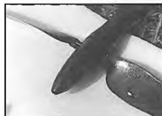
Der Verstellpropeller am Nurflügel von F.-J. Ney. Seine kompakte Mechanik verschwindet völlig unter dem Spinner. Um den Blattstellwinkel an die jeweilige Fluggeschwindigkeit anzupassen, hat Franz-Josef Ney eine spezielle Regelung: Bei mehr Spannung am Motor (entspricht höheren Fluggeschwindigkeiten) wird die Luftschraube automatisch auf mehr Steigung gestellt
