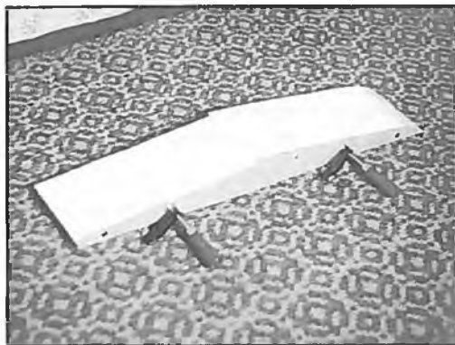
Der Viererpack nach erfolgtem Schnitt. Anschließend sind einzeln die Kielflächen zu bearbeiten
