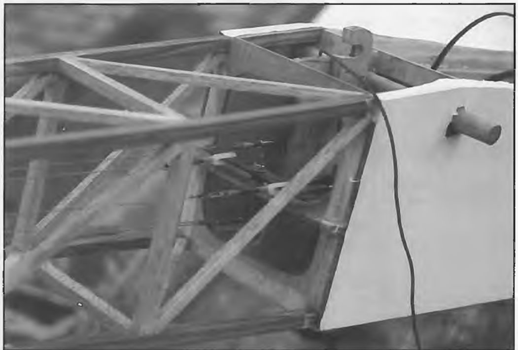
Der hintere Teil des Rumpfes besteht aus offenem Gitterwerk. Gut zu erkennen ist auf dem Foto eine der Wippen, über die die Stahllitzen mit dem Servo verbunden sind
