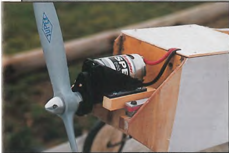
▲ Jenny elektrisch: Speed 600 mit Getriebe 2,5:1
