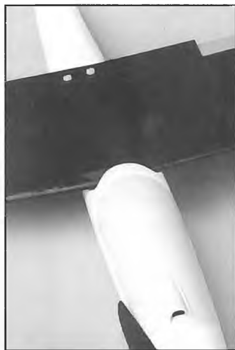
Fläche verschob sich regelmäßig bei der Landung: die Markierung auf der Fläche zeigt die Mitte an. In der Luft gab's keine Verschiebungen.
