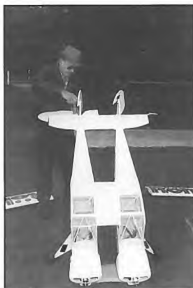
Für den PKW-Transport wird das komplette Doppelleitwerk abgenommen; lediglich die beiden Rumpfe bilden eine feste Einheit
