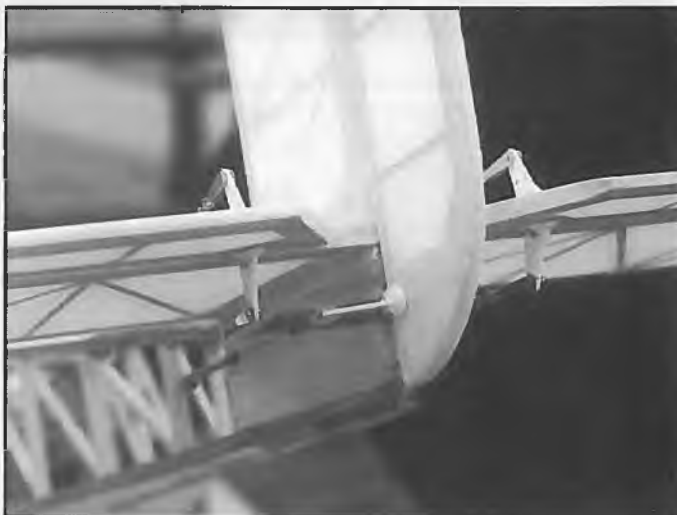
Die Ruder sind mit Stahllitze angelenkt, deshalb werden mehr als eine Handvoll Ruderhörner benötigt.
