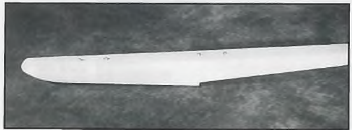
Der fertige Schwimmer vor der Oberflächenbehandlung: Bügelfolie oder Spritzen mit Ein- oder Zweikomponentenlack
