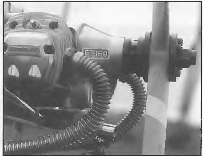
Manchmal ergeben sich aber Platzprobleme für den Filtereinbau: Wenn z. B. die Choke-Klappe im Wege steht oder der Raum einfach zu knapp ist
