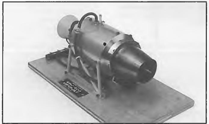
Die EMJ-200 „Viperjet“ - Gasturbine des jungen Niederländers Gerald Rutten überzeugt durch die handwerklich perfekte Verarbeitung aller Komponenten
