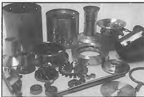
Diese Teile gehören alle zur EMJ-200. Das Aluminium-Verdichterrad ist inzwischen gegen ein hölzernes Laufrad, wie auch in der Schreckling-Bauplanturbine, ausgetauscht worden, um eine geringere Hochlaufzeit zu erreichen
