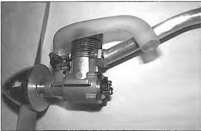
Der Motor OS-Hanno II als Teil des Antriebssystems. Propeller 13 x 11, langer Krümmer und „Long Chamber“-Resorohr von Hatori. So könnte der 2-Takt-Standardantrieb der laufenden, vielleicht auch der zukünftigen Wettbewerbsaison bei uns aussehen
