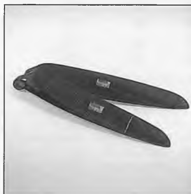
◀ Ragnar Sanftenbergs 15,5x8 Zoll CFK-Latte war frei von jeglichem Steigungsversatz
