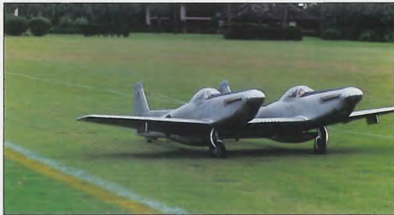
▲ Die F 82 „Twin Mustang“ von Art Johnson ist ein vollständiger Eigenbau, inklusive Einziehfahrwerk. Dies ergibt bei Top Gun jedoch keine Sonderpunkte. Das große Modell wird mit zwei OS 1.08 Zweitakt- Methanolmotoren angetrieben und wiegt 14 Kilogramm
