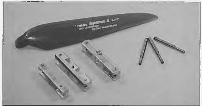
▶ Robbes rote „Dynamik-E“ der Größe 14,5x7 Zoll mit dem Namenszug des mehrfachen Elektroflugweltmeisters Rudolf Freudenthaler; ihre Steigung lag 0,75 Zoll unter den Angaben des Herstellers
