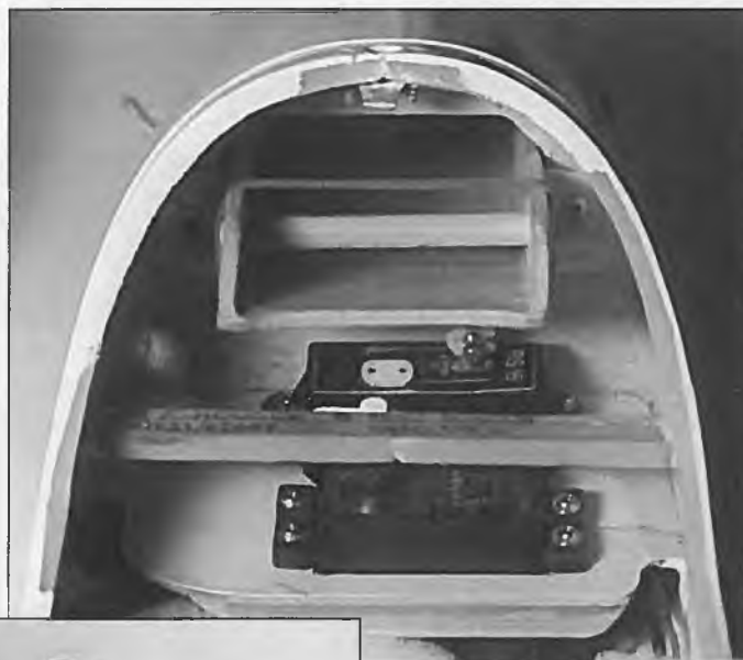
Der Akkuschacht. Die Lage der Antriebsbatterie muß so ausgewählt werden, daß nach dem Aus- bzw. Einbau des kompletten Antriebs der Schwerpunkt unverändert bleibt
