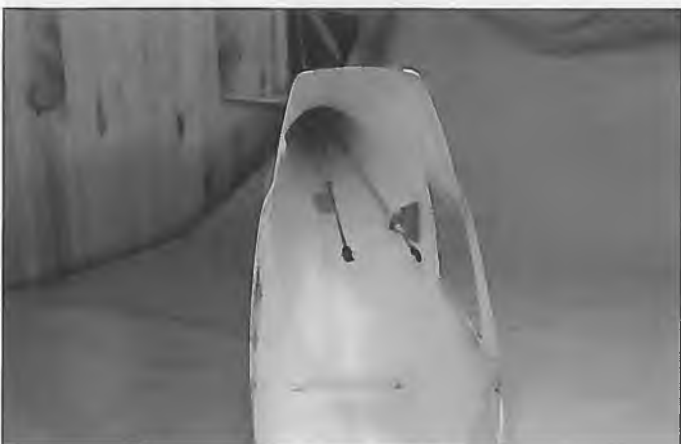
Das fertige Rumpfhinterteil ohne Mechanik. In der Mitte der Heckantrieb, rechts die Hecksteuerung mit einer etwas größeren Holzabstützung, als der Plan vorsieht
