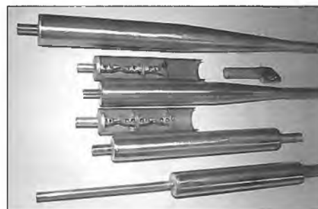
Alle Greve-Schalldämpfer auf einen Blick: Groß, aber mit ca. 230 g immer noch leicht, das ganz neue Resonanzrohr für 2-Takter ab 15 cm 3 nach dem ab 1996 geltenden F3A-Reglement. Rohrdurchmesser 50 mm. Die Schnittmodelle zeigen die neu entwickelten Dämpferteile der 2- und 4-Takt-Rohre
