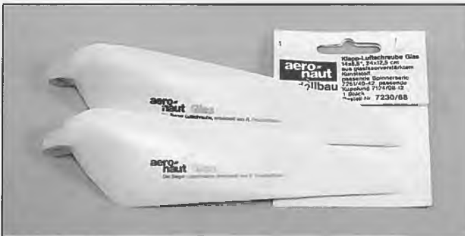
▶ Diese 14x8,5 Zoll Latte stapelte unbekümmert hoch. In Wirklichkeit lag ihre Steigung um 3,5 Zoll unter den Herstellerangaben
