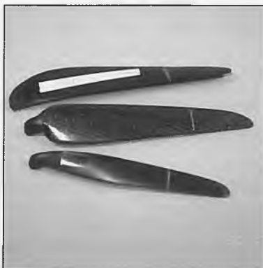
▶ Drei „reinrassige“ CFK-Latten; oben die GSI von Schüberl mit exakter Maßhaltigkeit, dann eine Freudenthaler 15x6,5 Zoll mit einer tatsächlichen Steigung von 8 Zoll, während die 14x8,5 U von Falco darunter lediglich mit 0,5 Zoll unter den Angaben lag
