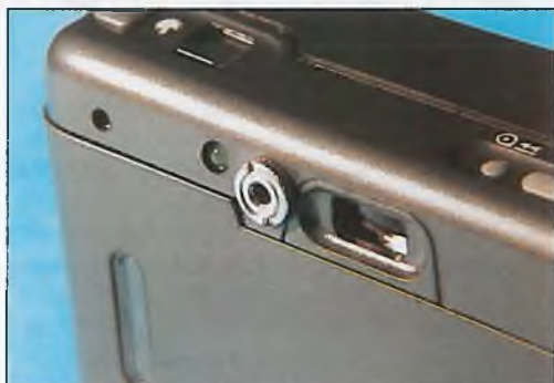
Eine kleine Modifikation mit großer Wirkung: die 2,5-mm-Klinkenbuchse
