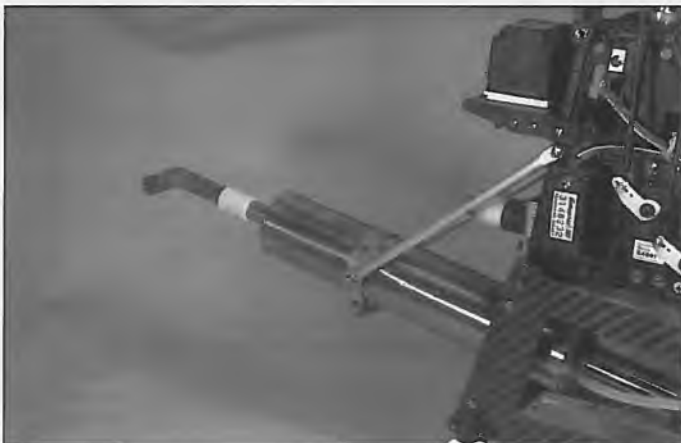
Das Resorohr ist durch diese Stützen fest mit der Mechanik verbunden und braucht keine weitere Auflage oder Ähnliches.
