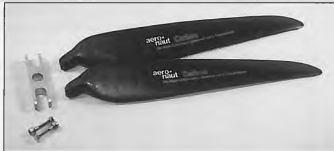
▶ Robbes rote „Dynamik-E“ der Größe 14,5x7 Zoll mit dem Namenszug des mehrfachen Elektroflugweltmeisters Rudolf Freudenthaler; ihre Steigung lag 0,75 Zoll unter den Angaben des Herstellers
