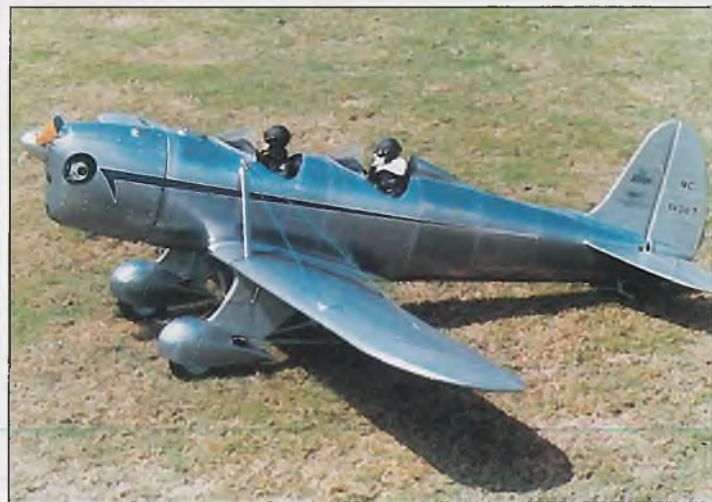
▲ Metallbauweise? Bei dieser Ryan STA von John Chevalier (1/4-Scale) ist der Metalleffekt durch einen Trick erzielt worden, und zwar durch den Auftrag einer Aluminiumpaste aus dem Künstlerbedarf
