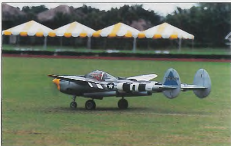
▲ „Mama's Boy“, die P 38 - Lightning des Teams Florenze/Mears hat im Maßstab 1/6 ganze 2,5 Meter Spannweite. Zwei Mokl 25 ccn Motoren verleihen der Maschine adäquate, aber nicht spektakuläre Flugleistungen. Der Baukasten und das auf hydraulischen Betrieb umgebaute Einziehfahrwerk stammen von Yellow Aircraft. Ohne Zweifel eines der Favoriten unter den „Prop's“
