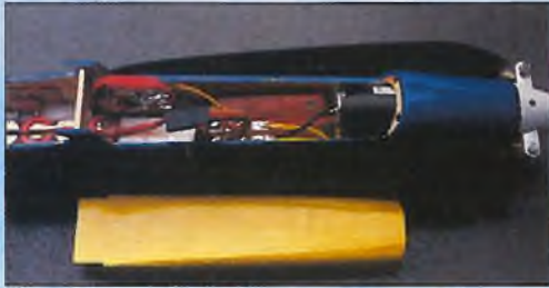
Im vorderen Teil des Rumpfboots, dessen größte Breite 38 mm beträgt, sind Triebwerk, Solarflugregler, Anschlußplatte (rechts) und Längsregler (links) untergebracht.
