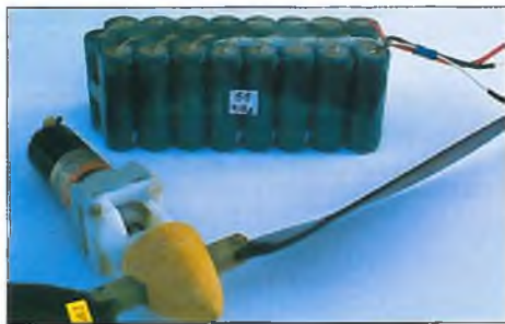
▲ Gut für fünf Stunden und mehr: 24 Sanyo HR-AU, Maxon RE 025-055, Marx Pile 6:1 und Schöberl Moskito.
