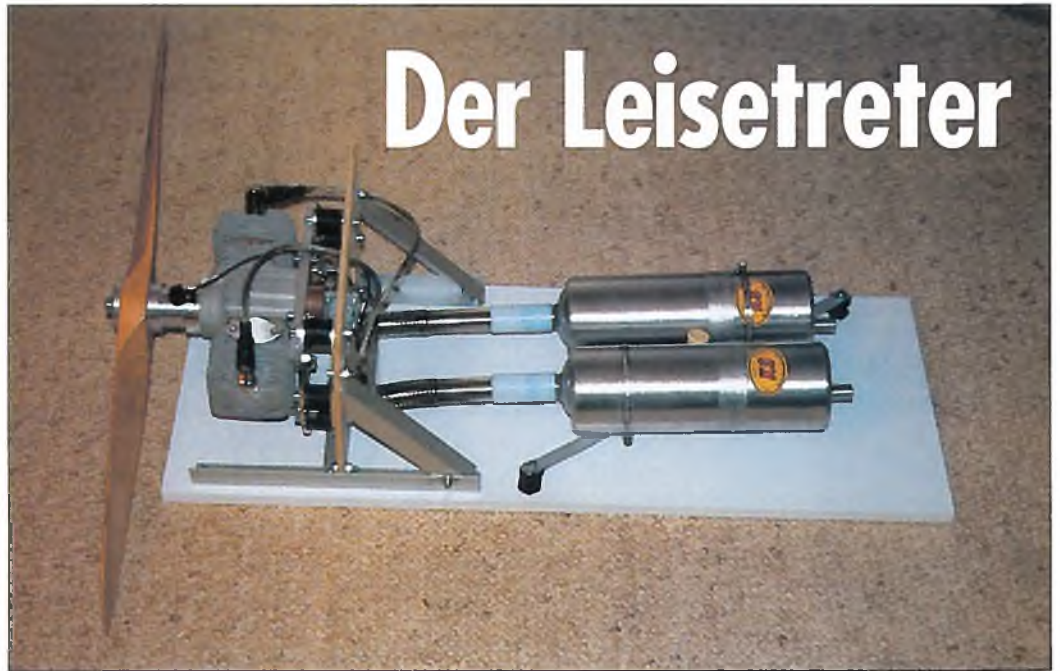
Probeaufbau (Mock-up) des 90-cm 3 -Boxermotors der Firma Meiß mit 7-Kammer-Dämpfern aus Aluminium von Krummscheidt sowie Schwingmetallaufhängung. Dieser Aufbau läßt sich in einer Frisch-Wilga unterbringen und wird dort einem weiteren Praxistest unterzogen.
