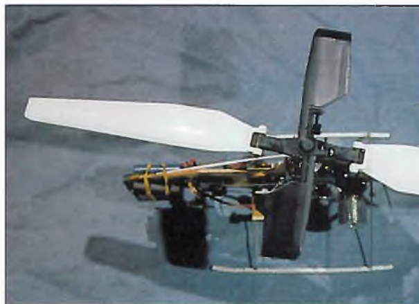
▲ Der Motor ist hängend eingebaut, der Auspuff zeigt dabei nach unten. Der Schieber im dünneren Teil ist die Drossel des Motors. Der großzügige Kühlkopf ist bis etwa 30° Außentemperatur voll ausreichend.
