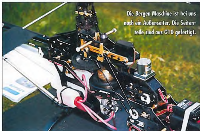
Der Viertakter von Vario zeigte sich als äußerst ruhig und relativ durchzugskräftig.
