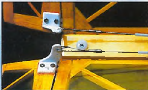
Die Steuerstangen aus 0,8-mm-Stahldraht lassen sich durch die federnden Sicherungen aus 0,5-mm-Stahldraht schnell anlenken und lösen. Auf- und Abbau des Leitwerks werden so erleichtert.
