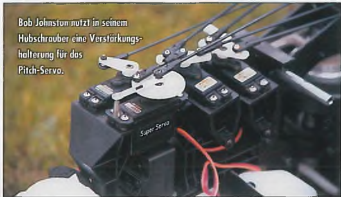
Gut zu erkennen ist der Verzicht auf eine Push-Pull Anlenkung in Youngbloods Maschine.
