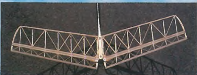
Einige Konstruktionsdetails des V-Leitwerks sind im Rohbau deutlich zu erkennen. Nicht sichtbar sind die Scharniere unter der geteilten Grundplatte, die es ermöglichen, die Leitwerkshälften wie die Seiten eines Buches in die Ebene aufzuklappen. So beansprucht das sonst sperrige Leitwerk weniger Raum für den Transport.
