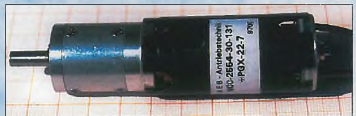
Der aufgefärbte Motor bildet mit dem einstufigen Planetengetriebe eine Triebwerkseinheit, die sich gut für die widerstandsarme Auslegung des Rumpfkopfes eignet. Die Durchmesser von Welle, Getriebe, Motor sind 5/22/25 mm.
