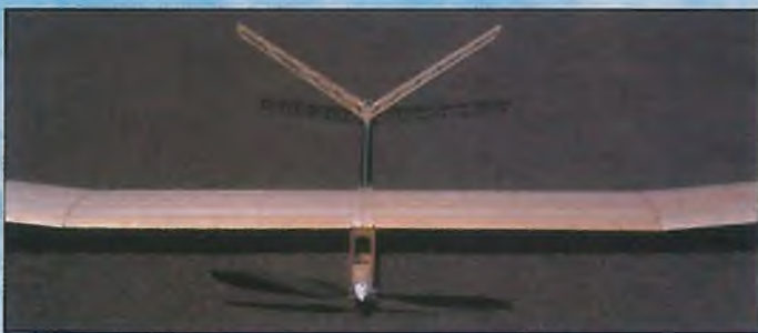
Der Propeller ist mit 460 mm Durchmesser auffällig groß. Auf dem an der Oberseite durchgehend beplankten Flügelmittelfstück zeichnen sich die Reihen der Lötunkte ab.
