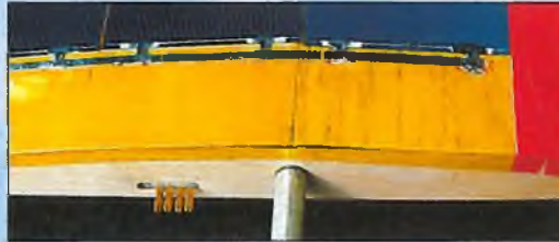
Im linken Flügel sind die Steckelemente für die Flügelverbindung verleimt. Der Polystyrolstab von 6 mm Durchmesser überträgt die mechanischen Kräfte, der vierpolige MPX-Stecker sorgt für die elektrische Verbindung zwischen den Flügeln.
