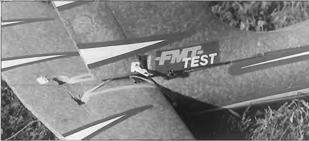
Die Anlenkung des Seitenruders kann mittels des Stellringes exakt eingestellt werden. Unter den Befestigungs-Gummiringen des Höhenruders erkennt man die 10 Gramm Trimmblei.
