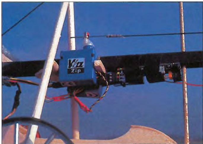
▲ Die beiden Volz-Mikro-Servos und der Simprop „Nano“-Empfänger (ohne Gehäuse) im Detail.
