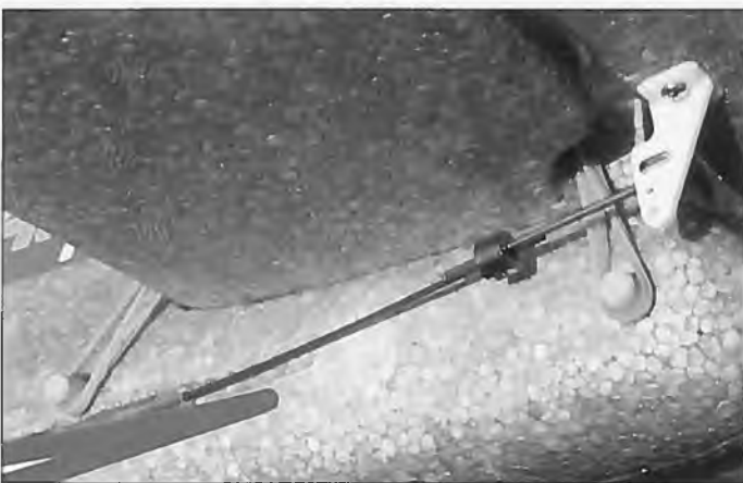
Die Anlenkung und die Befestigung des Höhenruders mit den eingesteckten Rundhölzern am Rumpfe.
