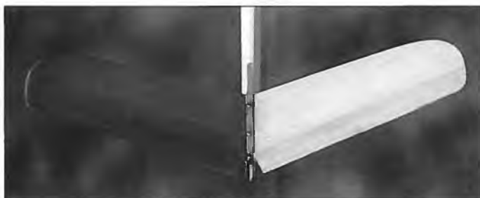
Vorgesehen ist eigentlich ein Kreuzleitwerk. Aus Gewichtsgründen und zur Erhöhung der Bodenfreiheit bekam allerdings ein V-Leitwerk den Vorzug.
