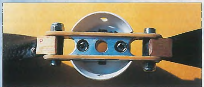
Ein Gummiring (Robbe 9112) sichert das Anklappen der langen Propellerblätter. Wenn der Spinner etwa 2 mm über das Alu-Mittelstück hinausragt, ist damit eine begrenzte Führung für den Gummiring gegeben. Die Blattwurzeln müssen die gleiche Höhe haben wie die Gabeln des Mittelstücks, um ein Einklemmen des Gummis zu verhindern.
