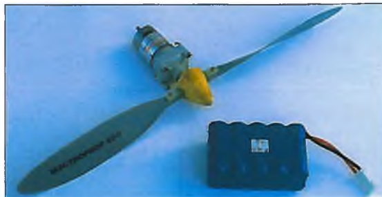
Der Antrieb des Solar-Excel: zehn Zellen Sanyo HR-AU, Simprop PS1500-10, Getriebe 3:1, Graupner Elektroprop
