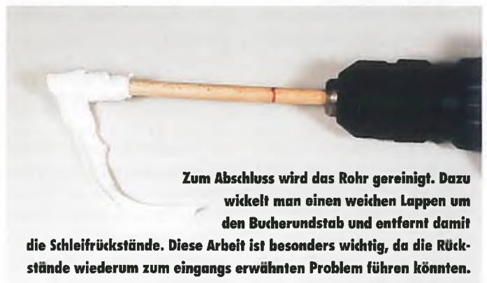
Achtung: Die Laufrichtung der Bohrmaschine bzw. des Akkuschaubers muss stimmen, sonst wickelt sich das Schleifpapier vom Stab ab.
