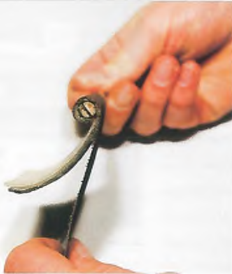
Um den Durchmesser zu vergrößern, kann man dünnes Schaumgummi zwischenlegen und mit aufrollen.
