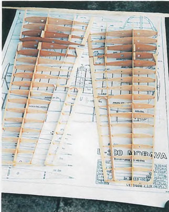
▲ Rohbaufertig: Die Flächen sind leicht und stabil, und besitzen nur dort Verstärkungen, wo es nötig ist.
