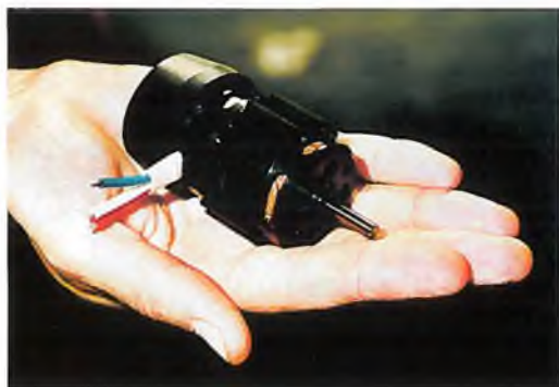
Spitzenmotor der Serie HP 220 Brushless mit Kevlarmierung des Rotors
