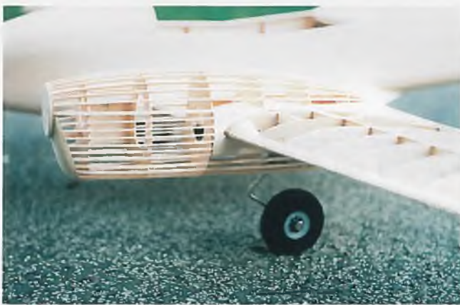
▲ Die fertige Motorgondel wird an die Tragfläche angepasst; erst wenn sie perfekt sitzt, wird der Übergang zur Fläche beplankt.
