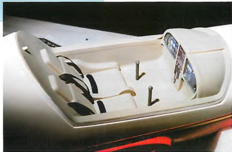
▲ Mit wenig Aufwand lässt sich ein ansprechendes Cockpit erstellen: Instrumente aus einer Luftfahrtzeitschrift ausgeschnitten, Sicherheitsgurte aus Dekoband, Steuerknüppel aus Bowdenzug-Außenrohr mit Stecknadelkopf. Kostenpunkt: Null!
