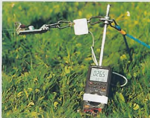
◀ Die Seilkraft-Messeinrichtung von Dieter Köhler.
