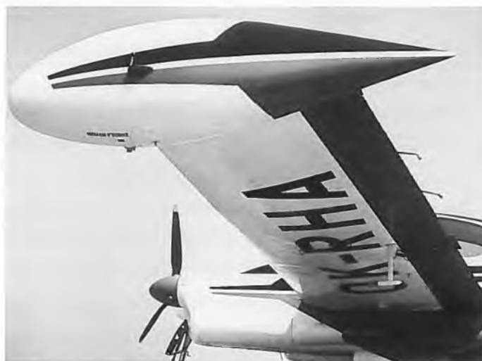
Die Haupttanks befinden sich in tropfenförmigen Behältern an den Flügelenden.
