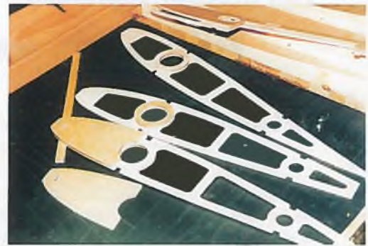
▲ Vormontage der Rippen für das Mittelteil.
