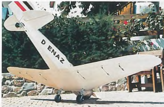
Die Anlenkung der Landeklappen wurde beim Prototyp nach außen gelegt.
