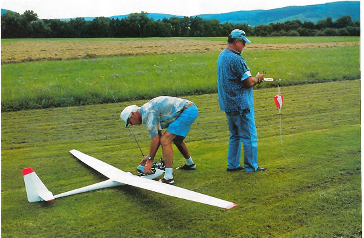
Die sicherste Startmethode: mit Gummiseil und Zugwaage. 15 kg Zugkraft genügen für einen 6-kg-Segler völlig.
