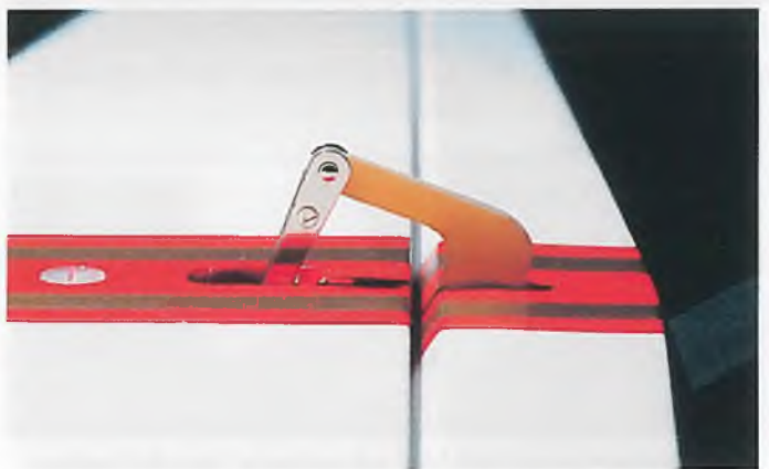
Die Anlenkung des Höhenruders wird demnächst noch rot lackiert. Solche Details lohnen sich bei diesen schönen Modellen.
