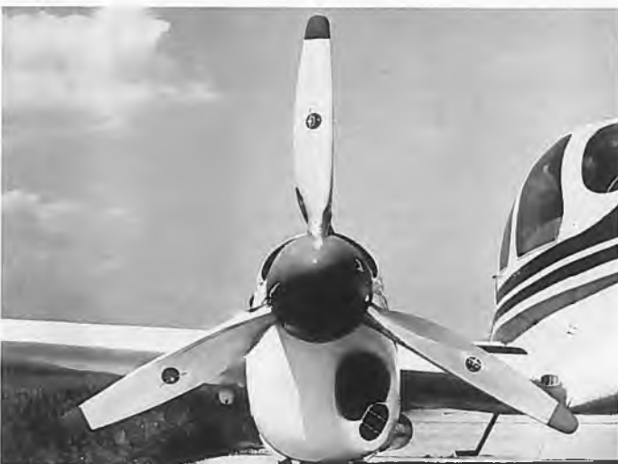
Die Metallflugschrauben vom Typ Avia V-506 haben einen Durchmesser von 1.750 mm.
