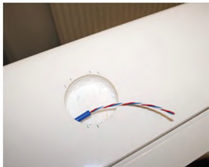
Das ist die im Text beschriebene Einzugshilfe für die Servokabel, ein eingeschobenes Bowdenzugrohr eines Sullivan-Zuges.
