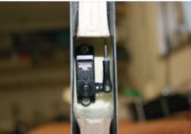
Die Aufnahme bietet ausreichend Platz für ein 13-mm-Servo. Die Anlenkung des Höhenruders erfolgt auf direktem Weg über 2-mm-Stahldraht und ist damit spielfrei. Als Ruderhorn wurde eine M3-Augenschraube mit 1,6-mm-Querbohrung verwendet.
