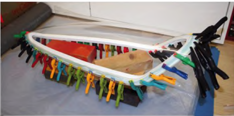
Die Kabine muss vom Erbauer noch angepasst und mit dem stabilen Rahmen verklebt werden.
