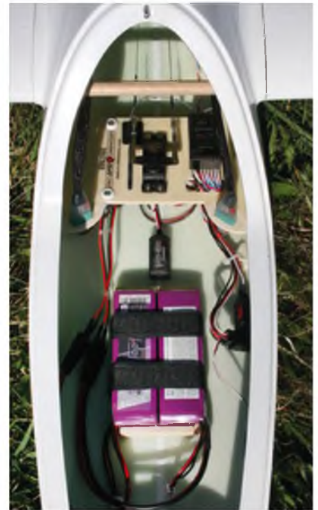
Der Rumpf der DG-808 bietet ausreichend Platz für alle RC-Komponenten und lässt darüber hinaus auch noch einen vorbildgetreuen Ausbau des Cockpits zu.
