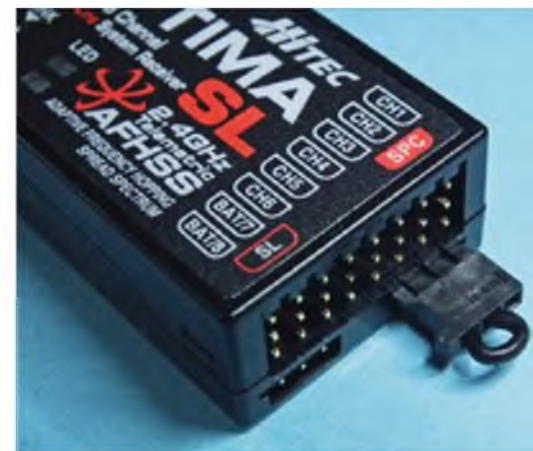
Acht PWM-Servoausgänge plus SL-BUS und SPC-Steckplatz, das sind die Anschlüsse des neuen 9-Kanal-Optima-SL-Empfängers.
