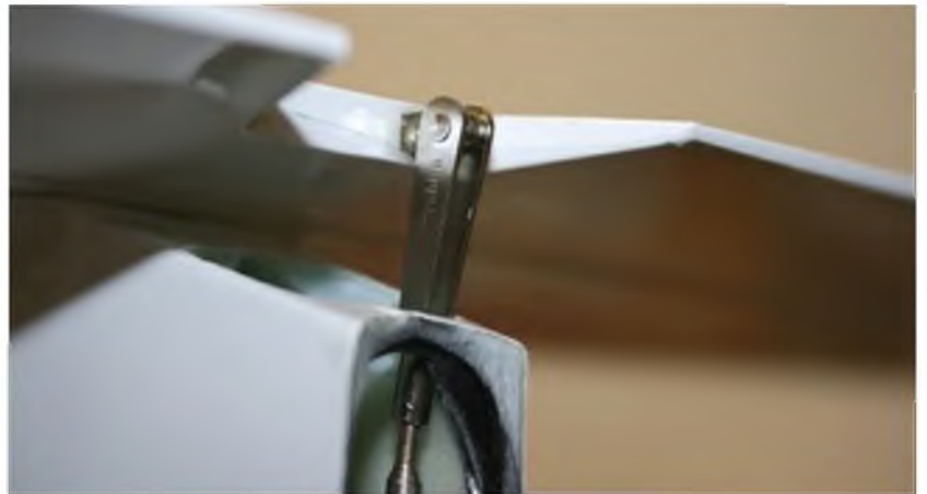
Die Aufnahme bietet ausreichend Platz für ein 13-mm-Servo. Die Anlenkung des Höhenruders erfolgt auf direktem Weg über 2-mm-Stahldraht und ist damit spielfrei. Als Ruderhorn wurde eine M3-Augenschraube mit 1,6-mm-Querbohrung verwendet.
