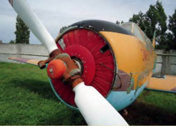
Den Antrieb übernimmt ein 9-Zylinder-Sternmotor Wedenejew M-14P und eine zweiblättrige verstellbare Luftschaube.
