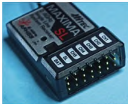
Fünf direkte PWM-Ausgänge, einen SL-BUS-Port und einen Batteriesteckplatz bietet der neuen 9-Kanal-Maxima-SL-Empfänger.
