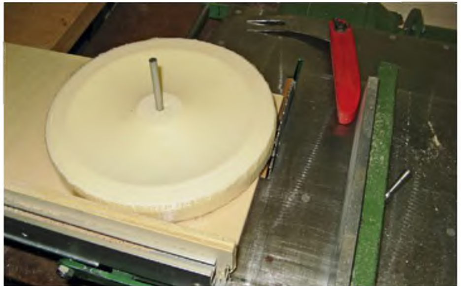
Zuschnitt eines Holzrades mit der Kreissäge. Achtung: Der Spaltkeil und die Schutzhaube wurden nur für das Foto ausgebaut.
