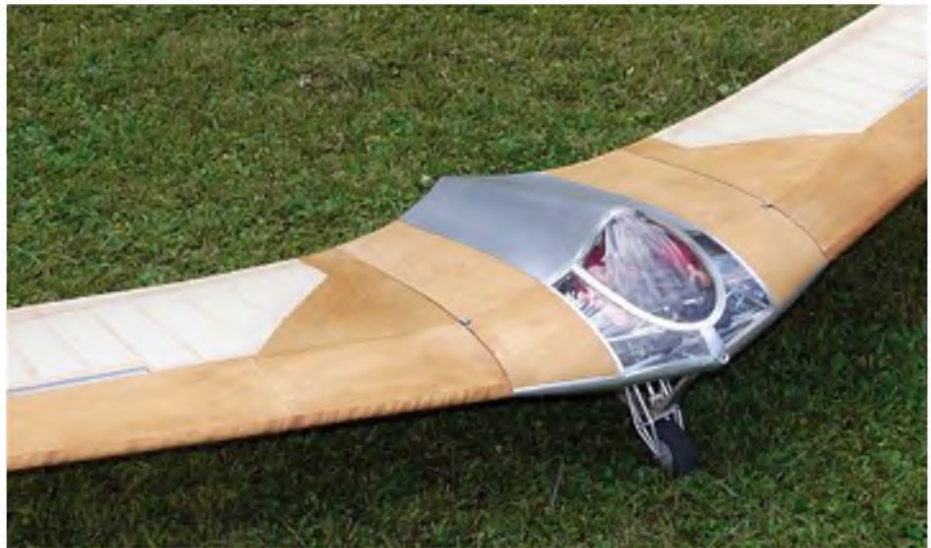
Meine Horten IV in Holzbauweise mit teilweise offenen Rippenfeldern. Der Bauplan des Modells im Maßstab 1:4 wird in naher Zukunft beim VTH erscheinen.
