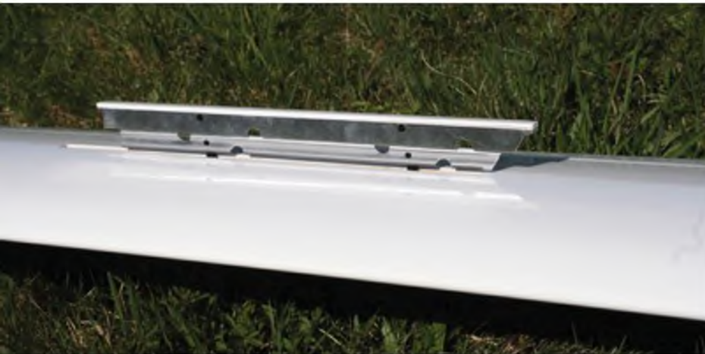
Die doppelstöckigen Störklappen wirken extrem gut und erleichtern die Landung an kleineren Hängen. Sie sind ab Werk perfekt eingebaut und bebügel.
