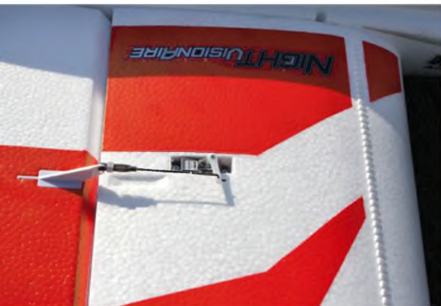
Große Klappen. Die Night VisionAire ist für den 3D-Flug ausgelegt. Entsprechend riesig fallen die Ruderflächen aus.
