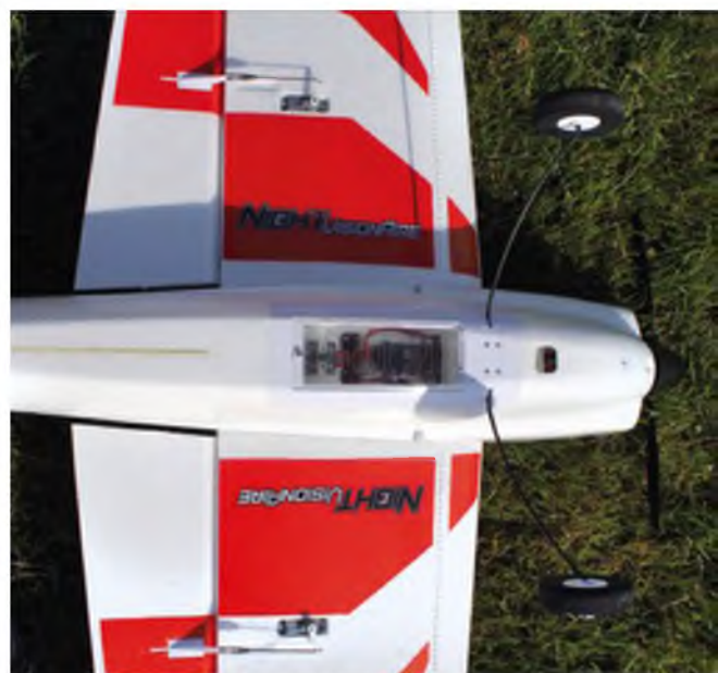
Die Elektronik ist über diese transparente Abdeckung zugänglich. Im Empfänger steckt die SAFE-Technologie mit Rettungsfunktion per Knopfdruck.
