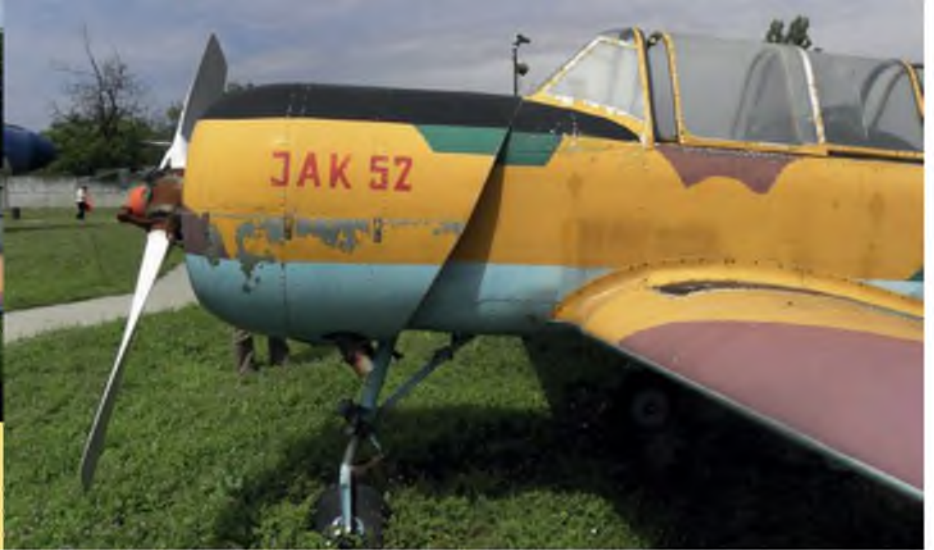
Den Antrieb übernimmt ein 9-Zylinder-Sternmotor Wedenejew M-14P und eine zweiblättrige verstellbare Luftschaube.
