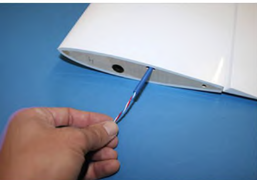
Das ist die im Text beschriebene Einzugshilfe für die Servokabel, ein eingeschobenes Bowdenzugrohr eines Sullivan-Zuges.
