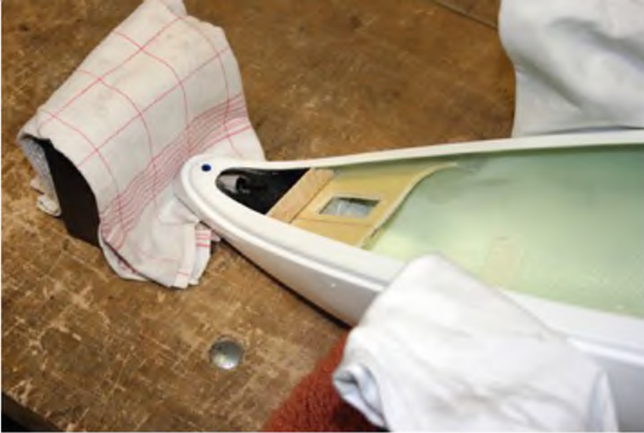
Im vorderen Bereich halten Schleppkupplung samt Servo, Flitschenröhrchen und mit Epoxidharz vergossenes Trimmblei Einzug.
