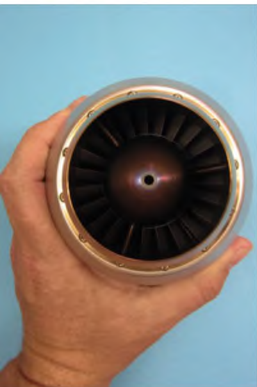
Der Temperatursensor ist beim Blick in die Schubdüse nicht mehr zu sehen – er liegt vor dem Turbinenrad.
