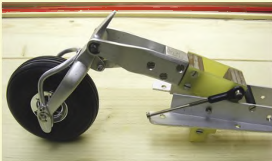
Das Heckfahrwerk im Rohbau.
