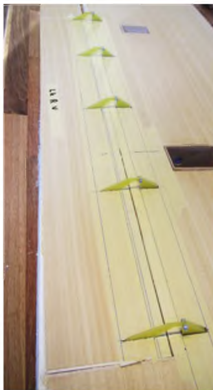
Um die Anlenkung der großen Landeklappen richtig auszulegen, diente eine einfache Schablone als Versuchsträger.
