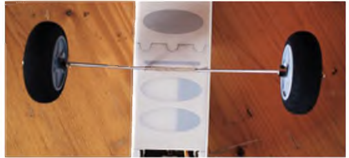
Nachdem das Fahrwerk im Rumpf eingesteckt ist, wird es mit einem dreieckigen Füllstück gegen Herausfallen gesichert. Der ursprüngliche (falsche) Schlitz wurde einfach überbügelt und schimmert nur noch durch die Bepannung.
