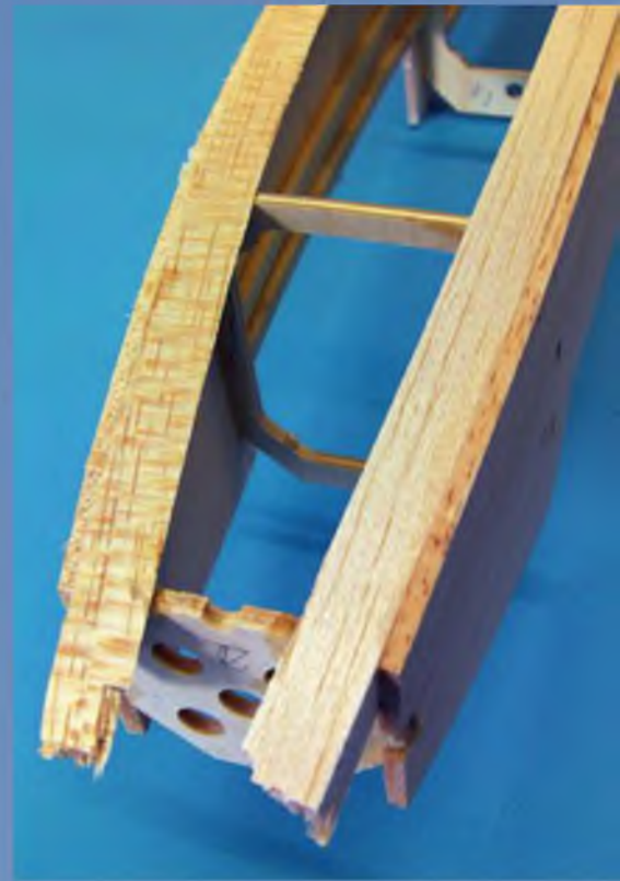
Auch die Rumpfunterseite erhält Verstärkungen aus Dreikantleisten, die rund geschliffen werden.
