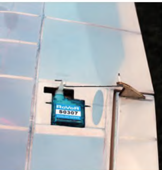
Die Querruderservos werden in die vorgefertigten Servorahmen einfach stramm passend eingedrückt und mit zwei Tropfen Klebstoff gesichert. Der Ruderanschluss erfolgt in gleicher Weise wie bei Seiten- bzw. Höhenruder.
