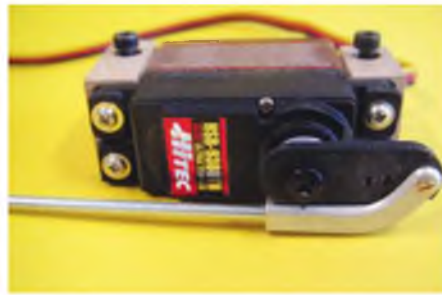
Die gekrümmten Aluhebel erlauben eine 180-Grad-Anlenkung zum sicheren Arretieren in beiden Endstellungen.
