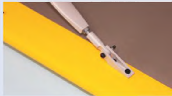
Der Strebenanschluss an der Tragfläche ist mit schönen Alu-Formteilen realisiert.
