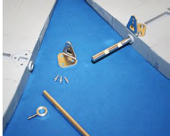
Stabil konstruiert ist die Lagerung und Anlenkung des Pendelhöhenruders über Aluminium-Teile.
