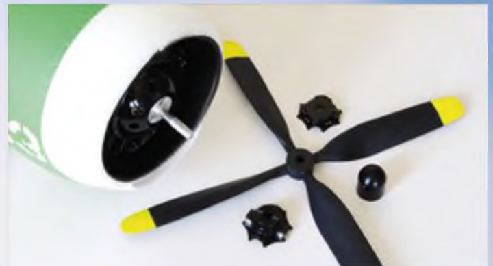
Potent motorisiert: Der eingebaute Brushless-Außenläufer mit 850 kV erzeugt eine vorbildgetreue Dynamik, der 10,5x8"-Vierblattprop ist ab Werk sauber gewuchtet und sehr leise.
