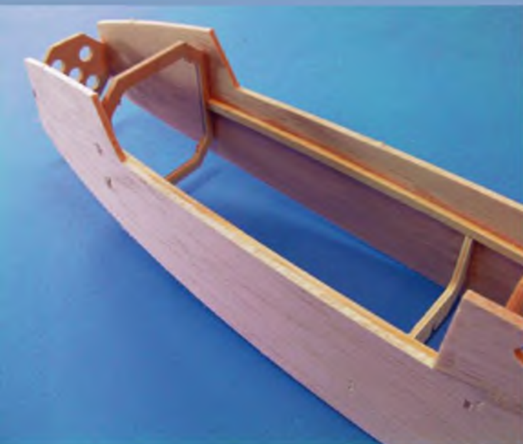
Hier sieht man das Rumpfvorderteil mit Spanten und Verstärkungsleisten sowie dem Halbspant zur Aufnahme der Fahrwerksträger.
