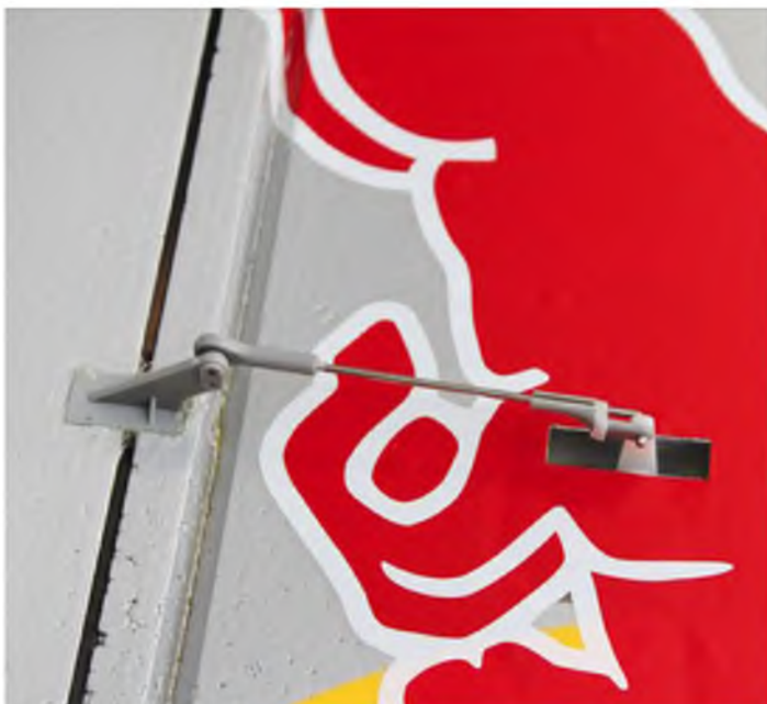
Die Anlenkungen (hier: Querruder) sind in der Länge einstellbar und haben einseitig eine Kugelkopfanlenkung. Dies ergibt verspannungsfreie und nahezu spielfreie Anlenkungen.
