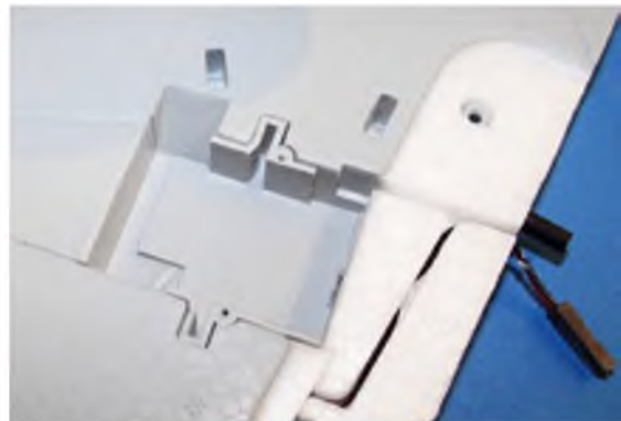
Den Kit-Lieferzustand zeigt hier das Beispiel des Seitenleitwerks: Beleuchtung und Servoaufnahme sind bereits herstellereitig installiert.
