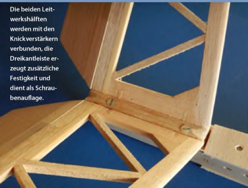
Die beiden Ruderblätter des Höhenleitwerks kann man mit Kiefernleisten verbinden, dann benötigt man nur eine Anlenkung.
