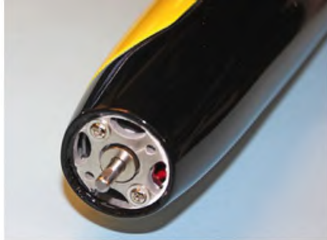
Der Motorspant aus Aluminium ist schon fertig verklebt, auch der Motor ist beim PNP-Modell fertig verschraubt.
