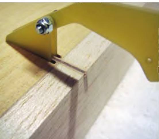
Die stabilen, dreiteiligen GFK-Landeklappenscharniere werden in der Fläche in Schlitzten und an einem mittleren 2-mm-Rippensegment gelagert.
