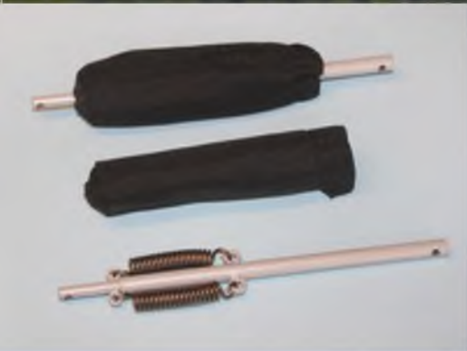
Die Stoßdämpfer wurden hier nur für das Foto geöffnet. Unter der Hülle verbergen sich zwei Federn welche die Landestöße aufnehmen und gut auf das Modell abgestimmt sind.
