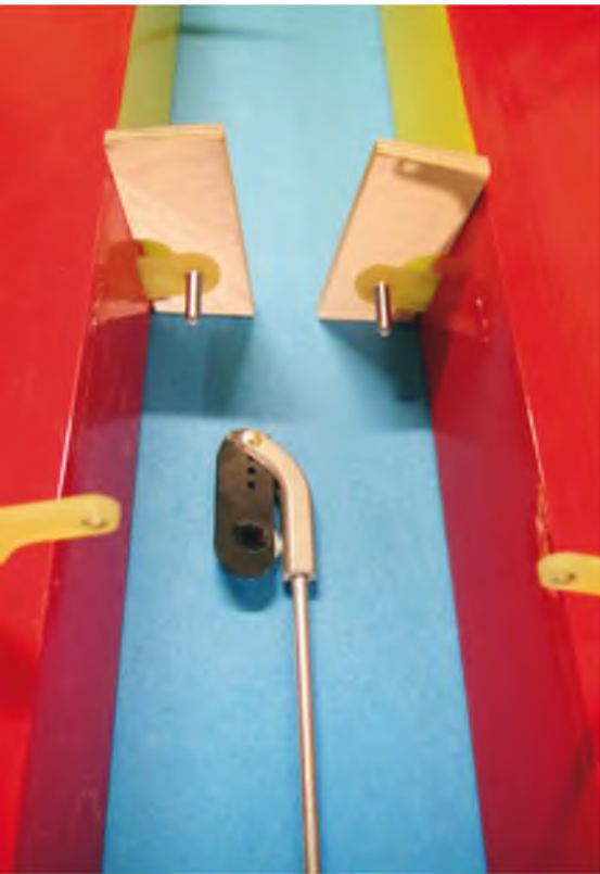
Damit beide Landeklappen gleich laufen, sind die GFK-Anlenkungen mit einer Schablone exakt am gleichen Punkt eingearzt.
