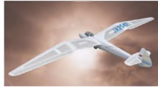
Minimoa 2a , M 1:7,5, Spw. 2.282 mm, Länge 932 mm, Gewicht 1,2 kg.
