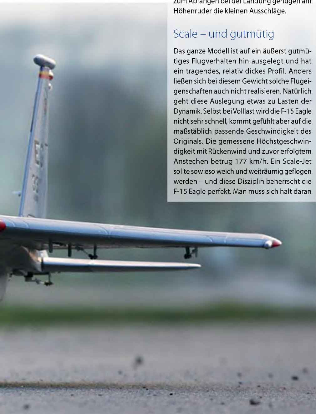
Für alle Steuerflächen werden 13-mm-Servos verwendet. Hier am Höhenruder sollten auf jeden Fall Exemplare mit Metallgetriebe zum Einsatz kommen.
