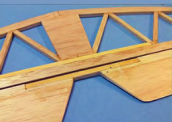
Die beiden Ruderblätter des Höhenleitwerks kann man mit Kiefernleisten verbinden, dann benötigt man nur eine Anlenkung.
