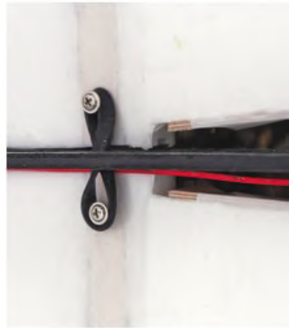
... hinten an der Endleiste sind die Flächenhälften an zwei kleinen Schrauben mit einem Gummiring zusammengehalten.
