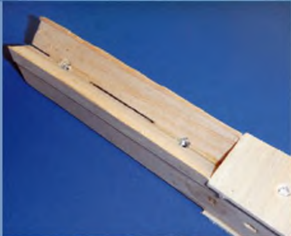
Und so sieht die Auflage für das schraubbare V-Leitwerk mit Einschlagmutter aus.
