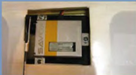
Beim Erprobungsmodell wurden in der Fläche vier Servos Savöx SG 0211 MG von rc-dome verbaut.
