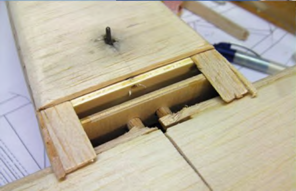
Das Brettchen für den Übergang des Rumpfs zur Tragfläche passt man im probemontierten Zustand an.
