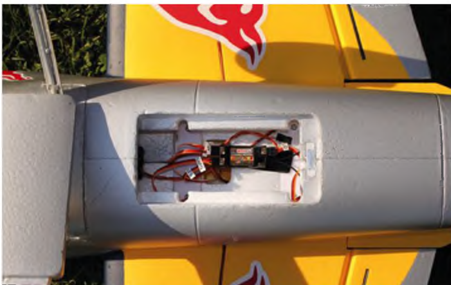
Der auf der Rumpfunterseite liegende Empfänger-Schacht ist auch der Zugang zur Flächenverschraubung.
