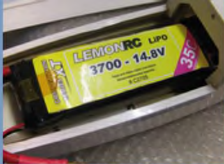
Das Akkufach nimmt 4s-LiPos bis etwa 3.700 mAh auf.
