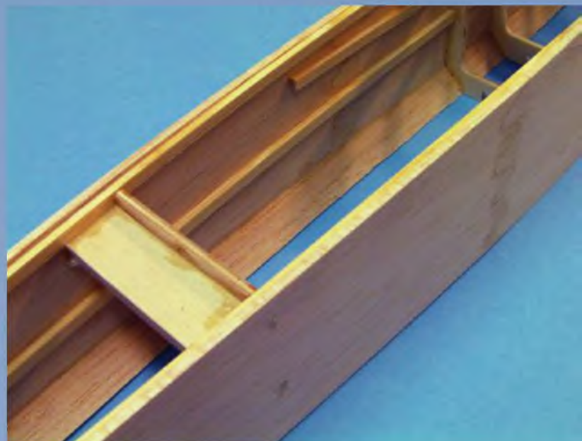
Bereich der Tragflächenauflage mit Verstärkungsleisten und Gewindebrettchen. Das Gewinde wird später direkt ins Holz geschnitten und mit Sekundenkleber gehärtet.
