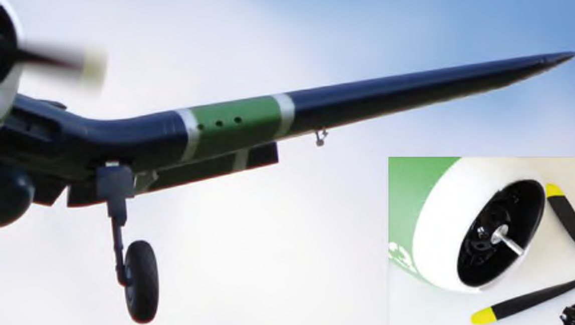
Potent motorisiert: Der eingebaute Brushless-Außenläufer mit 850 kV erzeugt eine vorbildgetreue Dynamik, der 10,5x8"-Vierblattprop ist ab Werk sauber gewuchtet und sehr leise.
