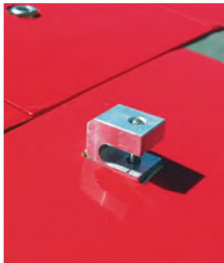
Die Schleppkupplung sitzt direkt hinter der Tragfläche.
