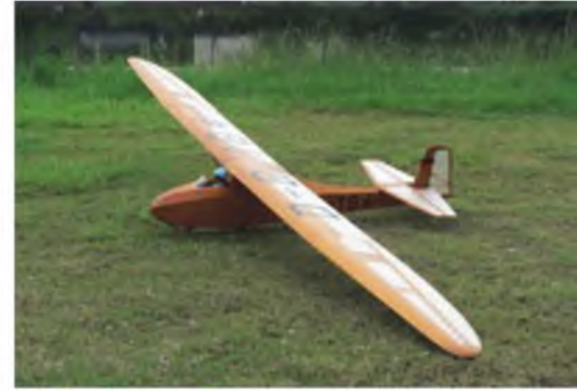
Grunau Baby , M 1:5, Spw. 2,7 m, Länge 1.205 mm, Gewicht 2 kg.
