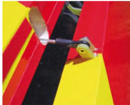
Die voll ausgefahrene Landeklappe am fertigen Modell. Um Klappergeräusche wirksam zu unterdrücken, sind über die volle Breite zwei Filzstreifen aufgeklebt.
