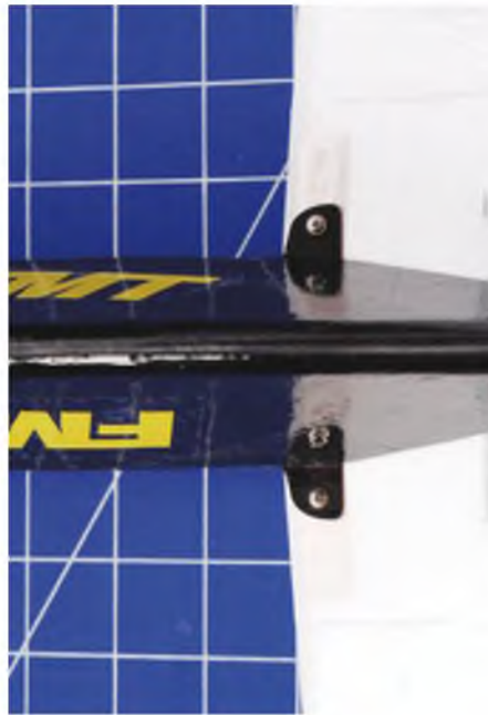
Im Bereich der Nasenleiste befinden sich Verstärkungen, dort werden die Flächenhälften mit kleinen Schrauben fixiert...
