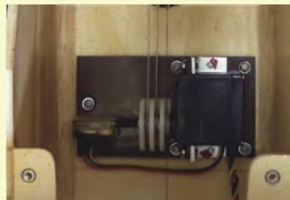
Die Servowinde für die Kabinenhaube mit dem externen Potentiometer. ▼
