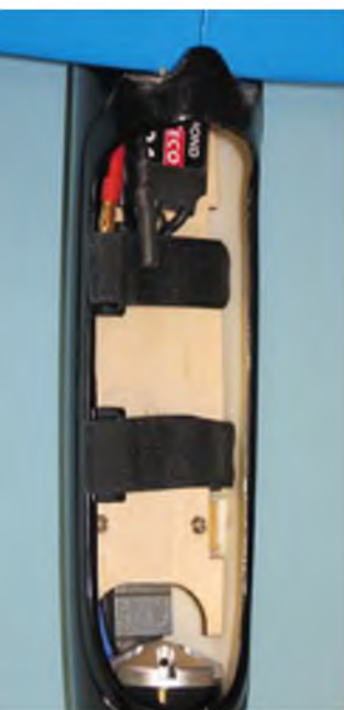
Das Querruderservo ist bereits fertig in der Fläche verbaut und verkabelt (PNP-Version). Das Ruderhorn muss nur noch verschraubt und das Gestänge erstellt und angebracht werden.
