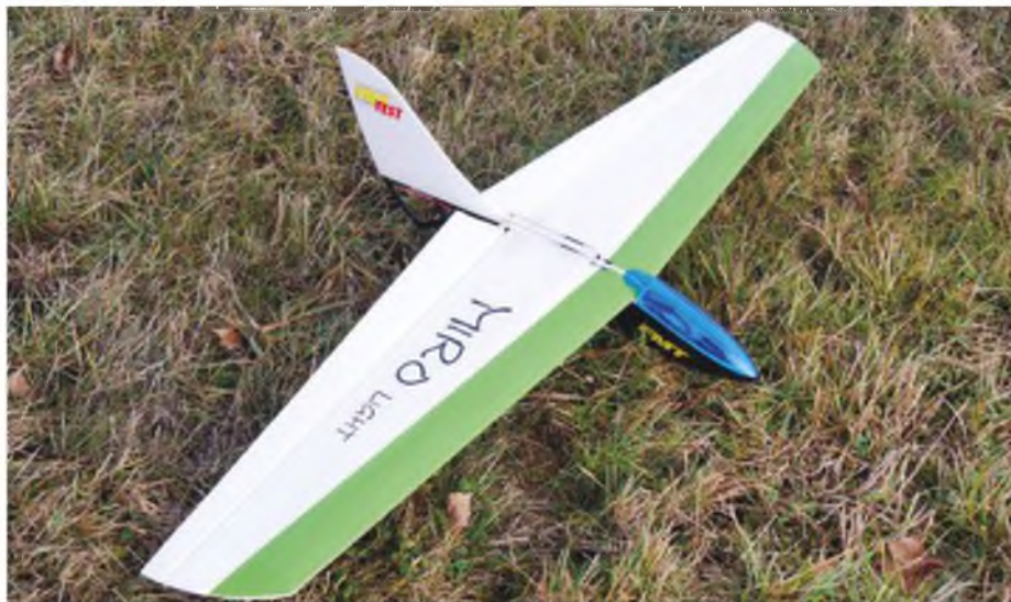
Der Miro Light ist mit seinen 1.100 mm Spannweite und 190 g Fluggewicht ein filigranes Depronmodell für kleine Hänge und schwache Thermik.
