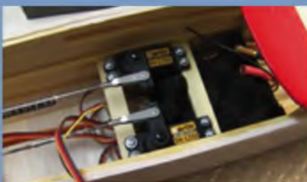
Für Höhen- und Seitenruder wurden Savöx SH 1350 MG eingesetzt.
