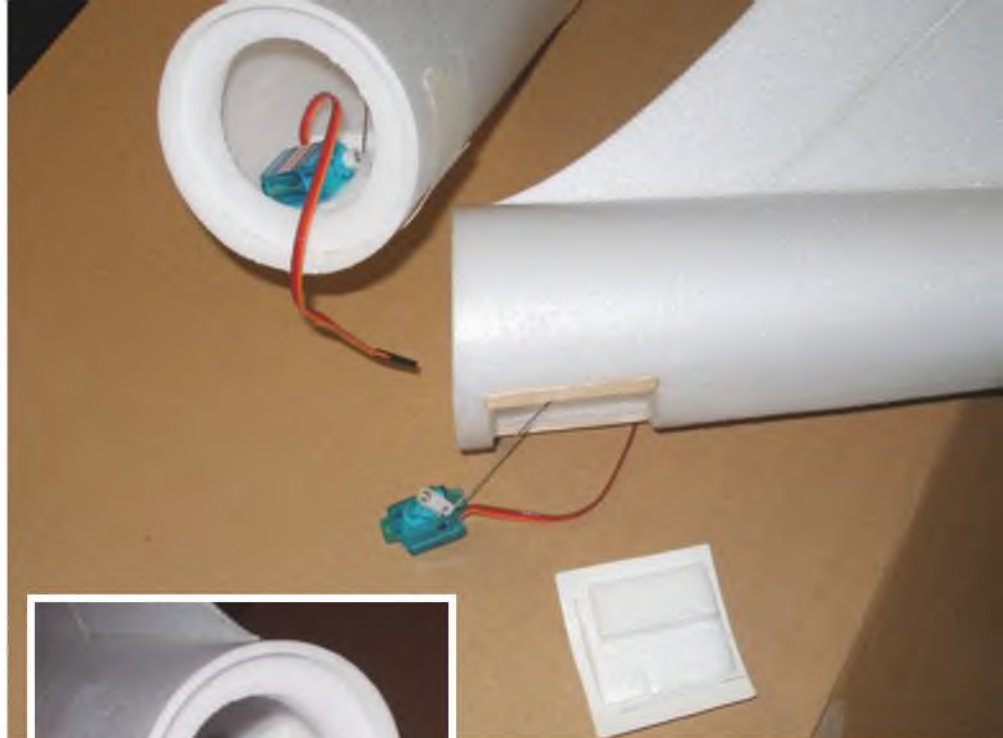
Die Montageabdeckung ermöglicht den Zugang zum Höhenruderservo und Empfänger. Das Bowdenzugrohr im Seitenleitwerk sorgt für zusätzliche Steifigkeit.
