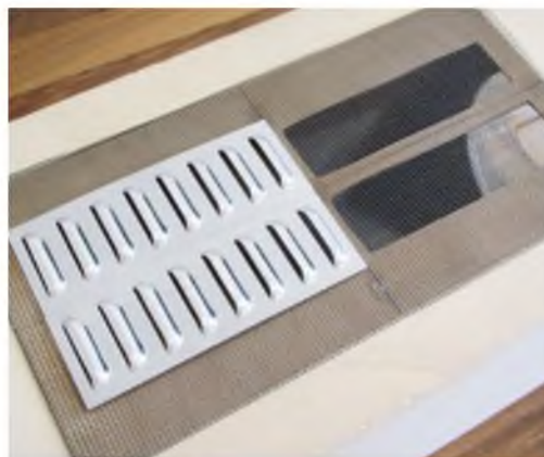
Der Tankdeckel dient gleichzeitig zur Luftansaugung des Heckvergasers vom King190. Eine Lage Gaze unter den Lufthutzen dient als Ansaugschutz.
