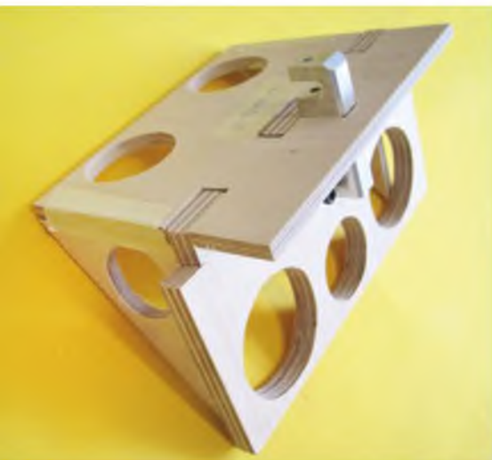
Das alles sitzt innerhalb des Rumpfes und leitet dreidimensional die Kräfte in den Rumpf.
