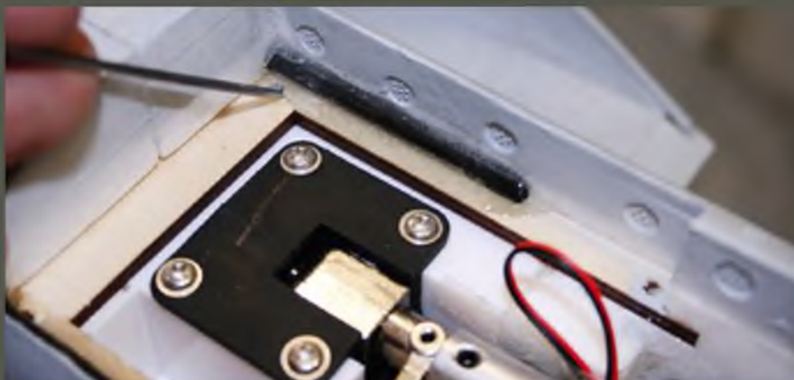
Die vorgeschlagene Verstärkungsmaßnahme stabilisiert den Rumpf im vorderen Bereich merklich.
