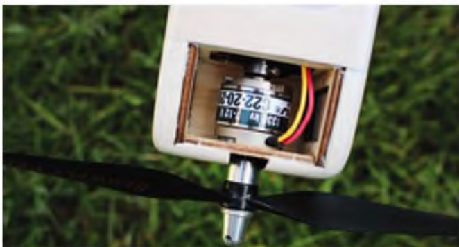
Der Motor ist perfekt auf das Modell abgestimmt. Die roxy-Motoren sind im Fachhandel erhältlich.
