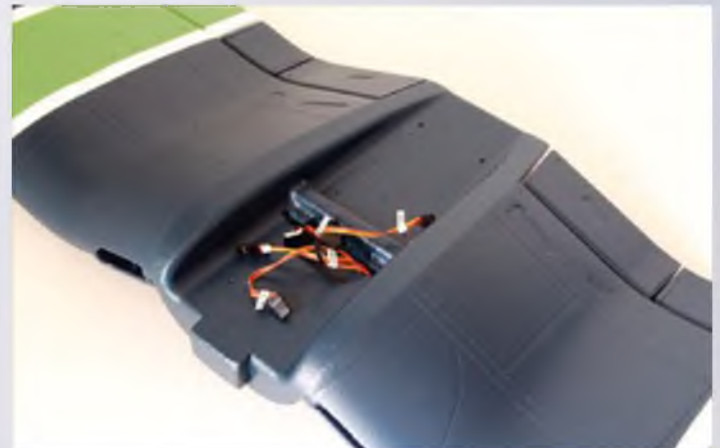
Auch bei der Flächenmontage kann nichts schiefgehen: Die Servokabel für Querruder, Landeklappen und Einziehfahrwerk sind beschriftet.
