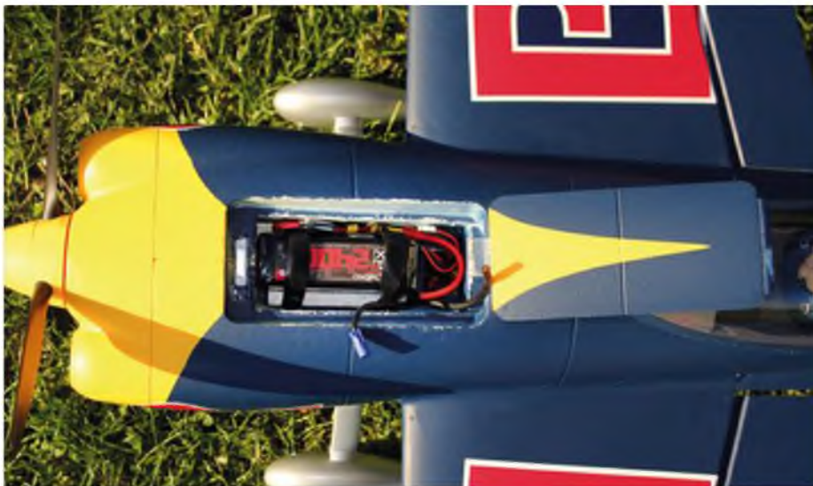
Der Akkusacht ist bereits ab Werk mit Klettschlaufen ausgestattet und bietet 4s-LiPos mit 2.200 bis etwa 3.000 mAh Platz.
