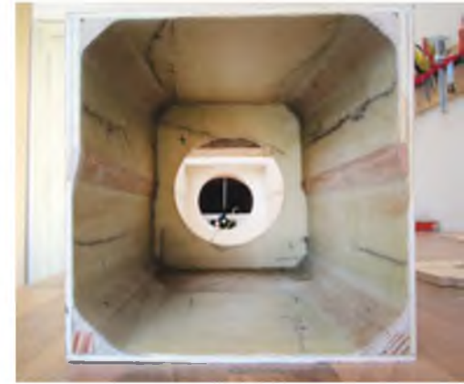
Alle Ecken und Kanten sind mit passenden Dreiecksleisten abgerundet. Dann wurde der gesamte Motorraum mit zwei Lagen 160-g/m 2 -Glasmatte ausgelegt.
