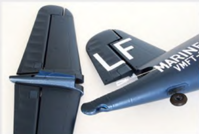
Ist in einer Minute gemacht: Das Höhenleitwerk steckt man auf den Rumpf und arretiert es mit einer Schraube. Die Passung der Schaumteile ist perfekt.
