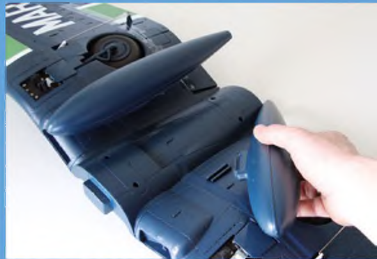
Die Außentank-Attrappen lassen sich an Kunststoffschienen ruckzuck montieren. Der Flügel ist mit elektrischem Einziehfahrwerk, Landeklappen und Querrudern ab Werk komplett ausgebaut.
