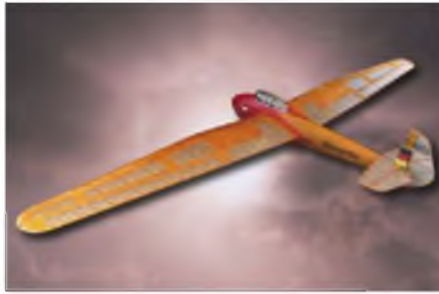
Rhönsperber , M 1:7,5, Spw. 2.026 mm, Länge 808 mm, Gewicht 1,02 kg.
