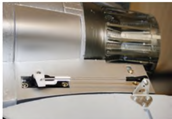
Für alle Steuerflächen werden 13-mm-Servos verwendet. Hier am Höhenruder sollten auf jeden Fall Exemplare mit Metallgetriebe zum Einsatz kommen.
