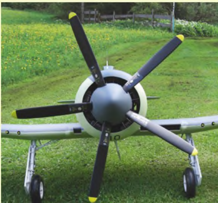
Der Scale-Fünfblatt-Propeller wird zum Fliegen durch einen SEP 30x18-Dreiblatt ersetzt.
