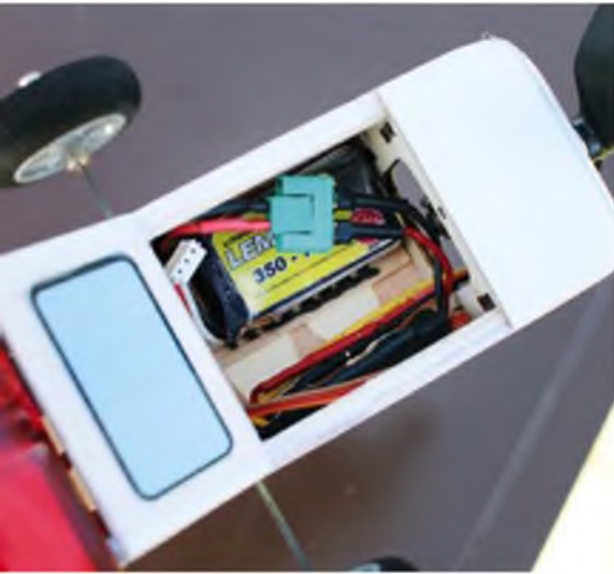
Für den empfohlenen Akku ist genügend Platz vorhanden. Seitlich an der Rumpfwand wurde der Regler mit Doppelklebeband angebracht.
