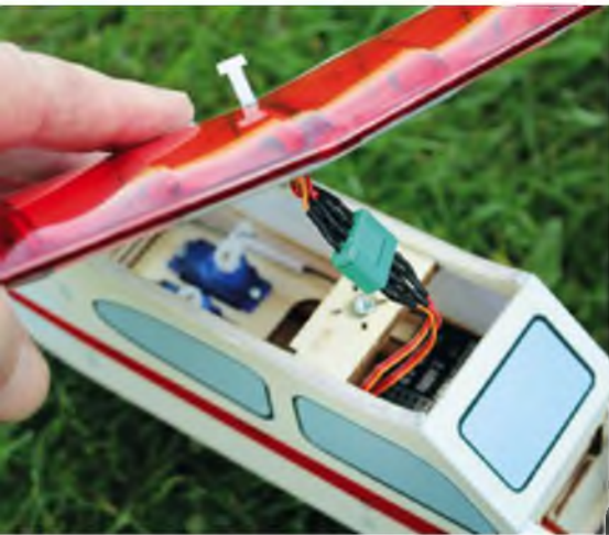
Zur Montage der Tragfläche auf dem Rumpf wird lediglich der Zentralstecker zusammen gesteckt und die Kunststoffschraube eingedreht – fertig!
