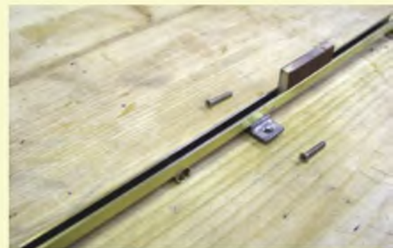
In den Schienen gleiten Novotex-Blöcke, welche 4 mm breit sind und eine beidseitige Nut von 1x1 mm als Führung eingefräst bekamen.
