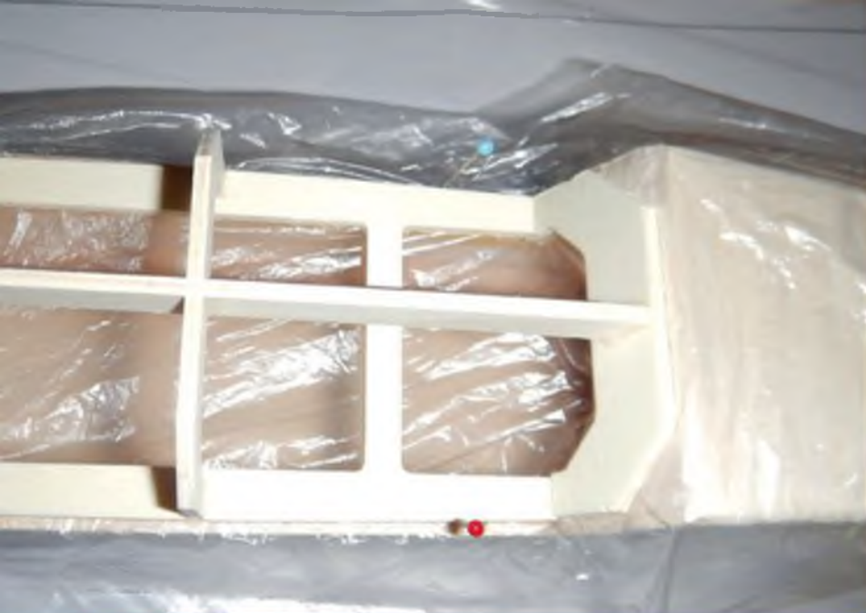
Das ist die Auflage für das nicht abnehmbare Leitwerk der Kreuzleitwerksversion...
