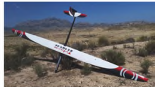
Minimoa 2a , M 1:7,5, Spw. 2.282 mm, Länge 932 mm, Gewicht 1,2 kg.
