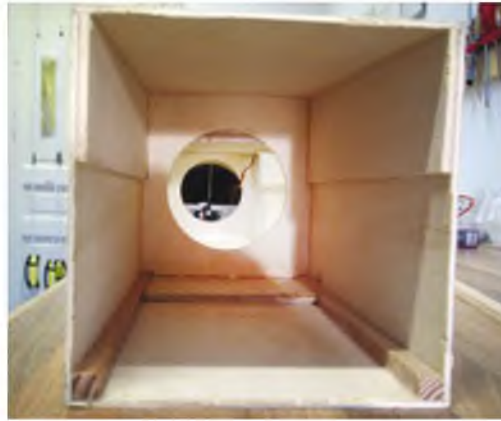
Der Motorspant ist abgeschnitten und lässt nun einen guten Einblick und Zugriff in den Motorraum zu.
