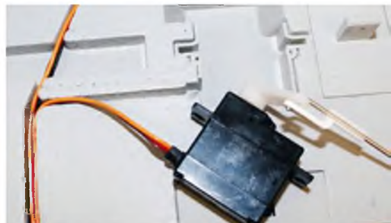
Auch an der Tragfläche findet man eine maximale Vorbereitung für den Servoeinbau vor. An den Laschen (rechts oben auf dem Bild ist eine sichtbar) lassen sich optional zu erwerbende Außenlasten montieren. Auf diese wurde allerdings aus Gewichtsgründen verzichtet.
