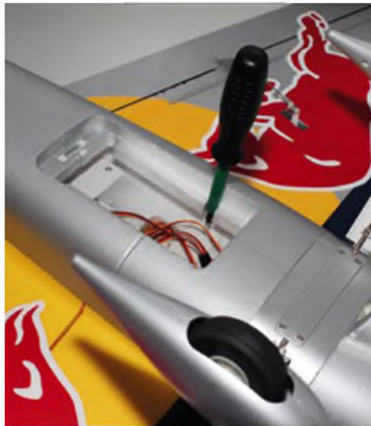
Die Sicherung der ineinandergreifenden Flächenhälften erfolgt mit vier Schrauben.
