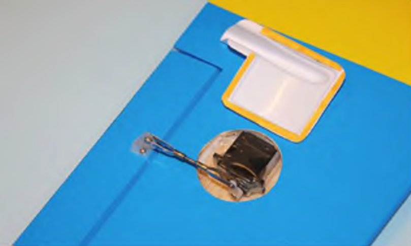
Das Querruderservo ist bereits fertig in der Fläche verbaut und verkabelt (PNP-Version). Das Ruderhorn muss nur noch verschraubt und das Gestänge erstellt und angebracht werden.
