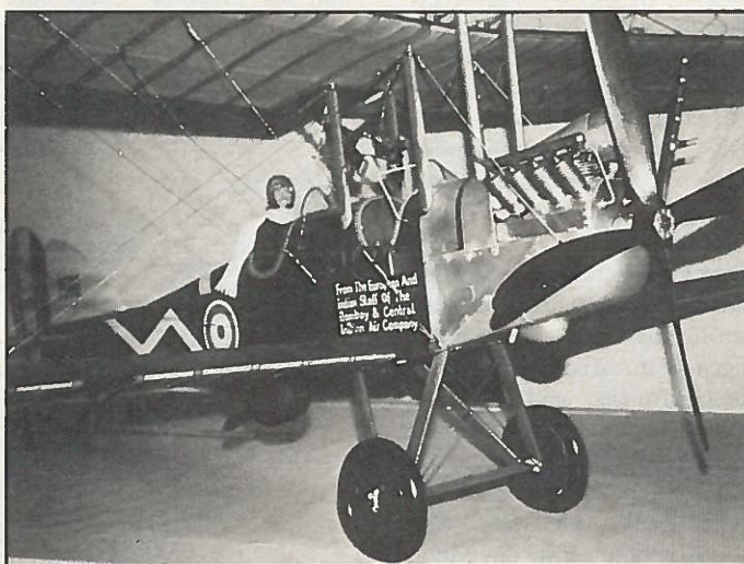
Ein Scale-Vierblattpropeller wird nur für Ausstellung montiert. Einen brauchbaren Vierblatt-Flugpropeller gibt es für Modellmotoren bisher nicht
