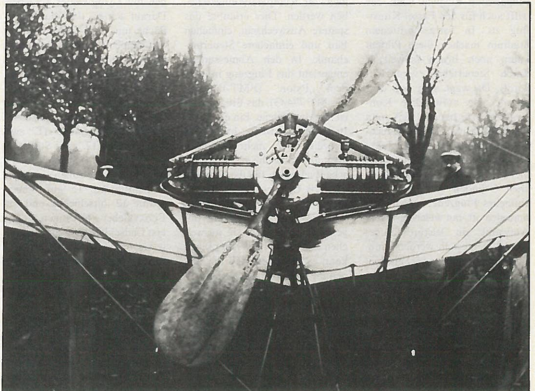
Die Libellule mit dem Boxer Dutheil & Chalmers. Man beachte die gewaltigen „Paddeln“ des Propellers
