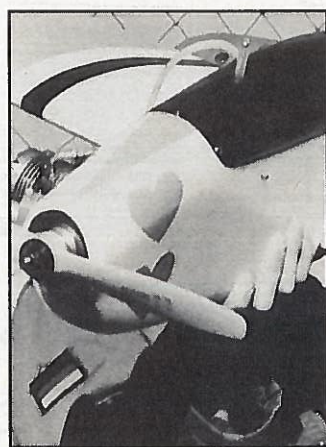
Die beiden herzförmigen Folienaufkleber decken die Zugangslöcher zu den Triebwerksbefestigungsschrauben ab und haben so die Funktion von Handlochdeckeln. Eine einfache und sehr leichte Verschlußmethode.
