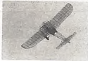
Bleriot XI 1909 H. D. Wahl, 1986, S: 1740 mm, L: 1500 mm, G: 3500 g, A: 4-Takt 7,5-13 ccm, RC: Flächenverwindung, Höhe, Seite, Motor: R: Holz, F: Holz. K-Plan: S: 1160 mm. Best.-Nr.: MT 945-G - PG: G Best.-Nr.: MT-945-K - PG: D
