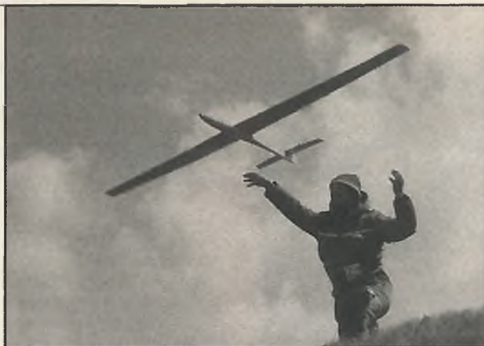
Espen Torp (Norwegen), F3B-WM-Teilnehmer 1987, startet das Modell von Fritz Kristofferson (Norwegen); dänisches Konzept: 2,5 m Spannweite, Flügelverwindung, modifiziertes E 180-Profil (als Oberseite wird ab 50 % der Profiltiefe die Oberseite des E 374 verwendet)
