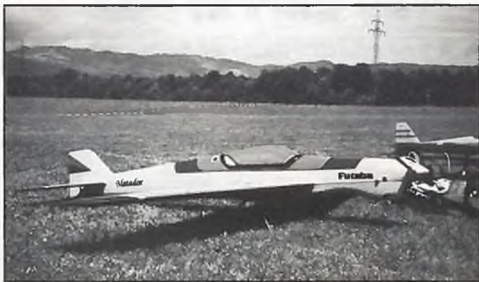
Abbildung oben links: Der Malador des Schweizer Georg Caduff. Gewöhnungsbedürftig die Motorhaube mit ihrer auffälligen Einschnürung der Unterseite. Der Yamada YS 120 Viertakter verschwindet unter der Motorverkleidung vollständig
