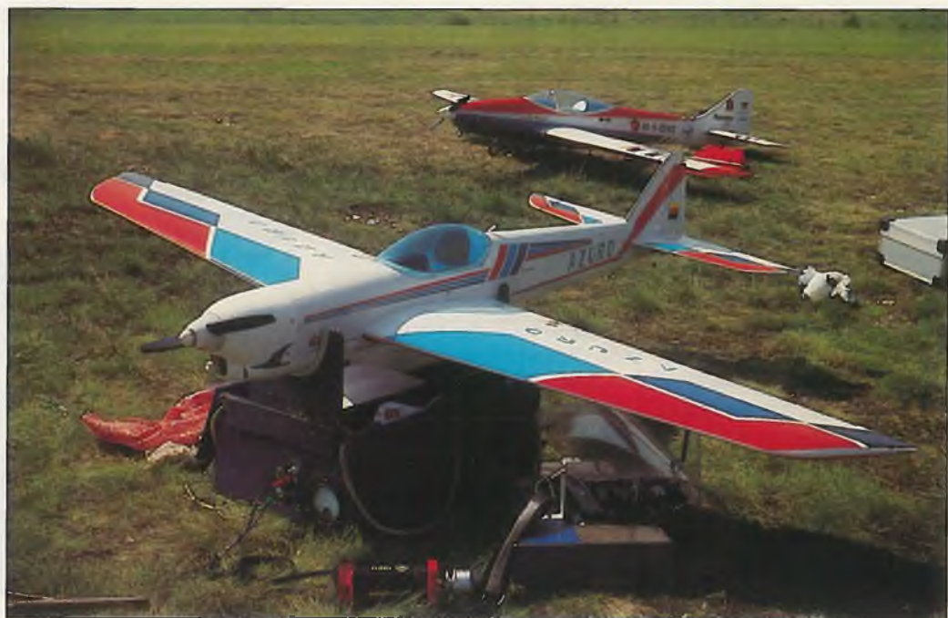
Zu den Leichtesten gehört der AZURO von Wolfgang Lorenz: Unter 3,5 kg bei 1,86 m Spannweite, Styro/Holz-Bauweise
