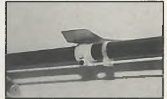
Der Halter der Höhenflosse muß unten etwas ausgearbeitet werden, um den Steuerdraht gradlinig verlegen zu können
