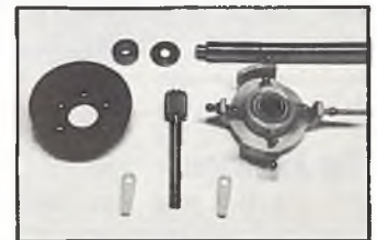
Die im Text angesprochenen Änderungen: Die Anlaufscheibe zwischen Kugellager und Rotorwelle; vergrößertes Innenzahnrad mit Ritzelwelle; überarbeitete Kugellagerteile; Taumelscheibe für 4-Servo- und 3-Servo-Anlenkung
