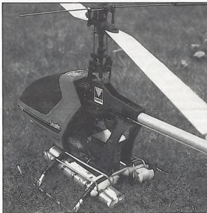
Der Elektrohubschrauber ist ein Graupner Shuttle mit 24 Zellen und Motor KE 40/10
