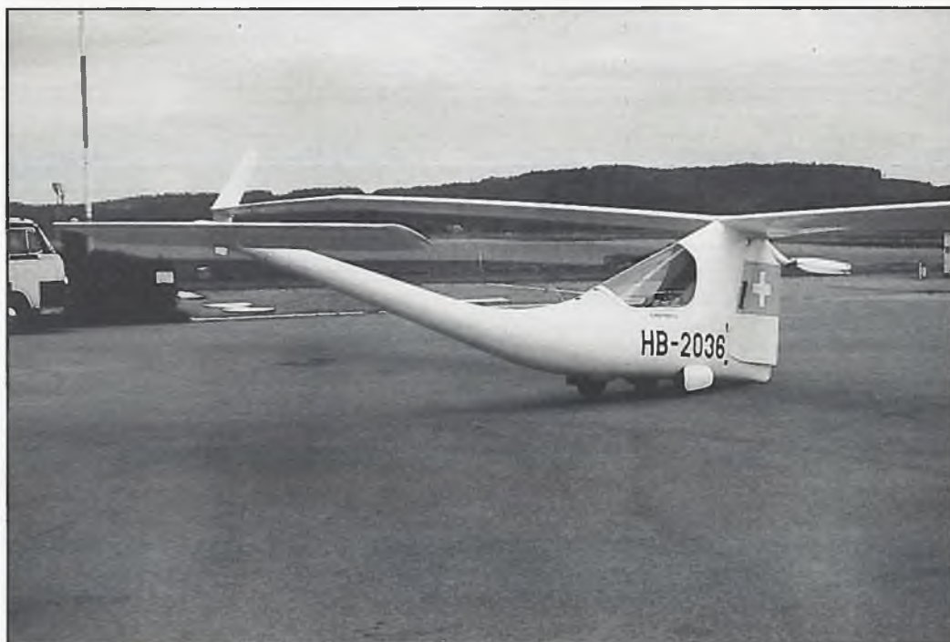
▲ Der futuristische Colibri von Ernst Ruppert aus der Schweiz. Der Pilot sitzt praktisch in der Seitenflosse, in der hinter dem Piloten auch noch der Motor untergebracht ist, der dieses Flugzeug einwandfrei eigenstartfähig macht.
