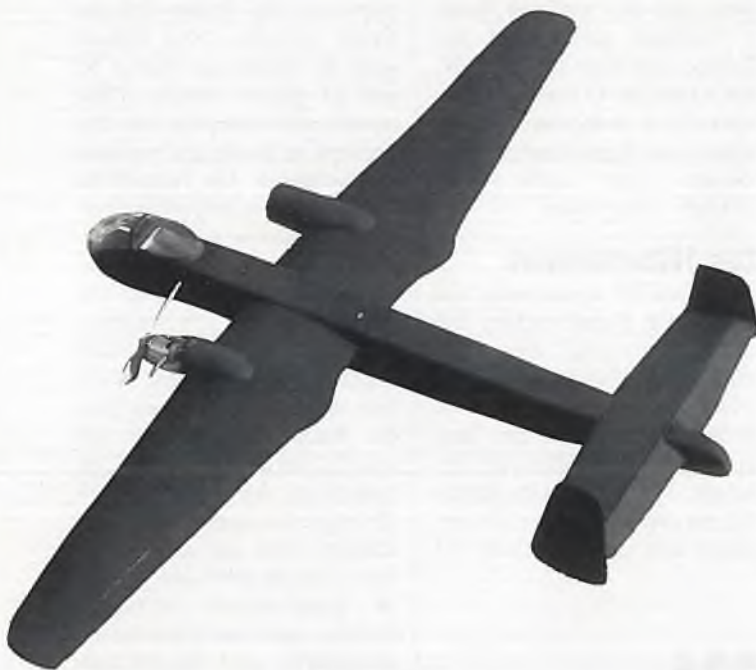
Preiswerter kann man eine Mehrmotorige gar nicht realisieren: zwei „Billigmotoren“, für die Motorsteuerung ein Schalter, als Flugakku ein 7-Zellen-Paket, das nur einen einfachen Lader benötigt
