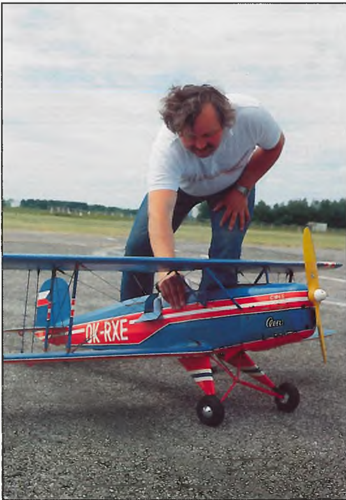
Aero C 104 S, eine in der CSFR nach dem Kriege gebaute Version der „Bü 131 Jungmann“, als Modell von Karel Vodesil, fliegt mit den Original-Profilen und wiegt bei 1712 mm Spannweite 5 700 g. Motor OS-FS90
