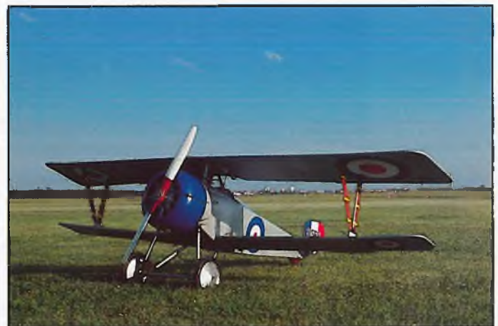
Stefan Wisst flog bei den Leistungswettbewerben für die Teilnahme an der WM im kommenden Jahr mit dieser Nieuport 17 ganz hervorragend. Bei einer Spannweite von 1960 mm fliegt das Modell mit Enya-20-ccm-Viertakter ausgezeichnet.
