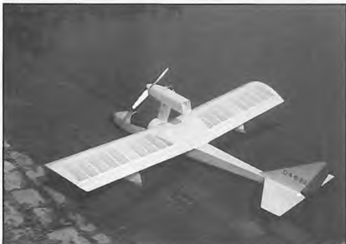
Der Bauplan-Laker (links) wird mit einem englischen Laser-Viertakter angetrieben, während das Bausatz-Modell einen normalen Zweitakter verwendet.
