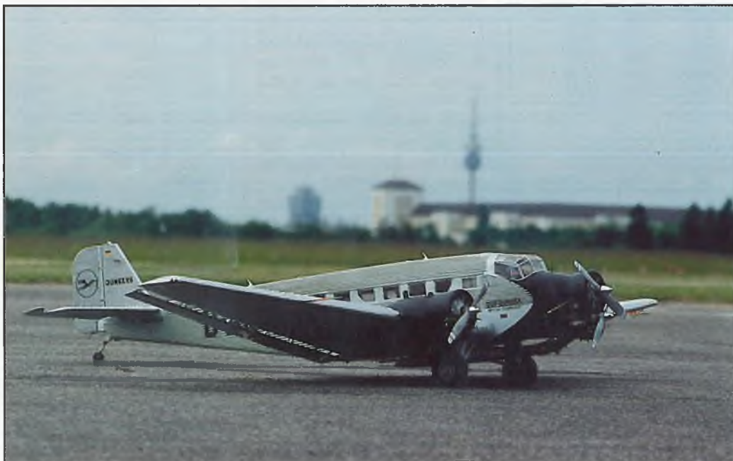
Günther Klaczynski aus Dresden flog diese kleine, aber feine Ju 52 mit 2 x Enya 3,5 ccm und einem Miko 10 ccm. Das Modell wiegt 6 500 g.
