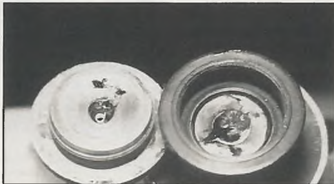
Dreimal der gleiche Motor unter gleichen Betriebsbedingungen während eines Laborversuches: Das beim zweiten Lauf verwendete Schmieröl hinterließ nahezu keinerlei Verbrennungsrückstände; „kolkelte“ aber einen Viertaktmotor vollständig zu.
