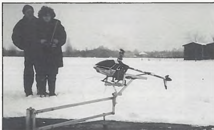
Im Bild die typische Ausgangssituation: Der Heli am Anschlag der Begrenzungskette hängend, mit zusätzlicher Drehung um die Hochachse
