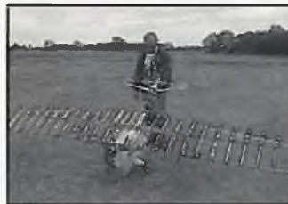
Die Klemm 17 stellte in SCALE Nr. 3 Hermann Wulf vor. Der filigrane Nachbau in Holz hat eine Spannweite von 4330 mm, geschätztes Fluggewicht von 10 kg und als Triebwerk den ENYA 240 VT, dem Hermann anstelle von zwei Vergasern nur einen einzigen verpaßt hat. Das bringt – oft ist es umgekehrt – bessere Laufeigenschaften
