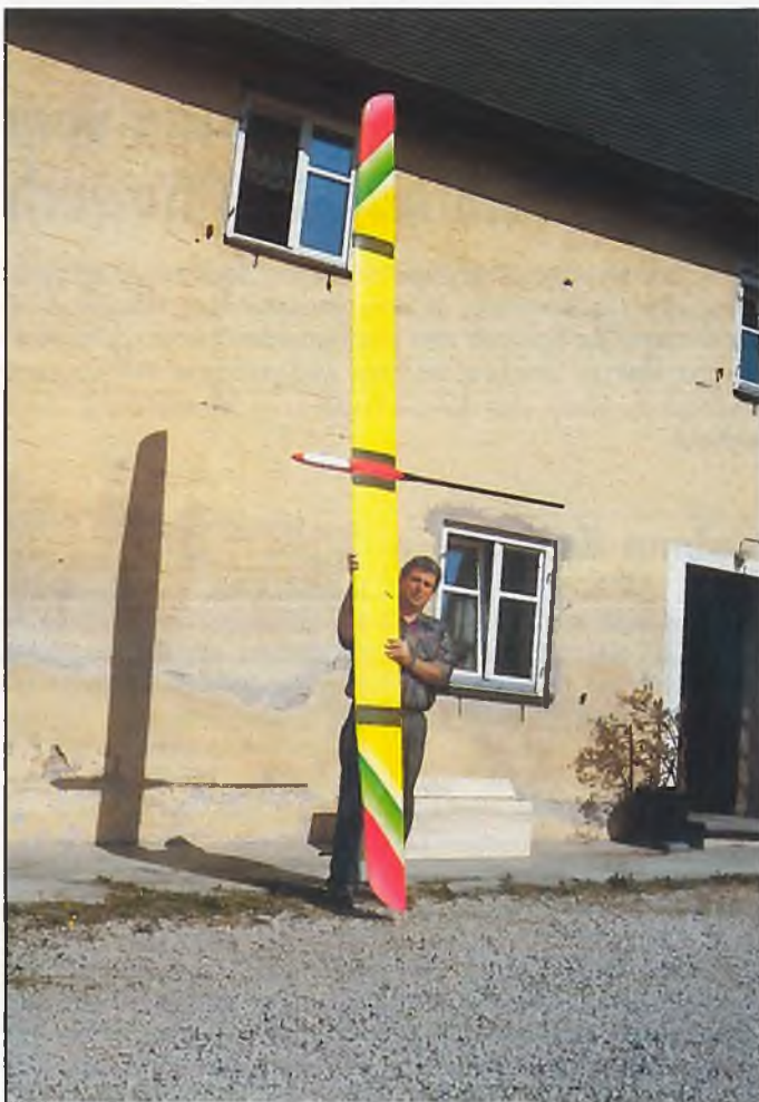
Das imposante Projekt Reno: Flügel mit 4,5 m Spannweite, in 4 Teile zerlegt paßt er in die handliche Transportkiste
