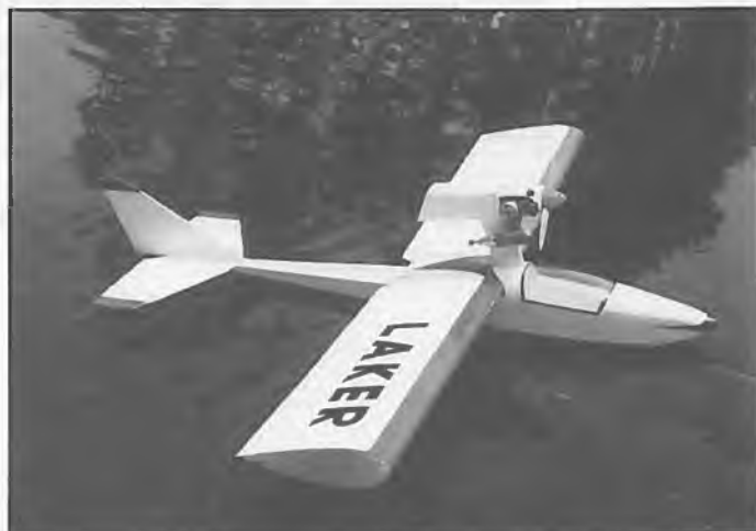
Der Bauplan-Laker (links) wird mit einem englischen Laser-Viertakter angetrieben, während das Bausatz-Modell einen normalen Zweitakter verwendet.
