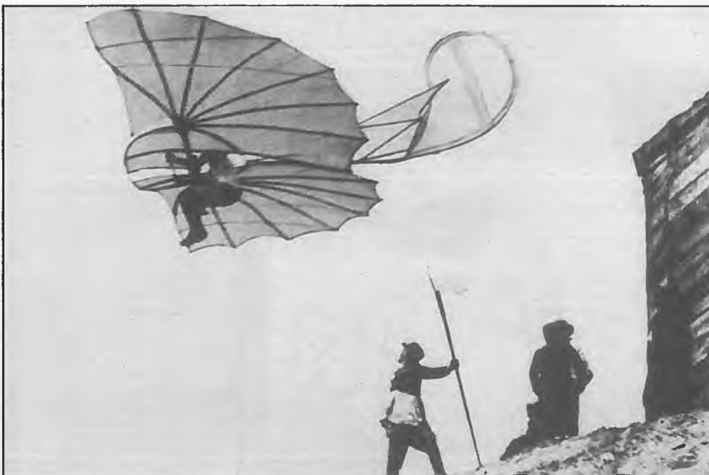
Einer der Gleiter von Lilienthal. Die Beine sind die eigentlichen Steuerorgane: Füße nach vorn = „drücken“, Füße nach hinten = „ziehen“
