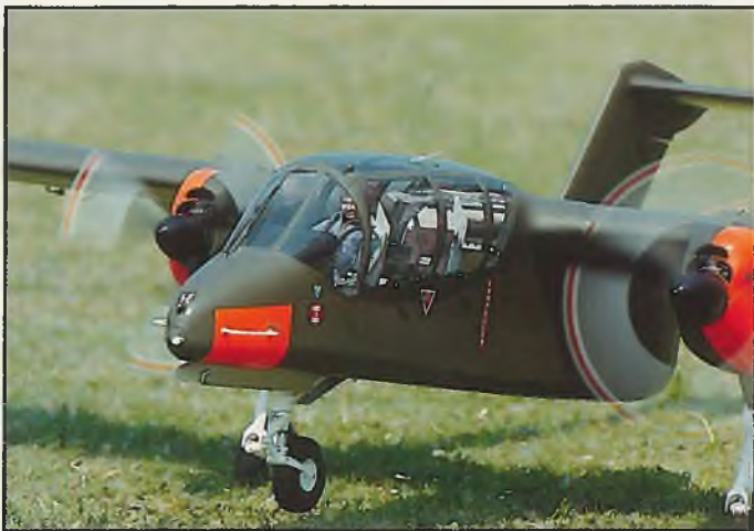
BRONCO DV 10 A von Eckhard Erbsland. Eigenkonstruktion einschließlich Fahrwerk, 2040 mm, Gewicht 12500 g, 2 x 15 ccm OS-Zweitakter. Bauweise Holz mit GFK-Teilen
