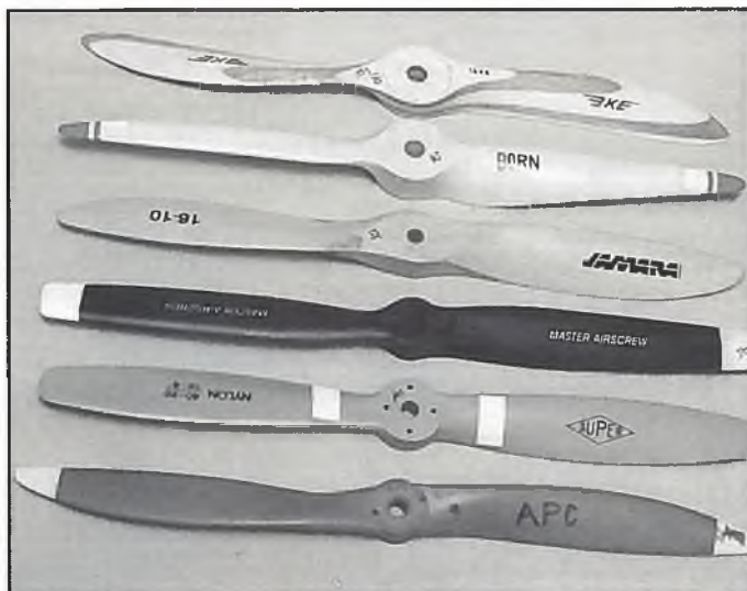
Auch die Formgebung des Propellerblattes hat aufgrund des daraus resultierenden Widerstandes (bzw. der Motorlast) Einfluß darauf, ob der Verbrennungsmotor "klingelt" oder nicht.
