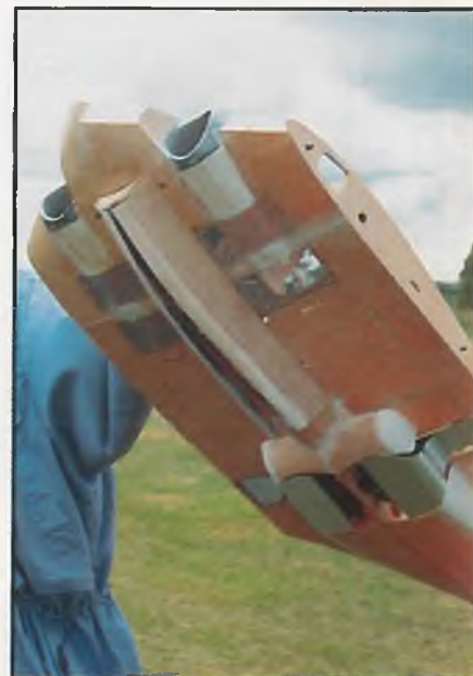
Im Herbst sollte er fliegen, der mit zwei Elektro-Impellern angetriebene Horten-Nurflügel von Edward Uden. Das Rohbau-Flügelmittelstück zeigte (einmotorig und auf seinem Einziehfahrwerk) schon passable Fahrleistungen auf dem FAG-Vorfeld
