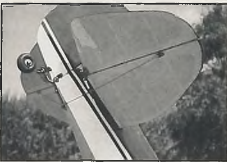
Die Verstrebung des Höhenleitwerks und die gekoppelte Anlenkung der beiden Querruder
