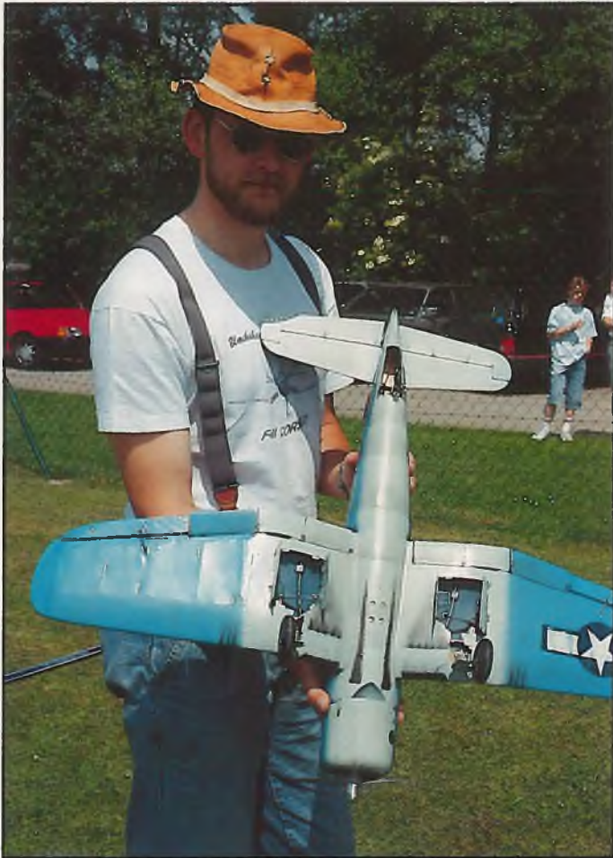
CORSAIR F4U-1A von Armin Morgenweck. Das winzige Modell, Spannweite 900 mm, Gewicht 1080 g mit Einziehfahrwerk und Landeklappen. Selbst das Heckrad fährt mit ein. Motor 2,5 ccm. Auch so klein läßt sich Scale bauen und selbst wenn diese Flugzeuge vergleichsweise unscheinbar sind, steckt in ihnen mehr Modellbaukunst, raffinierte Technik und Leichtbauperfektion als in vielen imposanten Großmodellen!
