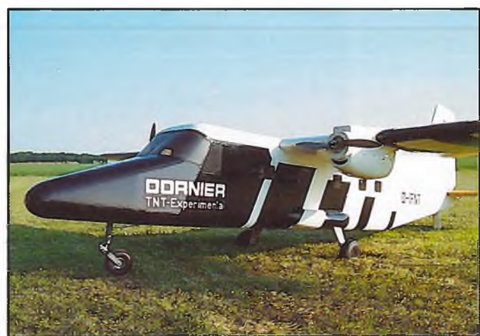
DORNIER TNT von Hans Dieter Ide mit Elektroantrieb. Spannweite 3680 mm, Länge 2890 mm, Gewicht 16540 g, Maßstab 1:4,6. 80 Zellen 1.4 Ah. Das Modell begestert im Fluge
