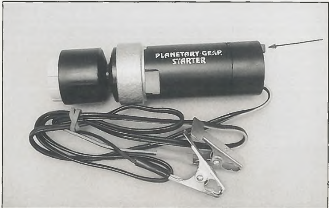
Klein, aber fein, - der Pfeil zeigt auf die Stecksicherung
