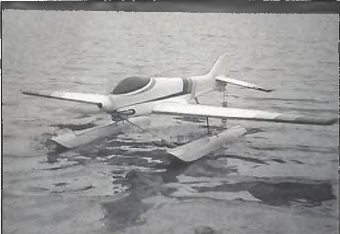
Häufig wurden Modelle der alten F3A-Generation eingesetzt. Deren Flugeigenschaften mit Schwimmern können aber mit einem leichten, größeren Modell nicht mehr konkurrieren. Hier H. Petersdorffs "Shadow" mit vollintegriertem Resorohr.
