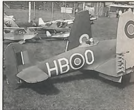
Auf dem engen Flugzeugträger muß man die Flügel hochklappen. Die "Hawker" konnte es, der RC-Nachbau kann es auch: Sie rollt mit angeklappten Tragflächen zur Startbahn, erst dort werden die Flächen (per RC!) heruntergefahren und verriegelt
