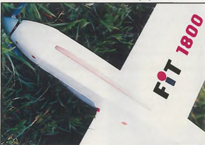
Die Landekufe schützt den Rumpfboden vor Beschädigungen.
