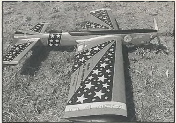
Das Flugzeug des Favoriten Dr. Egervary, Platz. 2: Spannweite 154 cm, Gewicht ca. 1800 g, Motor ST 60
