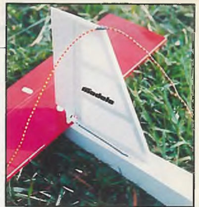
Das Seitenleitwerk und das Höhenleitwerk sind in Stegbauweise ausgeführt - das spart Gewicht.
