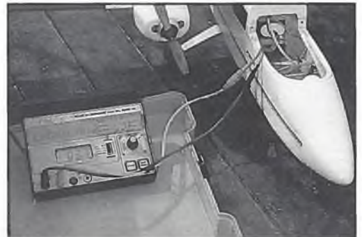
Das kleinere Automatik-Gerät “Lader 16 Rx” von Robbe für 4-16 Zellen kommt immer dann zum Einsatz, wenn ausschließlich 400er Modelle geflogen werden. Leider gibt das Gerät nach der Vollererkennung kein “Düdeliüt” von sich ...
