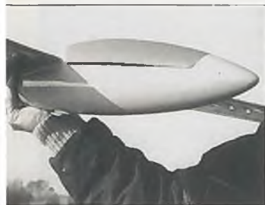
Hier paßt faßt schon ein Hut durch: die Passung der Kabinenhaube ist mangelhaft. Hier sollte der Hersteller nochmals Hand anlegen.
