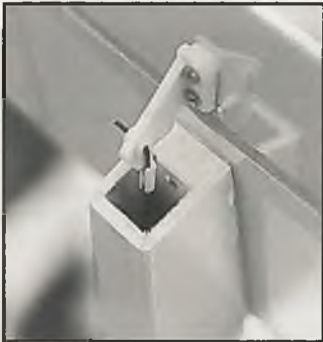
Das Höhenruder wird zentral aus dem Rumpf heraus angeleitet und hat ein Follenschamier.
