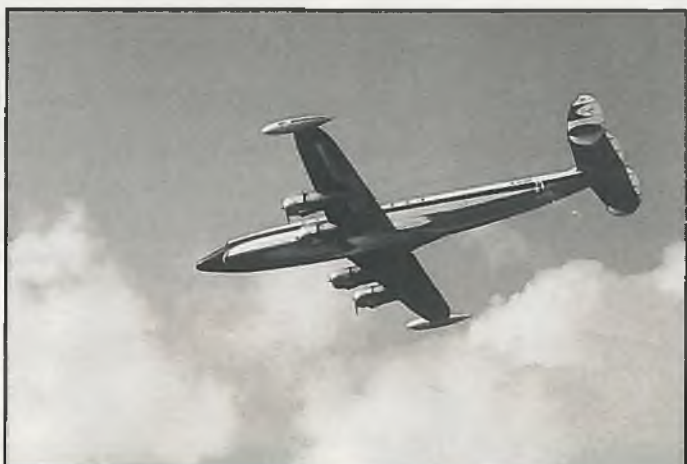
Sie hat immer noch das Zeug zum Superstar: Die Lockheed Super Constellation, die "Super Conny", ist als Modell ein "Oldtimer" mit eleganter, moderner Linienführung. Wenn sie, wie diese auf dem "Scale-Treffen", auch noch so sauber gebaut und so gut geflogen wird, so steht der fliegerische Höhepunkt des Tages auch schon fest. Daten: Spannweite 375 cm, 19,4 kg, 4x 10 cm. (Foto: Ian Tunstall)
