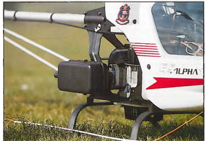
Der Dämpfer wurde mit einem schwarzen Thermo-Lack aus der Sprühdose lackiert und paßt so recht gut zum Alpha GS.
