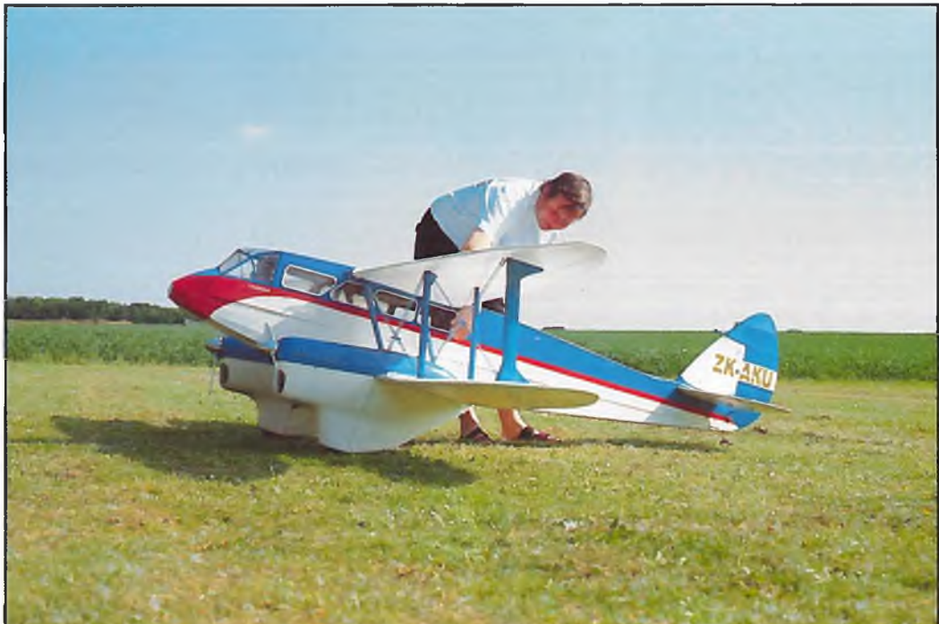
DRAGON RAPIDE DH 89, Eigenkonstruktion von Andreas Paul. Spannweite 3810 mm, Länge 2770 mm, Gewicht 18000 g, 2 x 20 ccm OS-Surpass, Bauweise Holz, Motorgondeln GfK
