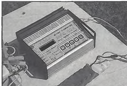
Der MFC 524 “at work”; der große Kühlkörper ist Garant dafür, daß der Lader allen thermischen Anforderungen gewachsen ist.
