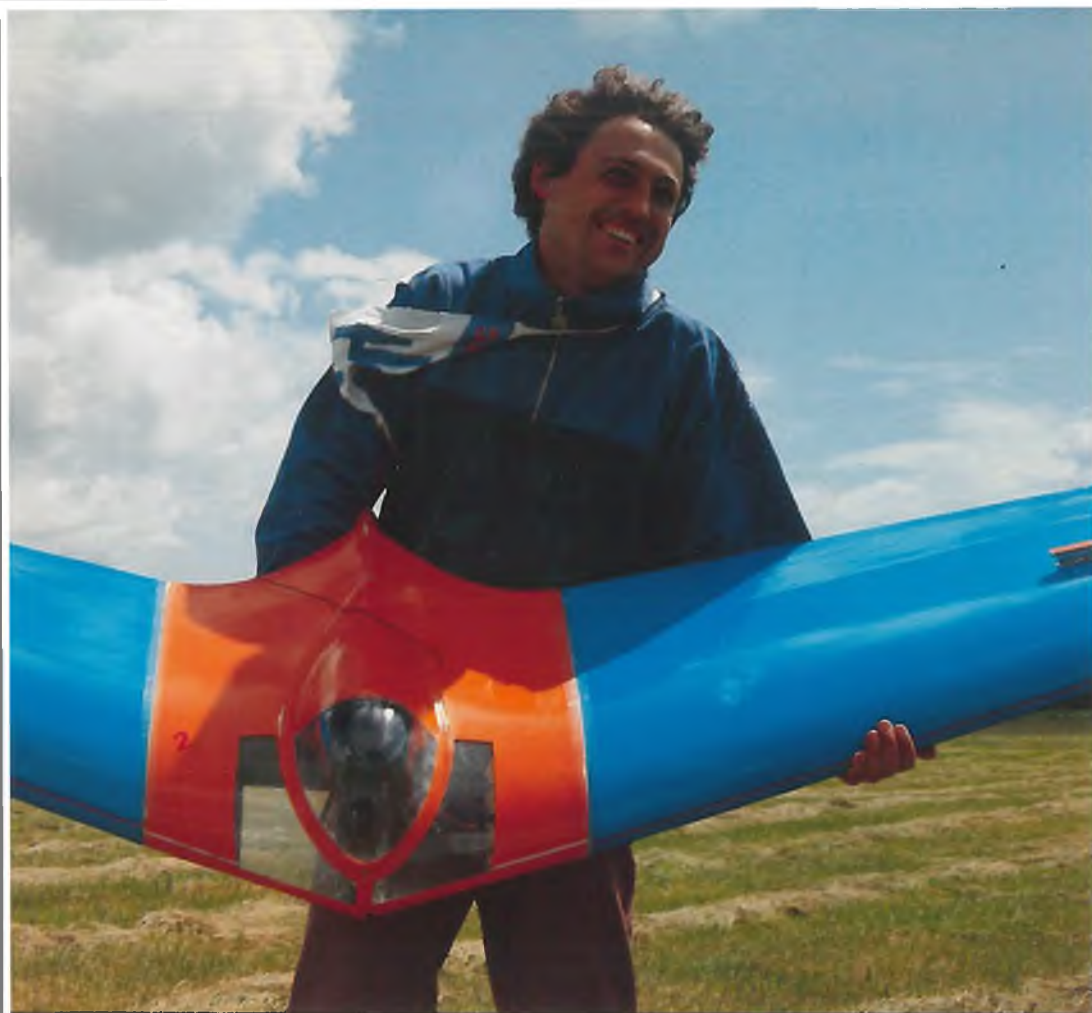
Im Herbst sollte er fliegen, der mit zwei Elektro-Impellern angetriebene Horten-Nurflügel von Edward Uden. Das Rohbau-Flügelmittelstück zeigte (einmotorig und auf seinem Einziehfahrwerk) schon passable Fahrleistungen auf dem FAG-Vorfeld
