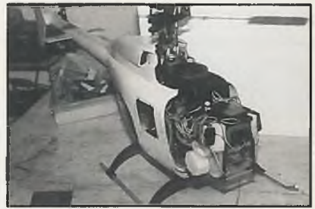
Bild 1: Einbau des Drehzahlreglers, Druckanschluß am Krümmer und der Aluwinkel für den Tank an der fast kabellosen Seite der Mechanik. Die Kufenbügel sind von Vario und haben sich besser bewährt als die originalen
