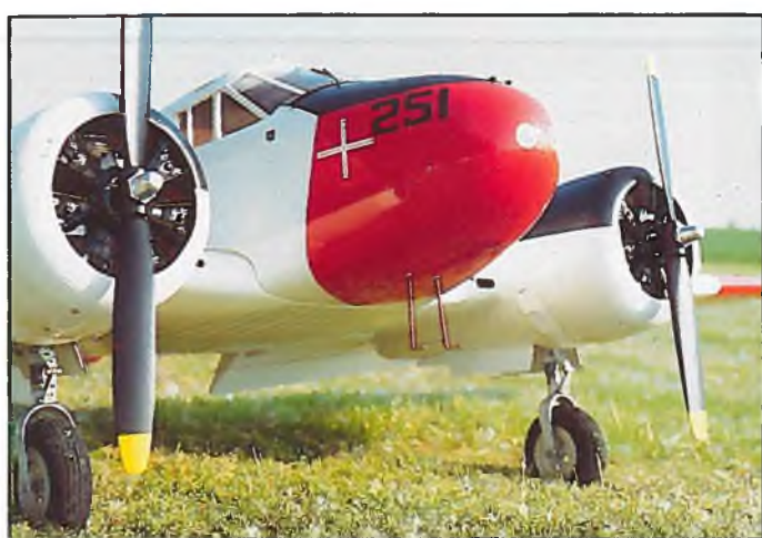
Beech H 18, Eigenkonstruktion von Horst Lohschmidt, Spannweite 2420 mm, 2 x 12,5 ccm Super-Tigre. Einziehfahrwerk von H. Weckop. Modell in Holzbauweise
