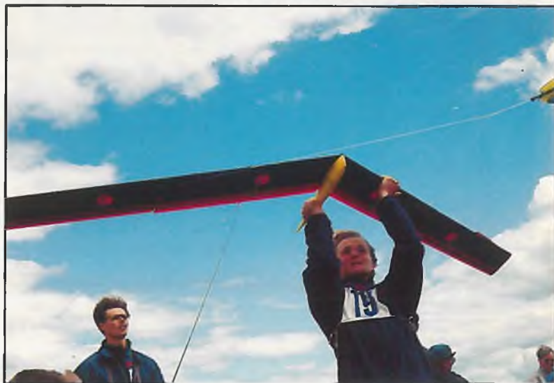
Ein typischer heutiger Leistungsnurflügel: Hochfestgebautes, gepfeiltes Brett mit Winglets. Im Bild Start des Modells des zweitplatzierten Christian Tollmien
