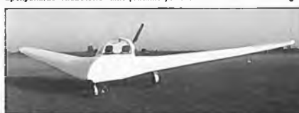
z.B. für die PUL 10, einem zweisitzigen Ultraleicht-Nurflüger aus R&G-Faserverbundwerkstoffen
