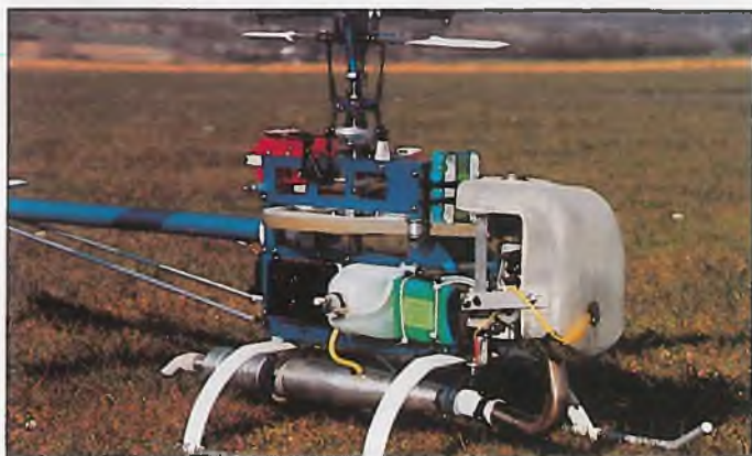
Der Motor sitzt ganz vorne und ist so für Wartungsarbeiten sehr gut zugänglich
