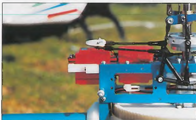
Hinter der Taumelscheibe ist der kugelgelagerte Schiebeshcft für die mechanische Mischung der Taumelscheibensteuerung
