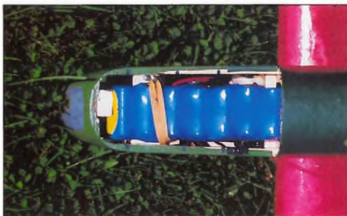
Im Rumpf, leicht zugänglich, der Akku. In den Gondeln, ebenso leicht zugänglich, die „Speed 400“ mit Getriebe
