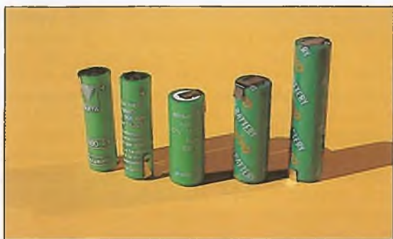
Die NiMH-Zellen VH 900 AA (Made in Germany) und VH 1500 4/5A, HR-A und HR-4/3A (Made in Japan) konnten bis zu 3 CA-Entladungen getestet werden
