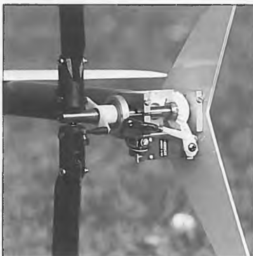
Das offene Heckgetriebe strahlt Stabilität und Zuverlässigkeit aus. Das Heckservo ist direkt darunter angeschraubt, wodurch eine sehr direkte und spiefreie Anlenkung realisiert werden konnte
