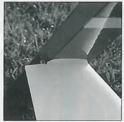
Die Höhenruderanlenkung ist gut versteckt und ist mit Kugelkopfgelenken bestückt
