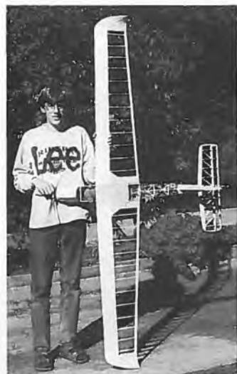
Der Modell-ULF im Rohbau; nach ohne Querruder, was sich bald als fatal erweisen sollte
