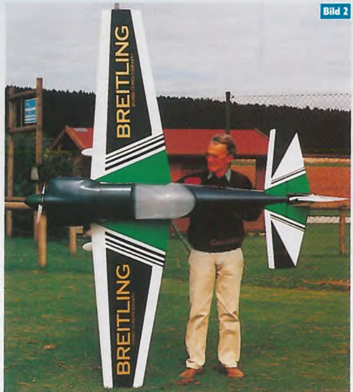
Bild 1: Die Testkandidaten von robbe; in der Tabelle ist mehr über die einzelnen Antriebe zu lesen und vor allem über deren Eignung für unterschiedliche Elektro-Großmodelle Bild 2: Die CAP 231 des Autors, im Artikel mehrmals erwähnt und in der FMT 1/96 ausführlich vorgestellt. Hier noch einmal die Kurzdaten: Motor Keller 240/6, Getriebe Synchro Gear 2500, Akku 52xSanyo N 1700 SCRC, Regler d53-100Go, Prop 20x10"
