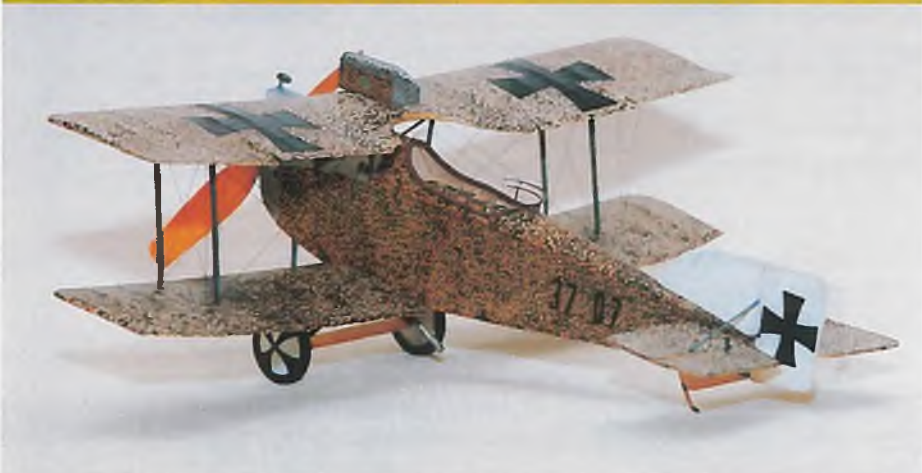
Fokker EIII, Größe „Pistachio“ (200 mm Spannweite), Motor G5, Fluggewicht 5,1 g. Auf der Filmschachtel findet Platz der „Wild WTI“, Nachbau eines schweizerischen Doppeldeckers aus dem Jahre 1924. Bunt gesprenkelt und sehr detailliert ausgeführt ist der Nachbau des „Aviatik CI“. 8,8 g Fluggewicht, Flugzeiten 30-40 Sekunden
