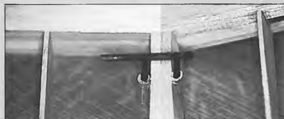
Innen- und Außenflügel mit der Klammerfixierung. Die Teile werden erst bespannt und anschließend zusammengelebt
