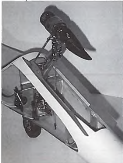
JK-Klapptriebwerk und Einziehfahrwerk an einer ASW 27 mit 5 m Spannweite: Sehr schmaler Rumpfausschnitt durch patentrechtl. geschützten Hauptträger der Triebwerkskonstruktion.
