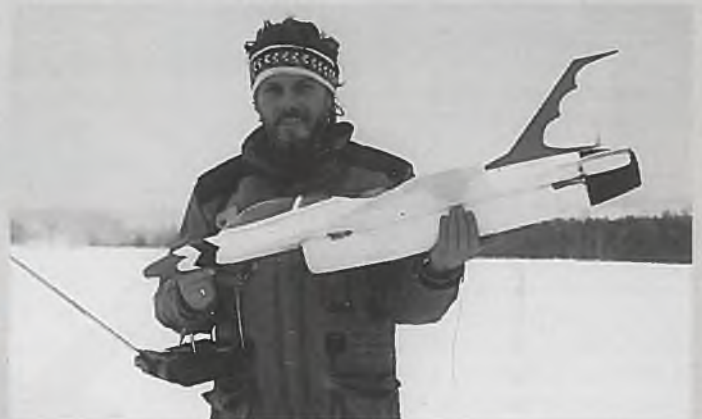
Der Erstflug im Schnee. Dank der Leichtbauweise hat die F 16 eine Flächenbelastung von 70 g/dm 2 bei einem Abfluggewicht von 1300 g
