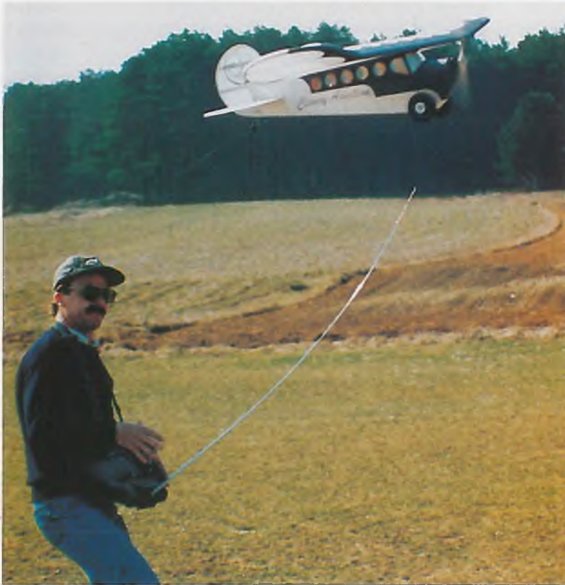
Der Handstart ist die einfachste Methode, um die Lazy Bee in die Luft zu befördern; Bodenstart ist dagegen wegen des schmalen Fahrwerks eine knifflige Angelegenheit
