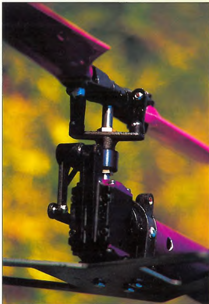
Das Alu-Heckgetriebe ist hochwertig und präzise, auch wenn die verwendeten Kegelräder relativ laut abrollen.
