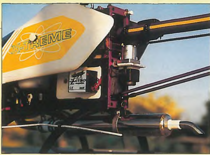
▲ Inzwischen hat sich der X-Treme, hier mal wieder mit einer weißen Standard-Haube, zum beliebten Versuchsträger entwickelt, wie die drei verschiedenen Piezo-Kreisel zeigen.
