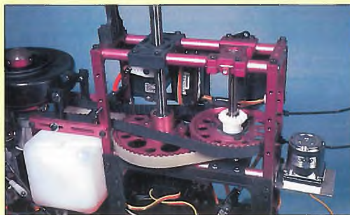
Das neue Getriebe im eingebauten Zustand. Die eloxierten Alu-Zahnriemenräder sehen einfach edel aus.
