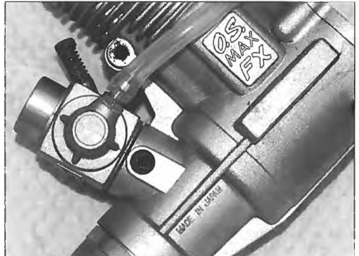
Vergaser mit getrennter Vollgas- und Leerlaufgemischregulierung.
