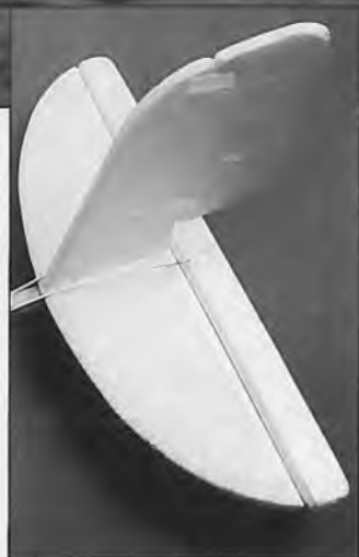
Seiten- und Höhenruder werden mit Schaumgummischarnieren befestigt
