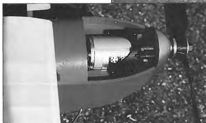
Die wirkliche Arbeit leistet in diesem Fall ein Speed 480 Turbo mit Getriebe
