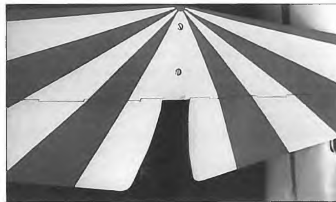
▲ Spaltfreie Befestigung am Beispiel des Höhenruders. Im getrennten ...
