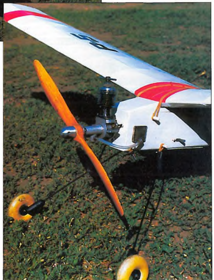
Der Selbstzündermotor K-16 ist ein Original aus den späten 40er Jahren.
