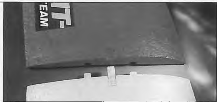
Die Verbindungsstelle von Mittelteil und Flächenohr. Die Ohren werden stumpf angesteckt und mit Klebeband befestigt.
