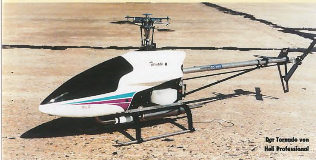
Das Heckgetriebe des Tornado ist aus Alu gefräst, der Antrieb erfolgt über einen Zahnriemen.
