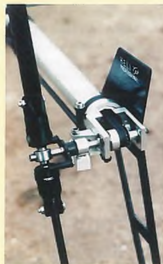
Das Heckgetriebe des Tornado ist aus Alu gefräst, der Antrieb erfolgt über einen Zahnriemen.
