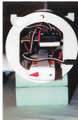
Kopf ab – dann kann man in den Rumpf schauen und Akku und Empfänger sehen.
