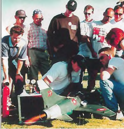
Sorgte am Rande des Geschehens für reichlich Aufsehen: In aller Eile wurde dieses Modell vor der Veranstaltung mit einer Nachbrenner-Turbine von skypipe ausgestattet und im Standlauf erprobt. (Foto: Alfred Kirst)
