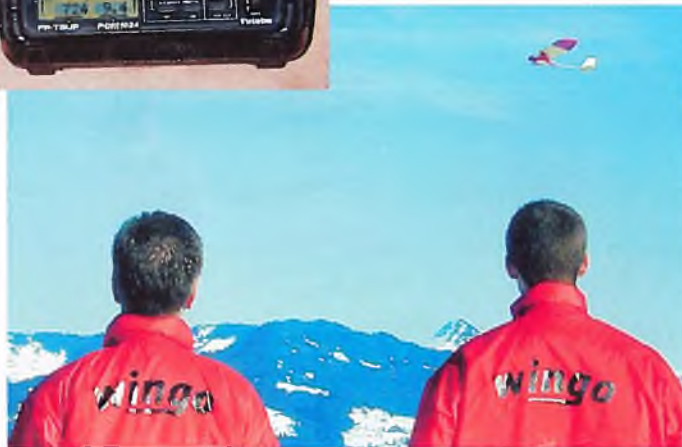
▲ Der Lehrersender Futaba T 9ZHP (Robbe-Bezeichnung PCM 1024 9Z) links erlaubt die im Text angesprochene Übersteuerung, der Schülersender ist ein Futaba FP-8UP (Robbe-Bezeichnung Field Force FF8).
