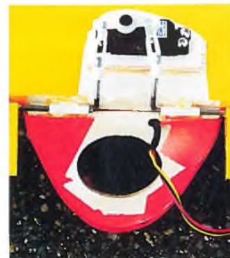
Die Querruderanlenkung mit einem Servo.
