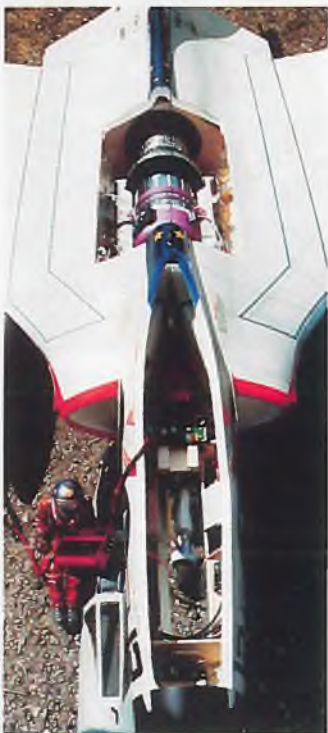
Die Skyray von J. Hennebühl kann sich nicht nur äusserlich sehen lassen. Auch im Inneren ist alles vorbildlich geordnet. Eine Jet-Cat P-120 dient als Antrieb, zwei Colafaschen werden als Tanks genutzt.
