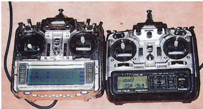
▲ Der Lehrersender Futaba T 9ZHP (Robbe-Bezeichnung PCM 1024 9Z) links erlaubt die im Text angesprochene Übersteuerung, der Schülersender ist ein Futaba FP-8UP (Robbe-Bezeichnung Field Force FF8).
