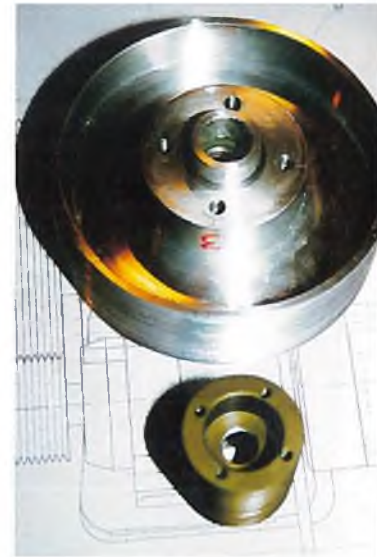
Die Riemenscheiben bilden die Basis der Getriebekonstruktion. Die kleine Scheibe sollte nach dem Einlaufen hart eloxiert werden.
