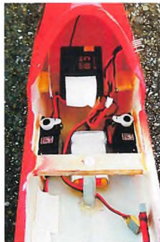
Hier sieht man den RC-Einbau und den Querträger für die Flächenbefestigung.
