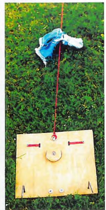
So könnte auch eine Fußauslösevorrichtung aussehen. Der Lappen dient zum Bremsen des Seils nach dem Ausklinken.
