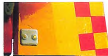
Das Spornrad wird direkt am Seitenruder befestigt.
