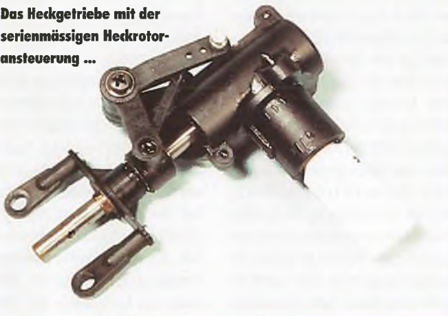
... und jetzt mit der High-End-Scherenanlenkung.
