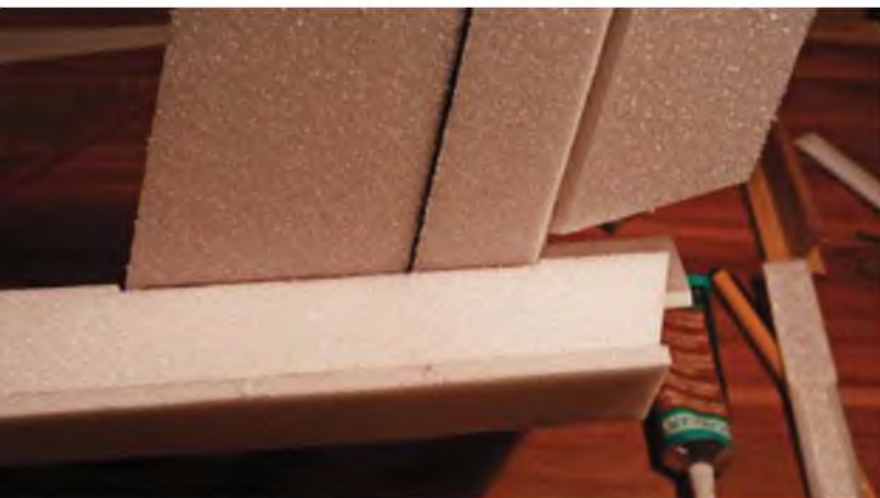
Die Aufnahme für das Leitwerk wurde angepasst. Dann wird das Leitwerk ausgerichtet und auf den Rumpf geklebt.
