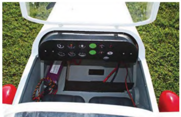
Der Bausatz enthält auch einen Satz Armaturen aus vorgefrästem Sperrholz. Die runden Anzeigen werden mit PVC-Abschnitten eingesetzt und die farbigen Anzeigen anschließend vor eine Klarsichtfolie geklebt.
