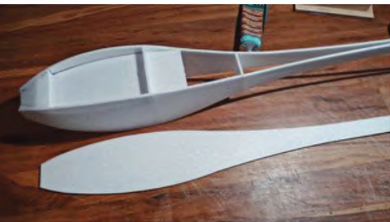
Beim Verkleben des Rumpfbodens lässt man den Kleber nicht abblüften, so können noch Korrekturen vorgenommen werden.
