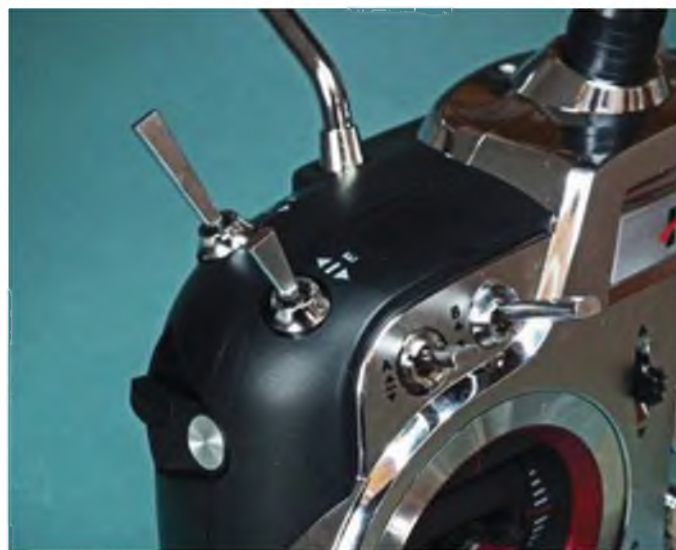
Auf der linken Schulter trägt der Sender neben dem seitlichen Drehgeber zwei drei- und zwei zweistufige Kippschalter. Deren Verwendung können Sie völlig frei wählen.
