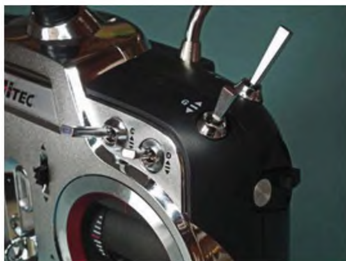
Auf der rechten Seite ist ebenfalls ein Drehgeber neben dem zweistufigen Moment-Schalter und den drei dreistufigen Kippschaltern untergebracht. Auch hier ist die Funktionszuordnung frei.
