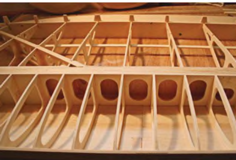
Die Abstände der Flächenrippen sind durch eine Hilfsleiste vorgegeben. Diese wird winklig auf dem Baubrett verschraubt. So hat man nicht nur die korrekten Abstände sondern auch die Gewähr, dass es keinen Verzug gibt.
