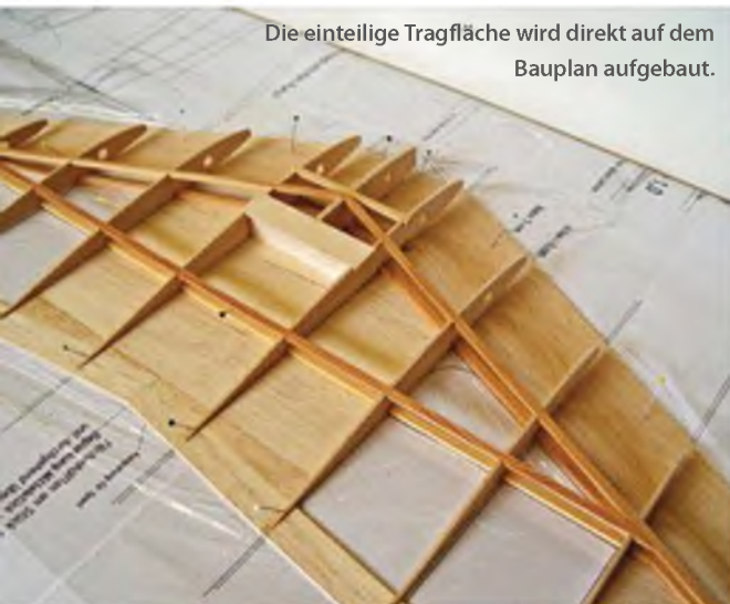
Verkleben der unteren Nasenbeplankung.
