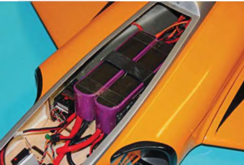
Trotz des engen Rumpfes passt der 6s-5.000-mAh-LiPo noch problemlos in den Habu.
