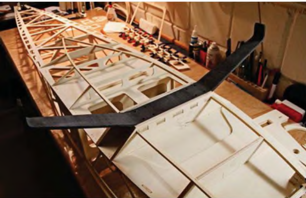
Das Hauptfahrwerk ist platziert und muss später noch verschraubt werden.
