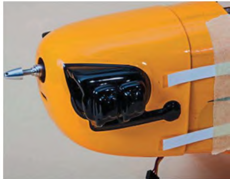
Die genaue Position der Befestigungsschrauben für die Motorhaube lässt sich mit Hilfe von Kartonstreifen übertragen.
