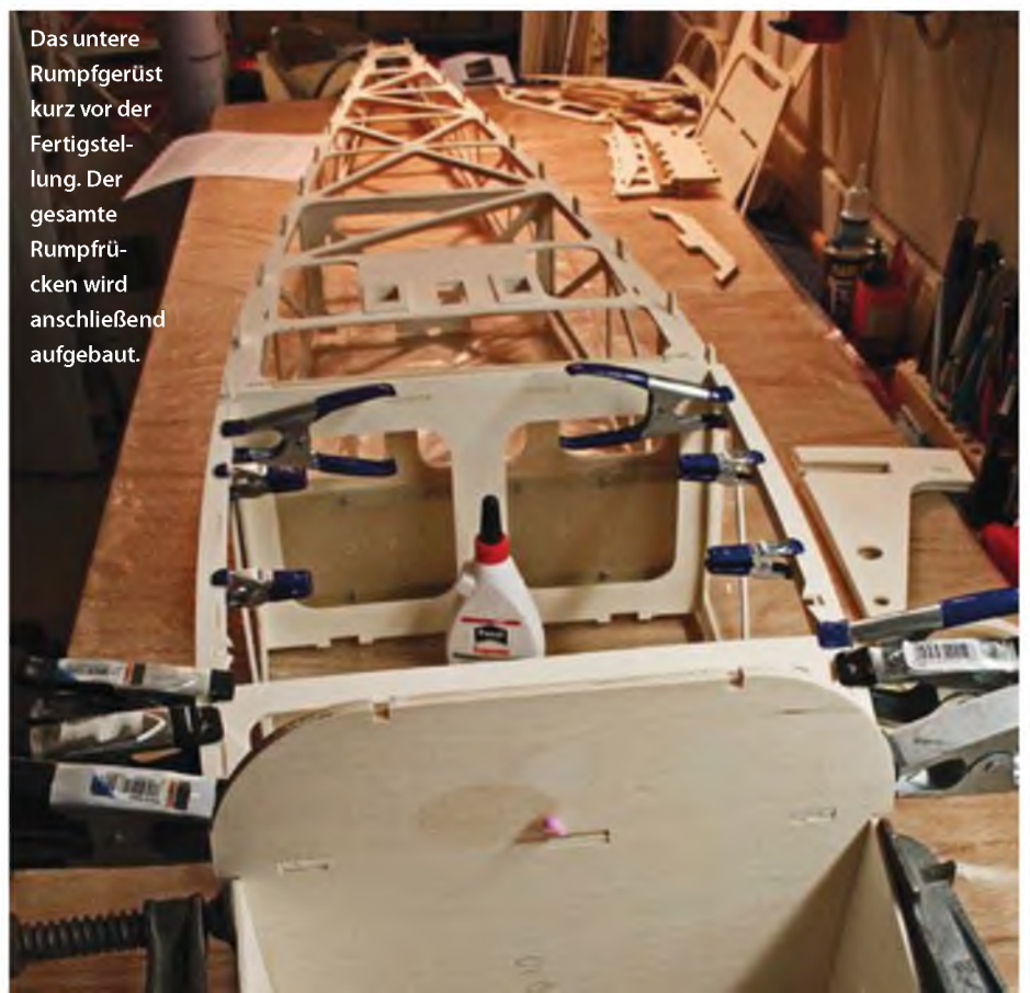
Die Seitenteile und der Rumpfboden werden als vorbereitende Arbeiten zusammengesteckt und verleimt. Das Servo gibt schon einmal eine Vorstellung von den Abmessungen des Rumpfes.
