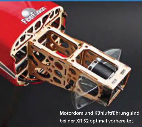
Der Regler hängt direkt unter dem Dom, die Kühlrippen wurden vom Schrumpfschlauch befreit.
