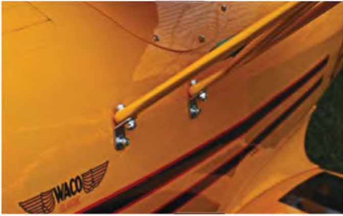
Die Aufnahme der Strebenhalter ist auch rumpfseitig perfekt vorbereitet, dank bereits herstellereitig eingebauter Einschlagmuttern.
