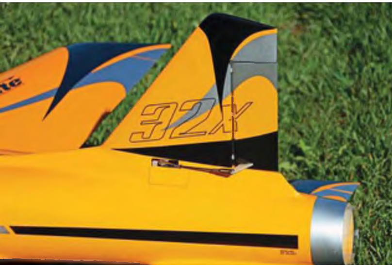
Das Seitenruder in Holzbauweise wird mit Stiftscharnieren angeschlagen, der Einbau des Servos ist perfekt vorbereitet und auf den empfohlenen Servotyp zugeschnitten.
