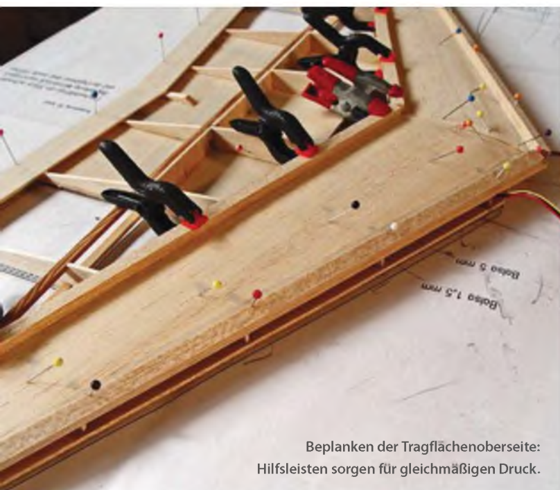
Die Servokabel werden in Trinkhalmen geführt.
