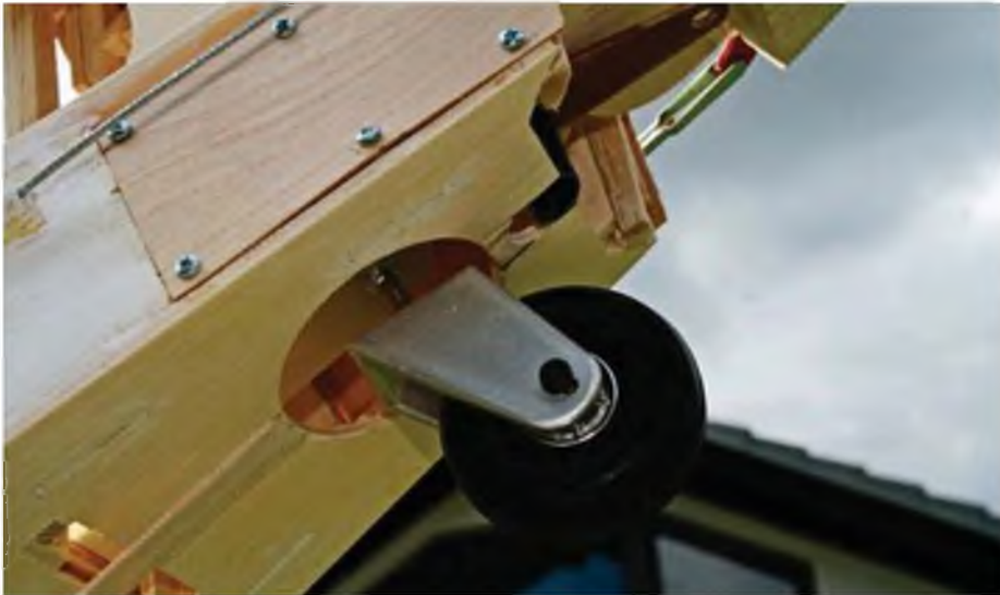
Das Spornrad ist mit einer GFK-Feder schwingend gelagert.
