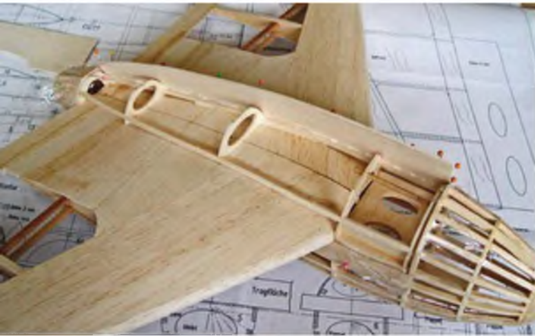
Rumpf und Tragflächen der Prototypen wurden mit Papier bespannt.
