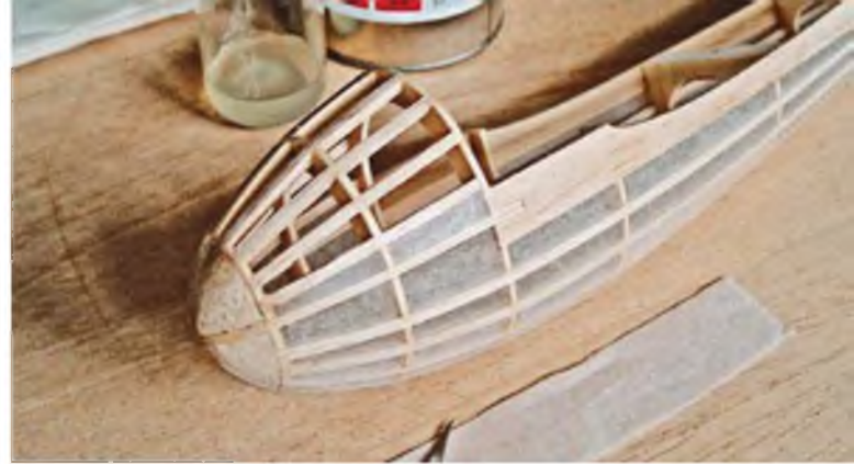
Rumpf und Tragflächen der Prototypen wurden mit Papier bespannt.
