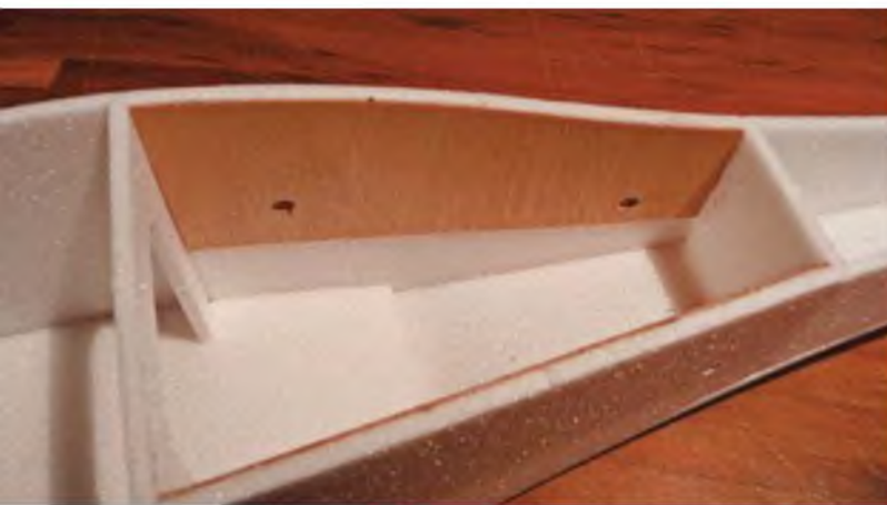
Die Sperrholzverstärkungen für die Flächenaufnahme. Sie werden mit den Rumpfsseiten oben bündig eingeklebt.
