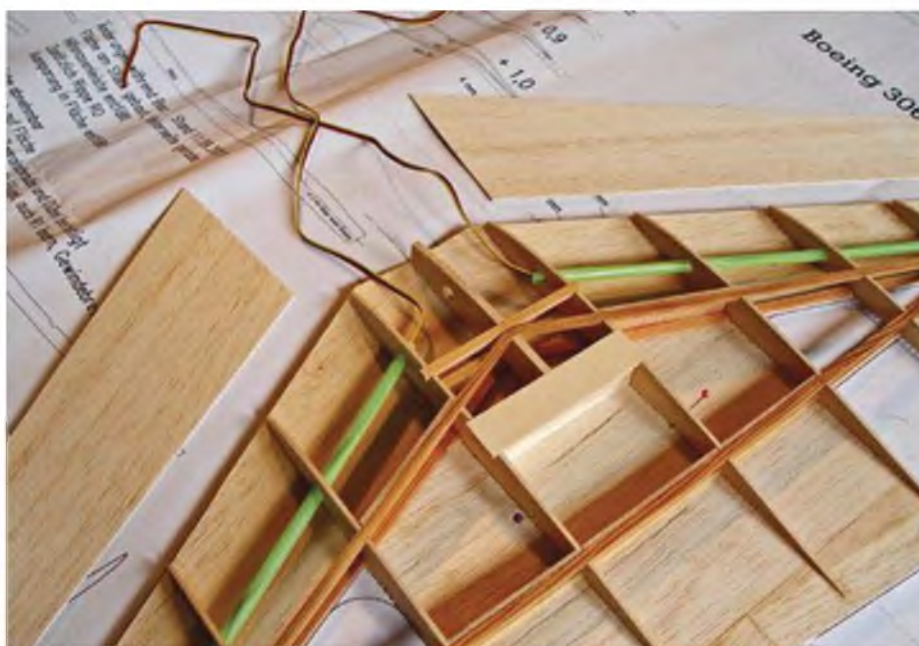
Die Servokabel werden in Trinkhalmen geführt.
