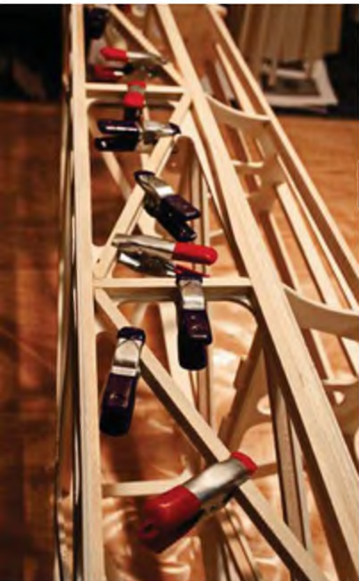
Zur weiteren Verstärkung des Rumpferüsts werden Streben aus Kiefer in Form geschnitten und verleimt.
