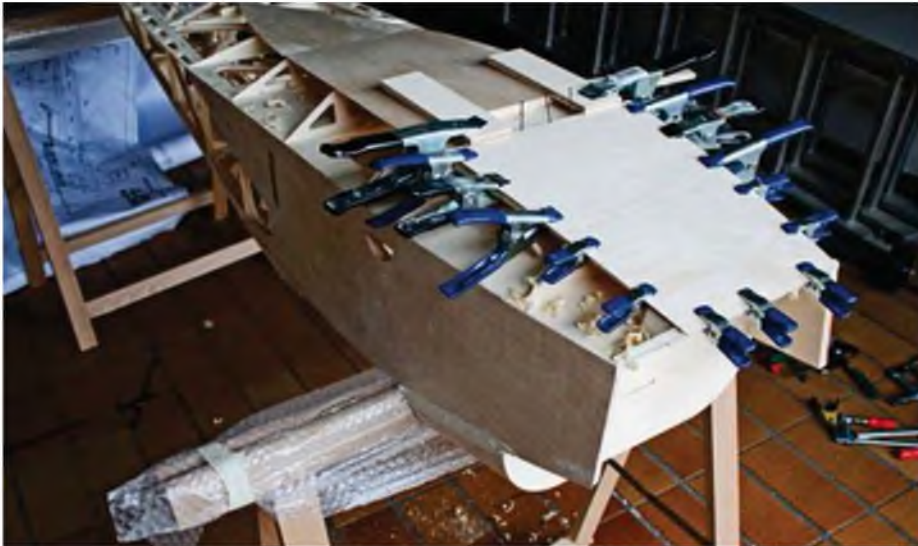
Die Sperrholzbeplankung ist fast fertig gestellt. Der hintere Rumpfbereich ist wie beim Original nur bespannt.
