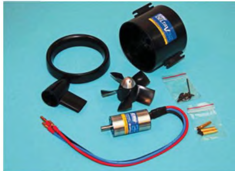
Der Impeller muss noch zusammengebaut und der Motor montiert werden. Aerodynamisch sauber zeigt sich der Abströmkonus und die Kabelführung.
