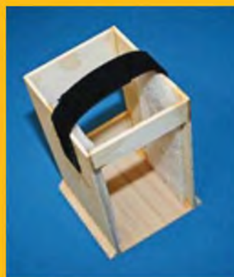
Die Rumpfföffnung und der Akkuschatz müssen in Eigenregie erstellt werden. Die zuvor ausgetrennte Klappe ist lediglich über ein Stück Klebefilm anschärnt und wird über einen Kabinenhauben-Verschluss gesichert. Damit ist ein bequemer Wechsel des Akkus möglich.
