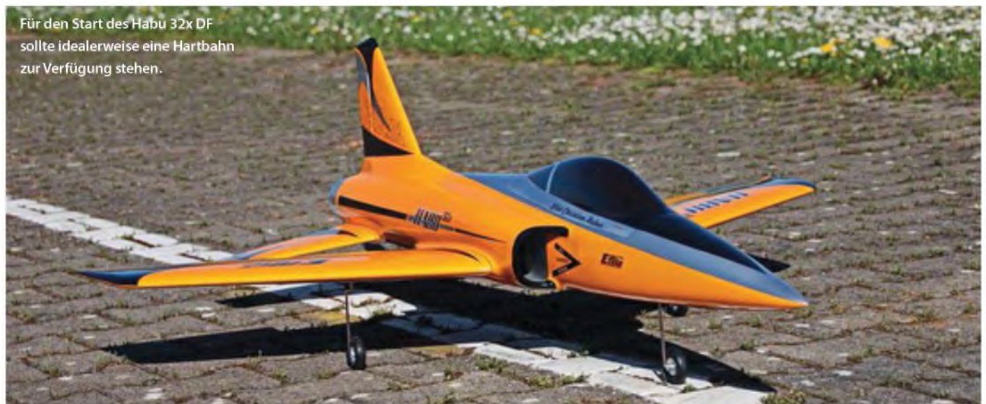
Trotz des engen Rumpfes passt der 6s-5.000-mAh-LiPo noch problemlos in den Habu.
