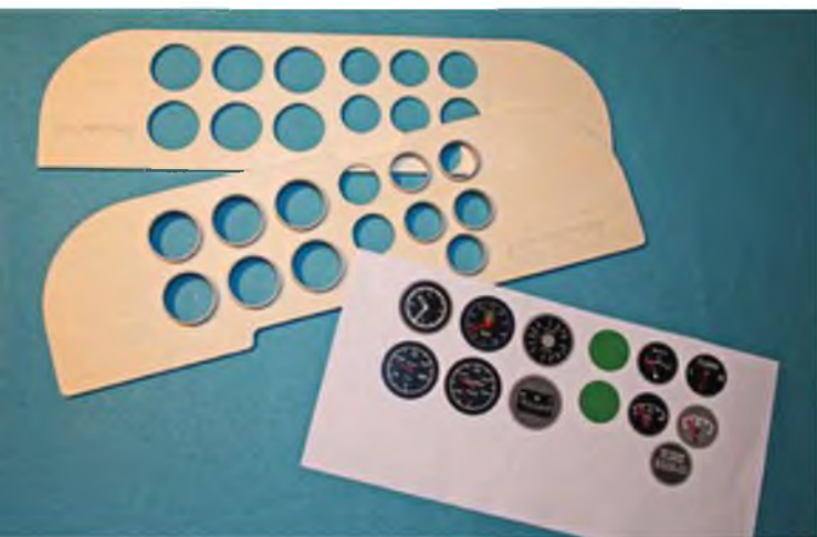
Der Bausatz enthält auch einen Satz Armaturen aus vorgefrästem Sperrholz. Die runden Anzeigen werden mit PVC-Abschnitten eingesetzt und die farbigen Anzeigen anschließend vor eine Klarsichtfolie geklebt.
