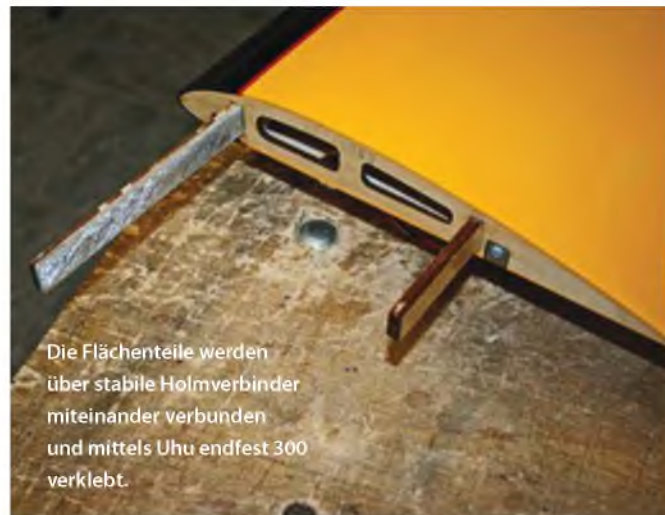
Die Strebenhalter sind je nach Biegewinkel sortiert abgepackt und binnen Minuten montiert. Für eine feste Verschraubung sorgen eingeklebte Hartholzteile.
