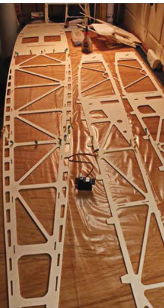
Die Seitenteile und der Rumpfboden werden als vorbereitende Arbeiten zusammengesteckt und verleimt. Das Servo gibt schon einmal eine Vorstellung von den Abmessungen des Rumpfes.
