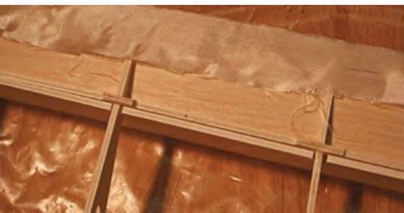
Zur Verstärkung kommt zwischen die Endleistenbeplankung der Querruder jeweils ein Streifen Glasgewebe mit Harz.
