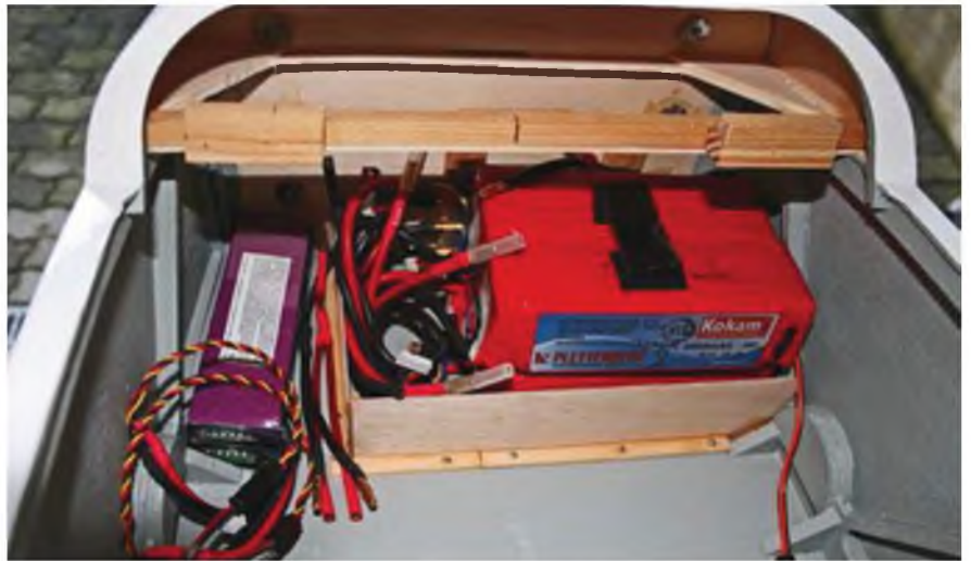
Die Antriebsakkus werden in einem Sperrholzrahmen mit Klettband gesichert. Die beiden Empfängerakkus sind mit einer Akkuweiche von Emcotec verbunden.
