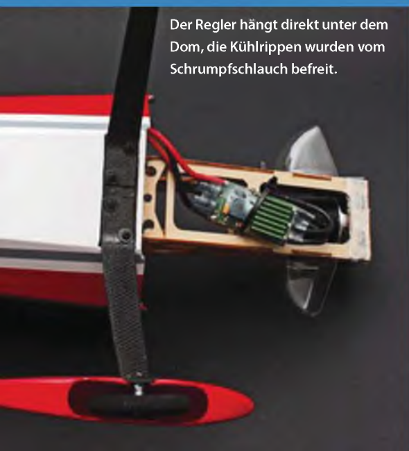
Motordom und Kühlluftführung sind bei der XR 52 optimal vorbereitet.
