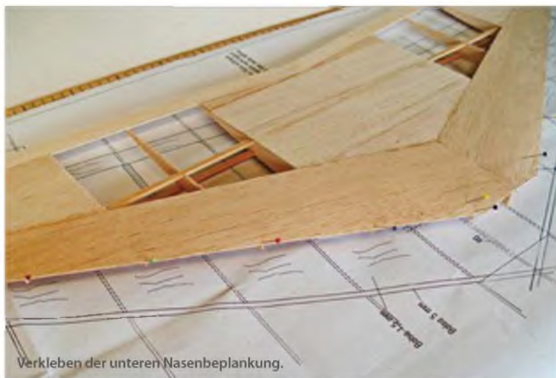
Die einteilige Tragfläche wird direkt auf dem Bauplan aufgebaut.
