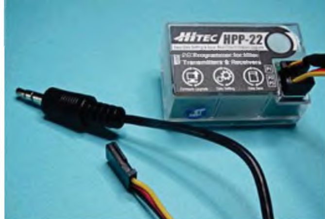
Das HPP-22-Interface verbindet Sender und Empfänger mit einem Windows-PC. Damit ausgerüstet kann man Softwareupdates ausführen und Telemetriedaten auf dem Rechner darstellen.
