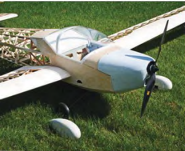
Die zweiteilige Motorhaube passt sich sehr gut dem gesamten Erscheinungsbild an. Als Scale-Detail sind die Fußtritte für den Einstieg vor der Tragfläche gut zu erkennen.
