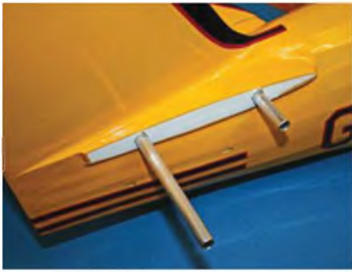
Das Höhenleitwerk wird über zwei gut dimensionierte Alu-Steckungen mit dem Rumpf verbunden und verklebt.
