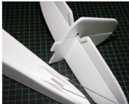
Die komplette Leitwerkseinheit wird mit dem Rumpf verklebt. Danach verbindet man die Steuerungsdrähte.
