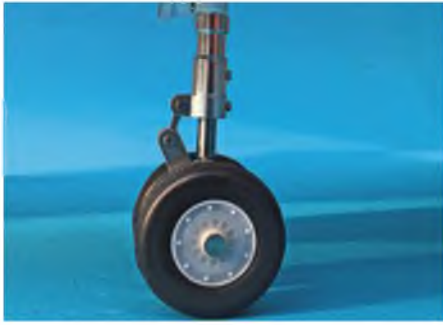
Das Fahrwerk ist komplett aus Metall, gefedert, sieht scale aus und verträgt auch mal eine „Flugzeugträgerlandung“.
