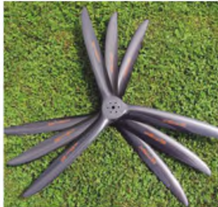
Die drei Engel-Propeller. Der 30x14 Zoll große Propeller hat sich als ideal erwiesen.
