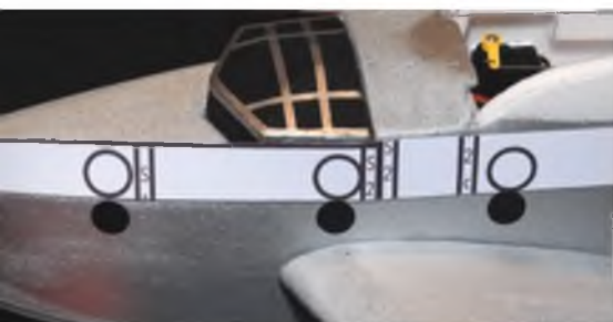
Zur Übertragung der Fenster-Positionen befestige ich den entsprechenden Ausschnitt des Plans mit wenig klebendem Tesafilm am Modell.
