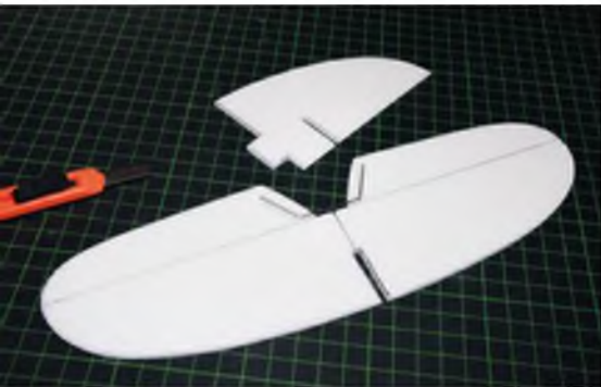
Die beiden Höhenruderhälften sind mit einem Reststück Draht und Epoxid-Harz verbunden. Das Ruderscharnier entsteht mit UHU Por oder einer anderen leichtgängigen Lösung.
