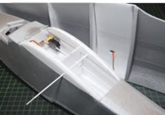
Die Tragflächen-Einheit wird vorne unter den Rumpfdeckel gesteckt und hinten mit einem Bowdenzuginnenrohr gesichert.
