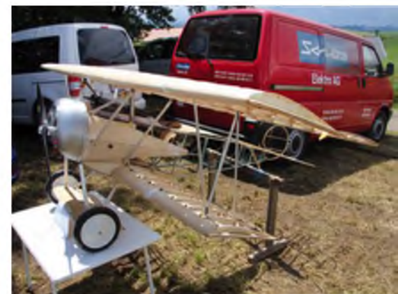
Auch die D VI von Martin Schulze, Vereinsmitglied in Huttwil, steht noch im Rohbau. Spw.: 2,4 m, Gewicht: ca. 12 kg.
