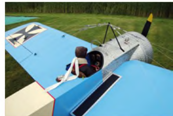
Diese Fokker E.III ist ein kompletter Eigenbau von Beat Egli im Maßstab von 1:2. Spw.: 5 m, Gewicht: 35 kg, Antrieb: Valach 170 cm 3 4T-Boxer. Perfekt gebaut bis zur kleinsten Schraube – die Detailtreue ist unglaublich.
