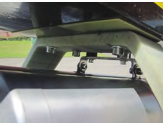
Beide Dämpfer sind schwingungsgedämpft mittels eines U-Halter aus 3-mm-Alu gelagert.
