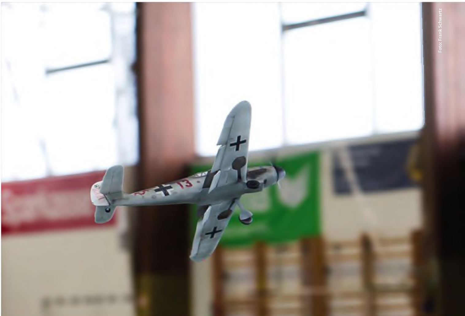
Die Fahrwerksbeine bestehen aus Q-Tips-Wattestäbchen, die Reifen sind aus Depron. Für besseren Grip sind sie mit dem Streifen eines Einweghandschuhs belegt.
