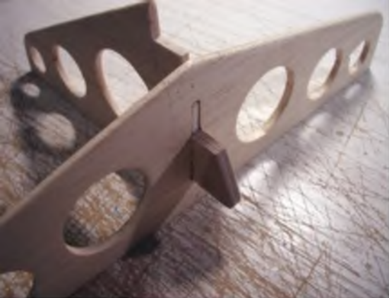
Das Seitenleitwerk sitzt in einem Schlitz im HLW. Von unten wird dann auch der Hecksporn im HLW eingelassen.
