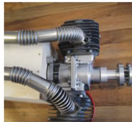
Die fertig gebogenen Krümmer sitzen perfekt zu den Schalldämpfern.
