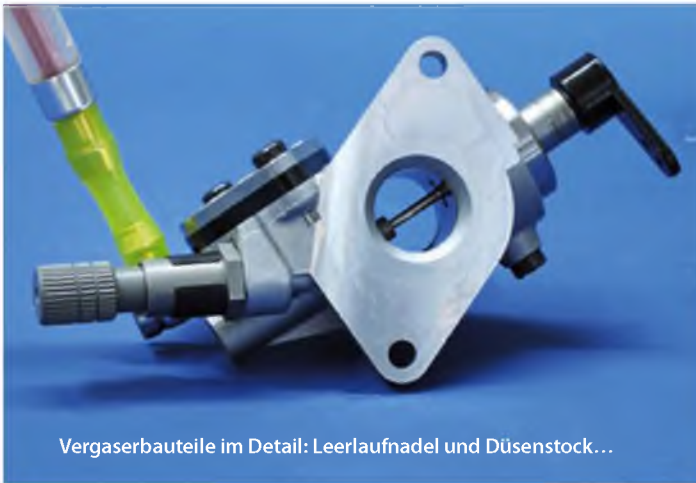
... sowie der integrierte Kraftstoffdruckregler.
