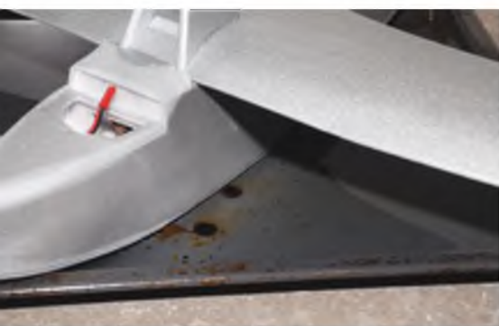
Vor der Befestigung der Stummel am Rumpf wird deren Position vom Plan auf die Seitenteile übertragen. Die Markierung prüft man (mit Akku an Bord) im Wasserbad.
