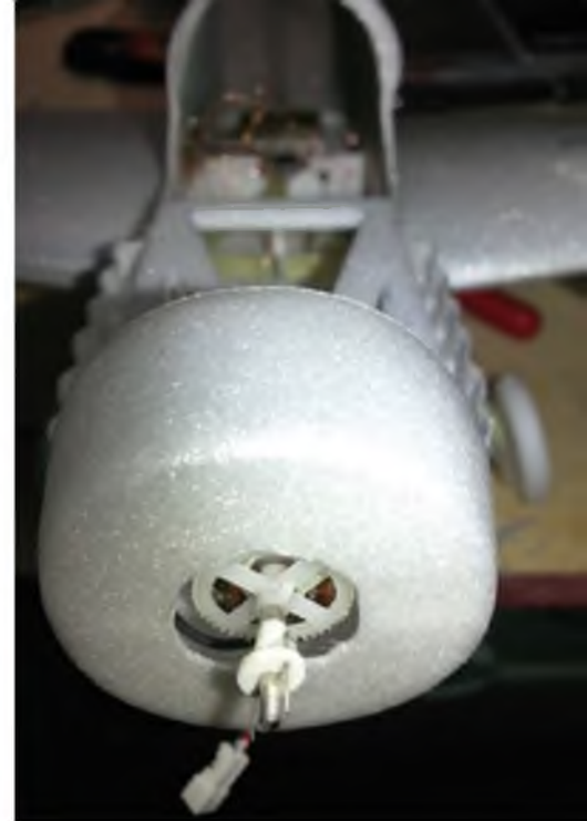
Die 5x4x3-Microinvent-CFK-Luftschraube passt von der Form und Größe sehr gut zum Maßstab. Der Luftschaubenmitnehmer ist auch selbst hergestellt.
