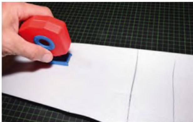
Tesafilm wird zur Verstärkung auf die Unterseite der Tragfläche geklebt. Bei dem angestrebten niedrigen Abfluggewicht reicht die Stabilität der profilierten Tragfläche, unterstützt durch diese einfache Maßnahme, aus.
