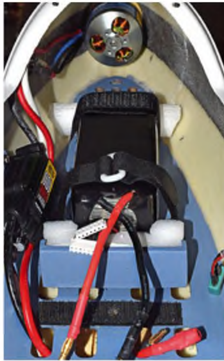
Der Flugakku kommt direkt vor dem Motor zum Liegen. Daher muss ein kleiner Ausschnitt in die Cockpitwanne (siehe Bild rechts) geschnitten werden.
