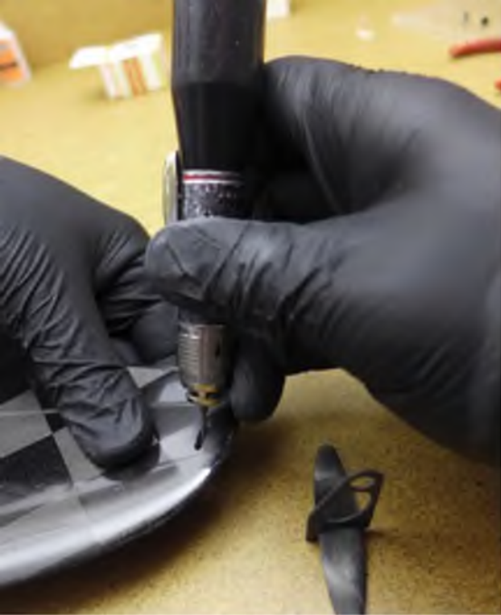
Die vertikale Öffnung für das Blade wird vorsichtig passgenau freigelegt.
