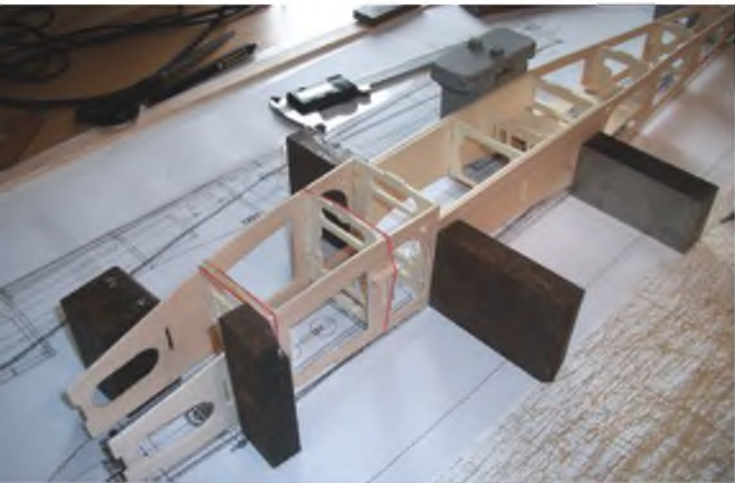
Ausgerichtet auf dem Bauplan werden die Bug- und Heckspanten gesetzt.
