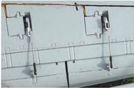
Alle Ruder sind mit Kunststoffscharnieren angeschlagen und mit Kugelköpfen angelenkt. Die Querruder und Landeklappen sind in Hohlkehlen gelagert.
