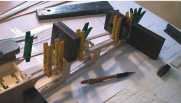
Dreikantleisten auf den Seitenteilen schaffen Klebefläche für Boden und Deckel.
