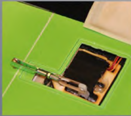
Die Servos wurden mit den ebenfalls bei Staufenbiel erhältlichen Rahmen befestigt. Im Rahmen fixiert habe ich sie mit einigen Tropfen Heißkleber.
