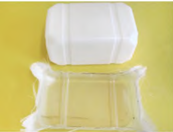
Den 1,5-l-Tank habe ich abgeformt und so eine perfekte Befestigung im Rumpf erreicht.
