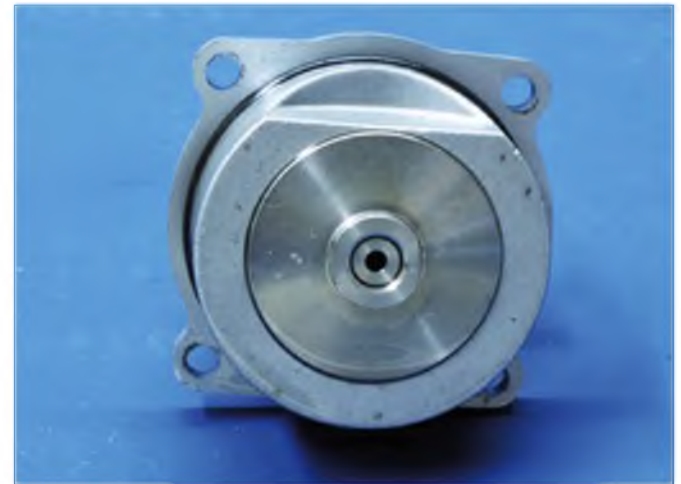
Der hintere Gehäusedeckel ist mit einem O-Ring abgedichtet. Die Stahlplatte hält das Pleuel auf dem Kurbelzapfen, das Loch in der Mitte ist der Druckanschluss für den Pumpenantrieb.
