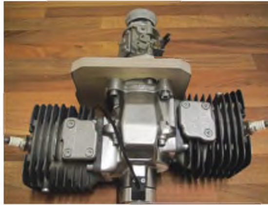
Der 12-mm-Motorspant ist vorbereitet für den finalen Einbau.
