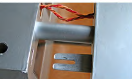
Ein Alurohr dient als Flächenverbinder. Die geschlitzte Lasche wird zusammen mit der Fläche in den Rumpf geschoben und anschließend durch eine Inbusschraube im Rumpf gesichert.
