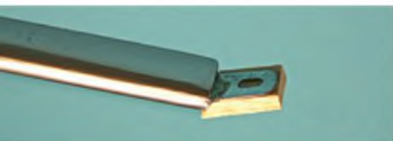
▲ ▼ An den Flächenstreben befinden sich Metalllaschen, die an der Fläche verschraubt werden sollen. Zusätzlich Balsaabschnitte auf den Laschen ergeben einen bessern Sitz und verhindern das Eindrücken der Beplankung.
