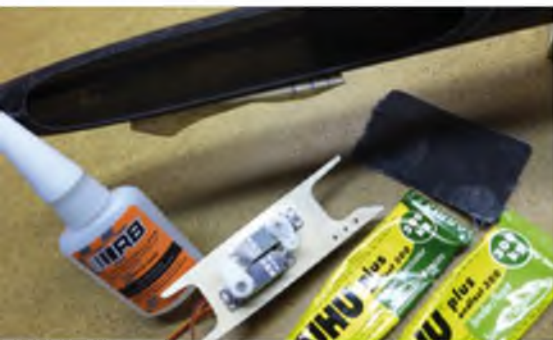
▼▲ Am Servobrett zeichnet man zunächst die gewählte Position der Servos an, dann sägt man es zu und klebt es in den Rumpf.
