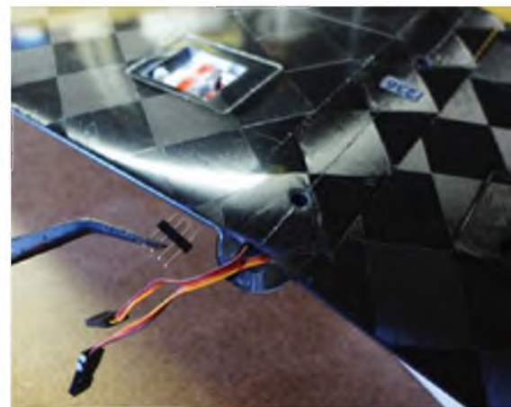
Die elektrische Verbindung der Fläche habe ich mit einem umgebauten Vierpolstecker realisiert.
