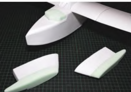
Die Abschlüsse der Stummel und das Cockpit habe ich aus massivem Styrodur geschnitten und verschliffen. Alternativ kann man diese Teile aus mehreren Schichten Depron fertigen.
