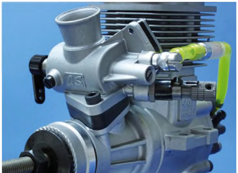
Der Zweinadelvergaser mit Druckregler – die kleine Schlitzschraube ist die Leerlaufnadel. Auch zu sehen: der Feinfilter in der Vergaserzuleitung.
