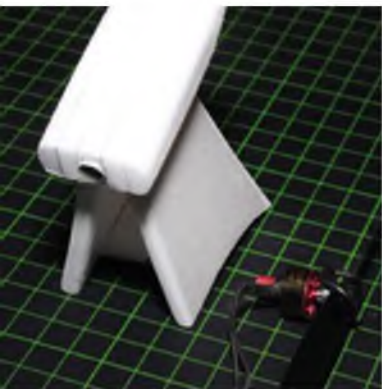
Das Motorgehäuse besteht aus fünf Lagen 6-mm-Depron und wird rund geschliffen.
