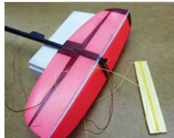
Das Einziehen der Seile für die Ruder geht mit Kupferlackdraht wunderbar.
