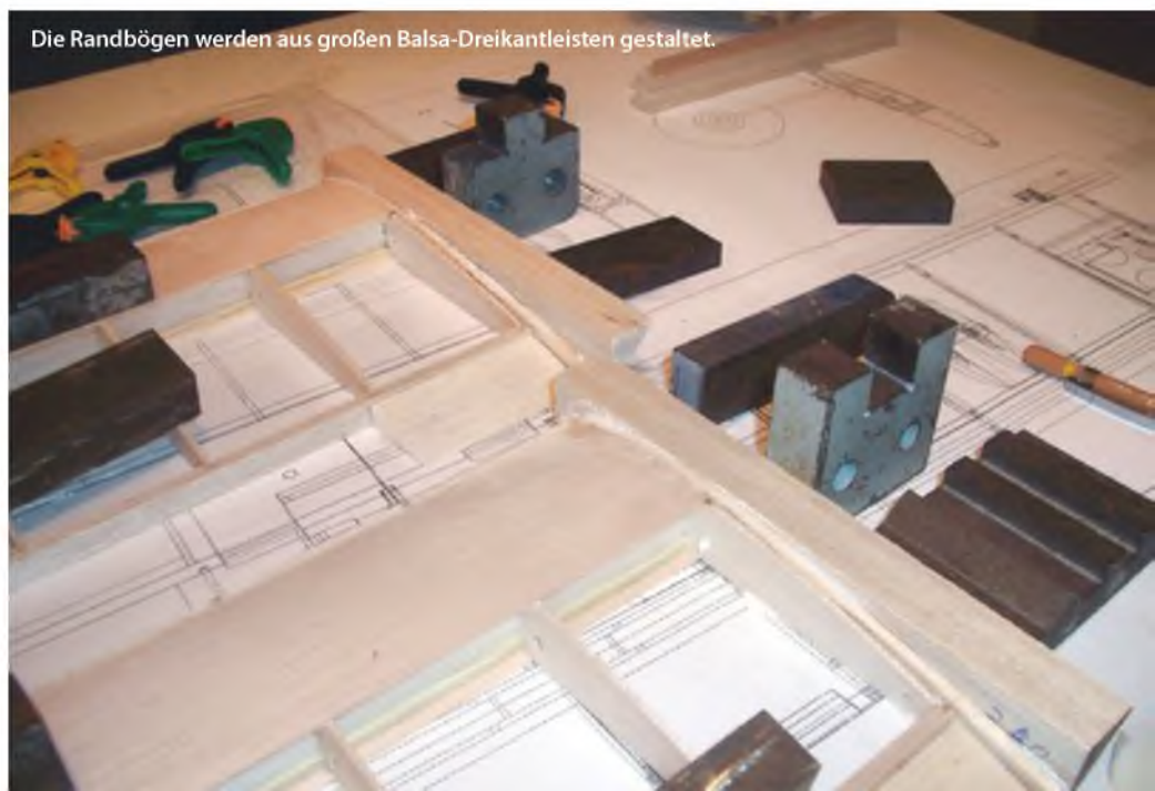
Verbinden der beiden Flügelhälften, ausgerichtet auf dem Bauplan.
