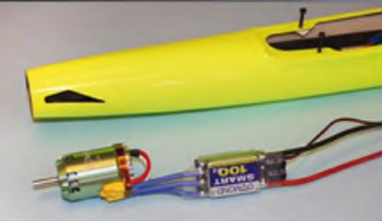
Der Regler wird direkt mit dem Motor verlötet und die Kabel dabei möglichst platzsparend untergebracht. Dank der Kapselung des Antriebs braucht man keine Angst vor durchgescheuerten Kabeln haben.
