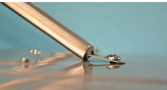
▲ ▼ An den Flächenstreben befinden sich Metalllaschen, die an der Fläche verschraubt werden sollen. Zusätzlich Balsaabschnitte auf den Laschen ergeben einen bessern Sitz und verhindern das Eindrücken der Beplankung.
