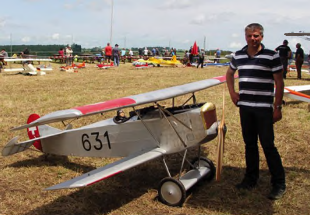
Die Fokker DVII von Rolf Fritschi ist elektrisch angetrieben. Spw.: 3,6 m, Gewicht 29,5 kg.
