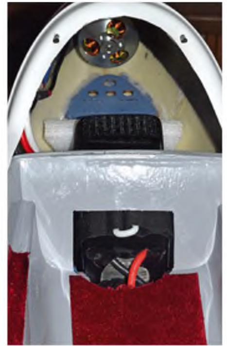
Der Flugakku kommt direkt vor dem Motor zum Liegen. Daher muss ein kleiner Ausschnitt in die Cockpitwanne (siehe Bild rechts) geschnitten werden.
