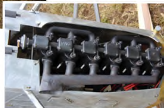
Unter der vorbildgetreuen Motorattrappe versteckt sich ein Hacker A 200.
