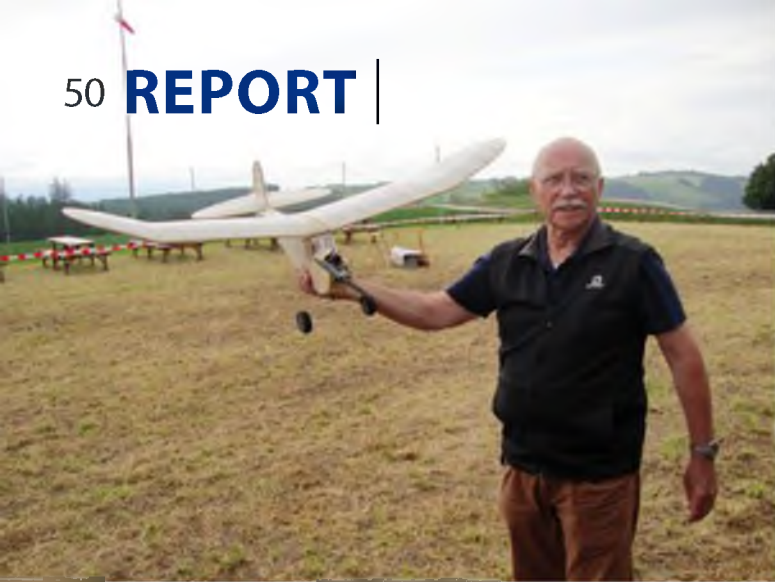
Gebaut nach einem alten Plan: der „Bulldozer“ im Regen von Huttwil. Spannweite: 112 cm, Länge: 77 cm, Gewicht: 580 g, Antrieb: Diesel Tai-fun Hobby. Die Steuerung erfolgt über Höhe, Seite und den Motorabsteller mittels einer Schlinge um den Schlauch der Spritzzufuhr. Gekoppelt mit einem Servo kann auf diese Weise einfach die Treibstoffzufuhr unterbrochen werden.
