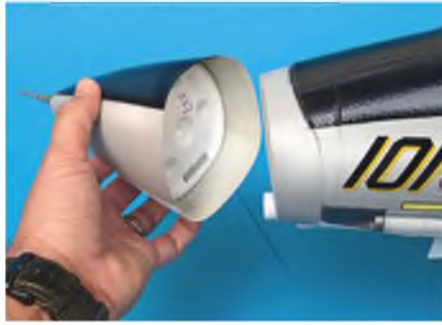
Die GFK-Nase ist abnehmbar, zum Transport ziehe ich sie immer ab.
