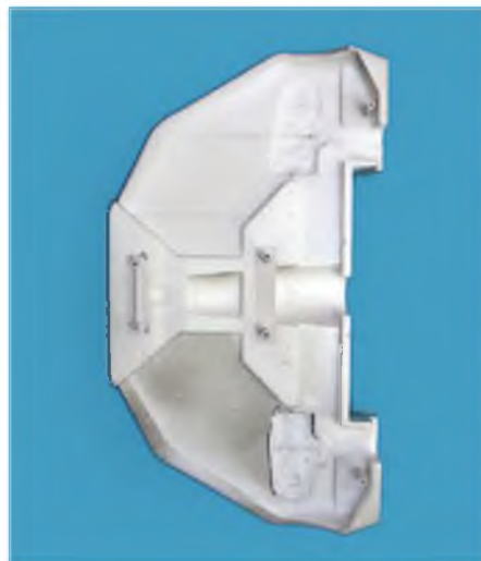
Die große Rumpfabdeckung sollte für einen guten Sitz an einigen Stellen etwas ausgefräst werden.
