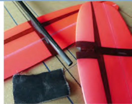
Das Rumpfenende wird zum Verkleben mit dem Seitenleitwerk angeraut.
