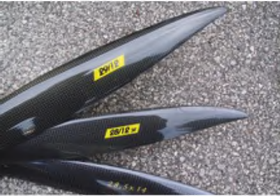
Die ersten drei Testpropeller. Schon bei den ersten Flügen hat sich gezeigt, dass 14 Zoll Steigung nötig sind, um die gesteckten Ziele in der Antriebsauslegung zu erreichen.
