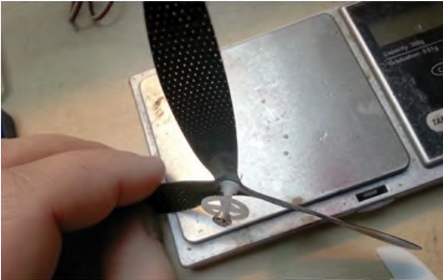
Die 5x4x3-Microinvent-CFK-Luftschraube passt von der Form und Größe sehr gut zum Maßstab. Der Luftschaubenmitnehmer ist auch selbst hergestellt.
