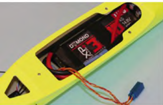
Der Akku findet im Rumpf bequem Platz, gehalten wird er von einer Klettbandschleufe.
