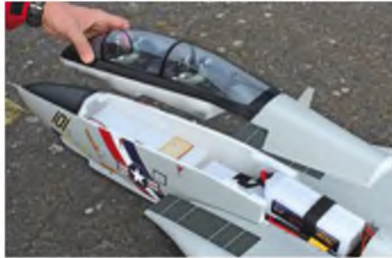
Die Kabinenhaube fungiert als Akkufachdeckel und ist vorn mit einem Dübel, mittig mit kräftigen Magneten und noch einem Schieberverschluss befestigt.
