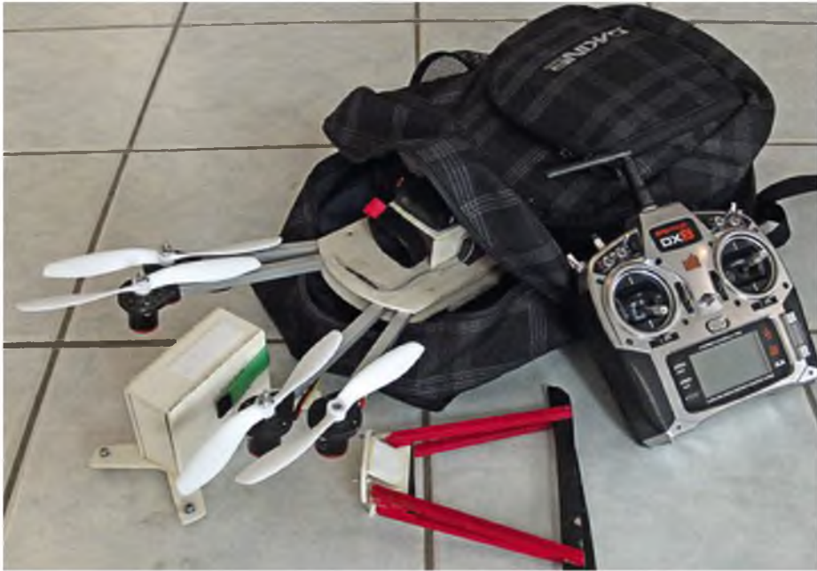
Ziel erreicht: Der Eigenbau-Copter lässt sich einfach in einem Rucksack verstauen.
