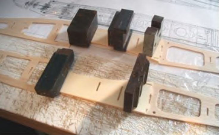
Die Rumpfsseitenteile werden im Bereich der Flächenaufnahme mit Pappelsperholz verstärkt.
