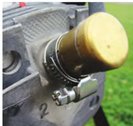
Die King-Zündkerzenstecker wurden mit je einer Schlauchschelle gesichert.
