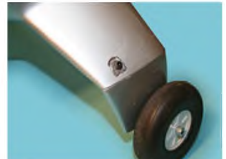
Die Flächenstreben werden am Fahrwerk befestigt. Die Bohrung im Fahrwerk muss in der Verkleidung freigelegt werden.
