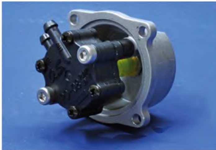
Der hintere Gehäusedeckel ist mit einem O-Ring abgedichtet. Die Stahlplatte hält das Pleuel auf dem Kurbelzapfen, das Loch in der Mitte ist der Druckanschluss für den Pumpenantrieb.
