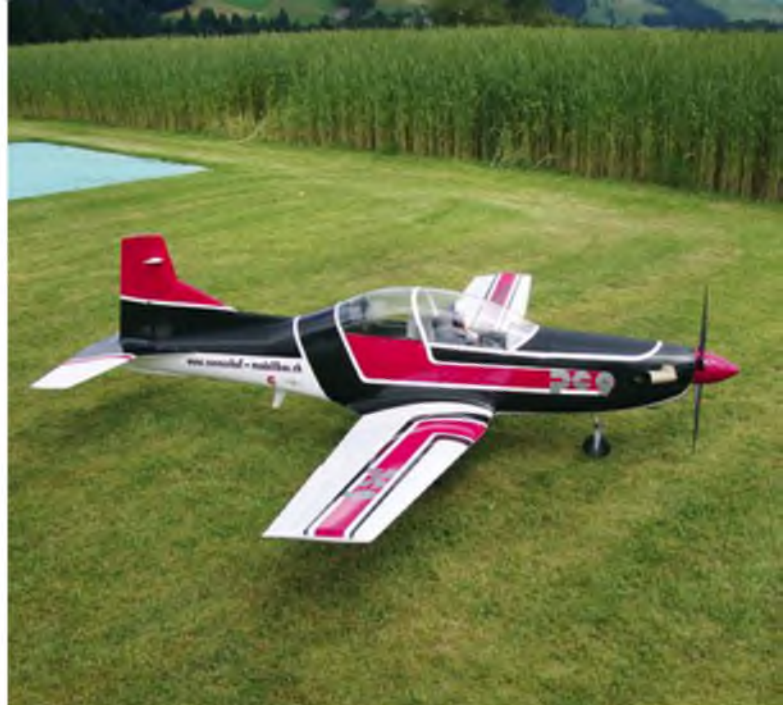
Pilatus PC-9 von Meinrad Kammerlander: Maßstab 1:4, Spannweite: 2,53 m, Gewicht: 17 kg, Antrieb: 3W-85Xi.
