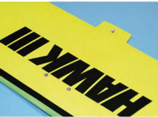
Die Tragfläche wird mit drei Schrauben auf dem Rumpf gehalten. Sowohl die Tragfläche als auch der Rumpf sind hierfür exakt passend vorbereitet.
