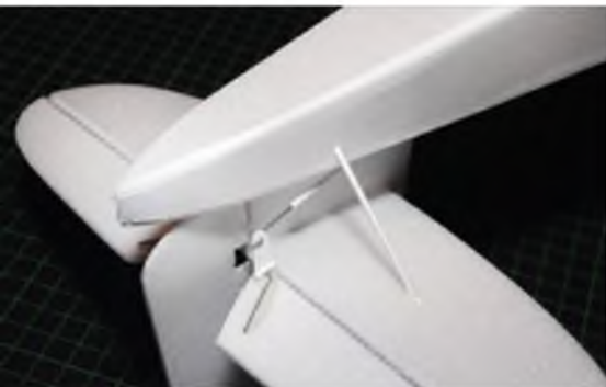
Für die Strebe vom Rumpf zum Leitwerk kommt ein Reststück Bowdenzuginnenrohr zum Einsatz.
