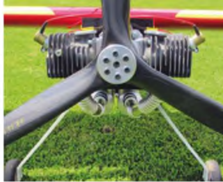
Obwohl alles frei liegt, zeigt die Ansicht direkt von vorne, dass der Stirnwiderstand relativ gering ist.
