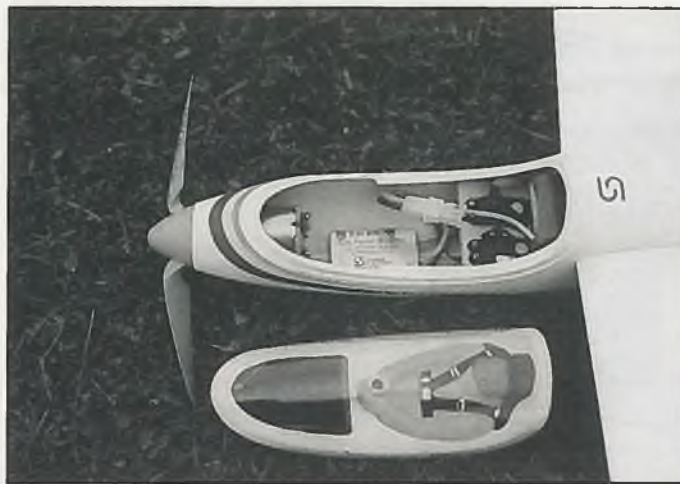
Akkuwechsel durch die Kabine und Elektronik gut zugänglich. Der Pilot bleibt bei dem Schauerwetter lieber unter der Haube
