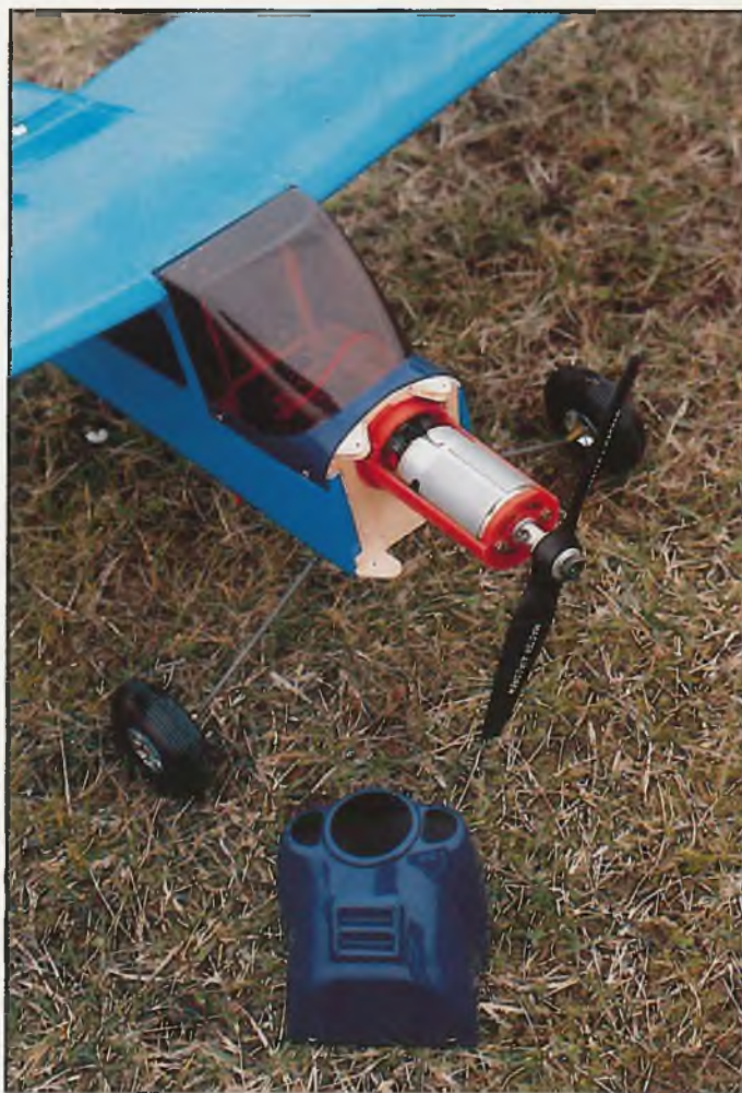
Der Motor wird in einer Art Schalenmotorträger befestigt
