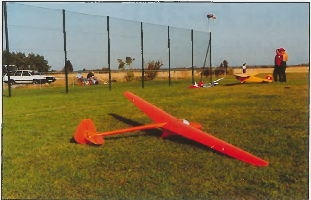
Der Gö-6 war ein Segler, der auf einen geringen Widerstand optimiert wurde, daher auch die eigenwillige Rumpfform. Man erhoffte sich, der damals jüngsten und leistungsfähigsten Konstruktion, der „Weihe“, konkurrieren zu können
