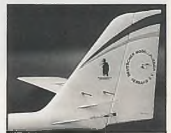
Das Leitwerk, gegenüber dem Bausatz geändert: Das Höhenleitwerk auf 2-mm-Stahldrähte steckbar, Ruder einzeln angelenkt. (Eine Pendelausführung wäre ohne Zweifel für diesen Umbau einfacher, nur würden die Flugeigenschaften vermutlich anders sein als die der Serienversion, die aber in diesem Bericht besprochen werden sollte)
