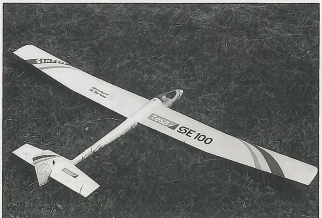
Das Leitwerk, gegenüber dem Bausatz geändert: Das Höhenleitwerk auf 2-mm-Stahldrähte steckbar, Ruder einzeln angelenkt. (Eine Pendelausführung wäre ohne Zweifel für diesen Umbau einfacher, nur würden die Flugeigenschaften vermutlich anders sein als die der Serienversion, die aber in diesem Bericht besprochen werden sollte)
