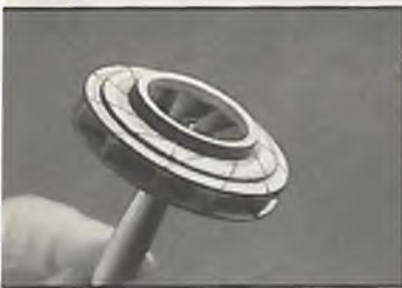
Das Verdichterrad der Turbine von K. Schreckling: Aus Sperrholz mit Kohlefaserverstärkung gebaut
