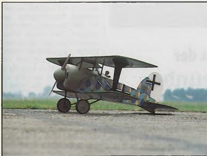
◀ Albatros D XI mit 2 018 mm Spannweite und 38-ccm-Titan-Motor von Otto Christmann, einem der Senioren, mit guten Flugeigenschaften.
