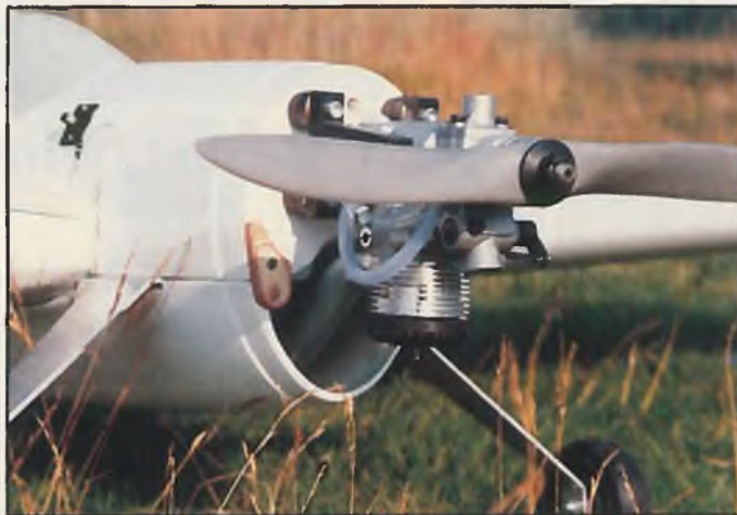
Der Einbau eines Heckauslaßmotors (für diese Triebwerke ist das Modell nicht vorgesehen) war nicht ganz einfach
