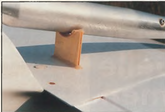
Bei elastisch aufgehängtem Motor muß auch das Reso-Rohr weich gelagert werden
