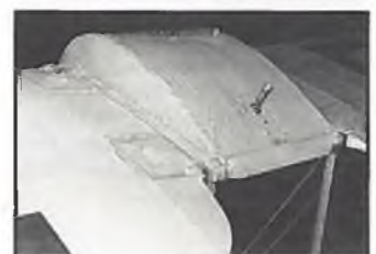
Der Tank, im oberen Flügel eingebaut: 68 Liter ist sein Volumen und der verspannte, eckige Doppeldecker schaffte mit diesem Vorrat 510 km Strecke! Was sagen dazu die heutigen Flugzeugbauer?
