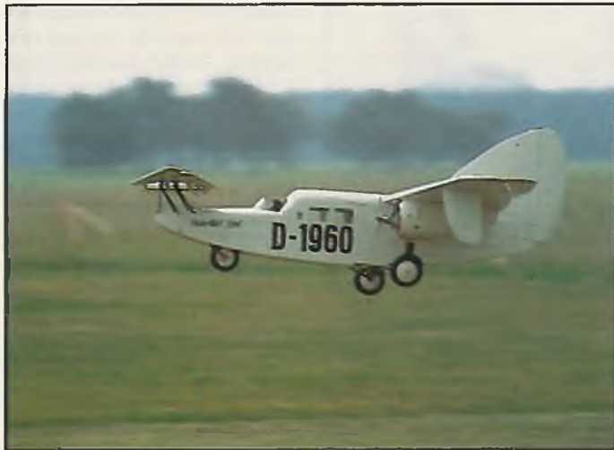
J. Mayer war wieder dabei, hier mit der Focke Wulf Ente: Spannweite 2 300 mm, Länge 1 580 mm, 7 500 g, 2 × 8,5 ccm OS-4 Takt-Motor. Flugeigenschaften: Bestens!
