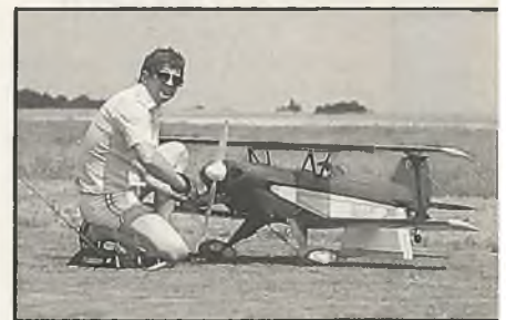
Der Mechaniker von Jiri Banas mit Acrosport. 1 980 mm Spw., 8 300 g und Quadra 35.
