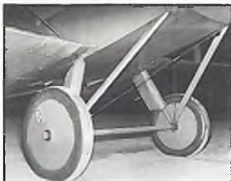
Das Fahrwerk hat eine durchgehende Achse. Für den Modellnachbau ist sie nur für Hartpisten geeignet, für Grasbahnbetrieb kann man sie weglassen oder ggf. abnehmbar machen
