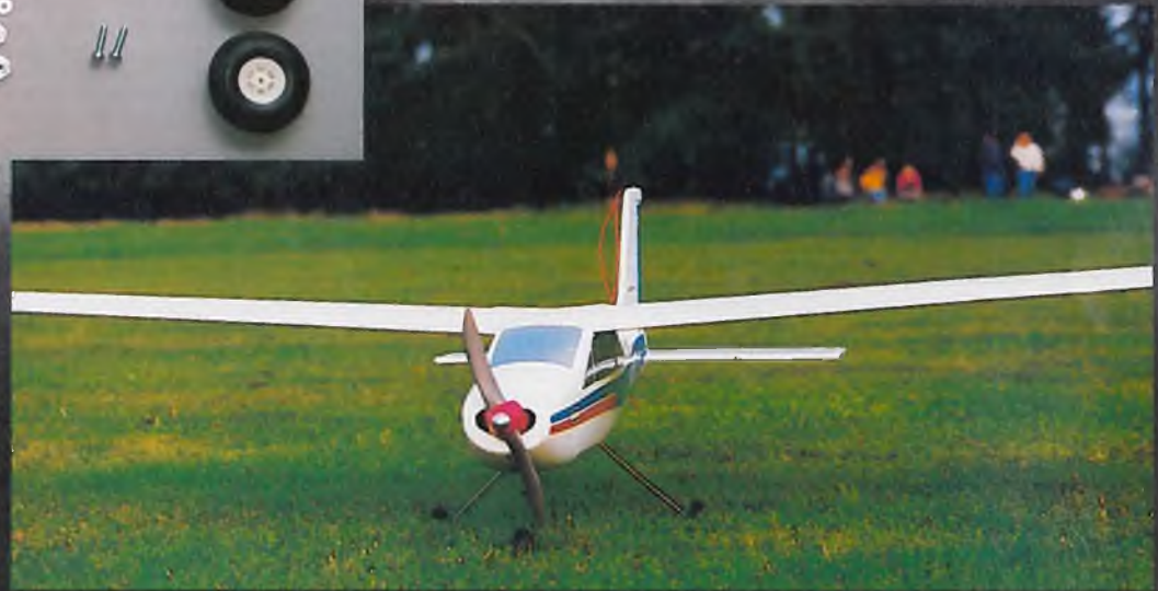
Der „Beschlagsatz“. Der Fahrwerksdraht ist robuster, als es der erste Eindruck erscheinen läßt. Der Spinner aus dem Bausatz verabschiedete sich im Duett mit der Luftschraube nach 40 Metern Steigflug
