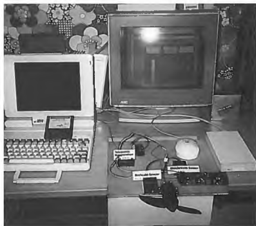
Datenaufzeichnung (Meßanordnung) für Spannung, Strom und Drehzahl an einem E-Motor mit Luftschaube. Die gewonnenen Daten werden über die Haupteinheit direkt zum PC gelenkt und gespeichert
