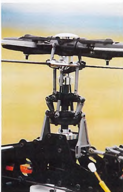
Rotorkopf, Pitchkompensator und Taumelscheibe sind großzügig dimensionierte, präzise funktionierende Komponenten
