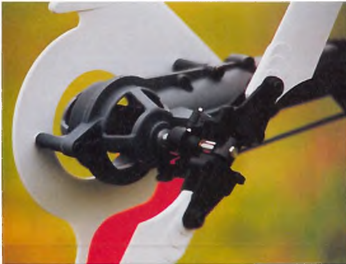
Auch das Heckgetriebe macht einen wuchtigen Eindruck, hat als Vorteil aber einen weiten Lagerabstand
