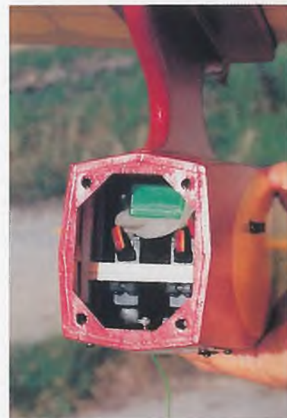
Die „RC-Zugänge“: Von der Unterseite des Rumpfs sind die Servos erreichbar, von der Frontseite, durch eine Öffnung im Spant, der Empfänger und der Akku
