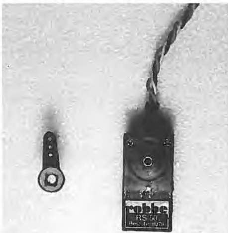
Servoachse Viereck, Servohebel Vielzahn: Mit TRIM ausgefüllt, entsteht eine absolut kraftschlüssige Verbindung
