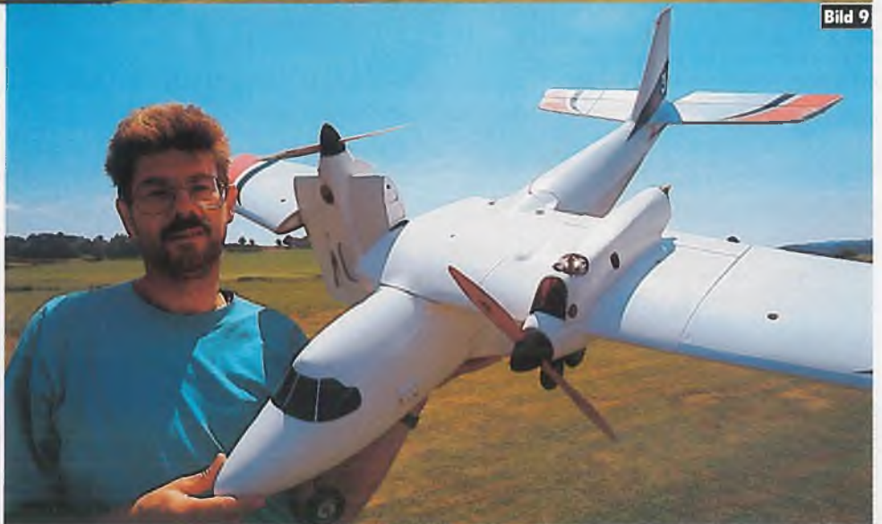
Bild 9: S. Herlein hat sich eine überaus schwierige Aufgabe gestellt, ein Flugzeug mit Klappmotoren zu bauen. Er hat damit noch viele Probleme
