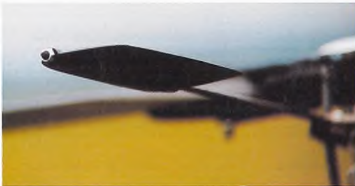
Die Paddel werden außen mit einer M4-Stopmutter gekontert. Keine besonders elegante Lösung, da kann man sich schnell mal einen Kratzer einfangen. Zum Aufschrauben, Kontern und gleichzeitigem Ausrichten braucht man eigentlich drei Hände, hier wäre „Standard“ völlig ausreichend gewesen
