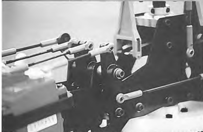
▲ Die Halterung für die Höhenflosse und die Stützstrebe ist recht klobig ausgefallen
