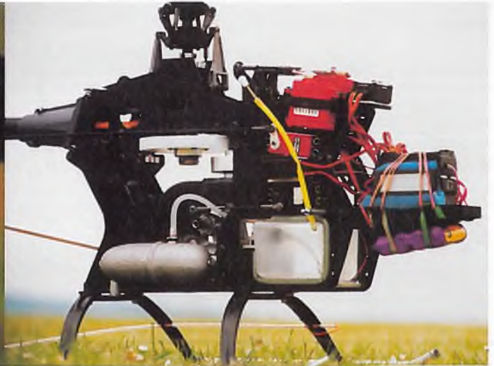
Auf dem Vorbau, der allerdings nicht zusätzlich abgestützt ist, ist genügend Platz für die Unterbringung der Fernsteuer-Komponenten
