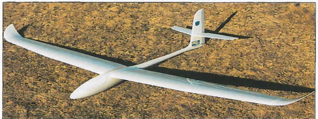
Geringe V-Form und stark hochgebogene Winglets verleihen dem Modell sein charakteristisches Aussehen
