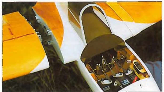
Unterhalb des Cockpits sind die Servos für Höhen- und Seitenruder, Spreizklappen und Schleppkupplung eingebaut.
