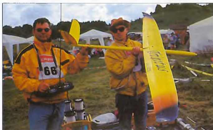
Trinitus , noch ein neues Gemeinschaftsprojekt der drei Dänen John Rasmussen (l.), Erik Dahl-Christensen und Claus Olsen , erlebte auf dem Dörnberg sein erfolgreiches Wettbewerbsentree. Technische Details: 3,20 m Spw., 64 qdm Tragfläche, Streckung » 17, Profil HQ/W-2/8
