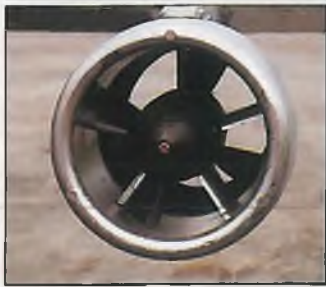
Die C-17-Antriebe sind zum Teil selbstgestrickt. Die vier Impeller bestehen jeweils aus einem Schwerdtfeger-Gehäuse, einem Rotor-Eigenbau mit 4 Blatt und 6 Zoll Steigung bei einem Durchmesser von 66 mm.
