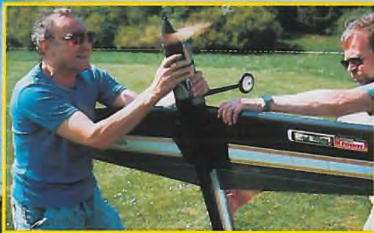
Im Zweitakt-Viertakt-Rhythmus laufen gut eingestellte Fesselflugmotoren. Hier Albert Reichle beim Abstimmen.
