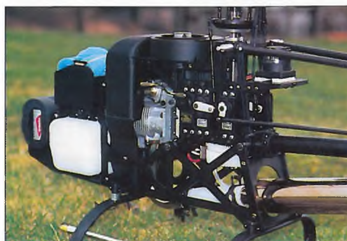
▲ Die linke Mechanikseite wurde komplett von Kabeln freigehalten, damit... ▶ ...die RC-Box zum Wechsel der Glühkerze nach rechts weggeschwenkt werden kann.
