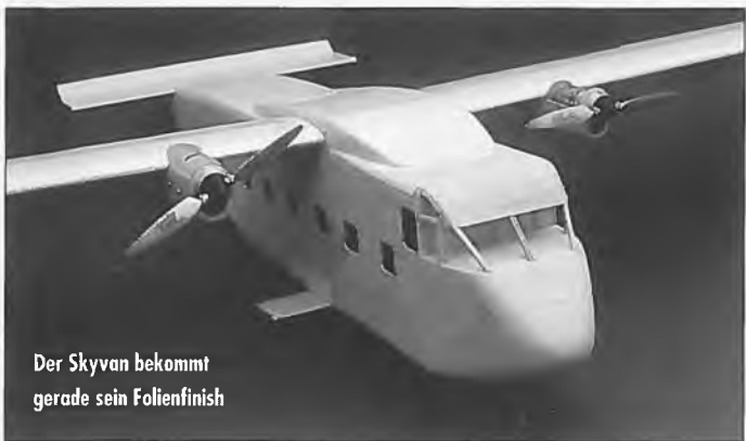
Die Motohauben aus dünnen Polystyrol schmiegen sich eng um die kleinen Speed-400-Motoren
