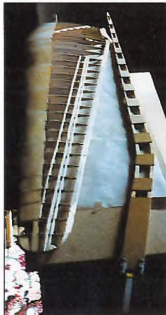
Zuerst entsteht der Rumpfhauptspant.
