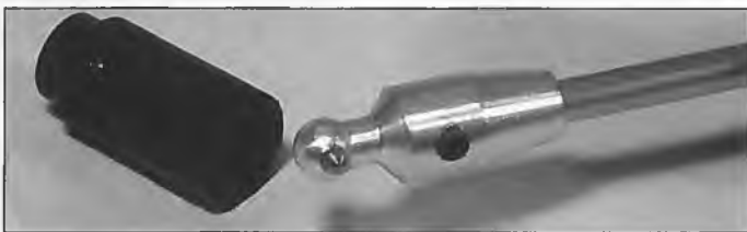
Eine hochwertige Kardankupplung befindet sich jeweils an den Enden des CFK-Antriebsrohres und sorgt für guten Rundlauf.
