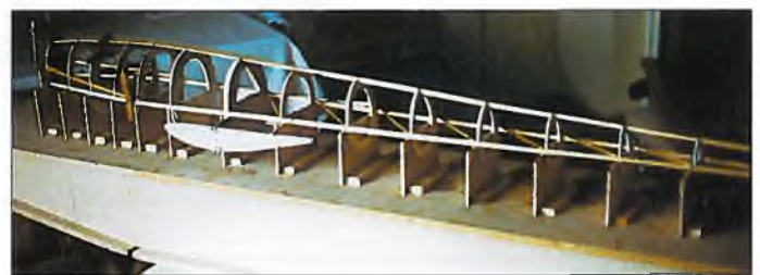
Zuerst entsteht der Rumpfhauptspant.
