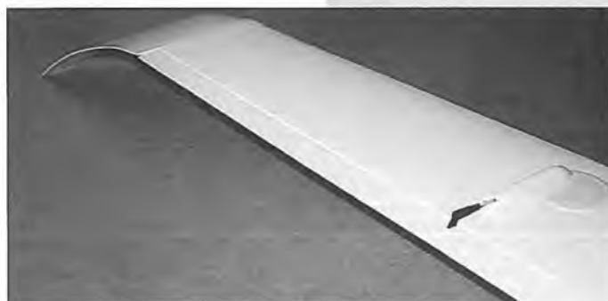
Die Servoabdeckungen sind aus ABS tiefgezogen.
