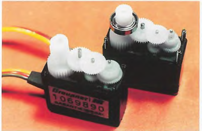
Kunststoffgetriebe von Hitec – das fünfstufige mit den dicken Rädern (links) gehört zum HS 85 BB, im HS 81 gibt es nur vier Getriebestufen und etwas dünnere Zahnräder. Beide Servos kann man auch mit sehr präzisen Metallgetrieben ordern.
