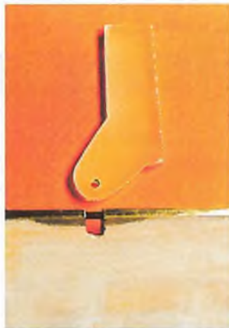
...am Ruder wird ein Messingröhrchen befestigt, das in gleichmäßigen Abständen geschlitzt wird. In der Tragfläche befinden sich GFK-Gegenlager.
