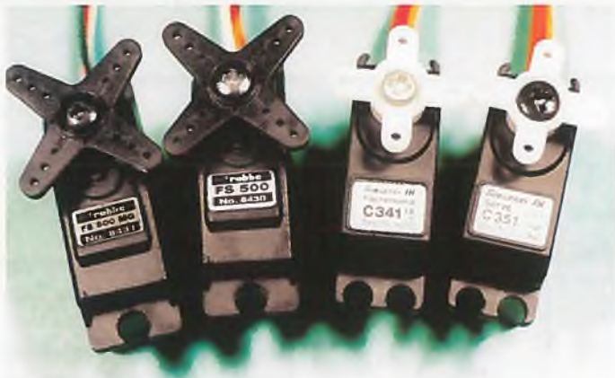
Graupner/JR und Robbe bieten ihre Mikroservos wahlweise mit Kunststoff- oder Metallgetriebe in gleichen Abmessungen an. Die neuen Robbe-Servos stammen offenbar nicht von Futaba.
