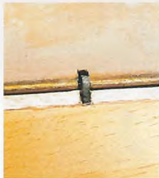
Durch die nach oben gebogenen Tragflächen ist eine besondere Scharniertechnik für die Querruder notwendig....
