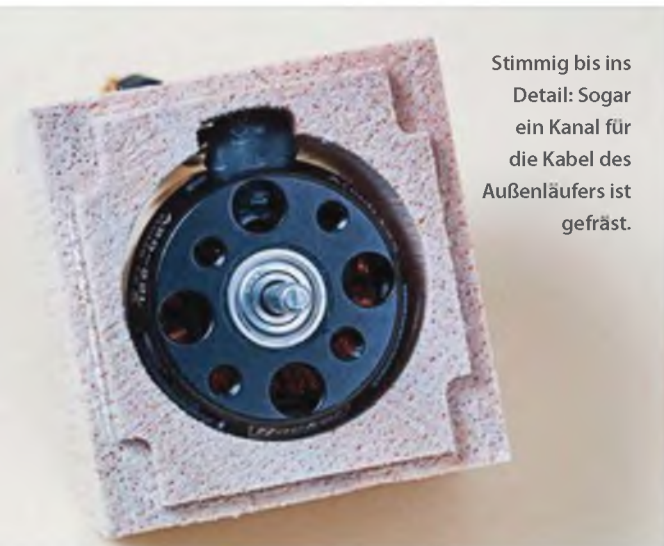
Der Hacker-Außenläufer wird mit Papier umwickelt. So lässt er sich im Nasenklotz zentrieren, damit er später frei dreht.
