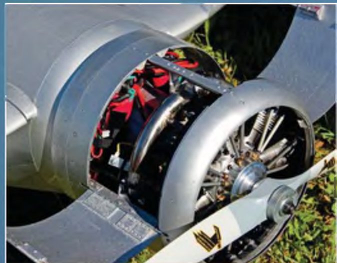
Angetrieben wird das 15 kg schwere Modell von zwei Evolution 735-Sternmotoren.
