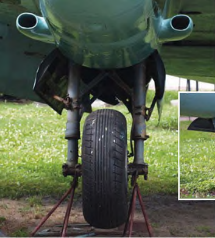
Auch das gedämpfte Spornrad zieht elektrohydraulisch in den Rumpf ein.
