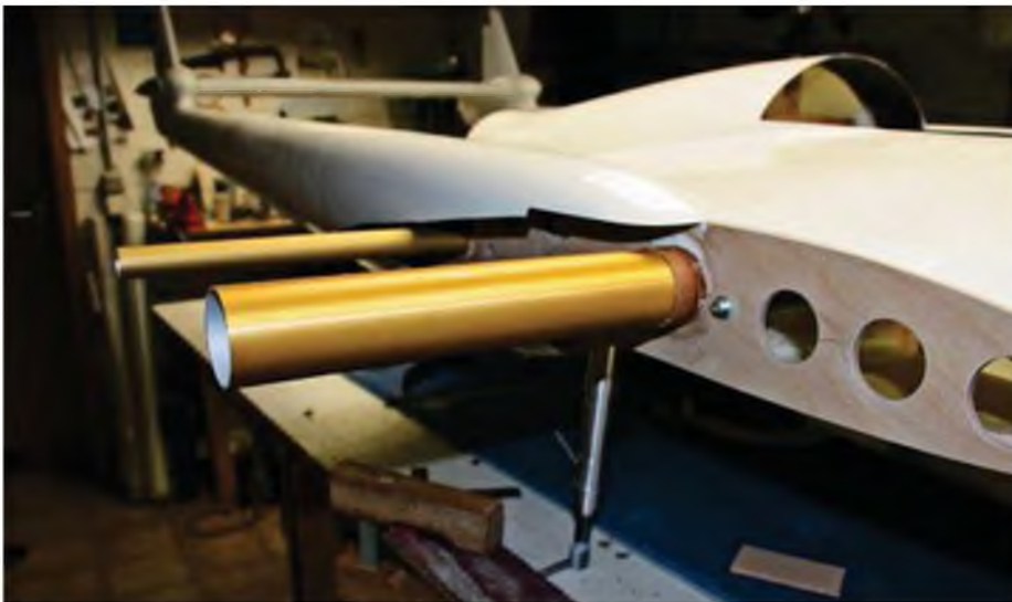
Die Anpassung der Ausleger an Rumpf und Fläche muss Stück für Stück mit Sorgfalt erfolgen.
