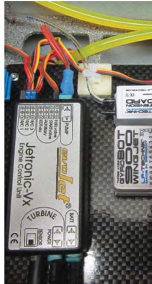
Eine typische Installation des GyroBot 900 Wing Jet (33x33x21 mm) in einem Jetmodell. Der Wing Jet fällt mit 65 g deutlich schwerer aus als der 900 Wing mit nur 14 g.
