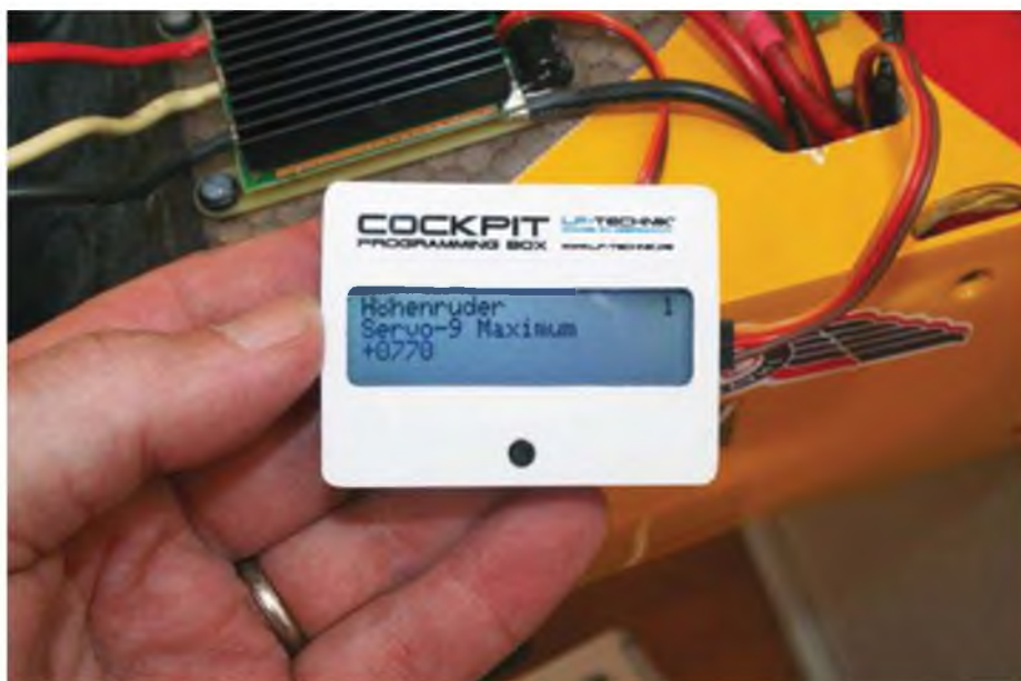
Hier erfolgen die Einstellungen per ProgBox. Im Bild ist gerade die Einstellung des Höhenruder-ausschlages zu sehen. Die Werte sind keine Angaben in mm oder Grad, sondern einfach imaginäre Zahlenangaben. Mit dem Vorzeichen wird die Richtung geändert.
