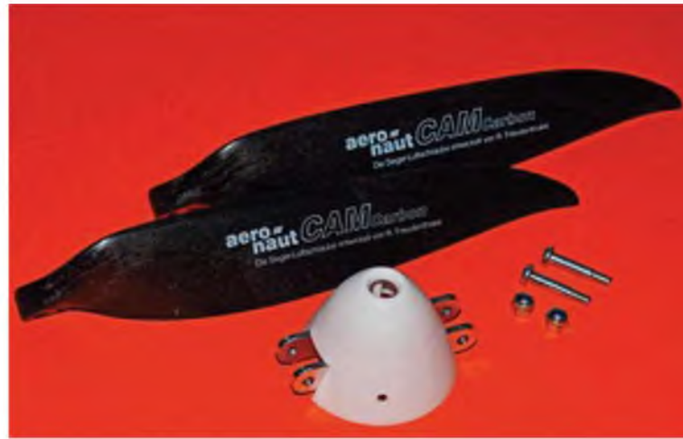
Der verwendete Antriebsstrang stammt komplett von Dymond: Motor GTX-3546, Regler Profi Evo 65 A, 3s-LiPo 2.200 mAh. Auch das passt perfekt: Reisenauer-Spinner/Mitnehmer und aero-naut CAM Carbon 13x6,5“.
