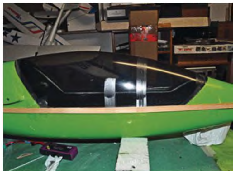
... oder mit Klebeband und Leisten, die den Vorteil haben, dass der Haubenrand schön gerade anliegt. Widerspenstige Stellen eventuell unterlegen oder zusätzlich besonders solide abkleben.
