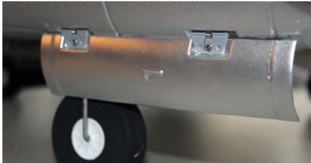
Die Fahrwerksklappen sind mit einem Federmechanismus versehen und gehen mit dem Fahrwerk automatisch zu bzw. auf.
