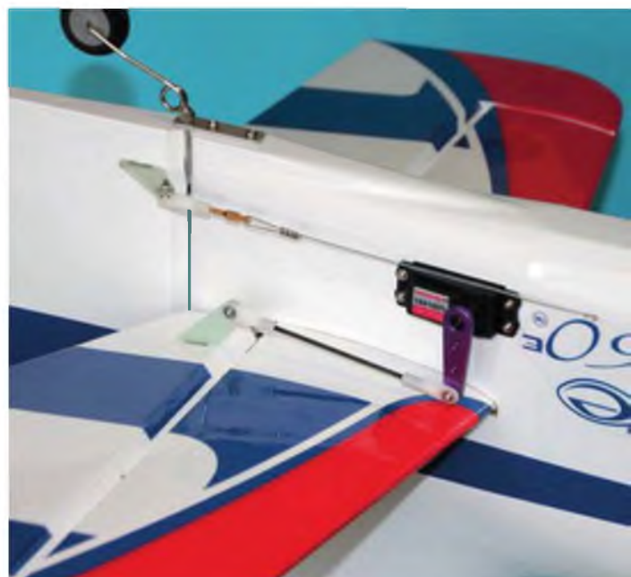
Das Höhenruderservo ist in der getesteten Version bereits im Rumpf verschraubt und die Anlenkung so weit wie möglich vorbereitet.
