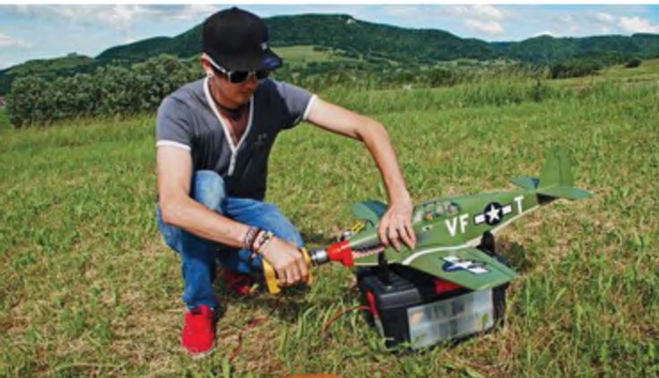
Meine Aircombat-Mustang wird von einem 2,5-cm 3 -2-Takter befeuert. Elektroantrieb ist aber genauso möglich.
