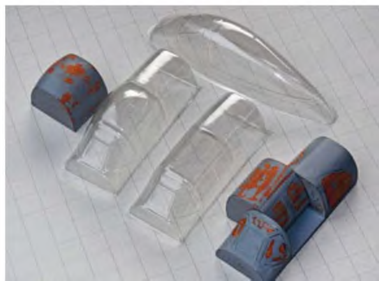
Drei Kanzeln stehen zur Wahl: Die eckige der A- und B-Version (rechts), die Malcolm-Haube der späten B-Mustangs (Mitte) und die Tropfenkanzeln der P-51 D.
