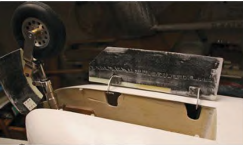
Die Bugrad-Klappen werden mit zwei Servos bewegt.
