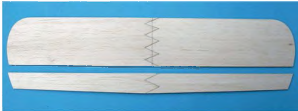
Diese Schäftung bedarf keiner Nacharbeit.
