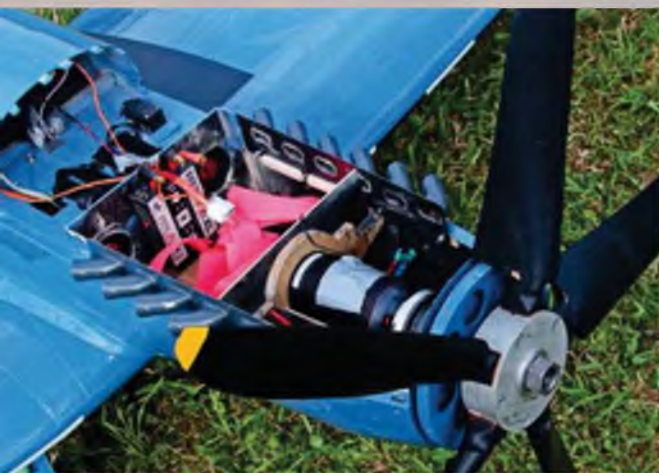
Das 23 kg schwere Modell wird von einem Neu-Motor mit 6,7:1-Getriebe und einem Seidel-28x19-Fünfblatt-Prop angetrieben. Mit einem 12s2p-8.000-mAh-LiPo werden bei etwa 200 A Spitzenstrom 4.000 1/min am Prop erreicht.
