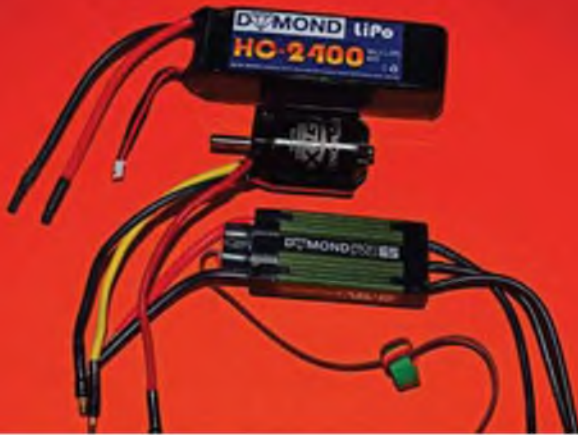
Der verwendete Antriebsstrang stammt komplett von Dymond: Motor GTX-3546, Regler Profi Evo 65 A, 3s-LiPo 2.200 mAh. Auch das passt perfekt: Reisenauer-Spinner/Mitnehmer und aero-naut CAM Carbon 13x6,5“.
