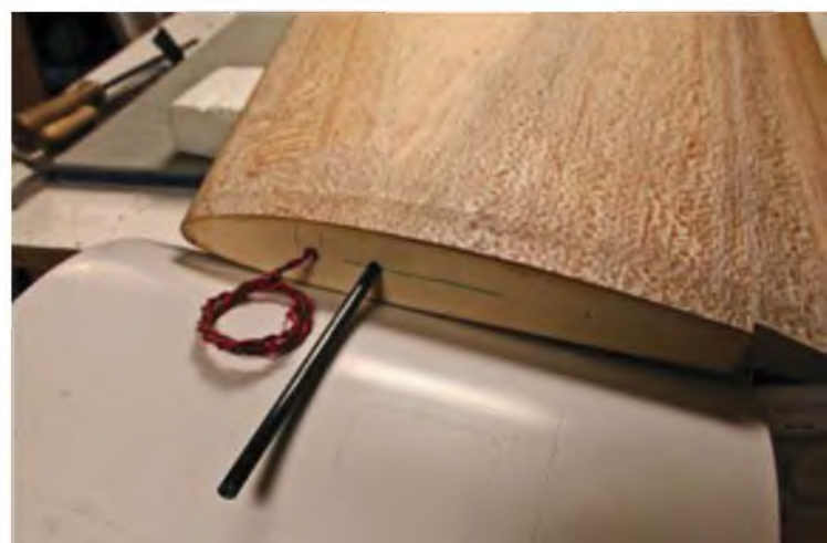
Die Tiptanks werden mit Harz verklebt. Als Verstärkung ist ein 6-mm-Kohlerohr von außen durch den Tiptank bis in die Endrippe der Tragfläche eingeschoben und verklebt. ▼
