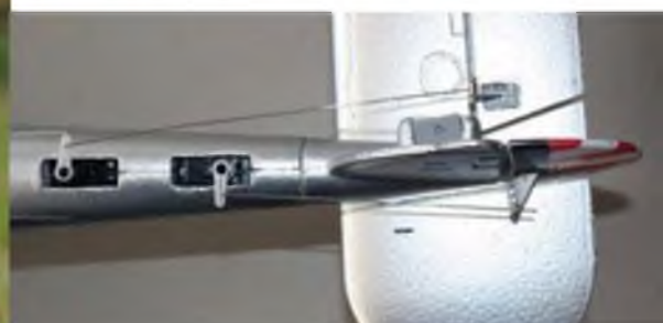
In jedem der beiden Rumpfausleger sitzt je ein Höhenrunder- und ein Seitenruderservo der 9-Gramm-Klasse.
