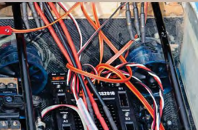
Zur Kühlung der Antriebseinheit sind im Motorspant drei 40-mm-Impeller installiert, die mit einem 2s-LiPo und nur mit halber Leistung betrieben werden.
