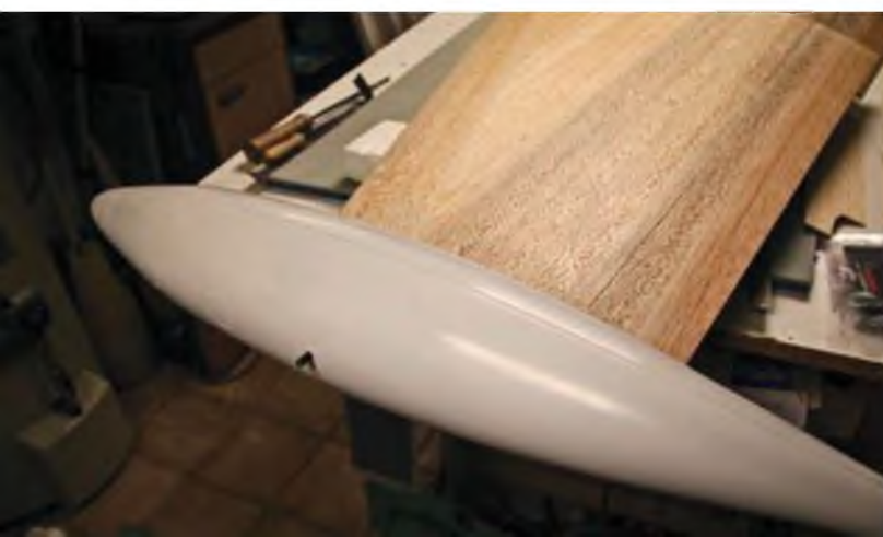
Die Tiptanks werden mit Harz verklebt. Als Verstärkung ist ein 6-mm-Kohlerohr von außen durch den Tiptank bis in die Endrippe der Tragfläche eingeschoben und verklebt. ▼
