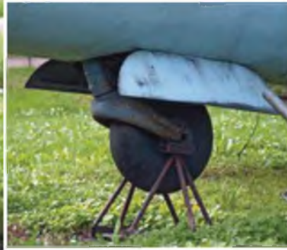
Auch das gedämpfte Spornrad zieht elektrohydraulisch in den Rumpf ein.
