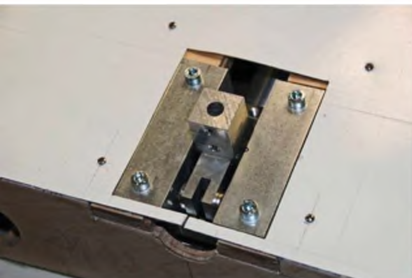
Die Mechanik wird auf gleiche Höhe zur Unterschale gebracht und etwas versenkt eingesetzt.
