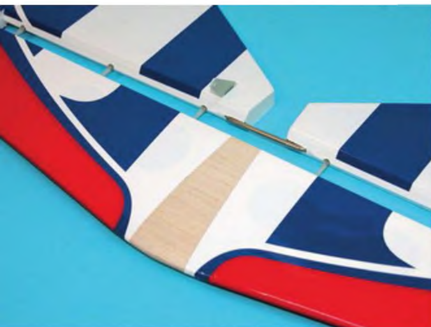
Das Höhenleitwerk ist noch zu verkleben und die Ruder anzuschlagen. All dies ist ab Werk perfekt vorbereitet und erfordert keinerlei Nacharbeit.
