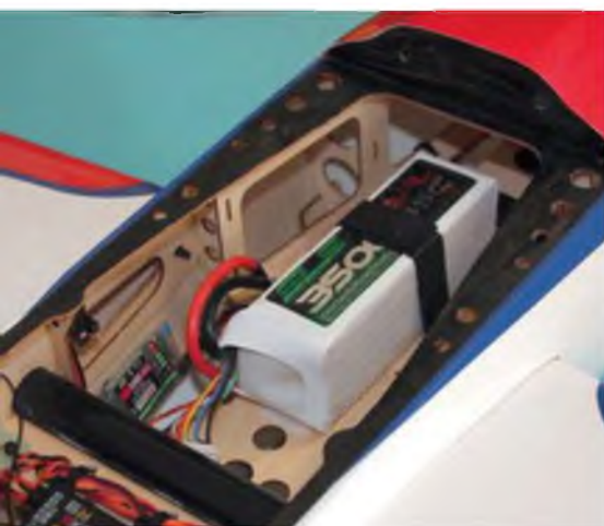
Der Akku findet auf dem vorgesehenen Brett Platz, der Schwerpunkt lässt sich auch mit unterschiedlichen Kapazitäten gut einstellen.
