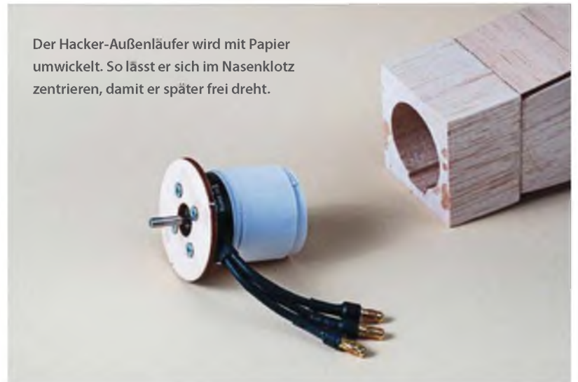
Stimmig bis ins Detail: Sogar ein Kanal für die Kabel des Außenläufers ist gefräst.
