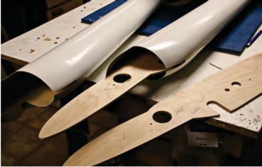
Die Steckungsspannten werden in den Heckauslegern zunächst nur geheftet.
