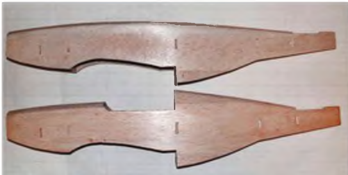
Mit diesem Plan können Sie die verschiedenen Mustang-Versionen aufbauen. Die Rümpfe im Vergleich: oben P-51 D, unten P-51 B.
