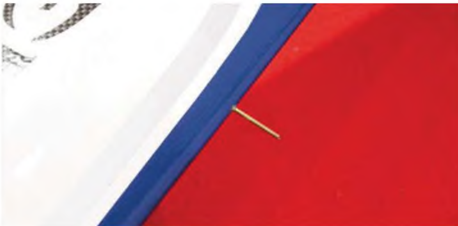
Das Staudrohr wird möglichst weit außen an der Tragfläche montiert um jegliche Beeinflussung durch Luftwirbel zu vermeiden.
