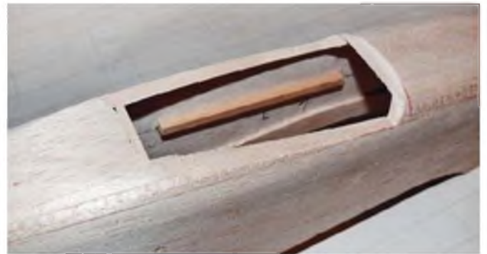
Schleifen ist besonders wichtig, erst dann entstehen die richtigen Mustang-Formen (hier: Kabinenausschnitt der P-51 D).
