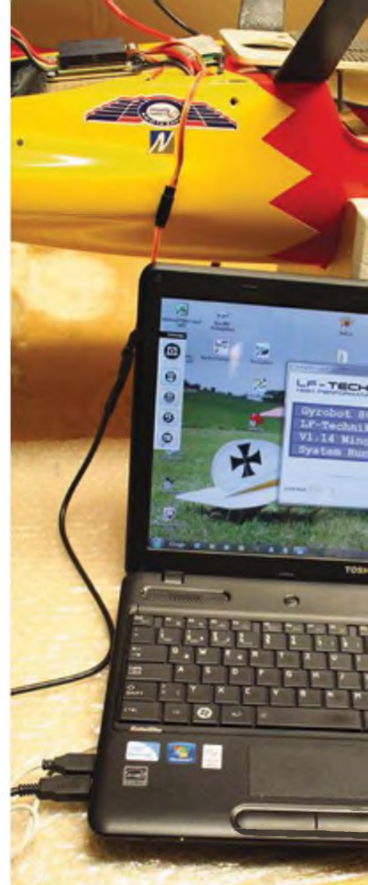
Hier die Programmiermaske auf dem Laptop. Von hier aus gelangt man in das Einstellmenü. Oben rechts wird die jeweilige Flugphase eingeblendet, welche gerade bearbeitet wird.
