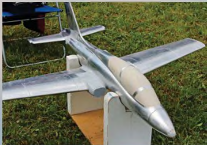
Daniel Eichenberger flog seine im Team mit Vater Beat gebaute MB-339. Das Modell im Maßstab 1:7,5 erreicht mit dem installierten Schubeler-Impeller DS-51 DIA HST und DSM 4640-950-Motor mit YGE-Regler an einem 10s 4.300-mAh-LiPo sehr überzeugende Flugleistungen. Beat und Daniel Eichenberger bauen derzeit an einer neuen Voll-GFK-Version der MB-339. In Huttwil zeigten beide das Urmodell und erste GFK/CFK-Teile. Die Vorbildtreue und Qualität der neuen Maschine wird erstklassig.
