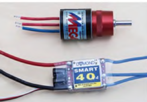
Eine gute Antriebs-Alternative ist der 93 g leichte Mega PG 16/7/4CE 3:1 (Bezug: www.modellhobby.de ).
