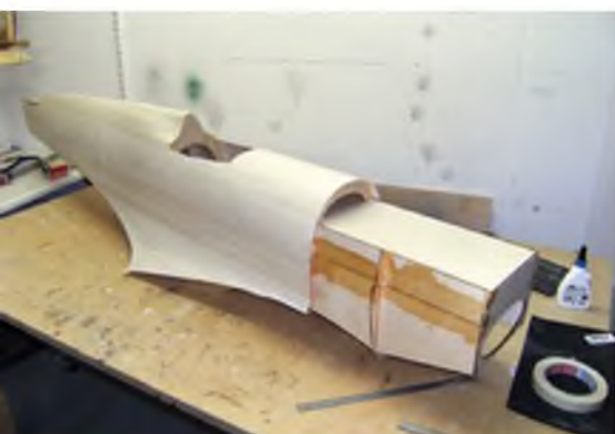
Der Rumpf ist komplett mit Balsa beplankt – der Motordom besteht aus Sperrholz und wird von der großen Motorhaube überdeckt.
