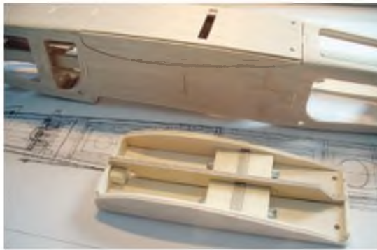
Die fertige Fahrwerksaufnahme im Vordergrund, hinten wird gerade die reine Abdeckung an den Rumpf angepasst.
