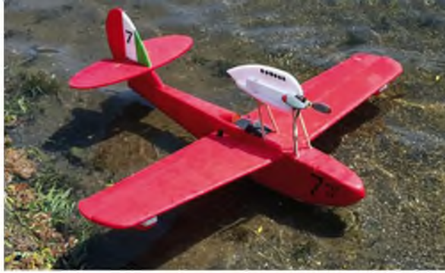
Die Macchi M33 von Ronald Lehndorff mit 100 cm Spannweite ist aus 6-mm-Depron gebaut. Die Tragfläche hat ein Kfm2-Profil (Kline-Fogleman).
