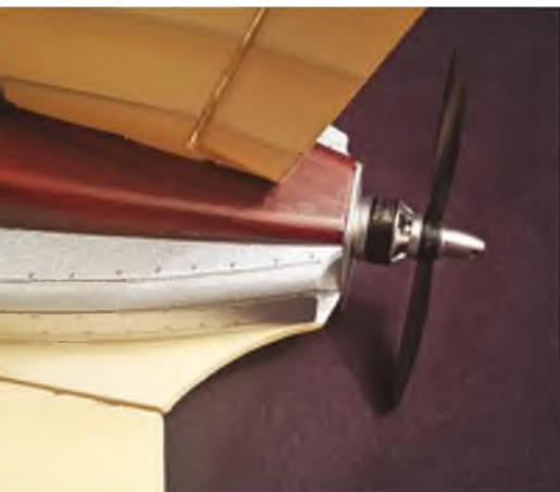
Als Antrieb kommt bei mir ein T-Motor-MN-1806-2300-Brushless-Außenläufer zum Einsatz.
