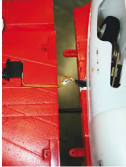
Die Flächen werden über ein Kohlefaserrohr gesteckt und mittels zweier Verschraubungen gesichert. Die Verlängerungskabel sind bereits fertig beschriftet.
