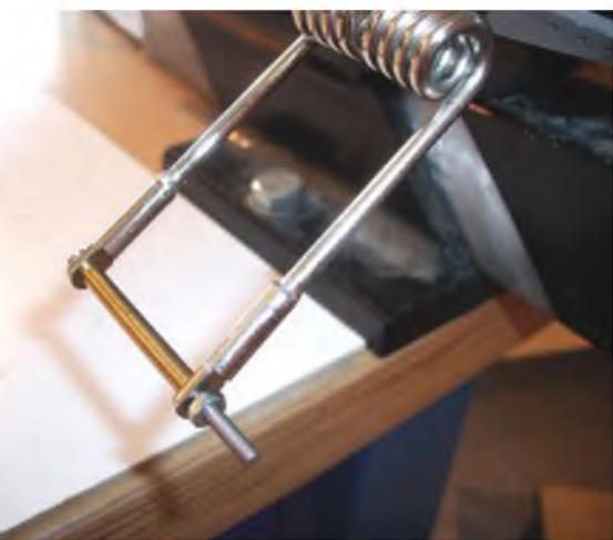
Zum Löten verwende ich einen kleinen Gasbrenner – so sollte das Resultat aussehen.
