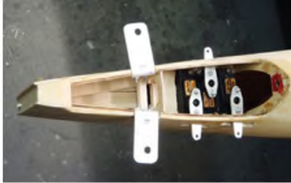
Das Leitwerk ist komplett abnehmbar, es wird über Alu-Winkel mit dem Rumpf verschraubt.
