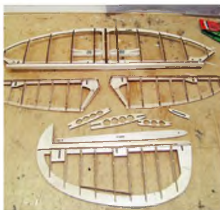
Die Leitwerke sind klassisch aufgebaut und werden voll beplankt.
