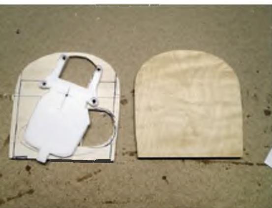
Mit einer Schablone wird der Motor auf dem Kopfspant ausgerichtet, danach werden die Ausschnitte für Vergaser und Krümmer festgelegt.
