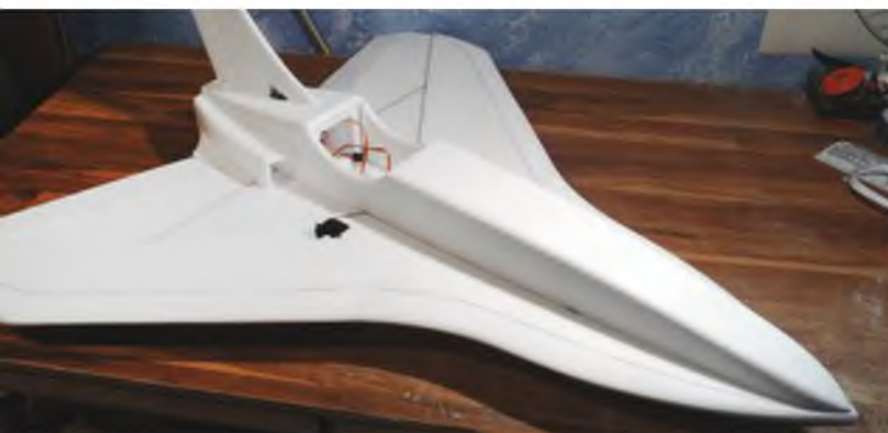
Auch die beiden „Turbinenverkleidungen“ entstehen aus Depron.
