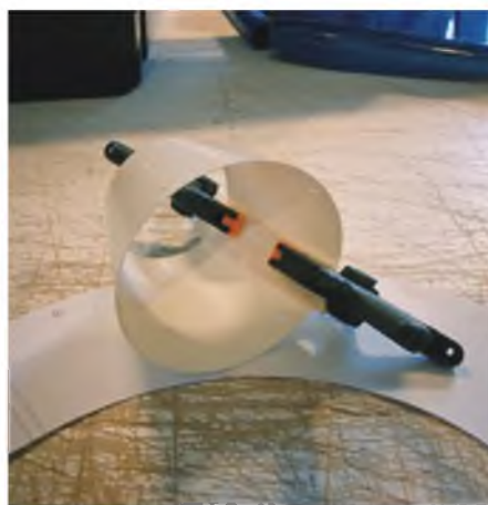
Die Motorhaubenabwicklung wird auf Kunststoff übertragen, auf Stoß gerollt und mit einem hinterlegten Streifen verklebt.
