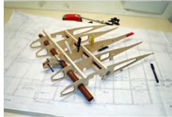
Der Tragflächenbau beginnt mit der Positionierung der Steckung – erst danach werden die Hälften getrennt und jede Fläche einzeln aufgebaut.
