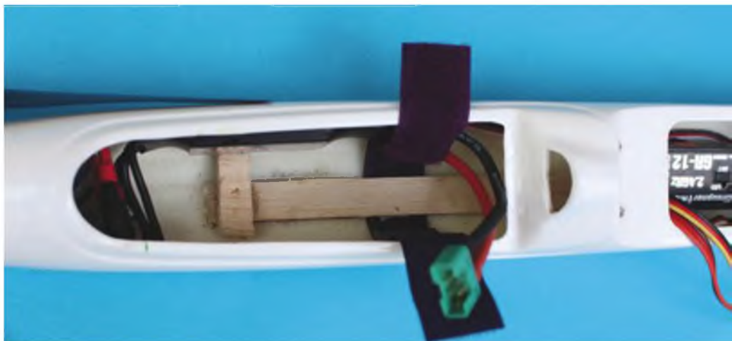
Bei der Akku-Befestigung ist etwas Eigeninitiative gefragt. Das Klettband habe ich mit einem dünnen Sperrholzstreifen im Rumpf verankert. Der kleine Holzklötzchen dient als Anschlag für den Akku.
