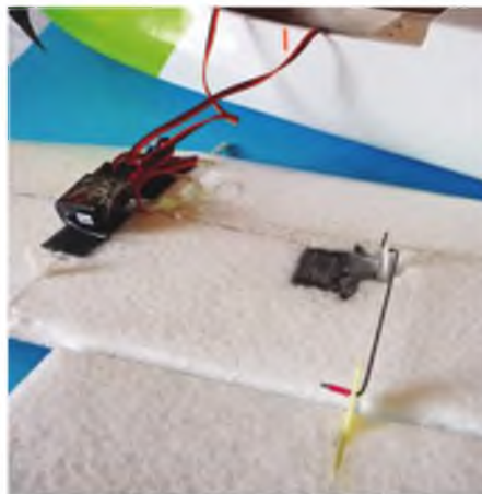
Der Empfänger – bei mir ein Spektrum AR6110 – ist unter der Tragfläche mit Klettband befestigt.
