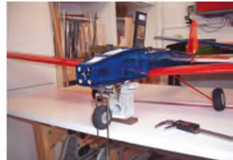
Um die Bugfahrwerkshöhe zu ermitteln, wird das Modell im korrekten Winkel aufgebockt.
