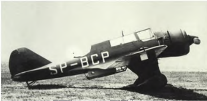
Durch das Absenken des Motors konnten die Sichtverhältnisse für den Piloten beim dritten Prototyp (PZL 23/III) erheblich verbessert werden.
