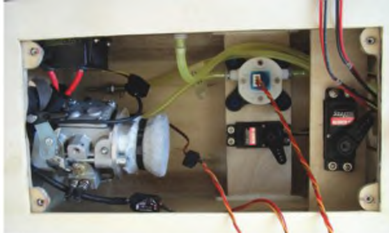
Der Tank-sensor MFlow sitzt zwischen Tank und Vergaser.
