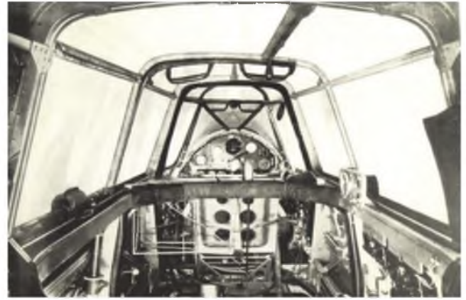
Durch das Absenken des Motors konnten die Sichtverhältnisse für den Piloten beim dritten Prototyp (PZL 23/III) erheblich verbessert werden.
