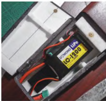
Klettband hält den Akku an seinem Platz. Der Deckel wird mit Laschen und zwei kleinen Magneten sicher gehalten.
