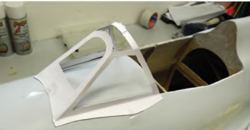
Die Anpassung des Übergangs von der Motorhaube zur Tragfläche.
