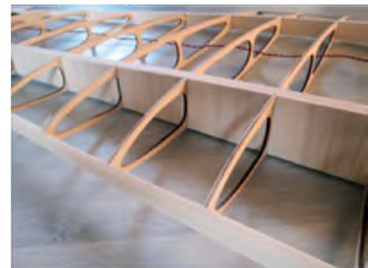
Der Holm wird außen verkastet. Die vorbereiteten Rippen sind großzügig ausgespart.
