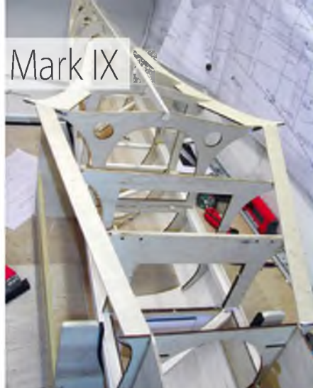
Ist das Oberteil beplankt und damit verwindungssteif, werden darauf die Spanten der Unterseite positioniert und verklebt.
