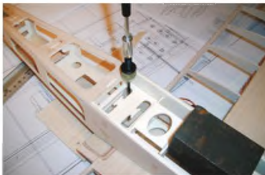
Für die Anpassung des Tiefdecker-Flügels werden hier – nach dem Ausrichten – die Bohrungen von der Aufnahme auf den Flügel übertragen.
