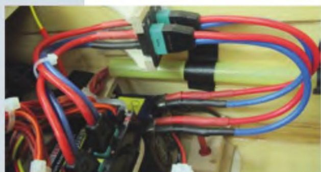
Die Steckverbindung der Akkus in einem Halter an der Rumpfsseitenwand.
