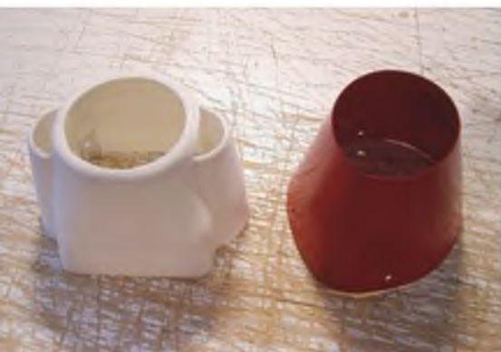
Die Motorhaube aus dem 3D-Drucker im Vergleich zur gerollten Haube.
