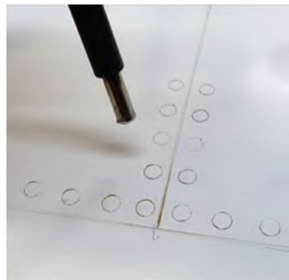
Mit der Lötkolbenspitze oder einem eingesetzten Edelstahlröhrchen wurden die Beplankungsstöße und Nieten in die grundierte Oberfläche gebrannt.
