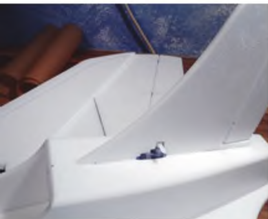
Seitenleitwerk und Servo werden mit dem Rumpf verbunden. Die Verklebung in den Schlitzen führt man wieder nass in nass aus.
