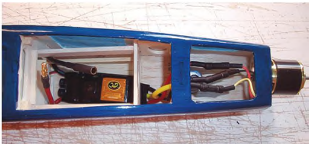
Motor und Regler sind eingebaut.
