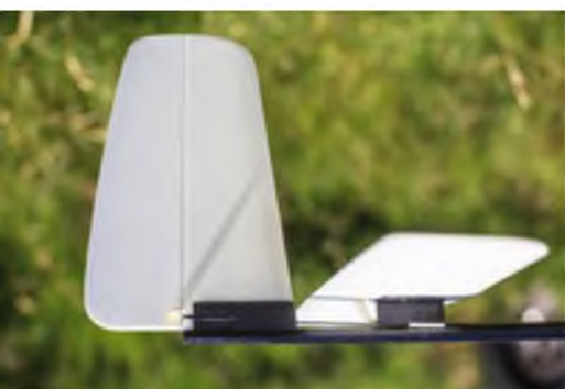
Das gedämpfte Höhenleitwerk ist abnehmbar.
