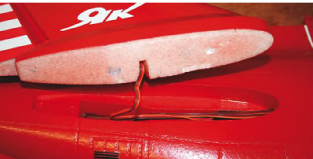
▲ Nur wenige Klebearbeiten sind am Modell zu erledigen – hier das Seitenleitwerk.
