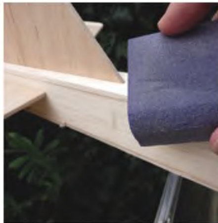
Wenn man auch den hinteren Rumpfbereich mit Leisten verstärkt hat, kann man die Ecken ohne Gefahr abrunden.
