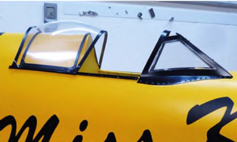
Sie sieht das Ergebnis mit eingesetzten Scheiben aus. Die Haube bleibt ständig geöffnet, um die Warmluft aus dem Rumpf abzuleiten.
