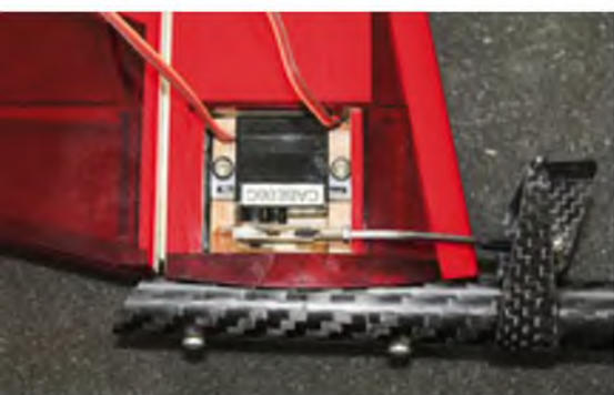
Höhen- und Seitenleitwerk sind abnehmbar.
