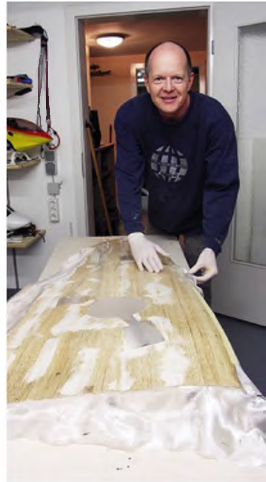
Alle Holzteile wurden mit 49-g/m 2 -Glasgewebe und Epoxidharz beschichtet.
