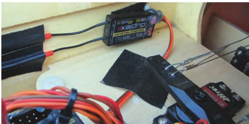
Ein Empfänger sitzt direkt an der Rumpfsseitenwand, der zweite ist in der Tragfläche positioniert.
