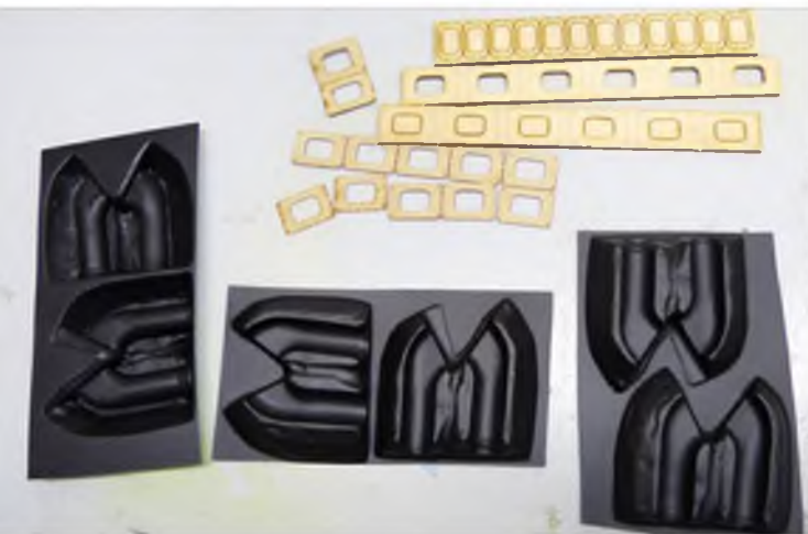
Die Tiefziehteile für die Auspuffattrappen machen auf den ersten Blick keinen sauberen und passgenauen Eindruck.
