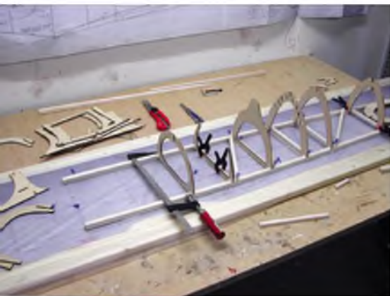
Der Rumpf wird geteilt aufgebaut – begonnen mit dem Oberteil.
