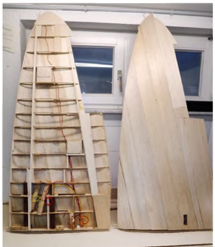
Bei der Positionierung der Fahrwerksträger und der Fahrwerksmechaniken ist Aufmerksamkeit gefordert.
