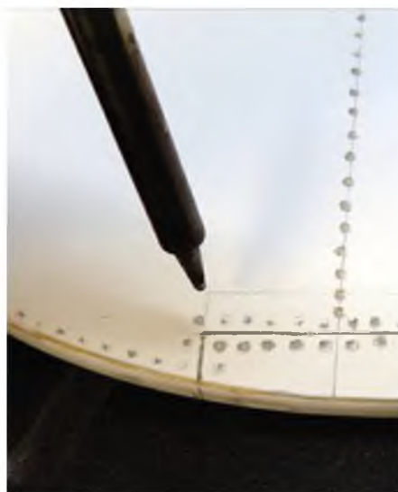
Mit der Lötkolbenspitze oder einem eingesetzten Edelstahlröhrchen wurden die Beplankungsstöße und Nieten in die grundierte Oberfläche gebrannt.
