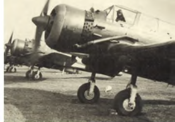
Diese PZL 23B zeigt den geschützten Ölkühler und an der Flächenunterseite die Bombenschlösser für 12,5-kg-Bomben.
