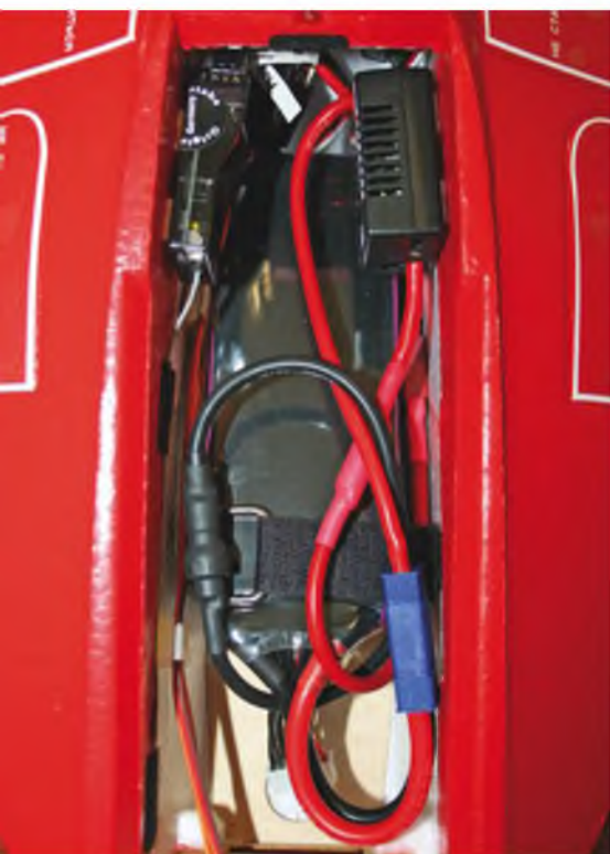
Für den Antriebsakku steht ausreichend Platz zur Verfügung. Der Jeti-Antiblitzz-Stecker verhindert zuverlässig den Kontaktblitz.
