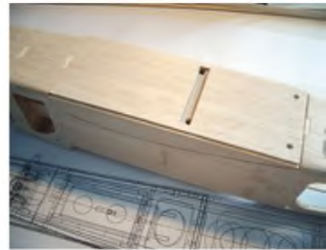
Die aufgesetzte Fahrwerksaufnahme liegt in der Flügelaufnahme für den Tiefdecker-Flügel.
