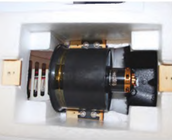
Der 70-mm-Impeller ist auf hohen Standschub ausgelegt und verhilft dem leichten Modell aber dennoch zu einer respektablen Höchstgeschwindigkeit.
