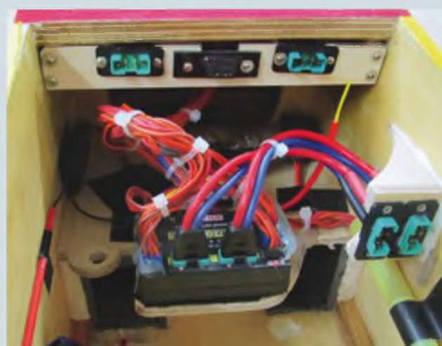
Die Flächenanschlusstecker wurden unter die hintere Flächenbefestigung verlegt.
