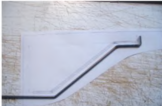
Endkontrolle des Fahrwerkes: Der Bügel sollte möglichst flach aufliegen.
