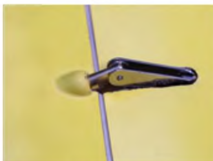
Die Gewinde für die Augenschrauben sind bereits in den Ruderblättern einlamiert.
