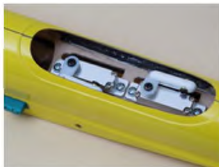
Zwei Servos werden hängend im Rumpf eingebaut.
