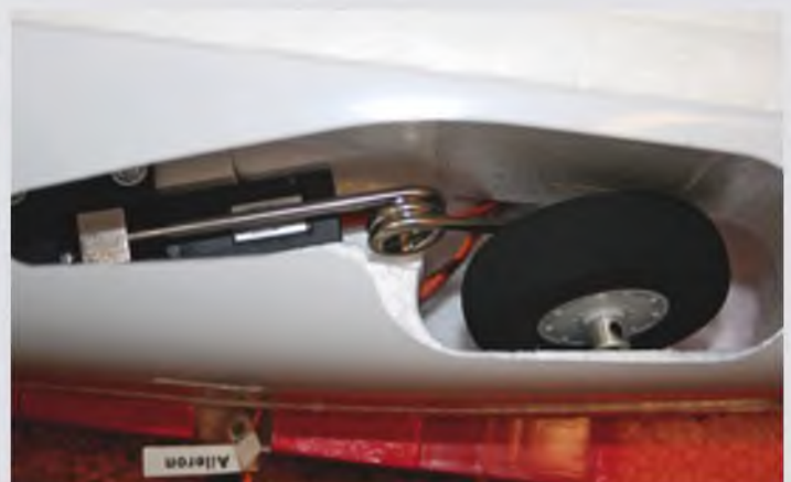
Das einfache und sehr robuste elektrische Fahrwerk ist bereits herstellenseitig eingebaut.
