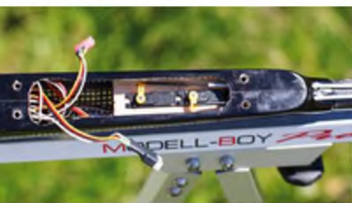
Insgesamt werden sechs Servos D47 bzw. FS31 eingebaut.
