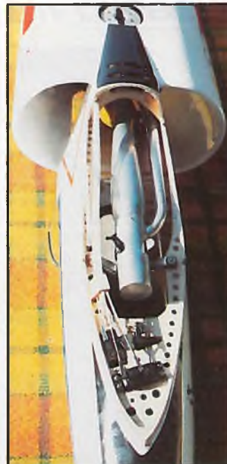
Recht hitzig muß es wohl in der Kabine zugehen, wo das Resonanzrohr Platz gefunden hat
