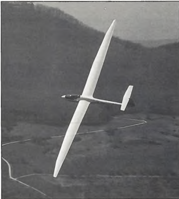
„Der Fall Discus“ und seine mittlerweile zahlreichen Nachahmer haben die Doppel- bzw. Mehrfachtrapeztragfläche wieder ganz aktuell gemacht: Wo liegt der Druckpunkt/Schwerpunkt bei einem Flügel mit solch sichelförmiger Nasenleiste?
