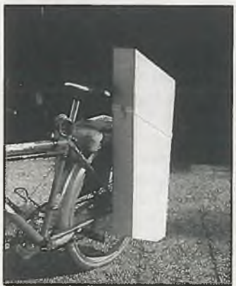
Das nochmalige Teilen der Flügelhälften ergibt ein sehr kleines Packmaß von nur 95 cm x 36 cm, so daß der Transport per Fahrrad, Rucksack oder Handgepäck möglich ist.
