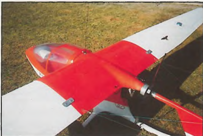
Noch einmal die ungewöhnliche Triebwerksanordnung, am fertigen Modell zu sehen. Die Konstruktion mit dem Verbrennermotor bereitete allein wegen der Vibrationen und der zu erwartenden Kräfte am Drucklager einiges Kopfzerbrechen. (Nicht ganz so vorbildgetreu, aber auch nicht ganz so kompliziert dürfte eine Elektro-HB-23 sein!)
