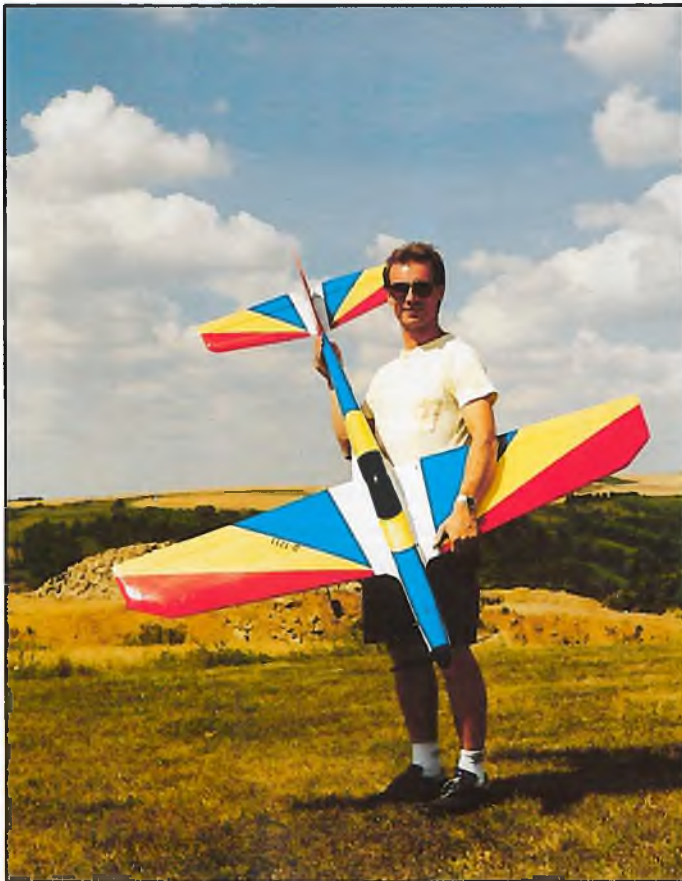
„Shadow“ heißt das Modell, Jürgen Steinmaier sein Konstrukteur und gleichzeitiger Gewinner der beiden Teilwettbewerbe. (Kurzdaten des Modells: 176 cm Spw., 3,6 kg Gewicht, Motor OS-„Hanno-Special“, Propeller 12 x 11,5 Ulsamer)
