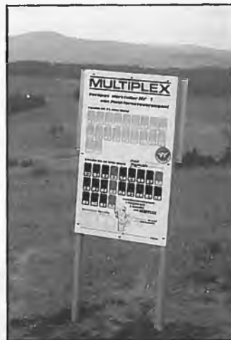
Solche Frequenztafeln werden künftig an der WaKu für Kanalordnung sorgen
