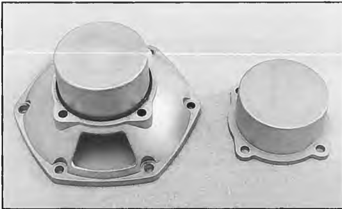
Der hintere Kurbelgehäusedeckel läßt sich gegen den mit angepasener Rückenflanschbefestigung auswechseln (liegt bei).
