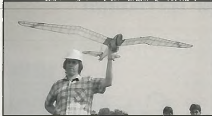
Ein ungarischer Modellbauer mit seiner „Minimoa“ in Sperrholz-Kiefer-Bauweise
