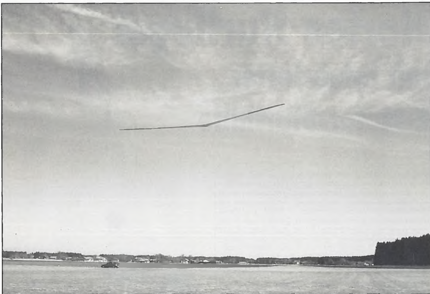
Der Nurflügel gleitet in der Seglerversion nach dem Handstart ca. 30 bis 40 m weit.
