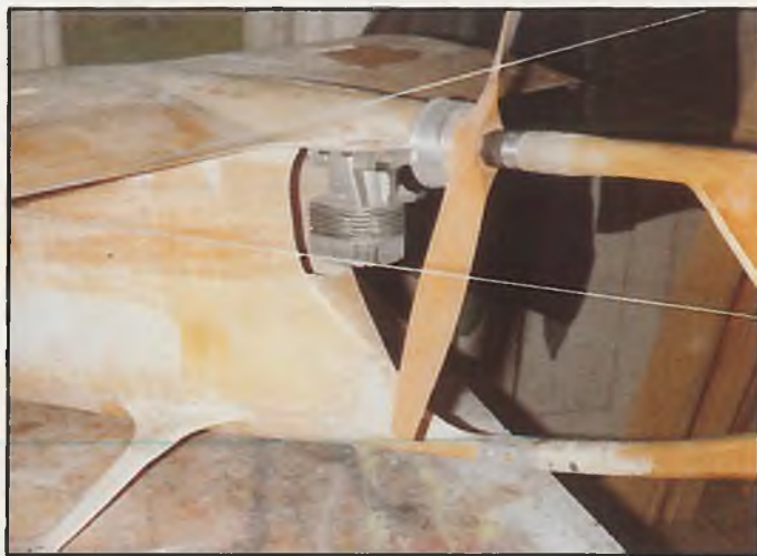
Das schwierige Detail: Der Rumpf muß in der Propellerebene trennbar sein, der obere Gurt des Leitwerksträgers stützt sich über ein Drucklager auf die Motorwelle. Hinter dem Propeller ist eine Schnurscheibe zum Anlassen montiert
