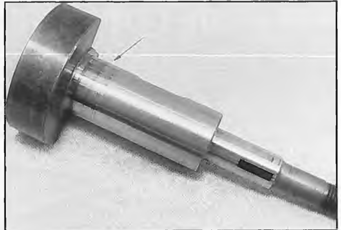
Deutlich erkennbar sind die Schleifspuren, die der sich drehende Lagersitzring auf dem Kurbelwellenschaft hinterließ.
