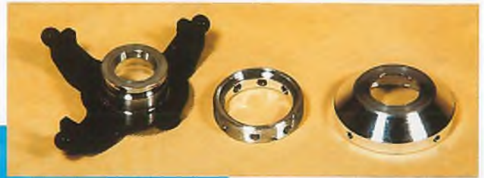
▲ Die Taumelscheibe dürfte das präziseste Teil am ganzen Hubschrauber sein. Wird sie sauber montiert, läuft sie perfekt.
