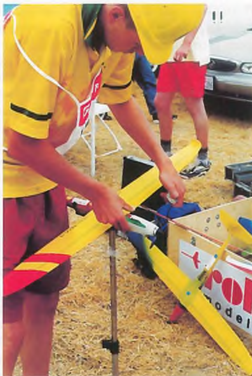
Gewissenhafte Startvorbereitungen zum F5D-Pylonwettbewerb. Die Rumpfschnauze wird mit Tesafilm gehalten.
