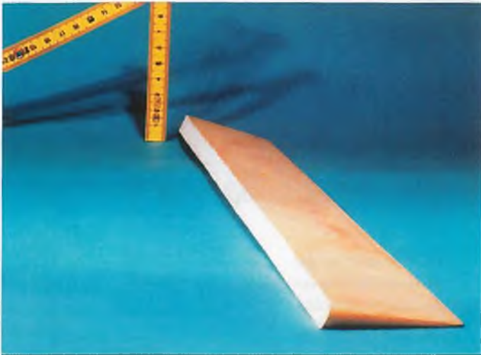
Leider war das Höhenruder total verzogen. Der Hersteller sollte unbedingt vermeiden, die Holzmaserung der Bepankung auf Ober- und Unterseite in unterschiedlichen diagonalen Richtungen aufzubringen.
