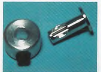
▲ Der „Umrüstsatz“, um den mechanischen Arlton-Kreisel durch eine elektronische Stabilisierung zu ersetzen. Ist in der E-Version Serie, kann aber generell nachgerüstet werden.
