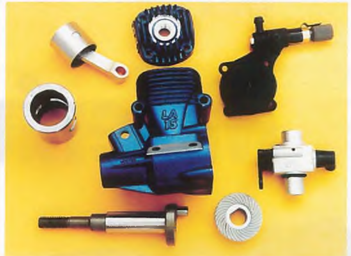
▲ Der 15 LA in Einzelteilen: Pfliffig ist die Lösung mit der am Kurbelgehäusedeckel montierten Düsenadel.
