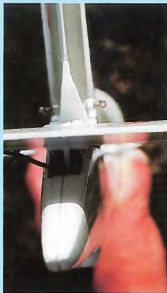
◀ Die Höhenruderanlenkung liegt verdeckt im Rumpf, daneben ist auch noch Platz für die Antenne.
