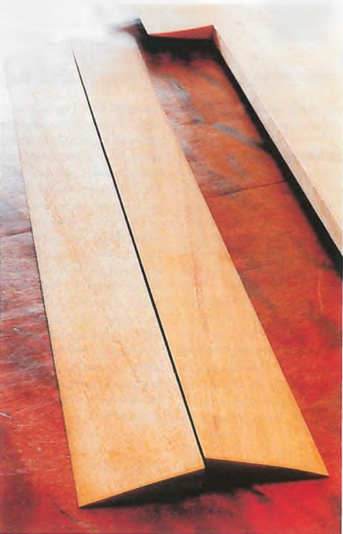
Die vorgefrästen und noch zu verkastenden Querruder sind mittlerweile fertig zum Oracovern. Erstaunt musste ich feststellen, dass der Hersteller die Querruder in unterschiedlichen Längen ausgefräst hat.
