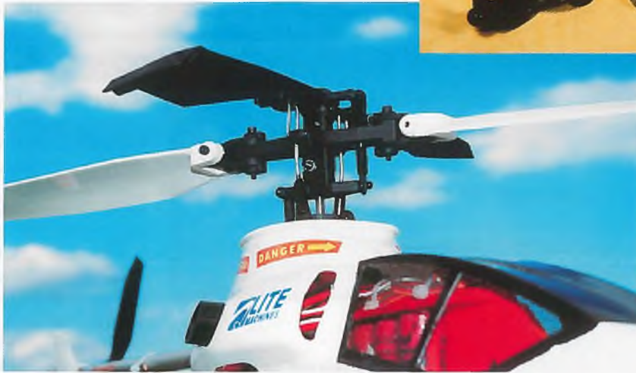
▲ Die Taumelscheibe dürfte das präziseste Teil am ganzen Hubschrauber sein. Wird sie sauber montiert, läuft sie perfekt.
