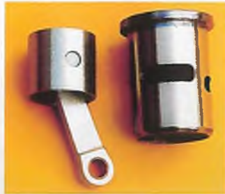
Solide: Die klassische Stahl/Stahl-Garnitur gab auch nach dem Testbetrieb ein einwandfreies Bild ab.
