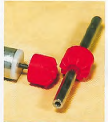
▲ Die Kegelräder des Heckgetriebes. Das Eingangsritzel ist mit dem Antriebsdraht fest verbunden und läuft in Teflonlager. Gut geschmiert gibt es damit absolut keine Probleme.
