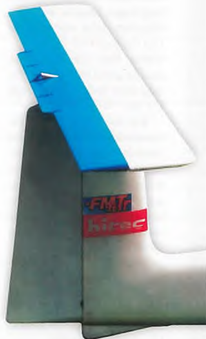
Das Höhenruder mit dem Trimm- bzw. Flettnerrudder.
