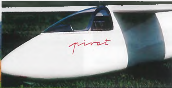
Die Haube geriet im vorderen Bereich etwas schlanker als beim Original.
