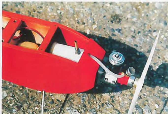
▲ Ein selbst gefertigter Tank mit 20 cm 3 Hubraum sorgt für Flugzeiten um 15 Minuten.
